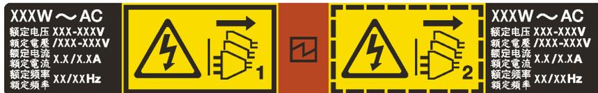
Figura 58. Etiqueta de fonte de alimentação hot-swap na tampa
