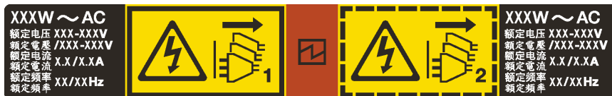
Рис. 58. Этикетка оперативно заменяемого блока питания на крышке
