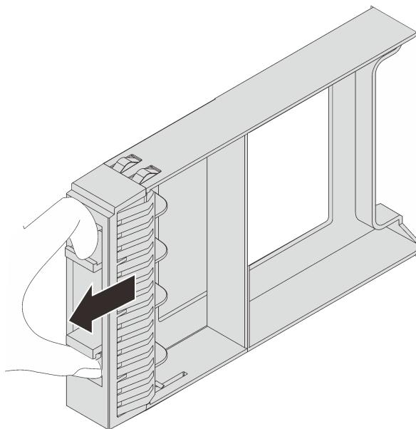
图 66. 卸下 2.5 英寸硬盘填充件
