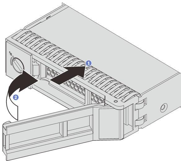
图 71. 安装易插拔硬盘
