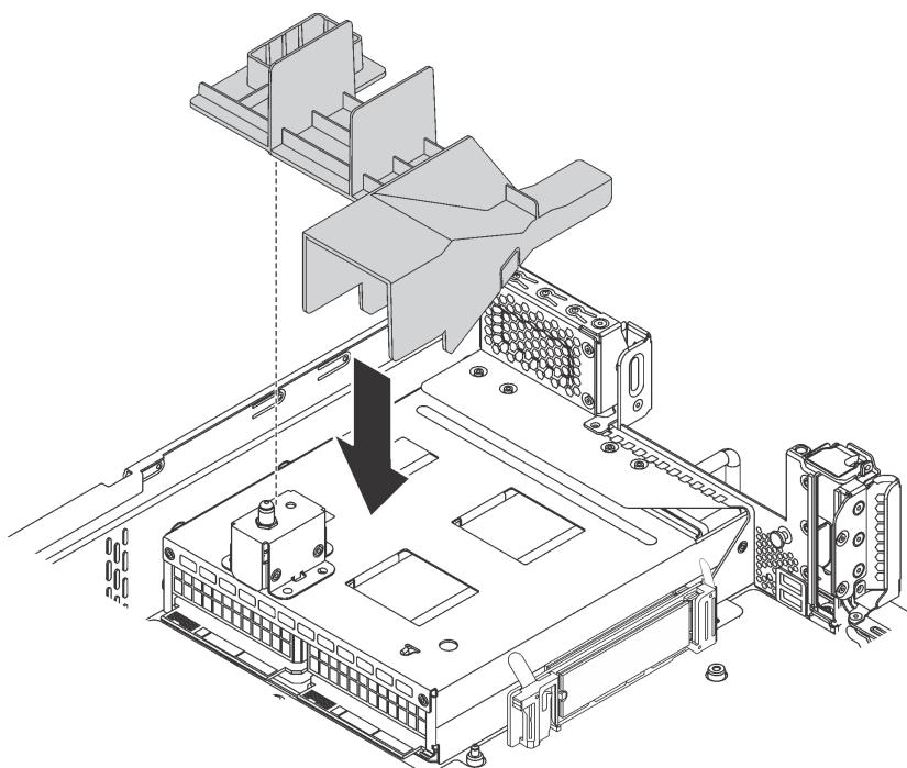
图 47. M.2 硬盘导风罩安装
