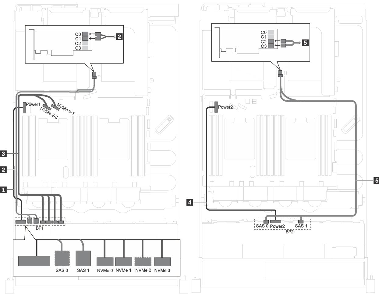
图22. 配备十二个 2.5 英寸 SAS/SATA 硬盘、四个 2.5 英寸 SAS/SATA/NVMe 硬盘和一个 16i RAID/HBA 适配器的服务器型号的线缆布放
