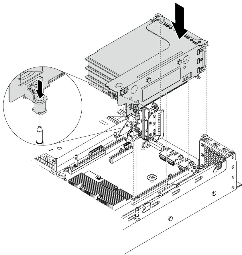
图 51. 安装转接卡 1 组合件
