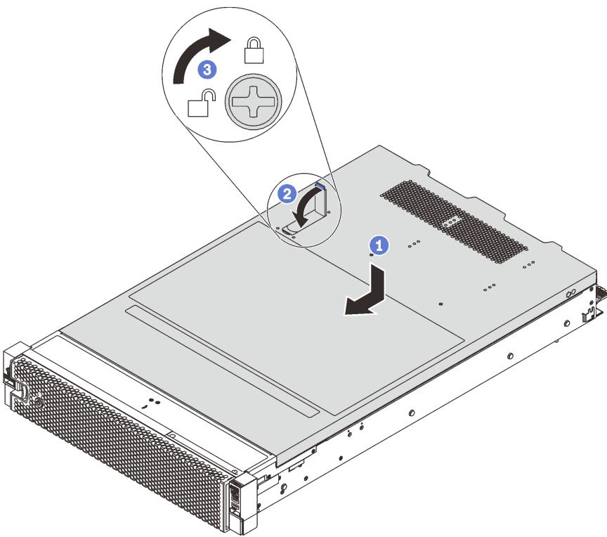
图 64. 安装顶盖
