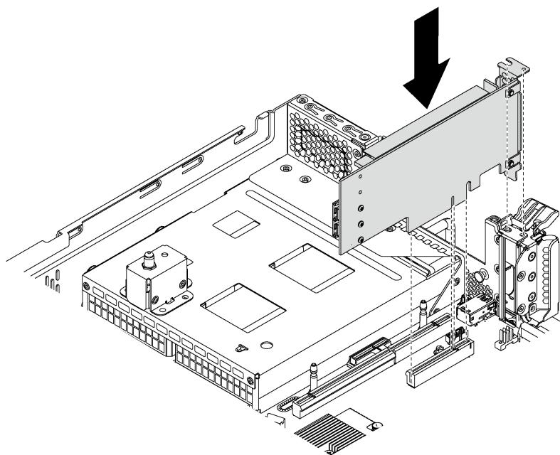
图 53. 将 PCIe 适配器安装到主板上
