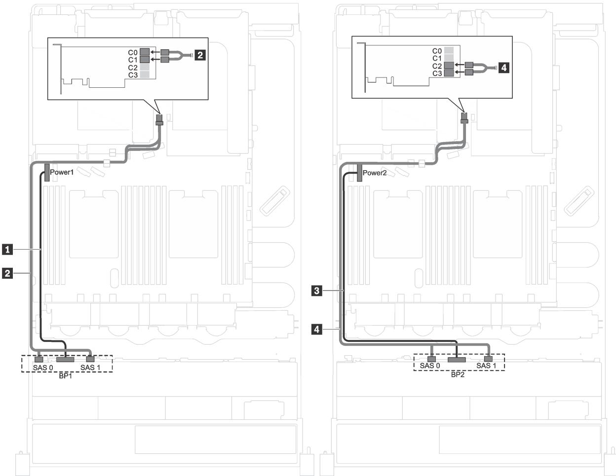
图 21. 配备十六个 2.5 英寸 SAS/SATA 硬盘和一个 16i RAID/HBA 适配器的服务器型号的线缆布放
