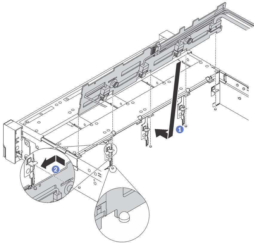
图 39. 安装 3.5 英寸硬盘背板
