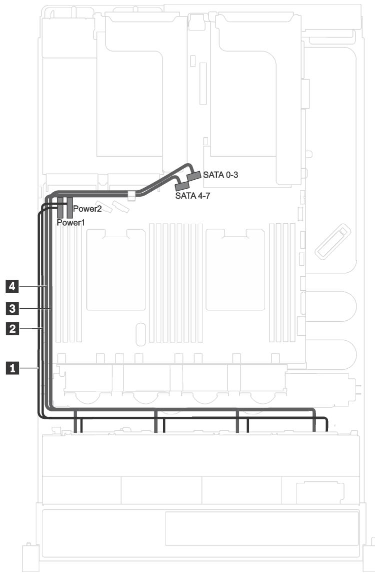
图 24. 配备八个 3.5 英寸易插拔硬盘的服务器型号的线缆布放
