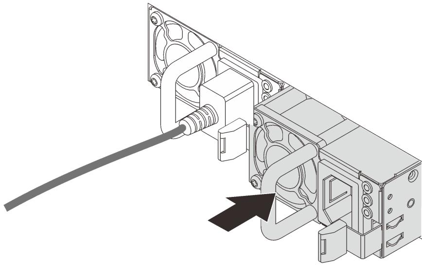
图 60. 安装热插拔电源模块
