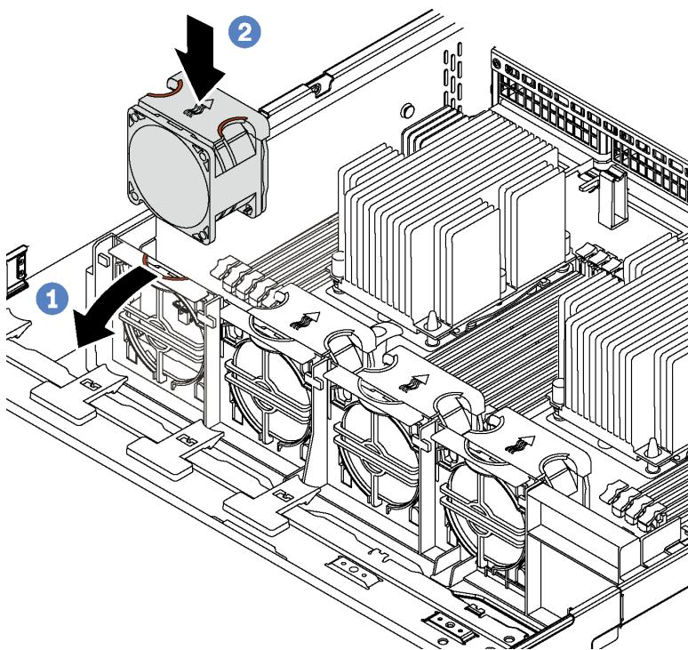
图 57. 安装系统风扇
