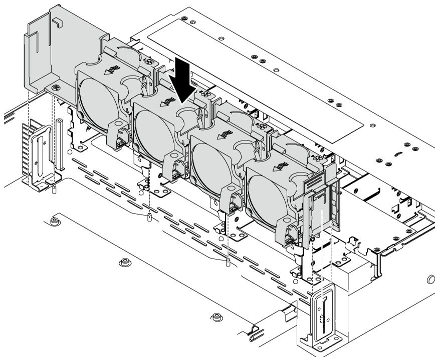
图 56. 安装系统风扇架
