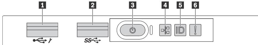
图 8. 配备八个 3.5 英寸硬盘插槽、八个 2.5 英寸硬盘插槽和十六个 2.5 英寸硬盘插槽的服务器型号的正面 I/O 组合件
