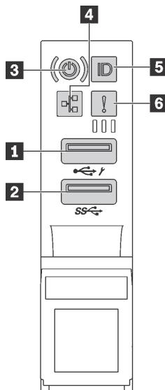
图 9. 配备十二个 3.5 英寸硬盘插槽的服务器型号的正面 I/O 组合件
