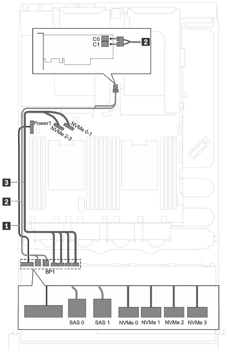
图 19. 配备四个 2.5 英寸 SAS/SATA 硬盘、四个 2.5 英寸 SAS/SATA/NVMe 硬盘和一个 8i RAID/HBA 适配器的服务器型号的线缆布放
