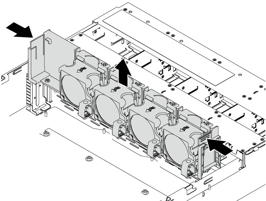
图 33. 卸下系统风扇架
