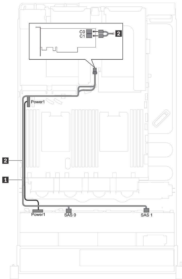
图 23. 配备八个 3.5 英寸热插拔硬盘和一个 8i RAID/HBA 适配器的服务器型号的线缆布放
