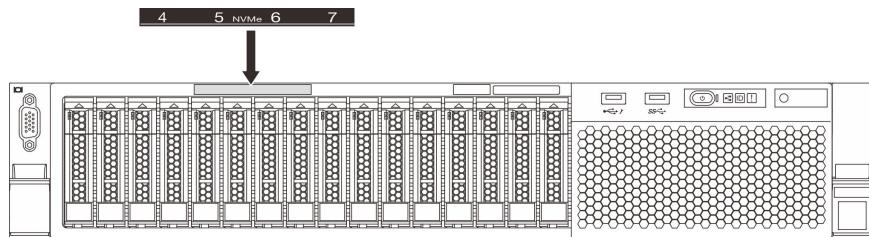
图 65. NVMe 硬盘的硬盘插槽标签
