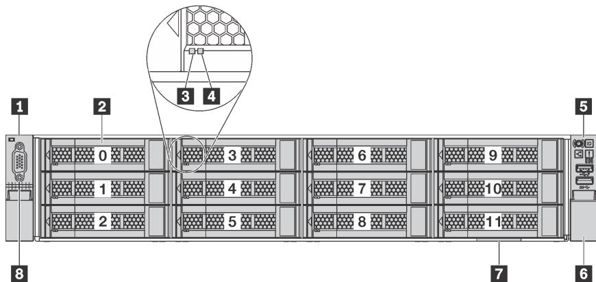
图 7. 配备十二个 3.5 英寸硬盘插槽 (0-11) 的服务器型号的前视图
