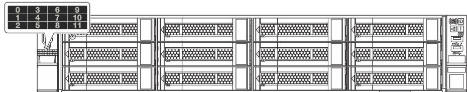
图 40. 装有 12 插槽背板的服务器型号的硬盘插槽标签
