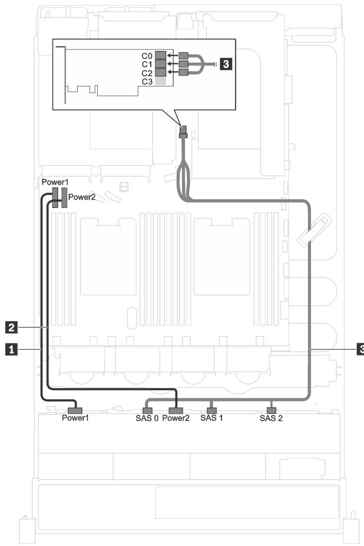
图 25. 配备十二个 3.5 英寸 SAS/SATA 硬盘和一个 16i RAID/HBA 适配器的服务器型号的线缆布放
