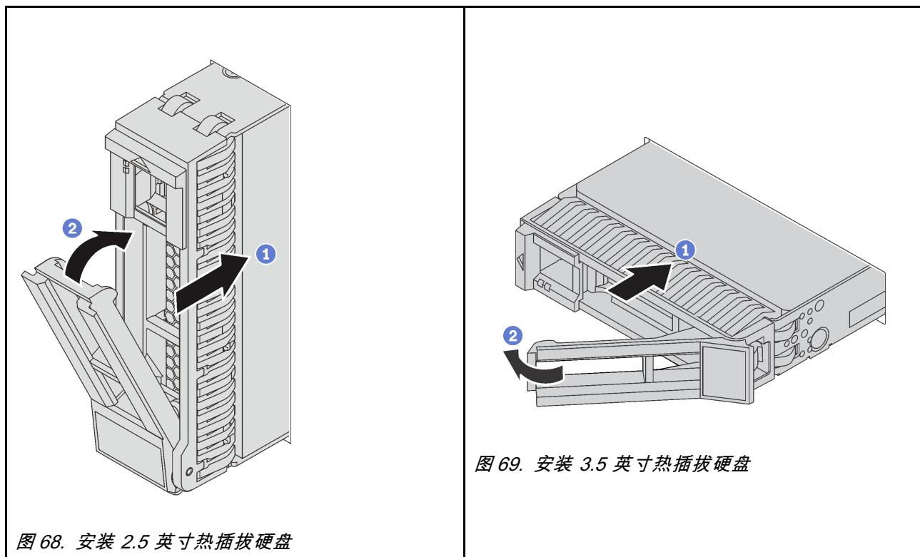
图 68. 安装 2.5 英寸热插拔硬盘
