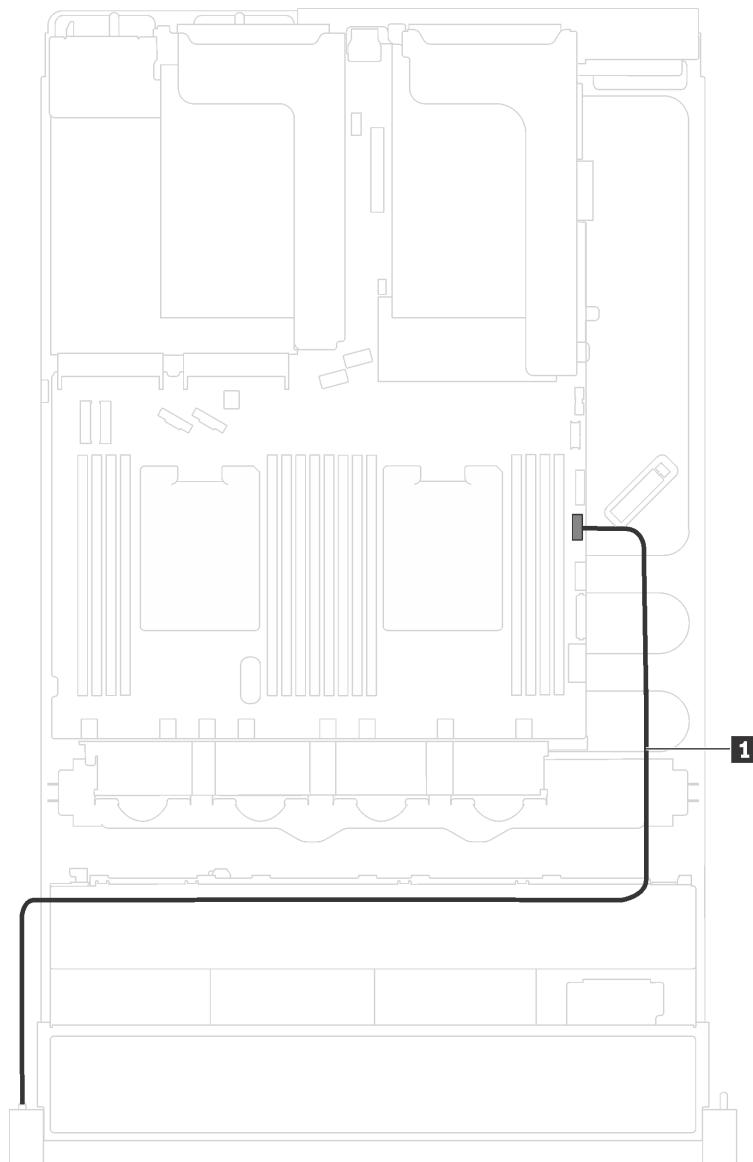
图 15. VGA 接口线缆布放
