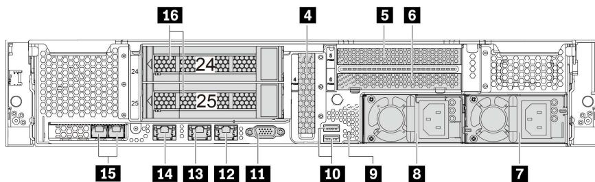
图 11. 配备两个背面硬盘插槽 (24-25) 和三个 PCIe 插槽的服务器型号的后视图
