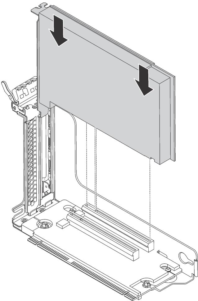
图 49. 安装 PCIe 适配器
