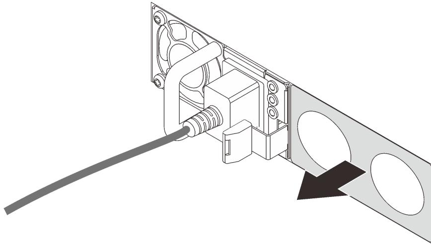
图 59. 卸下热插拔电源模块填充件
