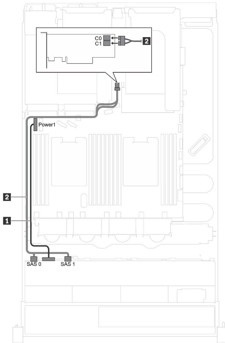
图 18. 配备八个 2.5 英寸 SAS/SATA 硬盘和一个 8i RAID/HBA 适配器的服务器型号的线缆布放
