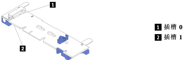
图 43. M.2 硬盘插槽
