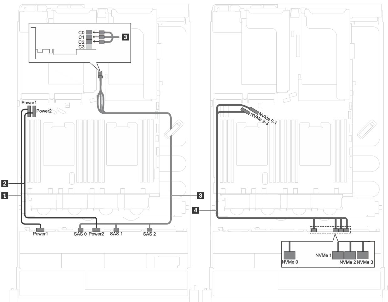
图 27. 配备八个 3.5 英寸 SAS/SATA 硬盘、四个 3.5 英寸 SAS/SATA/NVMe 硬盘和一个 16i RAID/HBA 适配器的服务器型号的线缆布放
