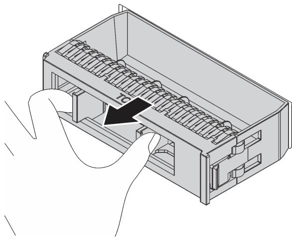
图 67. 卸下 3.5 英寸硬盘填充件
