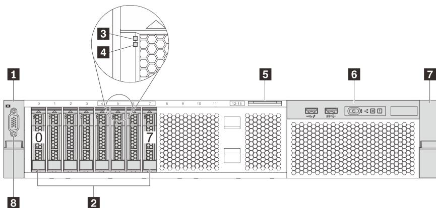
图 4. 配备八个 2.5 英寸硬盘插槽 (0-7) 的服务器型号的前视图
