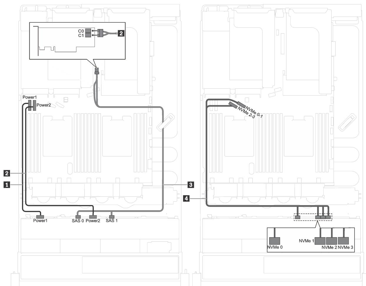
图 26. 配备八个 3.5 英寸 SAS/SATA 硬盘、四个 3.5 英寸 NVMe 硬盘和一个 8i RAID/HBA 适配器的服务器型号的线缆布放
