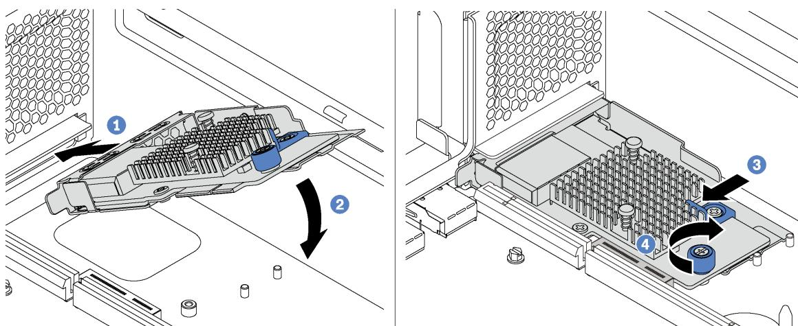
图 54. 安装 LOM 适配器
