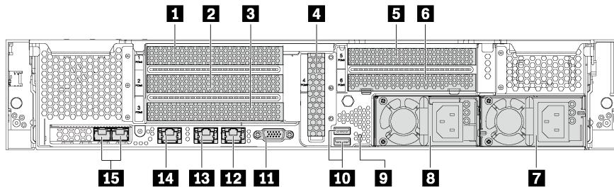
图 10. 配备六个 PCIe 插槽的服务器型号的后视图
