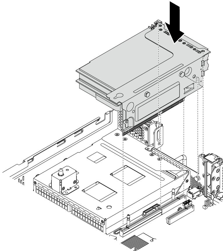
图 52. 安装转接卡 2 组合件
