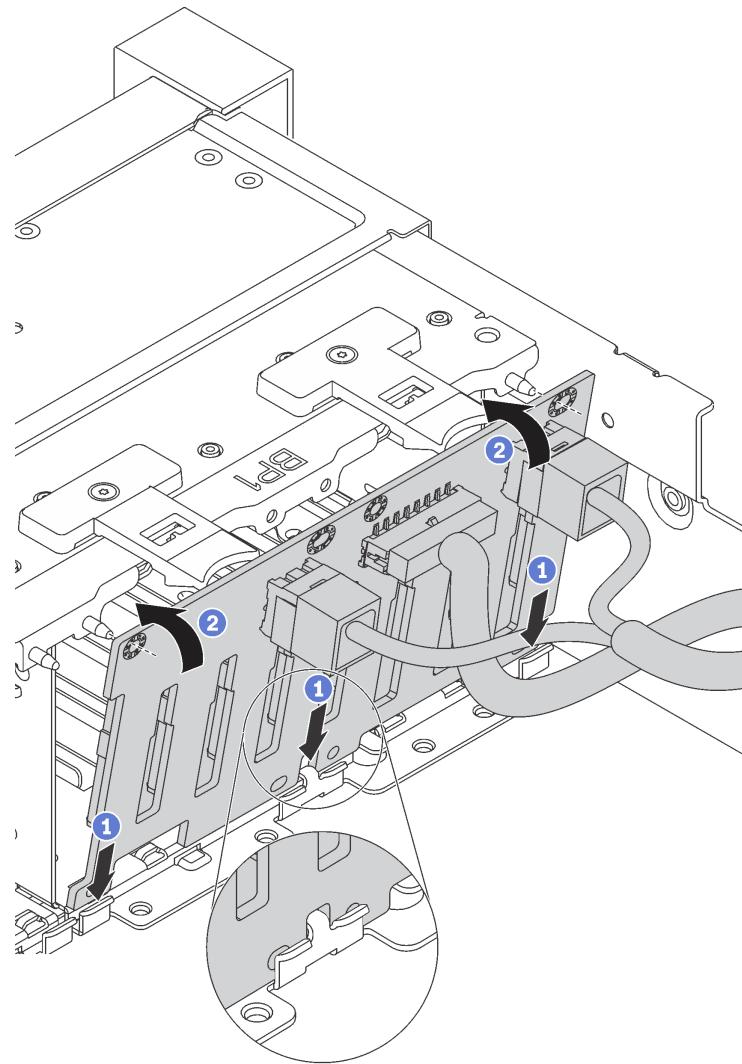
图 37. 安装 2.5 英寸硬盘背板
