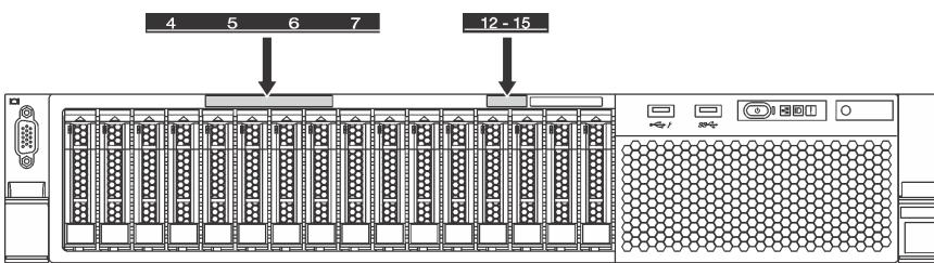
图 38. 装有两个 SATA/SAS 背板的服务器型号的硬盘插槽标签
