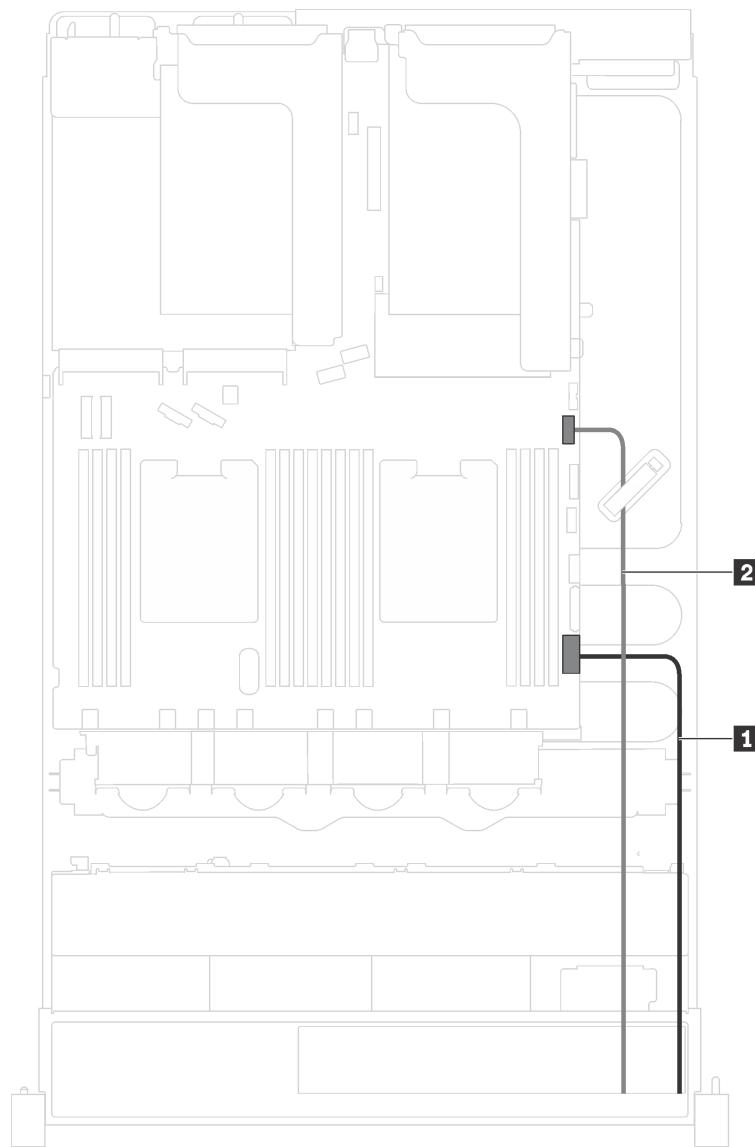
图 16. 机箱上的正面 I/O 组合件的线缆布放
