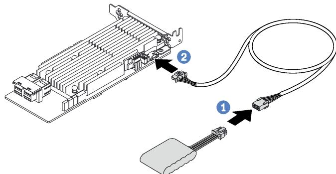
图 63. 将 RAID 超级电容器模块连接到 RAID 适配器
