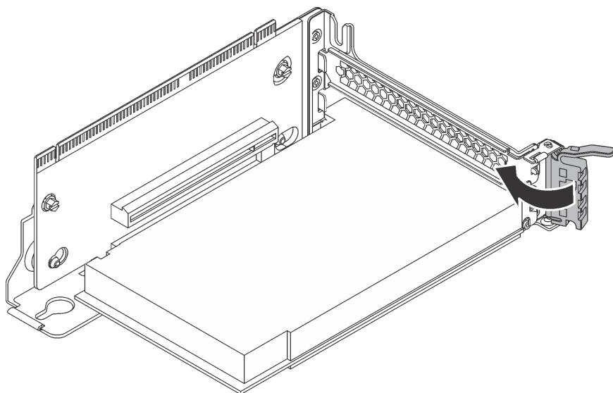
图 50. 闭合 PCIe 适配器固定滑锁
