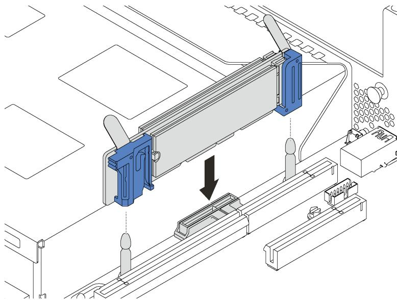
图 46. 安装 M.2 背板
