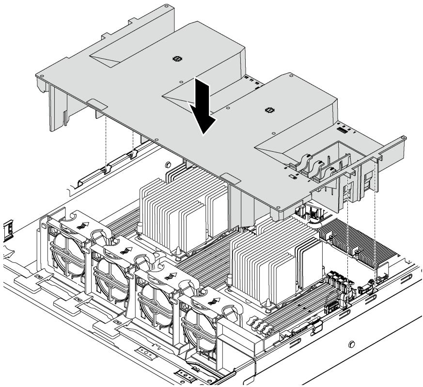
图 61. 安装导风罩
