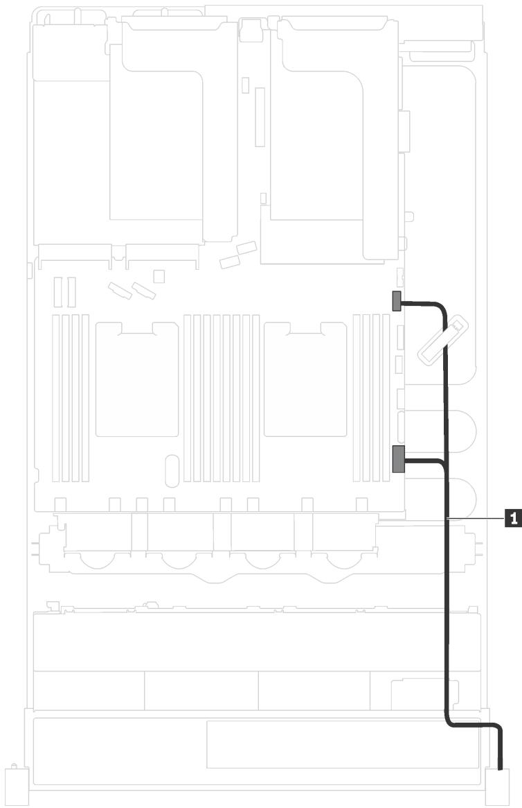
图 17. 右侧机架滑锁上的正面 I/O 组合件的线缆布放
