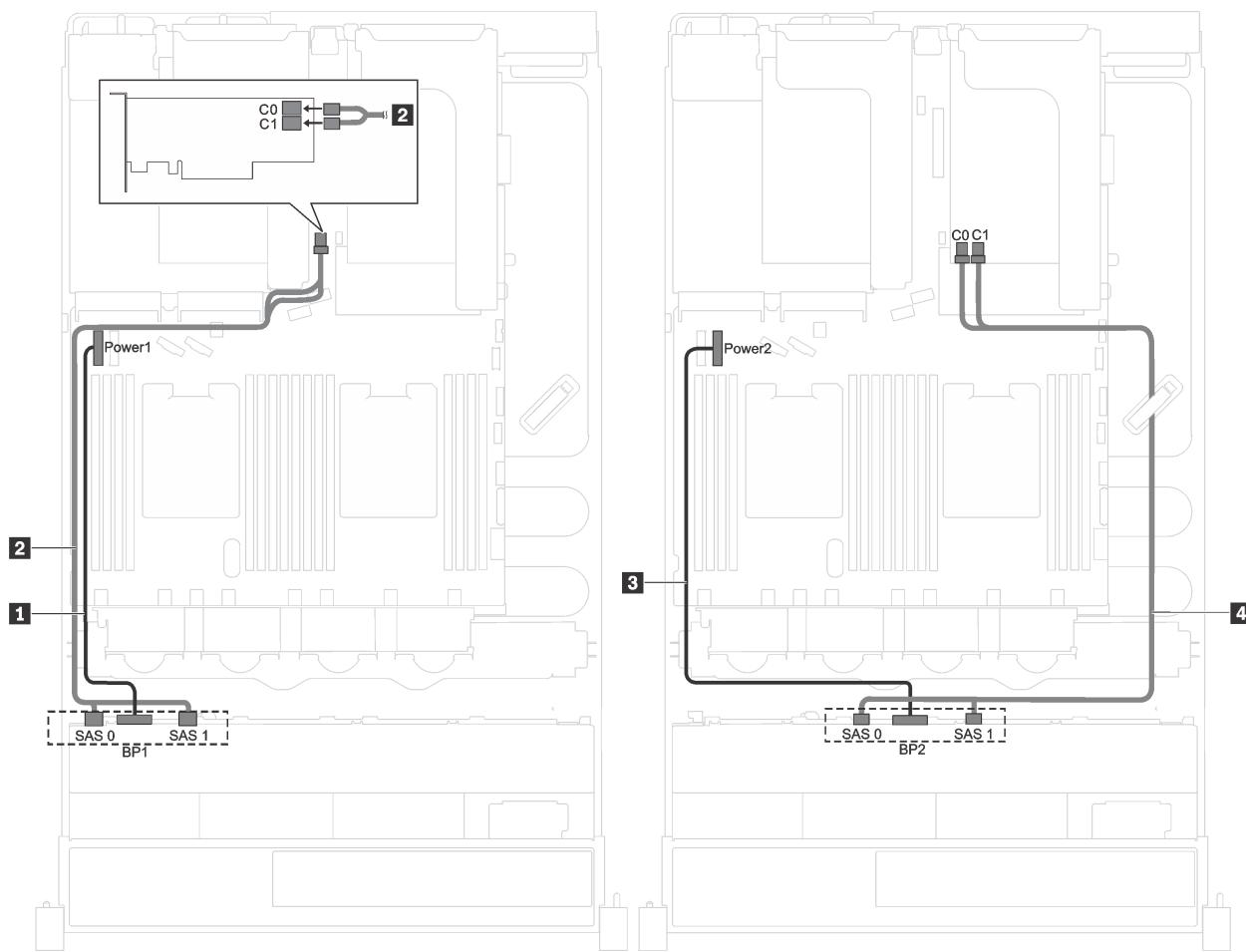
图 20. 配备十六个 2.5 英寸 SAS/SATA 硬盘和两个 8i RAID/HBA 适配器的服务器型号的线缆布放
