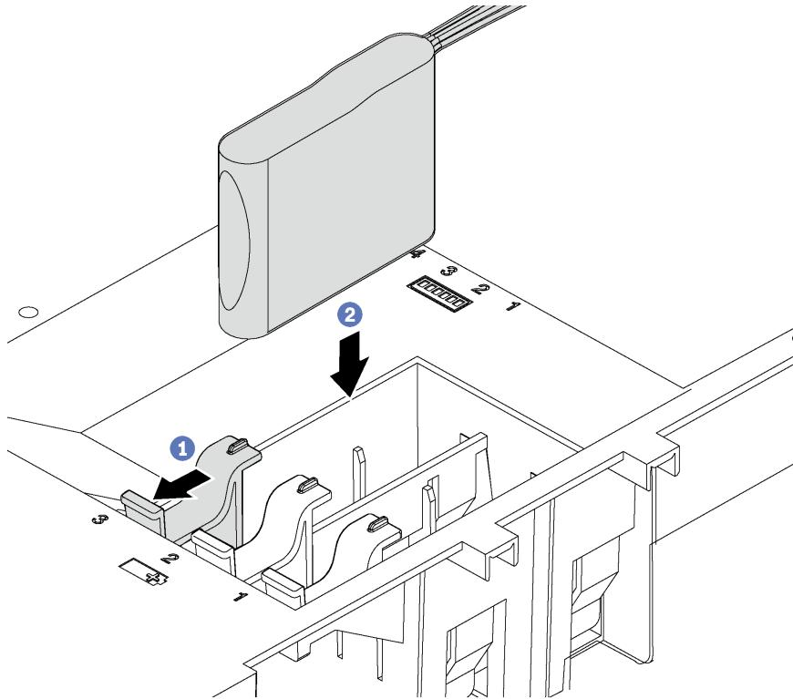
图 62. 安装 RAID 超级电容器模块
