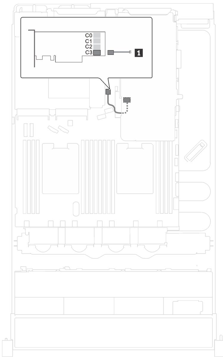
图 42. 背面热插拔硬盘组合件的线缆布放
