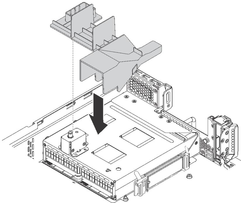
圖例 47. M.2 硬碟空氣擋板安裝
