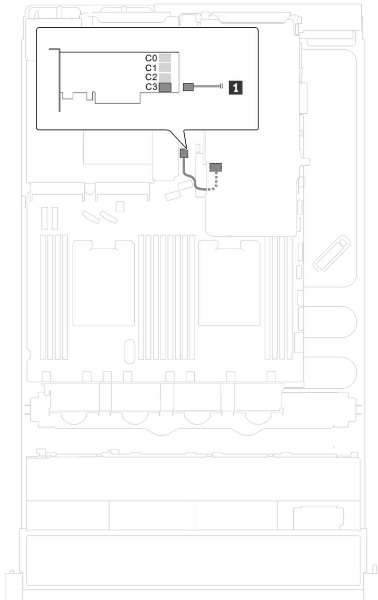
圖例 42. 背面熱抽換硬碟組件的纜線佈線
