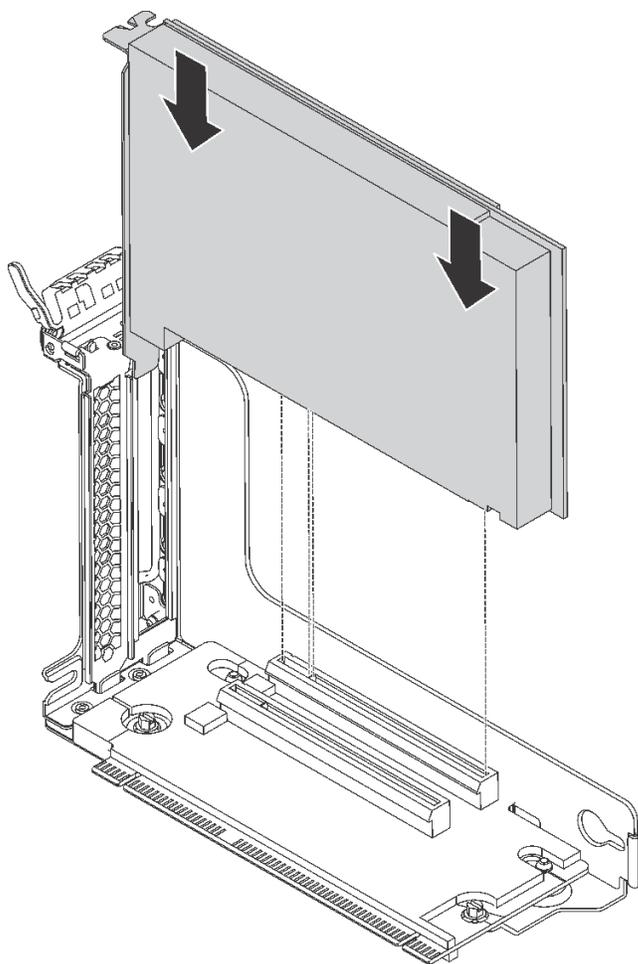
圖例 49. PCIe 配接卡安裝
