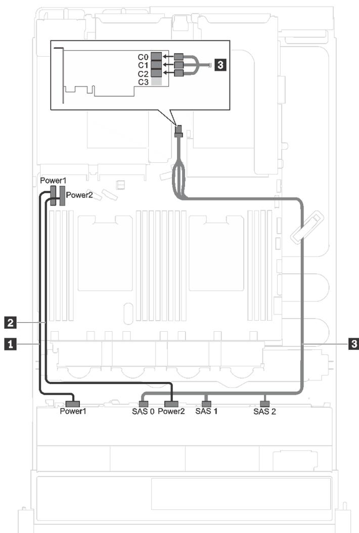
圖例 25. 配備十二個 3.5 吋 SAS/SATA 硬碟和一個 16i RAID/HBA 配接卡的伺服器型號的纜線佈線
