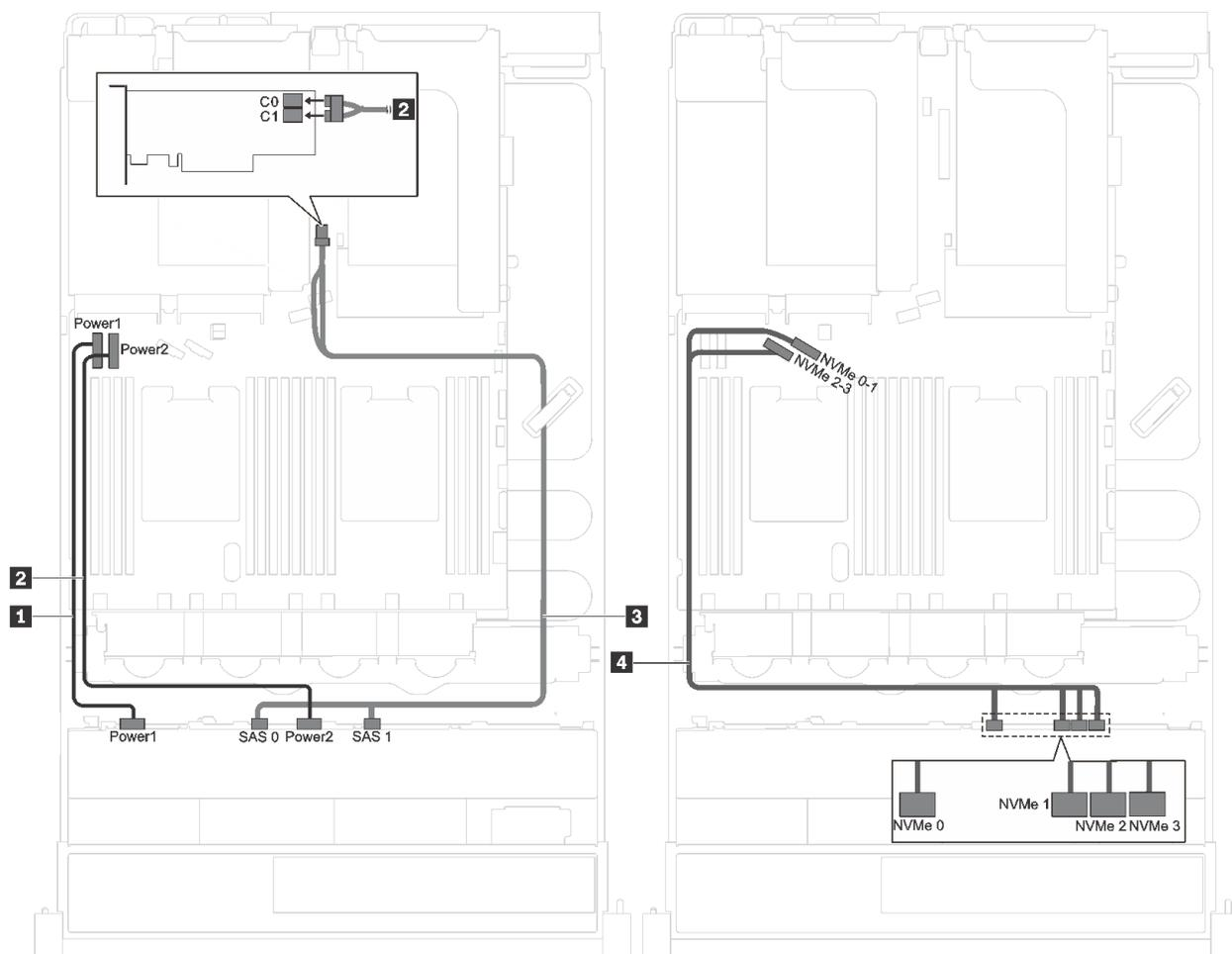
圖例 26. 配備八個 3.5 吋 SAS/SATA 硬碟、四個 3.5 吋 NVMe 硬碟和一個 8i RAID/HBA 配接卡的伺服器型號的纜線佈線
