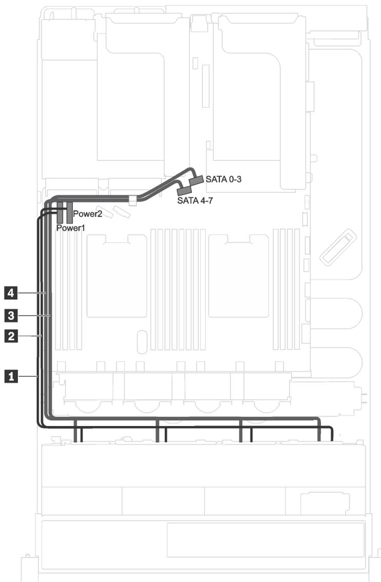
圖例 24. 配備八個 3.5 吋簡易抽換硬碟之伺服器型號的纜線佈線
