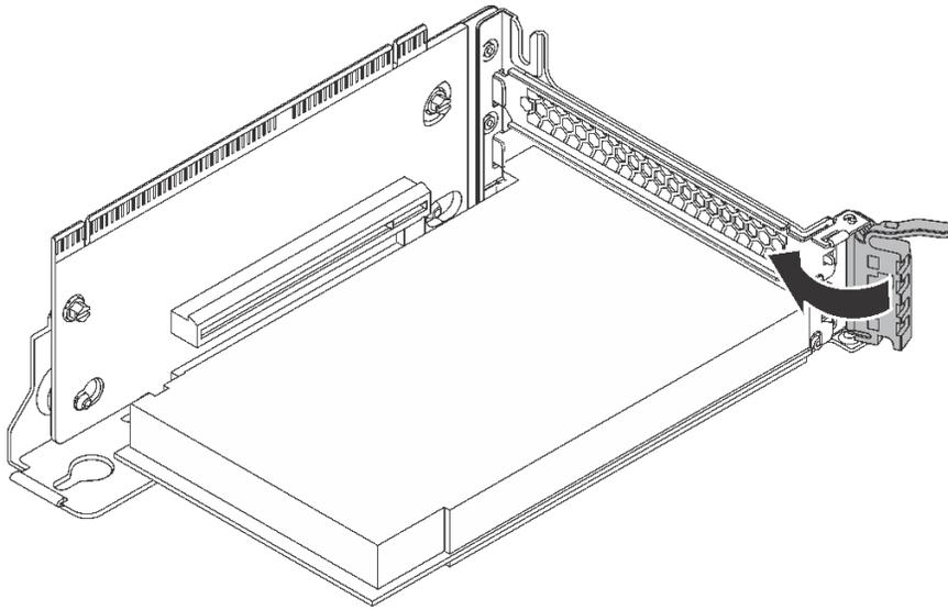
圖例 50. 關上 PCIe 配接卡固定門鎖
