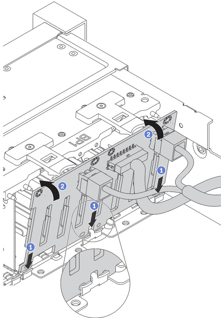
圖例 37. 2.5 吋硬碟背板安裝
