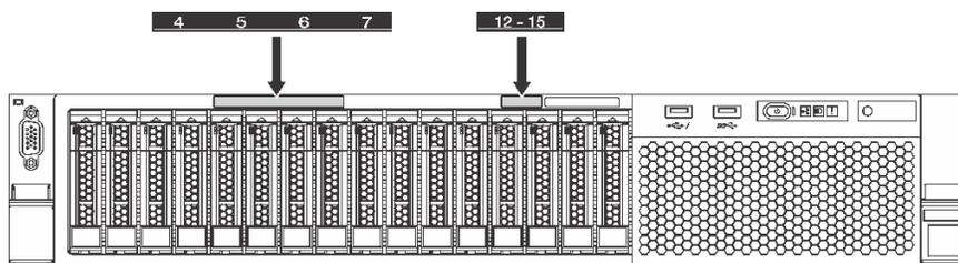
圖例 38. 適用於已安裝兩個 SATA/SAS 背板的伺服器型號的機槽標籤
