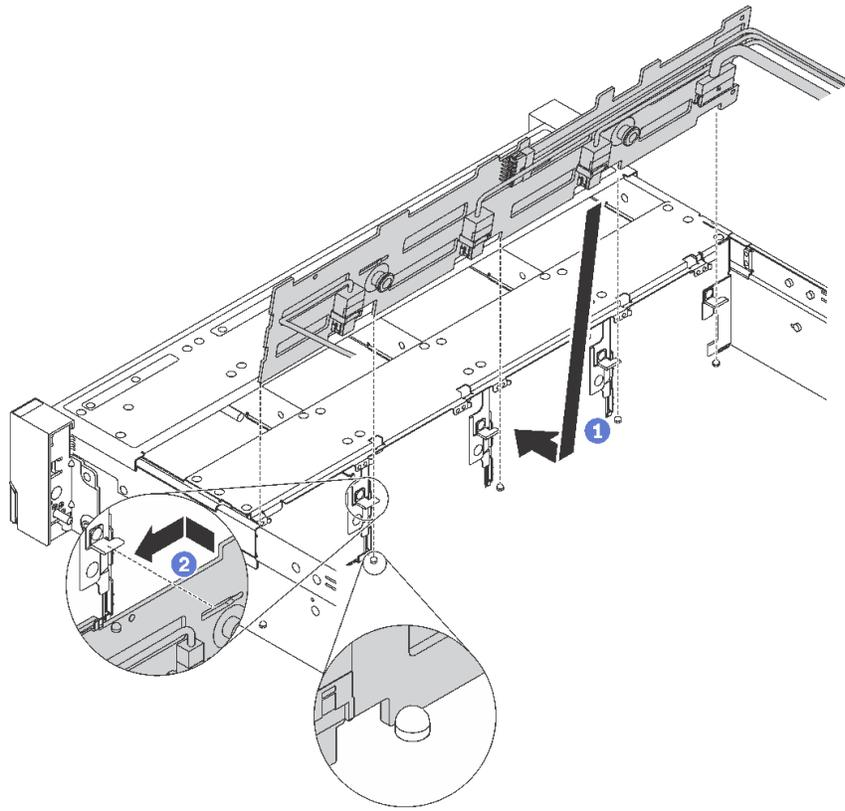
圖例 39. 3.5 吋硬碟背板安裝
