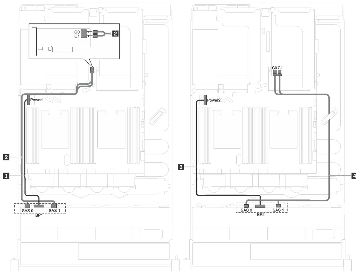
圖例 20. 配備十六個 2.5 吋 SAS/SATA 硬碟及兩個 8i RAID/HBA 配接卡的伺服器型號的纜線佈線
