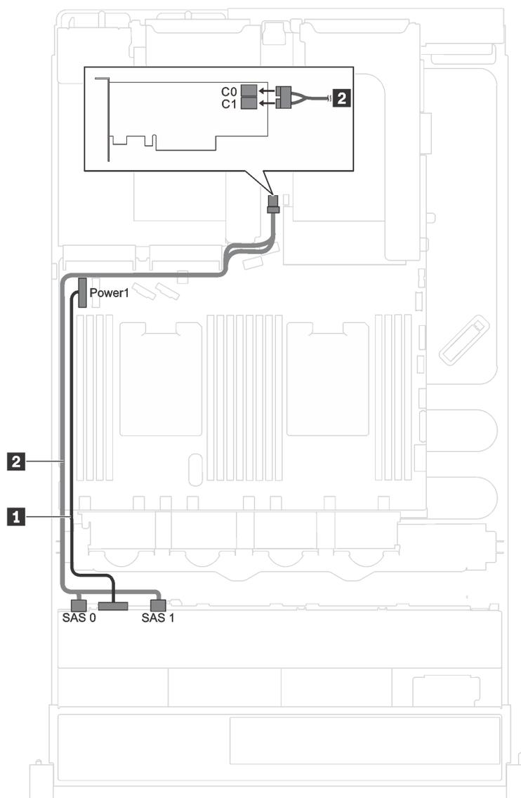
圖例 18. 配備八個 2.5 吋 SAS/SATA 硬碟及一個 8i RAID/HBA 配接卡的伺服器型號的纜線佈線
