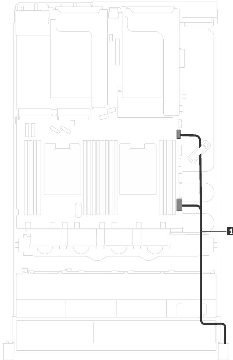
圖例 17. 右機架門鎖上正面 I/O 組件的纜線佈線
