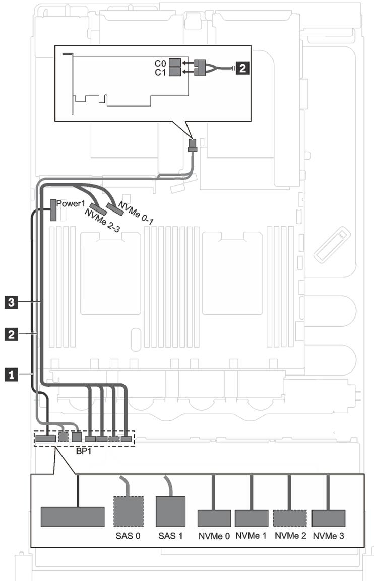
圖例 19. 配備四個 2.5 吋 SAS/SATA 硬碟、四個 2.5 吋 SAS/SATA/NVMe 硬碟和一個 8i RAID/HBA 配接卡的伺服器型號的纜線佈線
