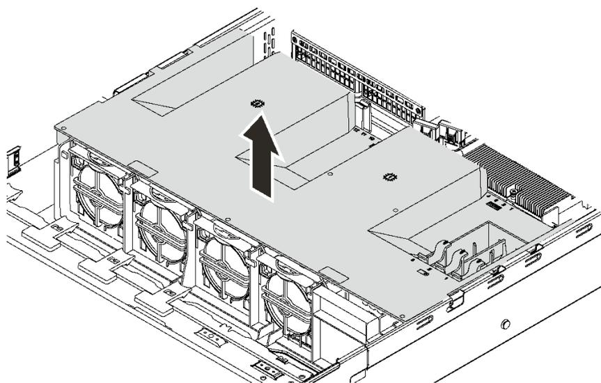
圖例 32. 卸下空氣擋板
