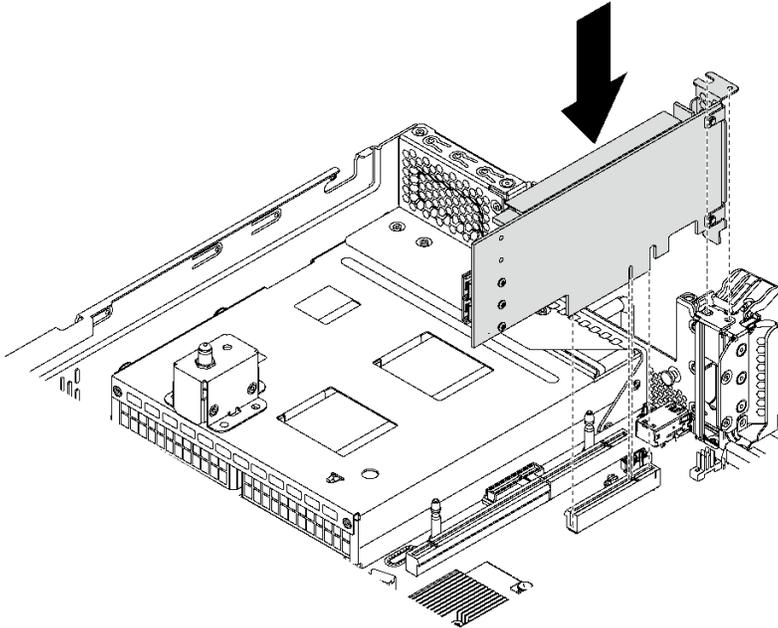
圖例 53. 將 PCIe 配接卡安裝在主機板上
