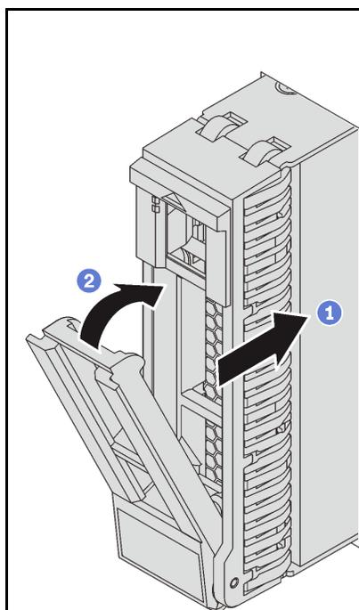
圖例 68. 安裝 2.5 吋熱抽換硬碟
