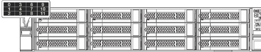
圖例 40. 適用於已安裝一個 12 機槽背板的伺服器型號的機槽標籤
