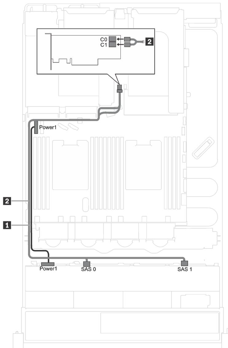
圖例 23. 配備八個 3.5 吋熱抽換硬碟及一個 8i RAID/HBA 配接卡的伺服器型號的纜線佈線
