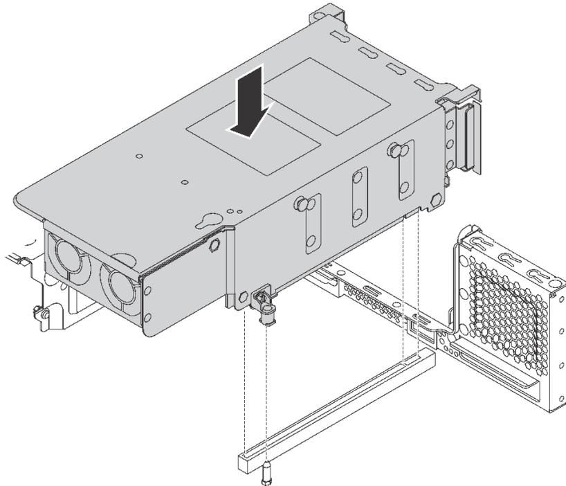
圖例 41. 安裝背面熱抽換硬碟組件
