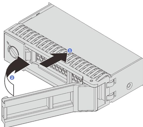
圖例 71. 簡易抽換硬碟安裝
