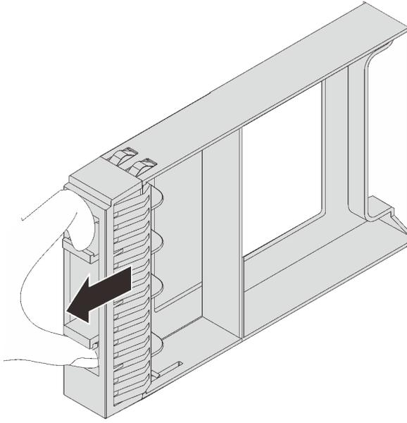
圖例 66. 卸下 2.5 吋硬碟填充板
