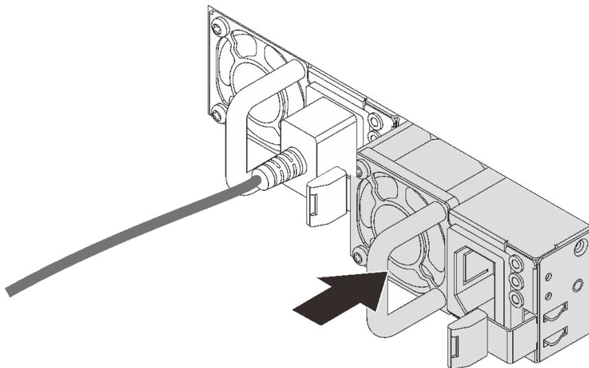
圖例 60. 安裝熱抽換電源供應器
