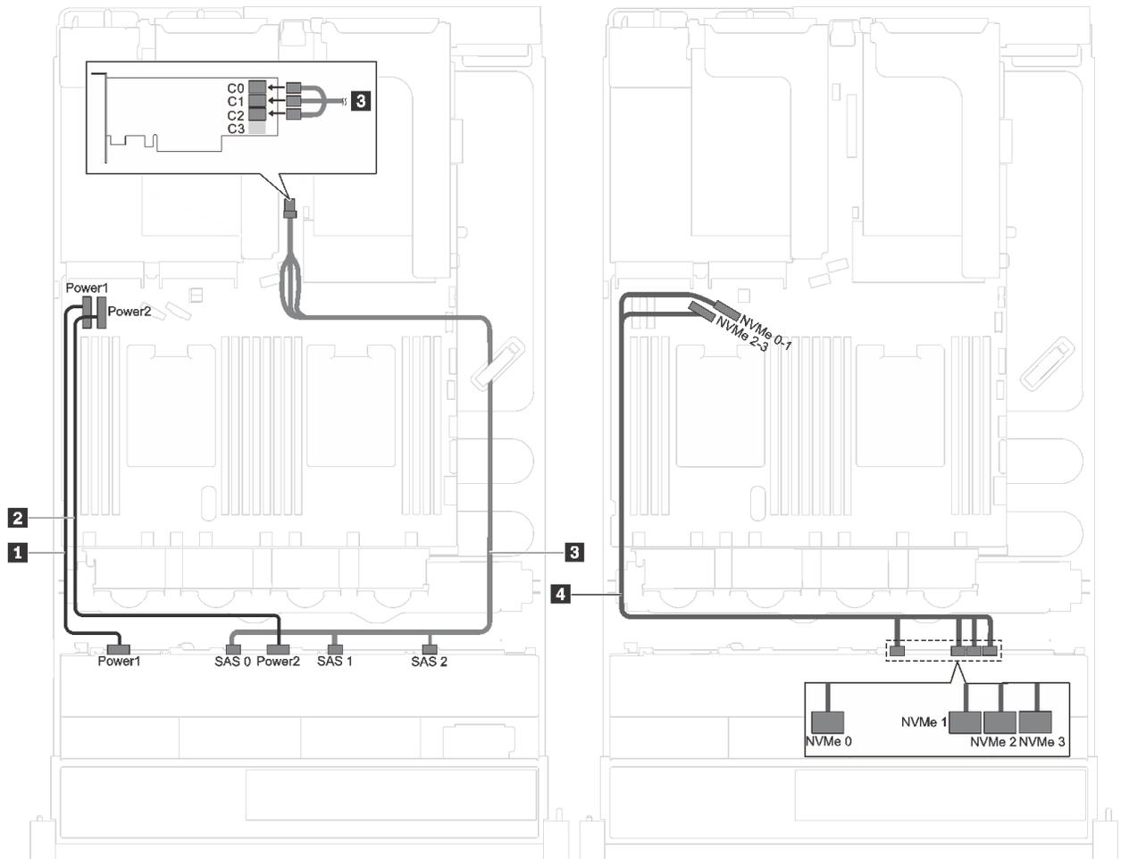
圖例 27. 配備八個 3.5 吋 SAS/SATA 硬碟、四個 3.5 吋 SAS/SATA/NVMe 硬碟和一個 16i RAID/HBA 配接卡的伺服器型號的纜線佈線
