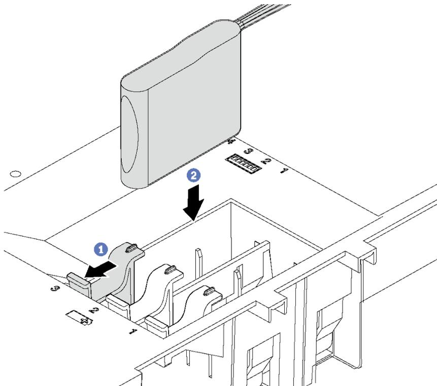
圖例 62. RAID 超級電容器模組安裝
