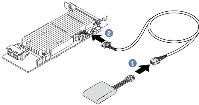
圖例 63. 將 RAID 超級電容器模組連接至 RAID 配接卡
