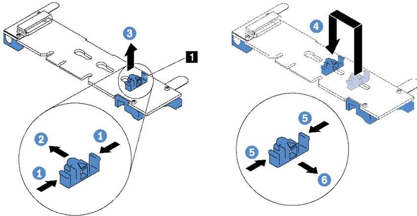
圖例 48. 調整 M.2 固定器
