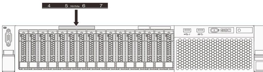
圖例 65. NVMe 硬碟的機槽標籤
