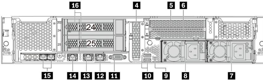
圖例 11. 配備兩個背面機槽 (24–25) 和三個 PCIe 插槽的伺服器型號的背面圖
