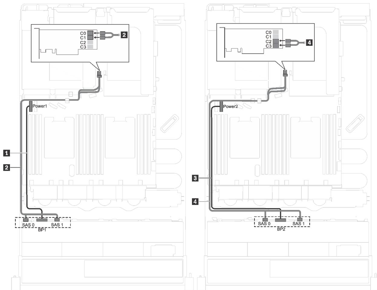
圖例 21. 配備十六個 2.5 吋 SAS/SATA 硬碟及一個 16i RAID/HBA 配接卡的伺服器型號的纜線佈線
