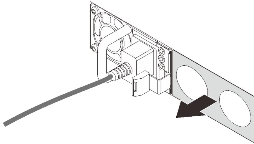
圖例 59. 卸下熱抽換電源供應器填充板
