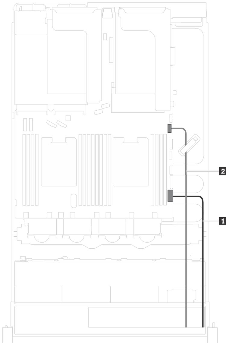
圖例 16. 機箱上正面 I/O 組件的纜線佈線
