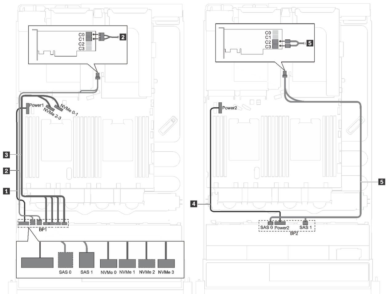
圖例 22. 配備十二個 2.5 吋 SAS/SATA 硬碟、四個 2.5 吋 SAS/SATA/NVMe 硬碟和一個 16i RAID/HBA 配接卡的伺服器型號的纜線佈線
