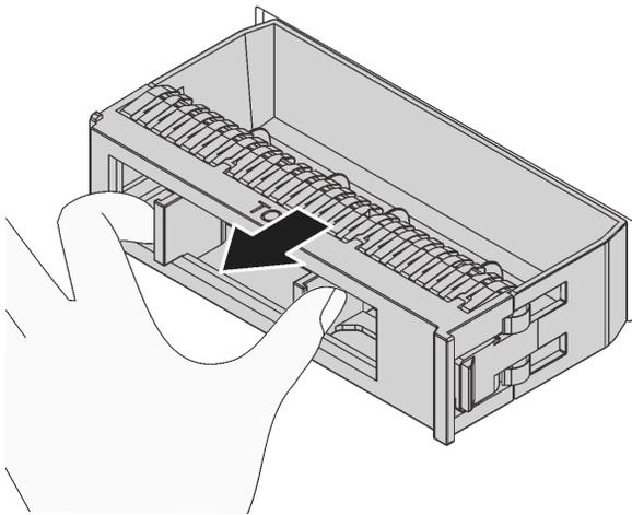
圖例 67. 卸下 3.5 吋硬碟填充板
