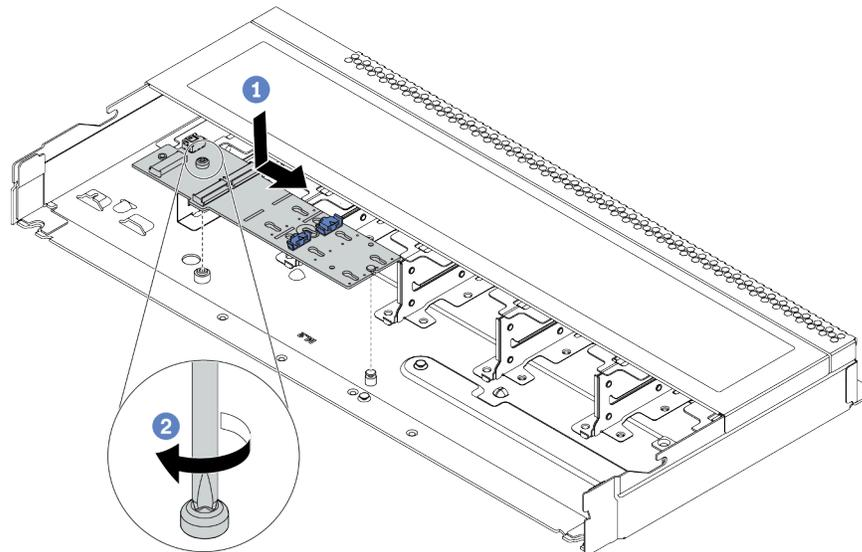
Figura 53. Installazione del backplane M.2
