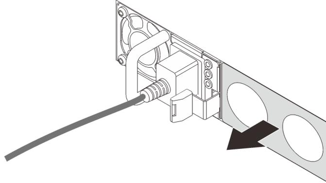
Figura 85. Rimozione dell'elemento di riempimento dell'alimentatore hot-swap
