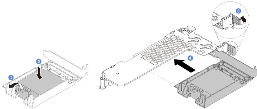
Figura 70. Installazione del modulo di alimentazione flash RAID sulla scheda verticale
