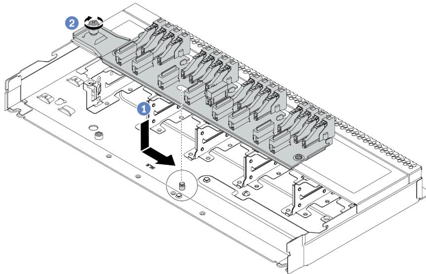
Figura 46. Installazione del backplane per 16 unità EDSFF
