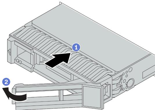
Figura 57. Installazione di un'unità hot-swap
