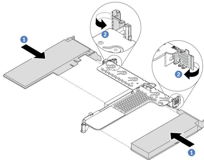
Figura 65. Installazione dell'adattatore PCIe nell'assieme verticale LPFH
