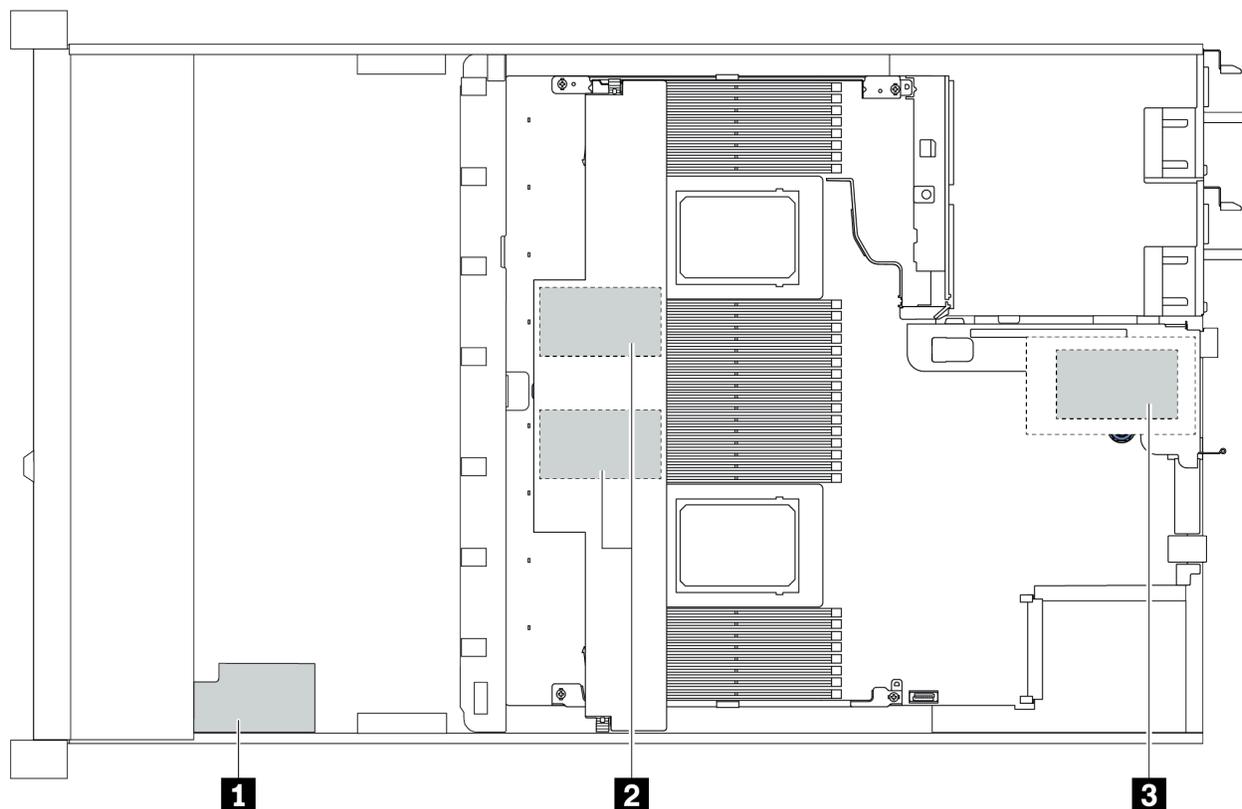
Figura 69. Posizione del modulo di alimentazione flash RAID
