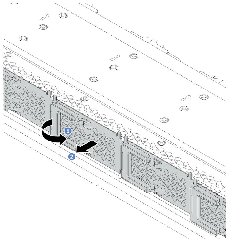
Figura 58. Rimozione del coperchio del telaio unità EDSFF
