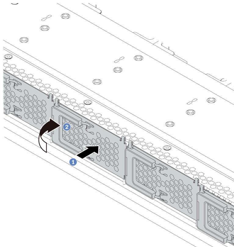
Figura 60. Installazione del coperchio del telaio unità EDSFF
