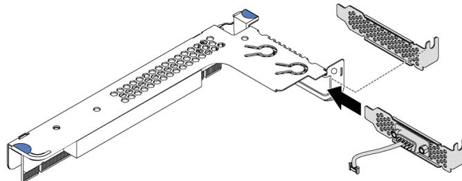
Figura 78. Installazione del modulo della porta seriale
