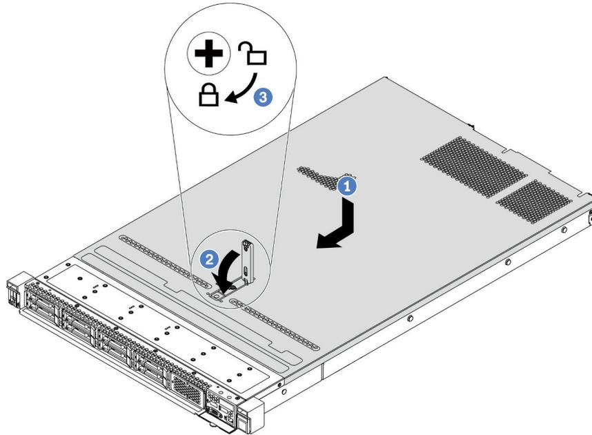
Figura 83. Installazione del coperchio superiore
