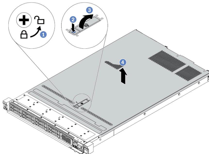
Figura 38. Rimozione del coperchio superiore
