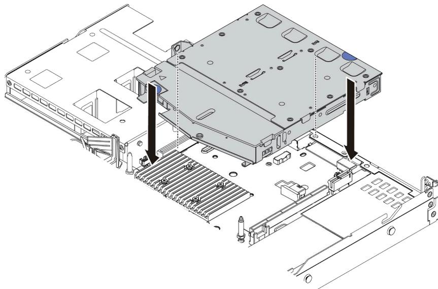
Figura 64. Installazione del telaio dell'unità hot-swap posteriore
