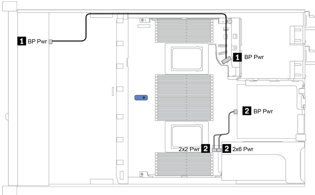
Figura 20. Collegamento dei cavi di alimentazione dei backplane
