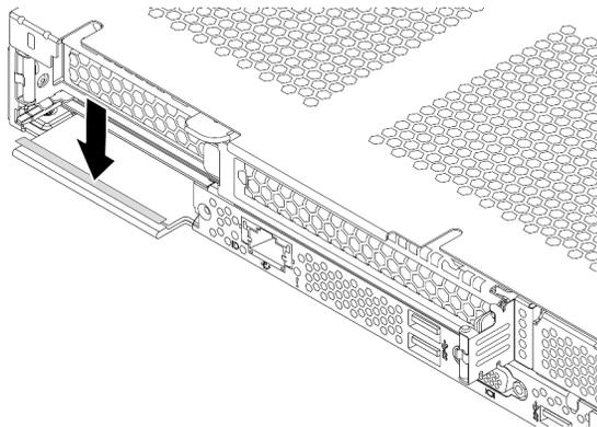
Figura 75. Installazione dell'etichetta dell'adattatore Ethernet OCP 3.0
