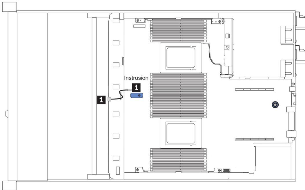
Figura 15. Instradamento dei cavi dello switch di intrusione
