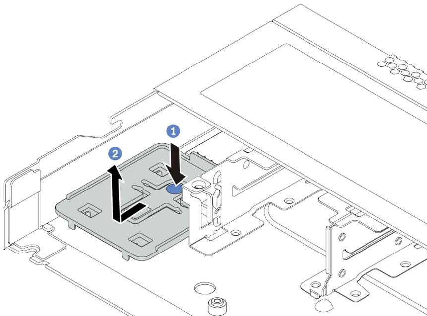
Figura 72. Rimozione del vassoio
