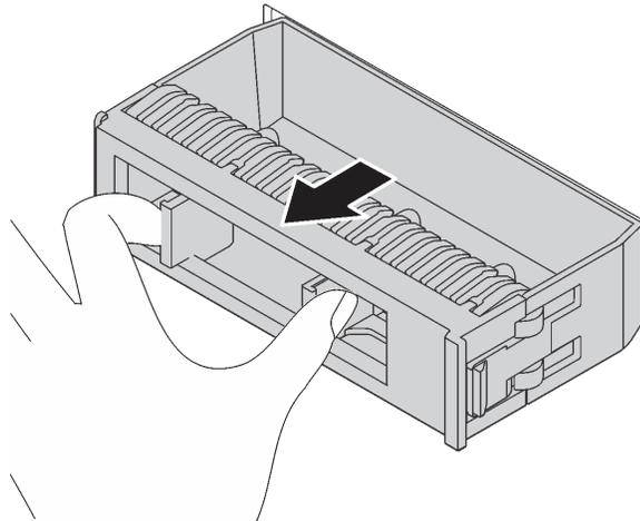
Figura 56. Rimozione dell'elemento di riempimento dell'unità
