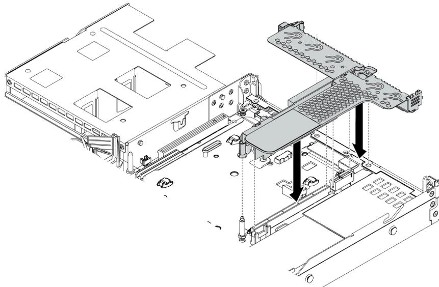
Figura 66. Installazione dell'assieme verticale
