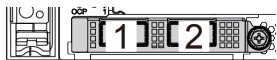
図 100. OCP 3.0 イーサネット・アダプター (背面に 2 個のコネクター)
