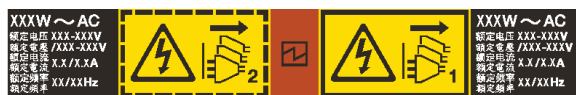
図 84. トップ・カバー上のパワー・サプライ・ユニット・ラベルの例
