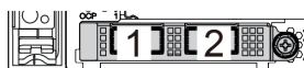
รูปภาพ 7. อะแดปเตอร์อีเทอร์เน็ต OCP 3.0 (หัวต่อสองหัว เห็นได้จากด้านหลัง)
