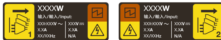
Figura 117. Etiqueta de unidad de fuente de alimentación de ejemplo en la cubierta superior
