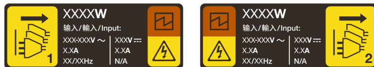
Figure 117. Exemple d'étiquette du bloc d'alimentation sur le carter supérieur
