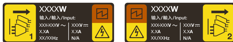
Рис. 99. Пример этикетки модуля блока питания на верхнем кожухе
