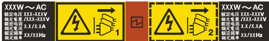
Abbildung 138. Hot-Swap-Netzteil-Etikett auf der Abdeckung
