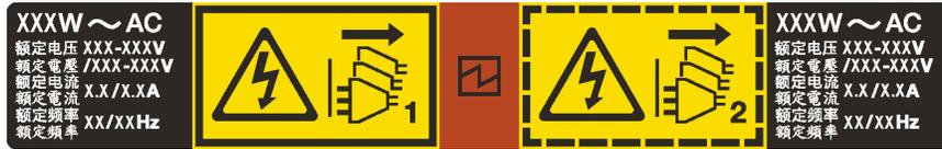
Abbildung 141. Hot-Swap-Netzteil-Etikett auf der Abdeckung
