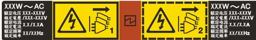
Figure 141. Étiquette du bloc d'alimentation remplaçable à chaud sur le carter
