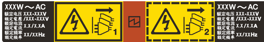
Рис. 141. Этикетка оперативно заменяемого блока питания на крышке
