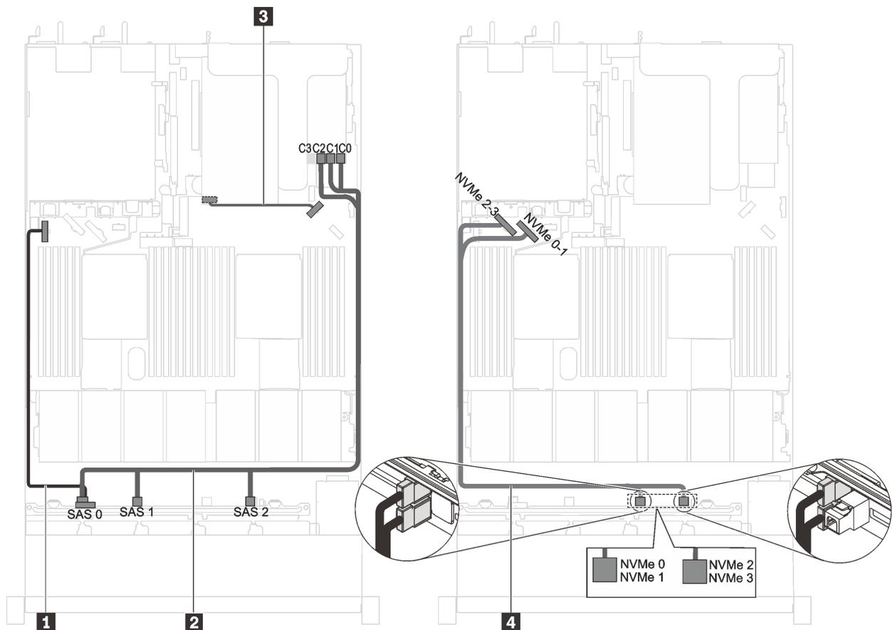
图 35. 装有六个 2.5 英寸 SAS/SATA 硬盘、四个 2.5 英寸 SAS /SATA/NVMe 硬盘和全高半长型 GPU 的服务器型号的线缆布放
