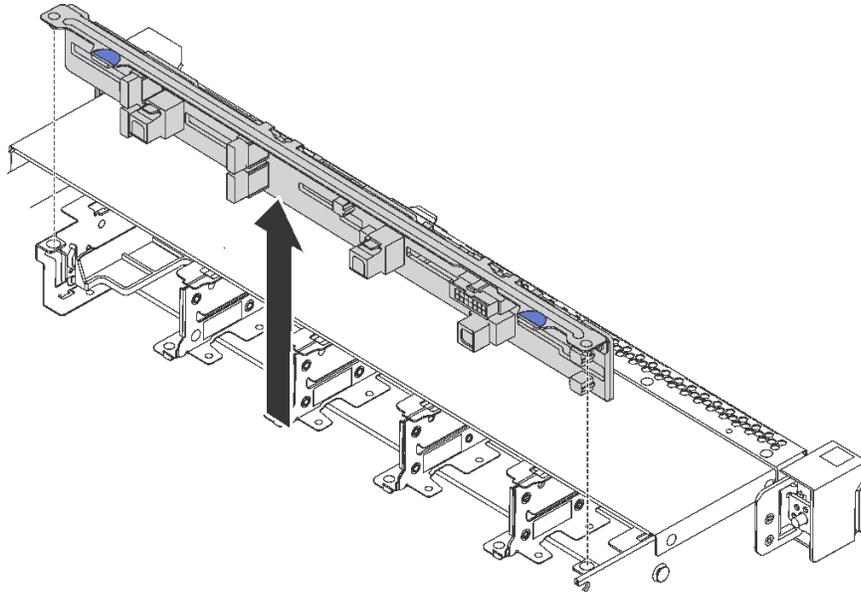
图 93. 卸下 10 x 2.5 英寸热插拔硬盘背板
