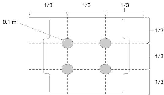
图 149. 导热油脂的正确形状
