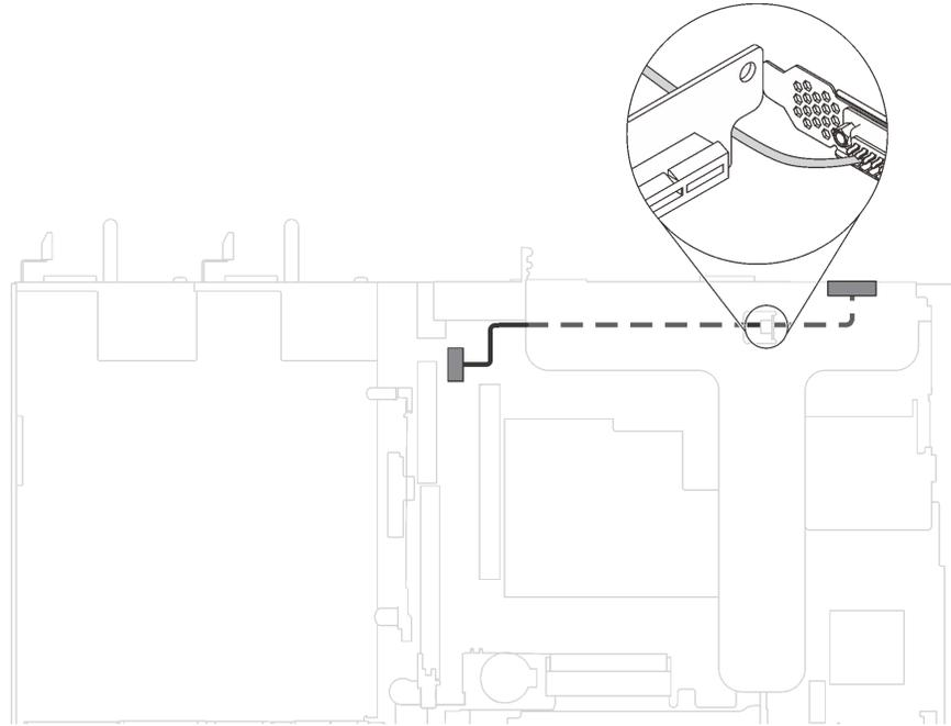
图 115. 安装在 PCIe 插槽 1 中的串口模块的线缆布放
