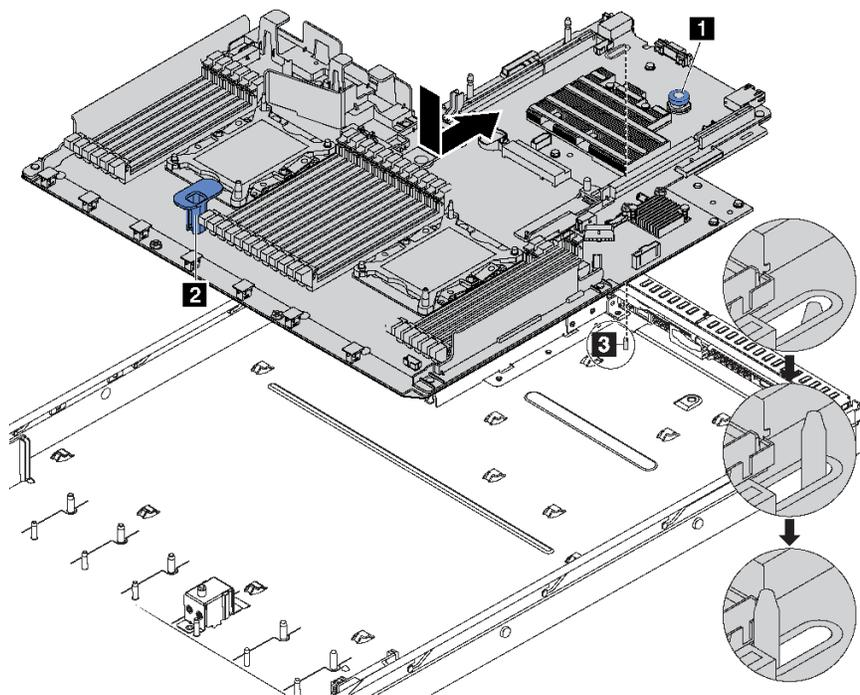
图 153. 安装主板
