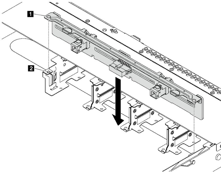
图 92. 安装 8 x 2.5 英寸热插拔硬盘背板
