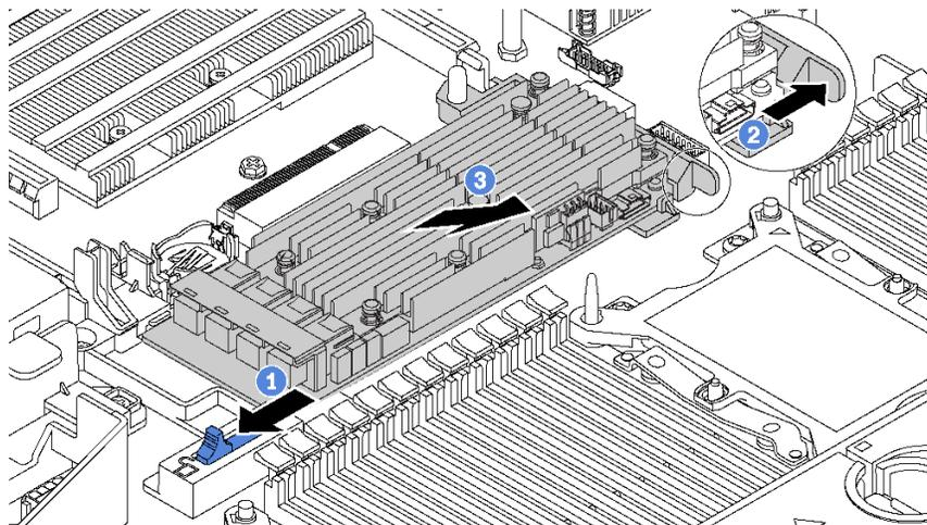
图 109. 卸下 RAID 适配器
