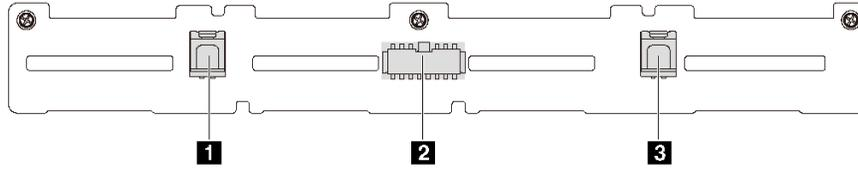
图 28. 用于八个 2.5 英寸 SAS/SATA 硬盘的背板上的接口
