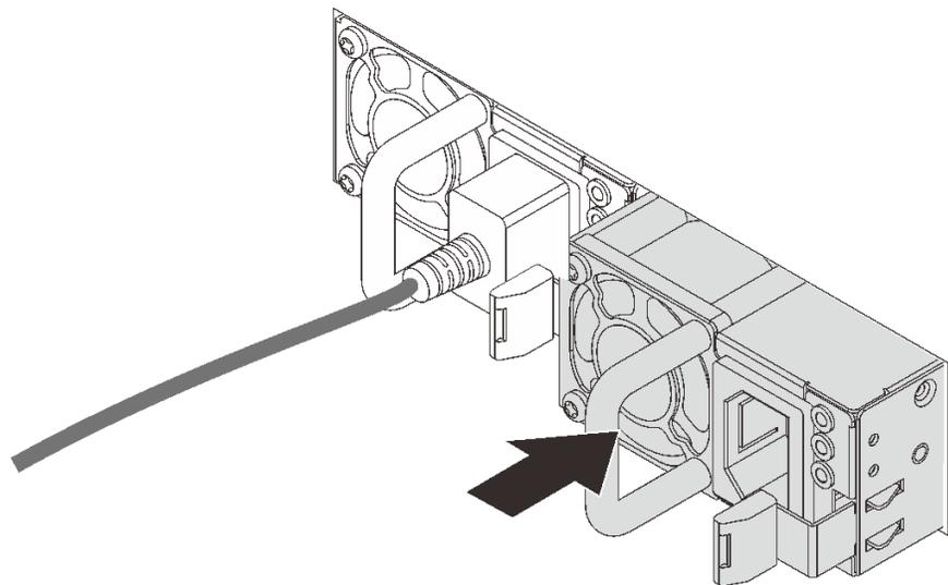
图 144. 安装热插拔电源模块
