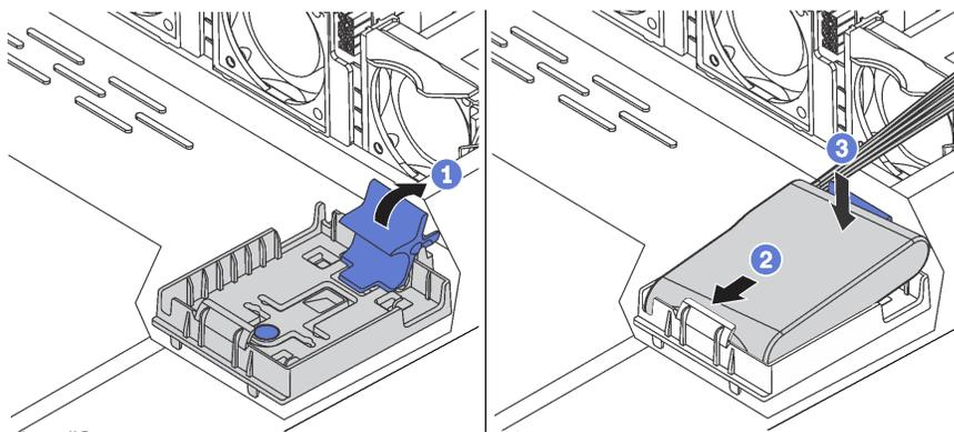
图 131. 将 RAID 超级电容器模块安装到机箱上
