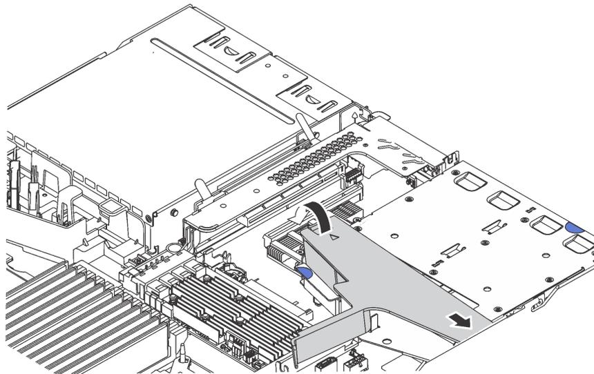
图 99. 安装导风罩
