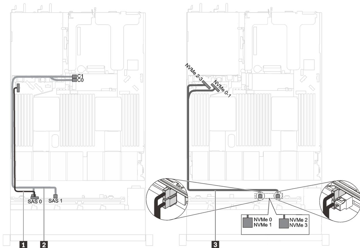
图 34. 配备六个 2.5 英寸 SAS/SATA 硬盘、四个 2.5 英寸 NVMe 硬盘和一个 8i HBA/RAID 适配器的服务器型号的线缆布放
