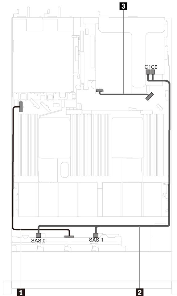
图 31. 装有八个 2.5 英寸 SAS/SATA 硬盘和全高半长型 GPU 的服务器型号的线缆布放
