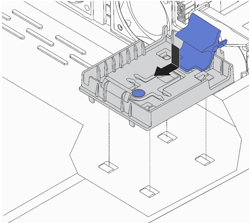
图 130. 安装 RAID 超级电容器模块夹持器
