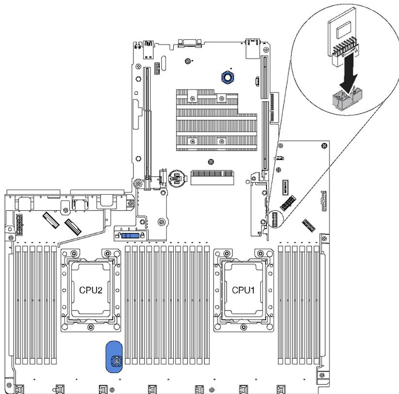
图 103. 安装 TCM/TPM 适配器
