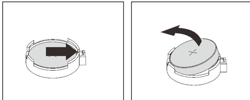
图 100. 卸下 CMOS 电池
