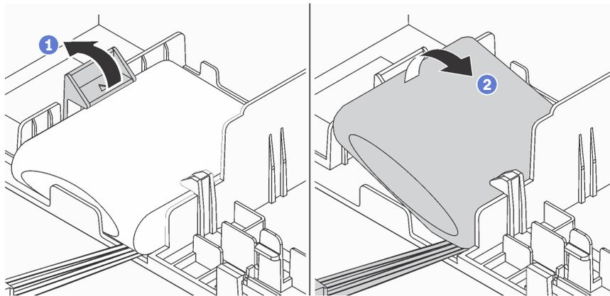
图 123. 在导风罩底部卸下 RAID 超级电容器模块
