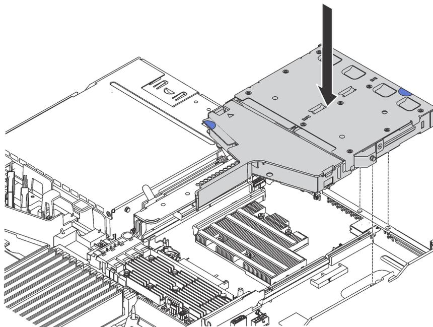
图 108. 安装背面热插拔硬盘组合件
