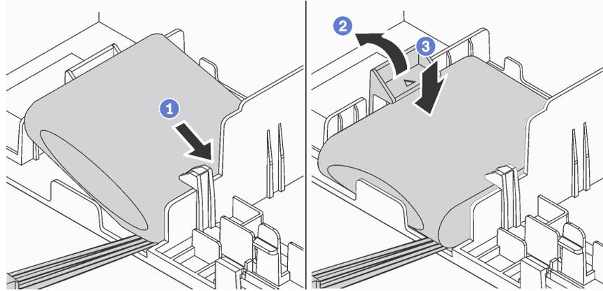
图 125. 在导风罩底部安装 RAID 超级电容器模块
