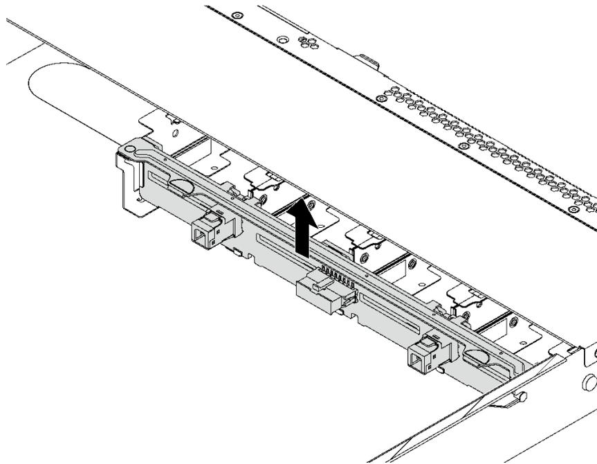
图 91. 卸下 8 x 2.5 英寸热插拔硬盘背板
