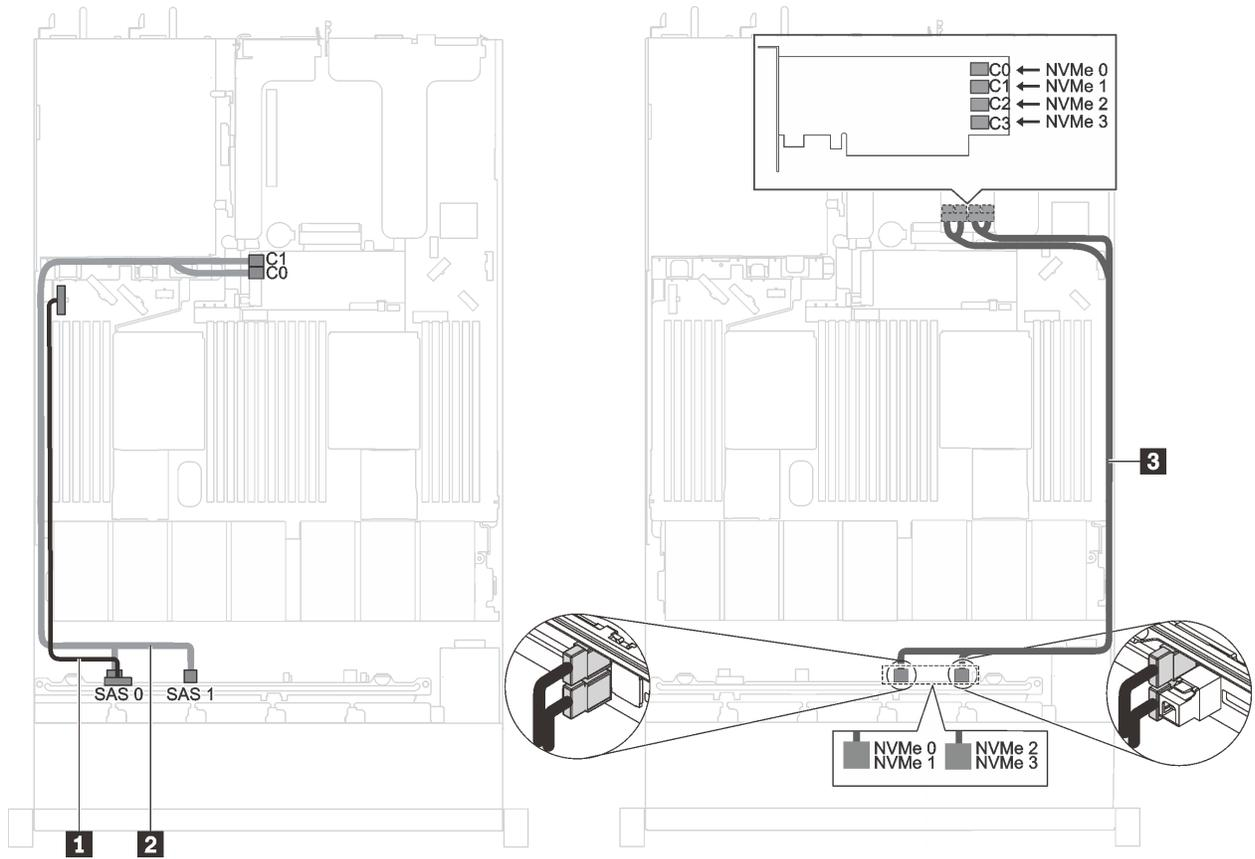
图 36. 配备六个 2.5 英寸 SAS/SATA 硬盘、四个 2.5 英寸 NVMe 硬盘、一个 8i HBA/RAID 适配器和一个 1610-4P NVMe 交换适配器（装入 PCIe 插槽 2 中）的服务器型号的线缆布放
