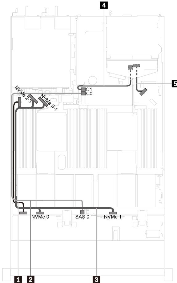
图 25. 装有四个 3.5 英寸 SAS/SATA/NVMe 硬盘和背面硬盘组合件的服务器型号的线缆布放
