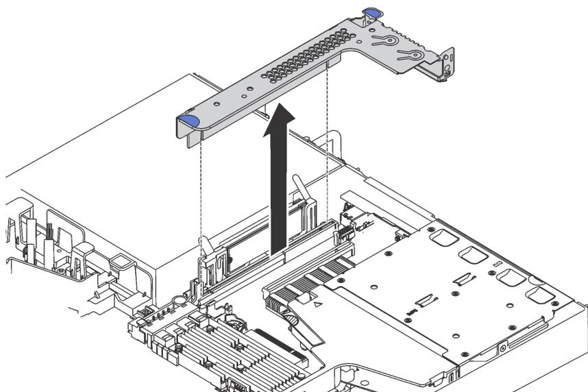
图 111. 卸下转接卡组合件
