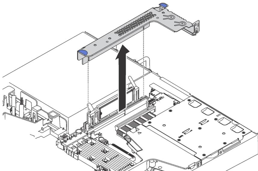
图 113. 卸下转接卡组合件
