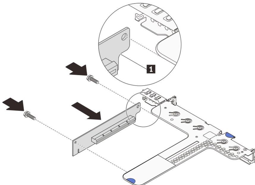
图 80. 安装转接卡
