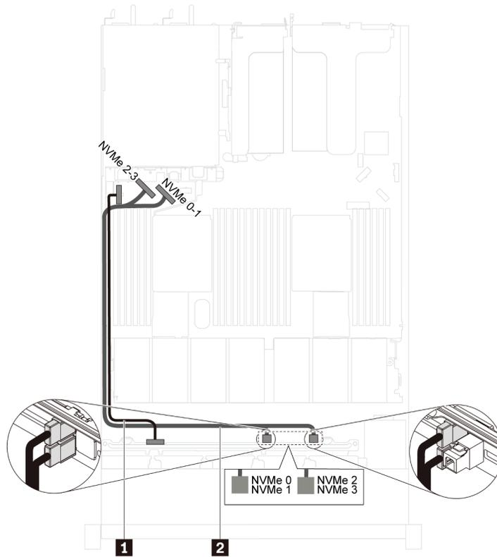
图 39. 配备四个 2.5 英寸 NVMe 硬盘且无 RAID 适配器的服务器型号的线缆布放
