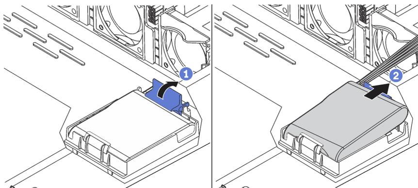
图 126. 卸下机箱上的 RAID 超级电容器模块
