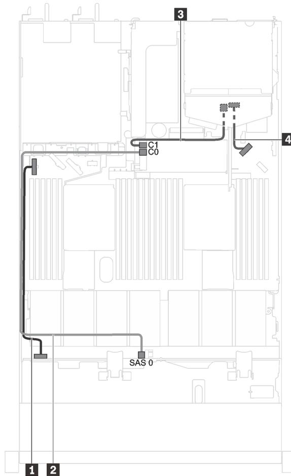
图 22. 配备四个 3.5 英寸 SAS/SATA 硬盘和背面硬盘组合件的服务器型号的线缆布放
