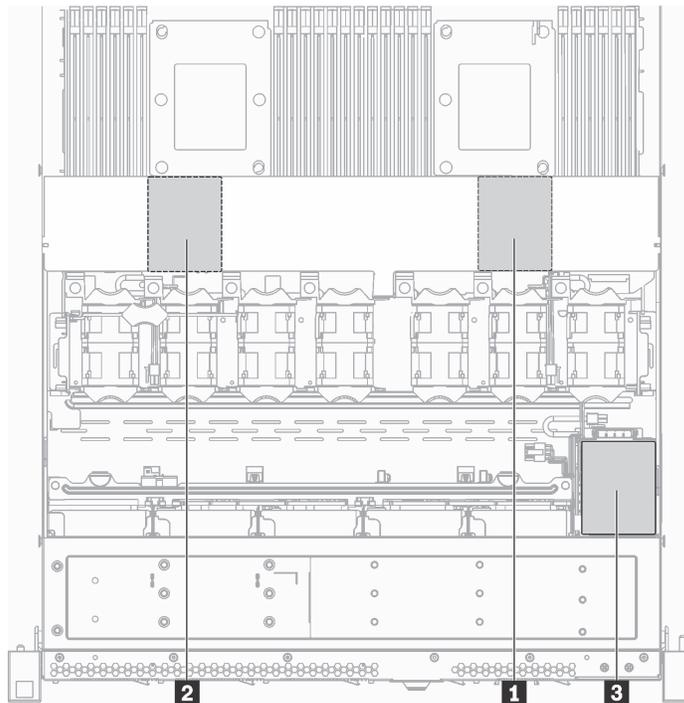
图 124. RAID 超级电容器模块位置
