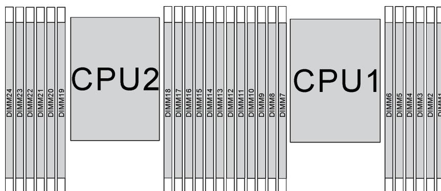
图 66. 主板上的内存条插槽
