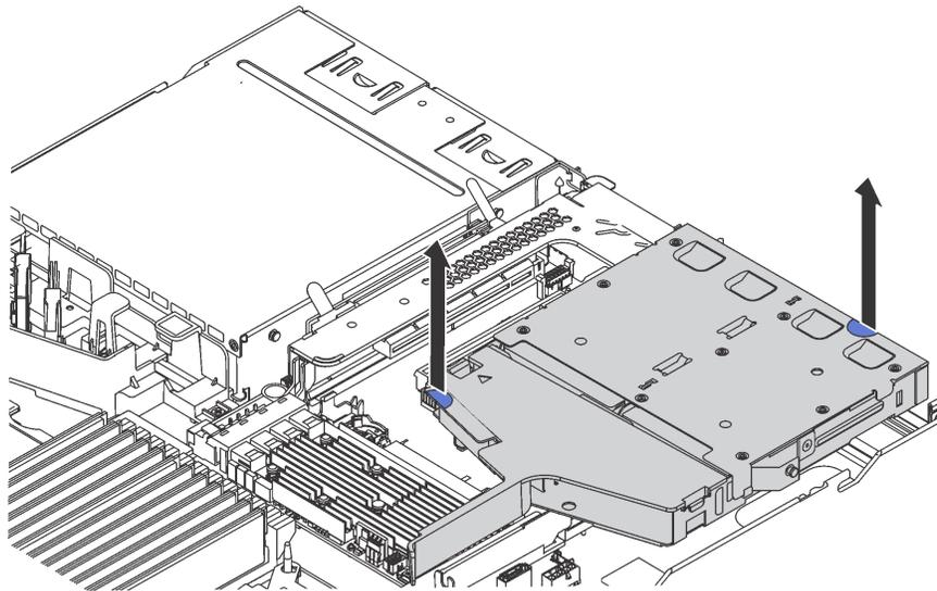
图 104. 卸下背面热插拔硬盘组合件
