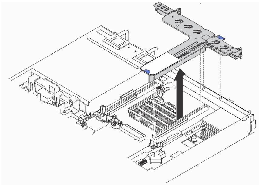
图 78. 卸下转接卡组合件
