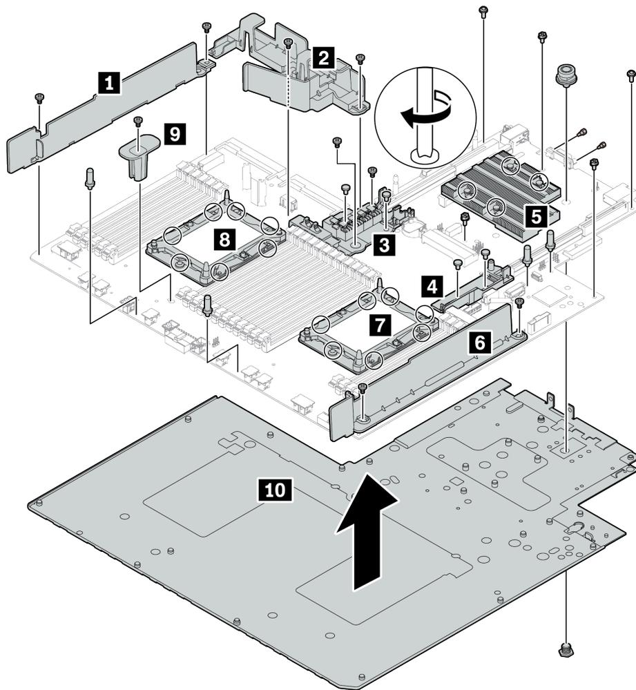
图 156. 拆卸主板
