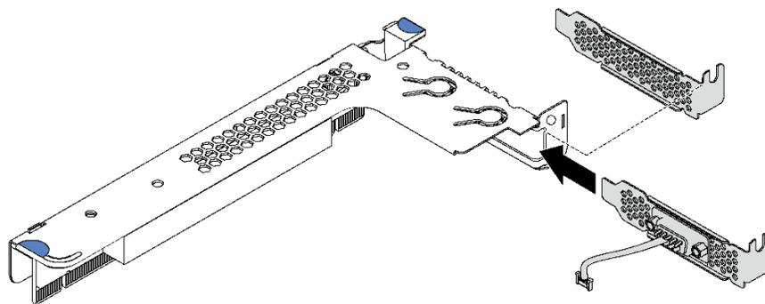
图 114. 安装串口模块
