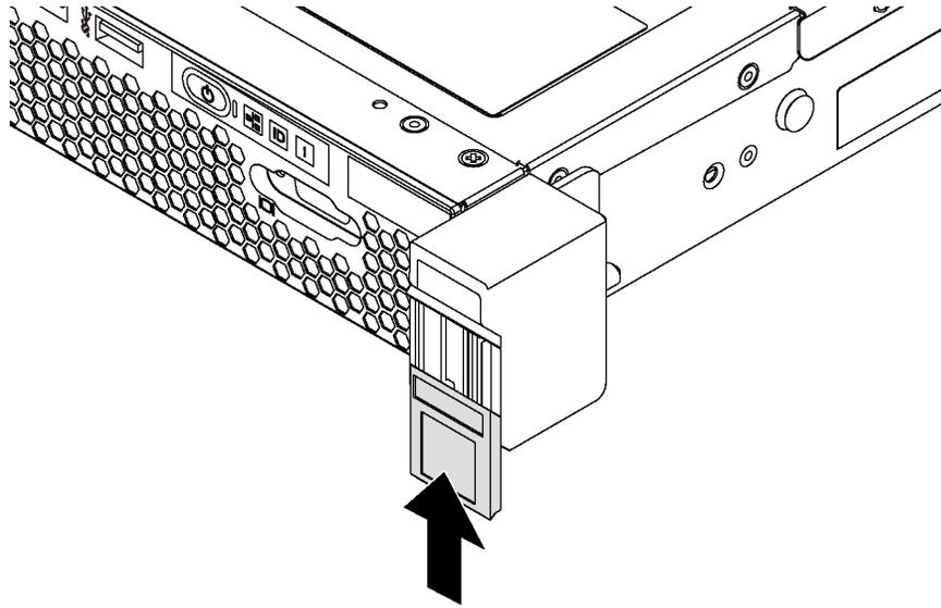
图 57. 安装标识标签板
