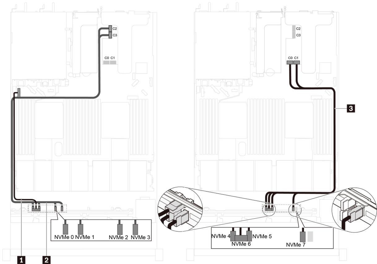
图 46. 配备八个 2.5 英寸 NVMe 硬盘并在 PCIe 插槽 2 中装有一个 NVMe 1611-8P 交换适配器的服务器型号的线缆布放
