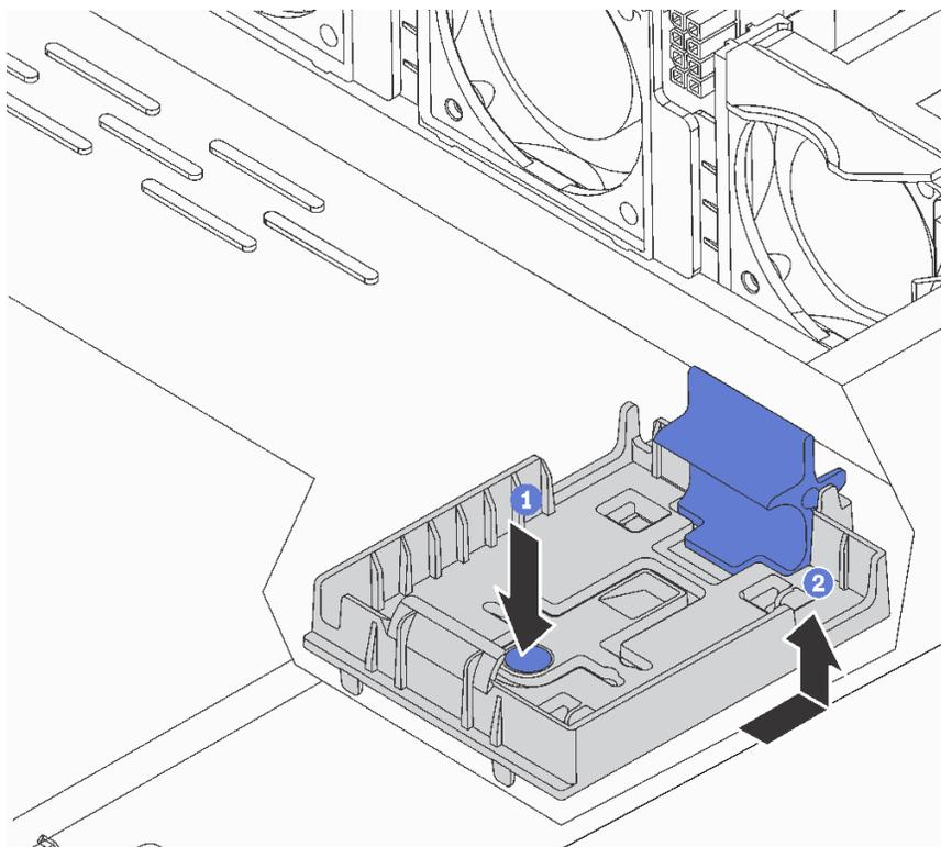
图 127. 卸下 RAID 超级电容器模块夹持器
