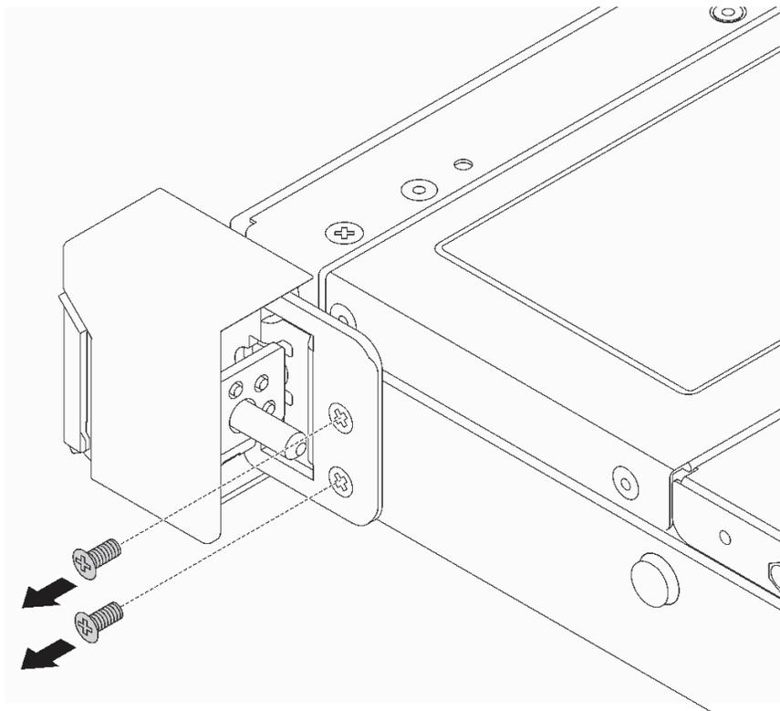
图 53. 卸下机架滑锁螺钉
