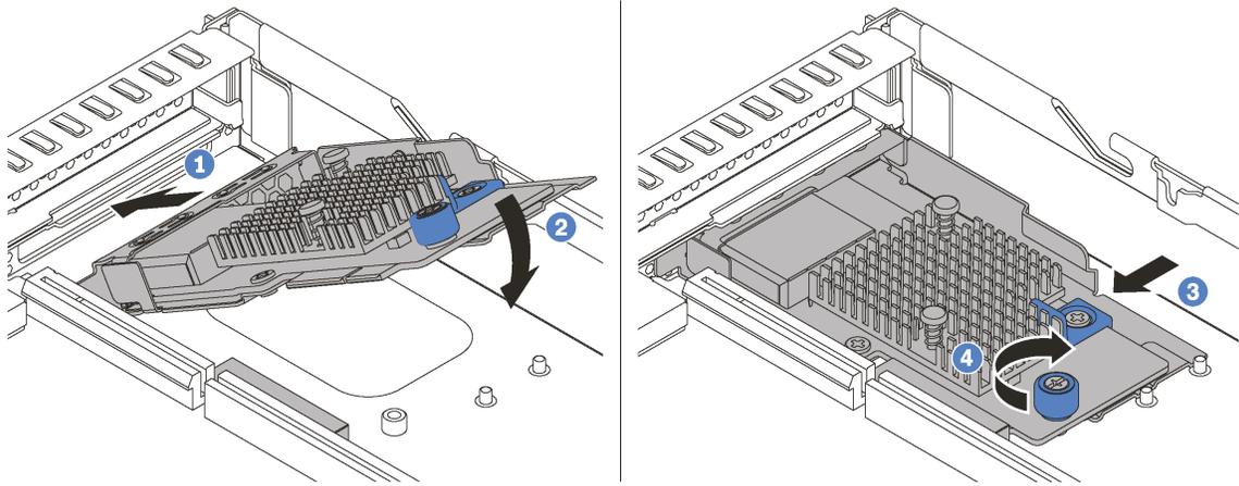
图 74. 安装 LOM 适配器
