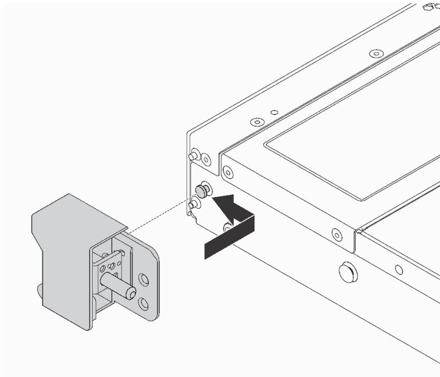
图 55. 安装机架滑锁
