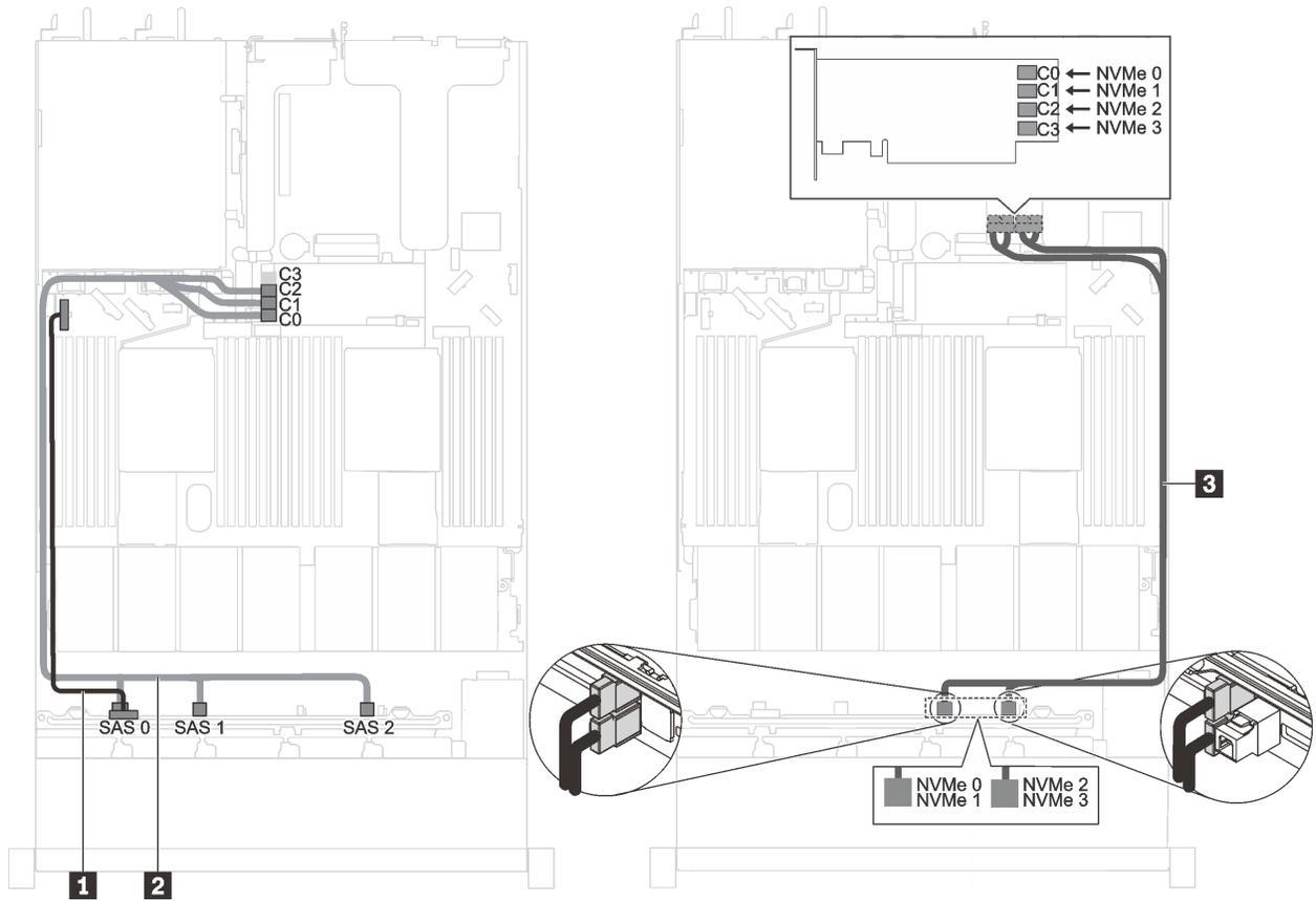
图 38. 配备六个 2.5 英寸 SAS/SATA 硬盘、四个 2.5 英寸 NVMe 硬盘、一个 16i HBA/RAID 适配器和一个 1610-4P NVMe 交换适配器（装入 PCIe 插槽 2 中）的服务器型号的线缆布放
