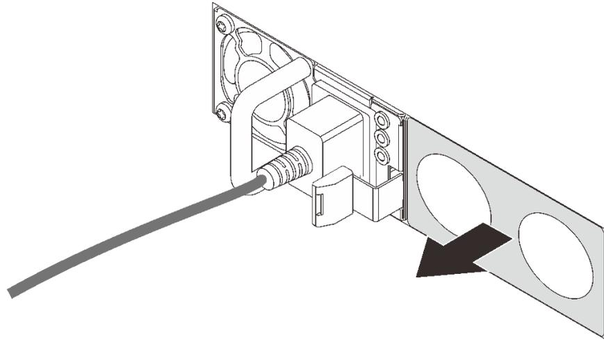
图 143. 卸下热插拔电源模块填充件
