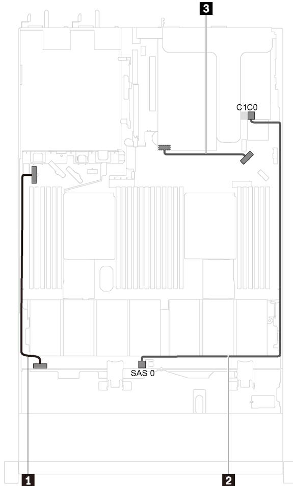
图 23. 装有四个 3.5 英寸 SAS/SATA 硬盘和全高半长型 GPU 的服务器型号的线缆布放
