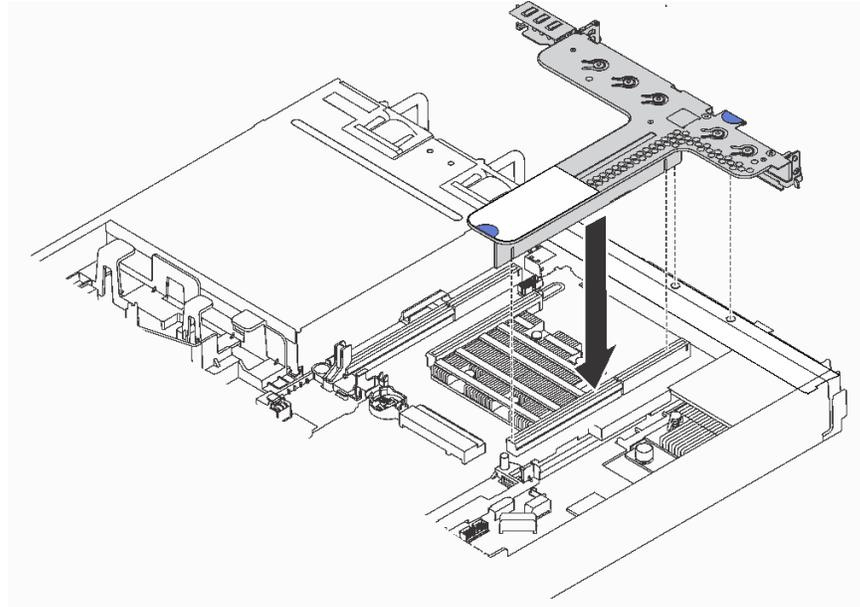
图 81. 安装转接卡组合件
