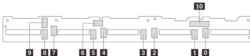
图 40. 用于十个 2.5 英寸 NVMe 硬盘的背板上的接口
