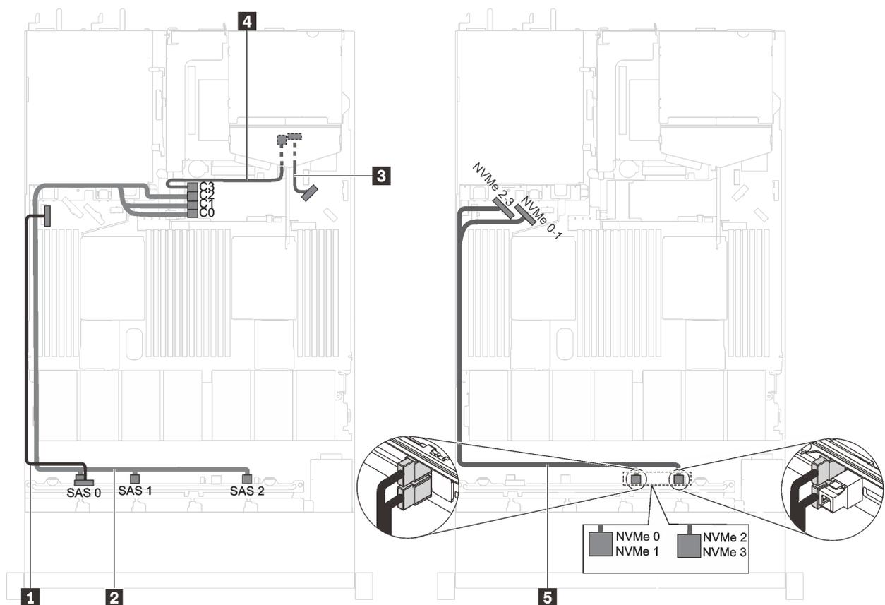
图 33. 配备六个 2.5 英寸 SAS/SATA 硬盘、四个 2.5 英寸 SAS/SATA/NVMe 硬盘、一个 16i HBA/RAID 适配器和背面硬盘组合件的服务器型号的线缆布放
