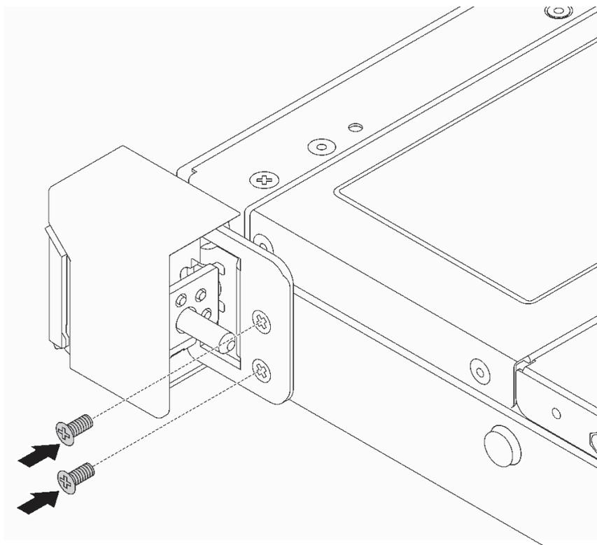
图 56. 安装机架滑锁螺钉
