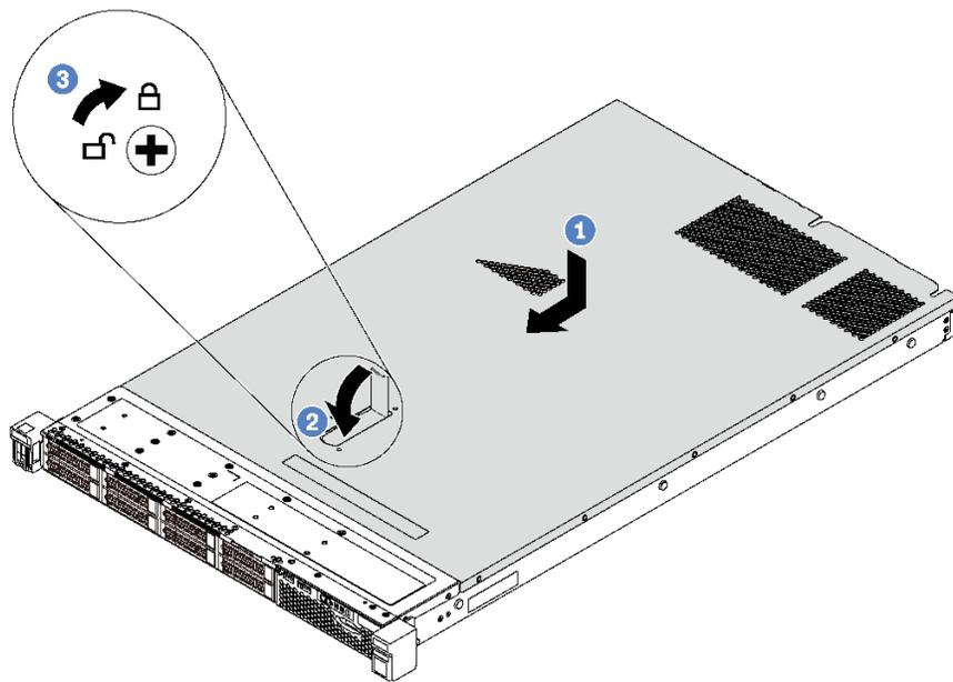
图 49. 安装顶盖
