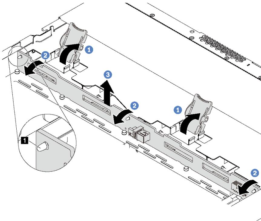
图 89. 卸下 4 x 3.5 英寸热插拔硬盘背板
