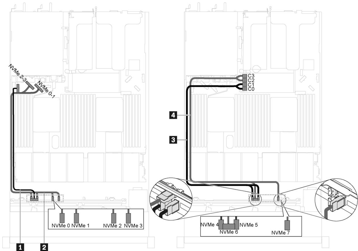
图 44. 装有八个 2.5 英寸 NVMe 硬盘并在 RAID 适配器插槽中装有一个 810 4 P NVMe 交换适配器的服务器型号的线缆布放
