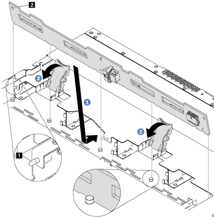
图 90. 安装 4 x 3.5 英寸热插拔硬盘背板
