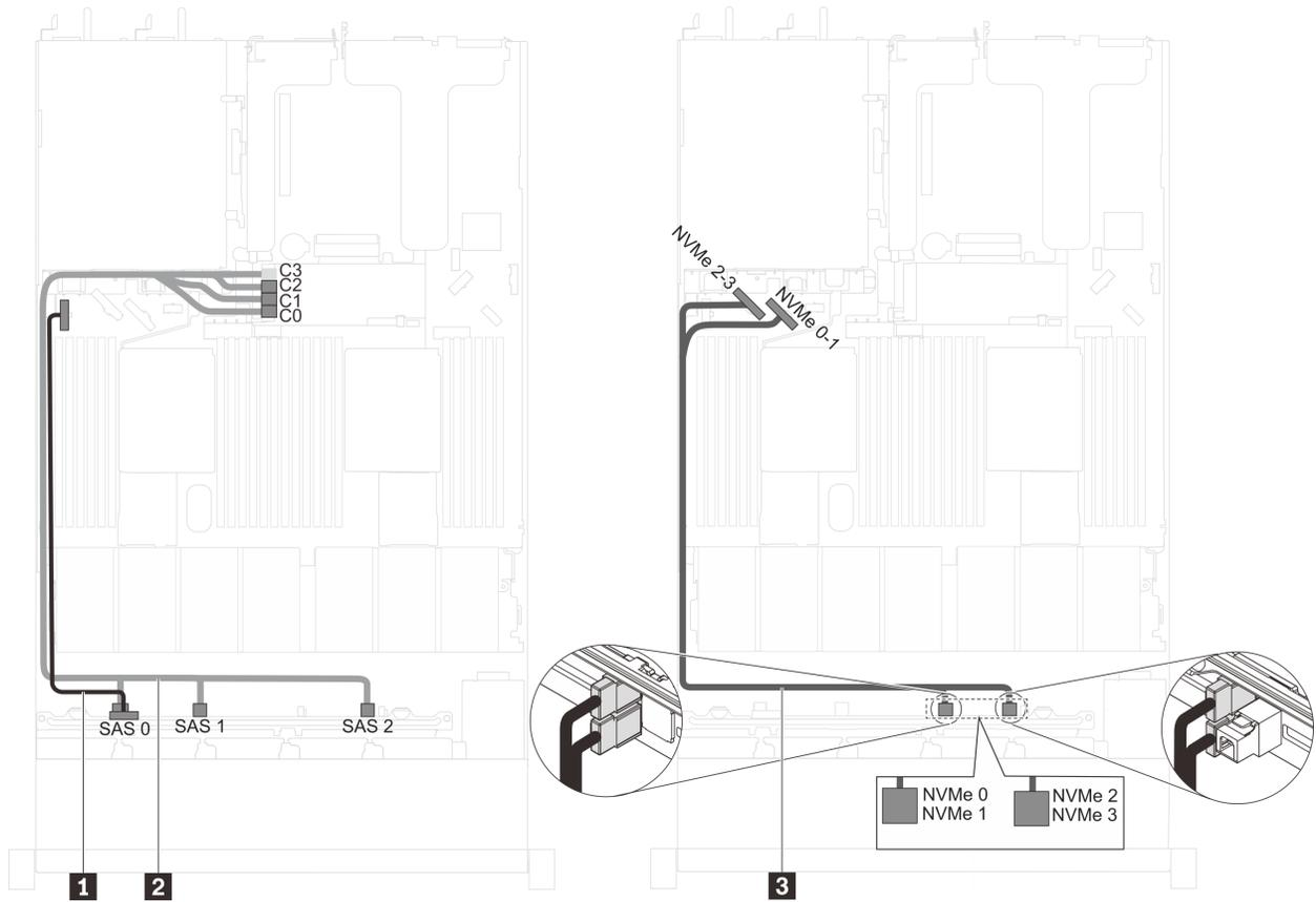
图 37. 配备 Intel Xeon 6154/6254/6240Y 处理器、四个 2.5 英寸 SAS/SATA/NVMe 硬盘和一个 16i HBA/RAID 适配器的服务器型号的线缆布放
