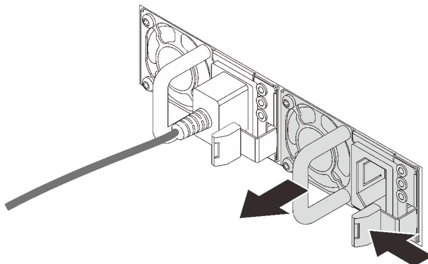
图 140. 卸下热插拔电源模块
