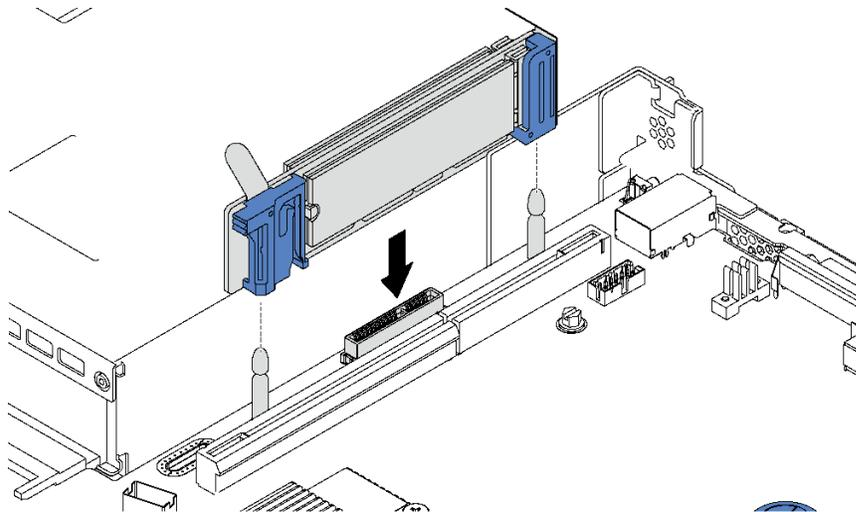
图 122. 安装 M.2 背板
