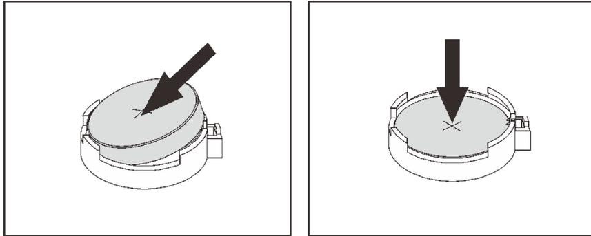
图 101. 安装 CMOS 电池
