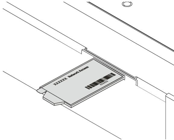
图 2. XClarity Controller 网络访问标签的位置
