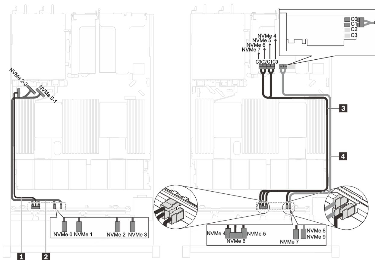
图 41. 装有十个 2.5 英寸 NVMe 硬盘、在 PCIe 插槽 2 中装有一个 1610-4P NVMe 交换适配器并在 PCIe 插槽 3 中装有一个 1610-4P NVMe 交换适配器的服务器型号的线缆布放
