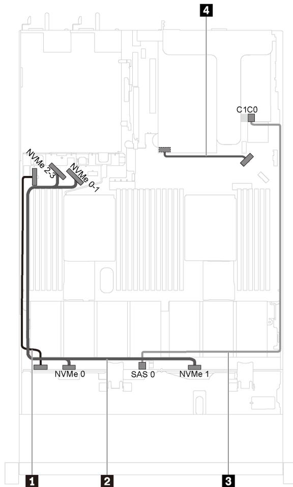
图 26. 装有四个 3.5 英寸 SAS /SATA/NVMe 硬盘和全高半长型 GPU 的服务器型号的线缆布放
