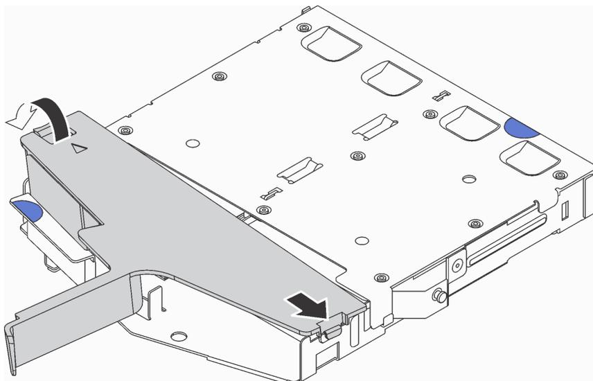
图 107. 安装导风罩
