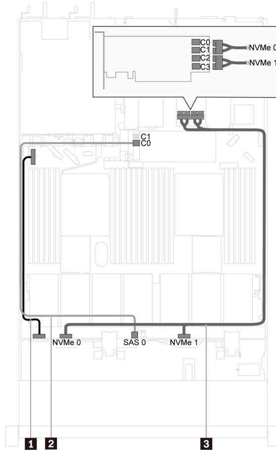
图 27. 配备四个 3.5 英寸 SAS/SATA/NVMe 硬盘和一个 1610-4P NVMe 交换适配器 (PCIe 插槽 2 中) 的服务器型号的线缆布放
