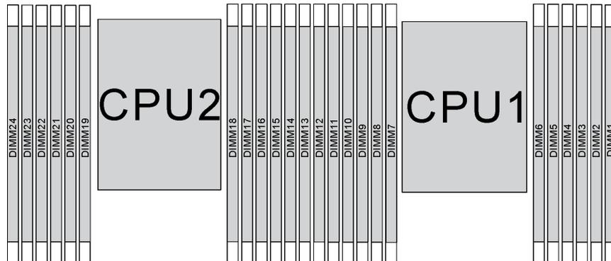
图 67. 主板上的内存条插槽
