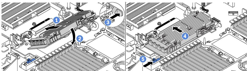
图 110. 安装 RAID 适配器
