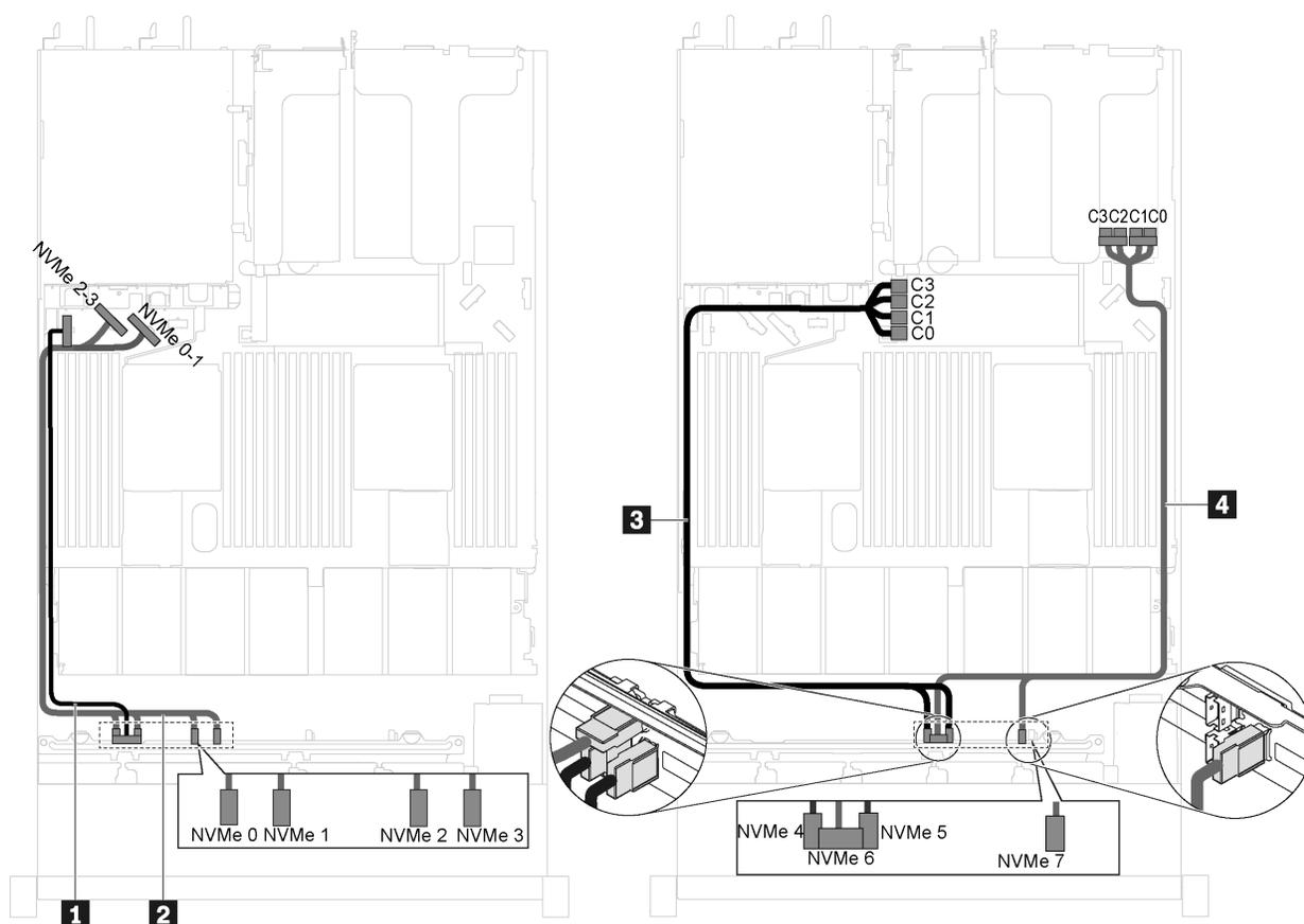
图 45. 装有八个 2.5 英寸 NVMe 硬盘、在 PCIe 插槽 1 中装有一个 810-4P NVMe 交换适配器并在 RAID 适配器插槽中装有一个 810-4P NVMe 交换适配器的服务器型号的线缆布放
