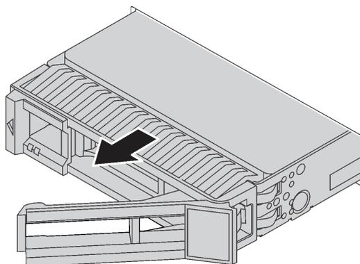
图 70. 卸下热插拔硬盘
