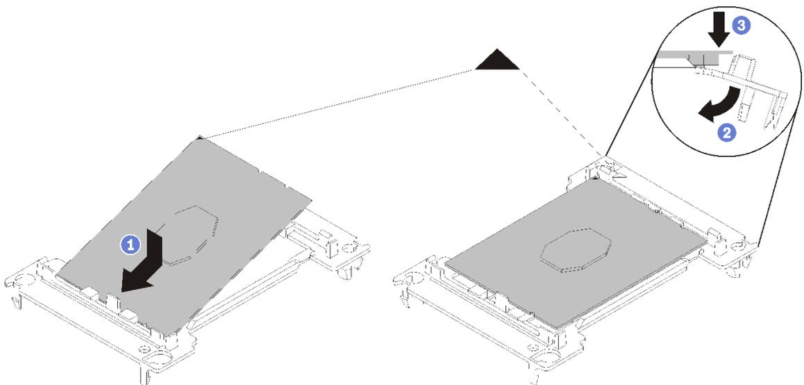
图 148. 安装处理器固定器
