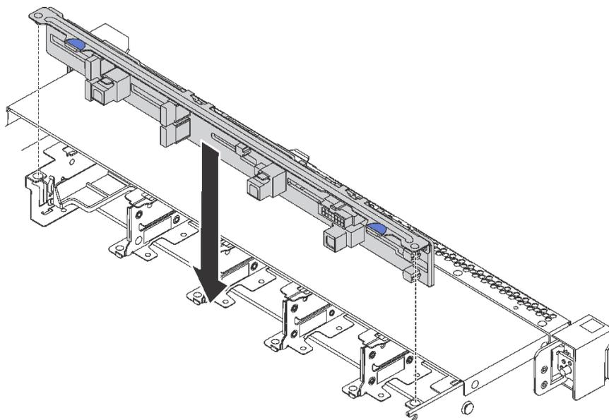
图 94. 安装 10 x 2.5 英寸热插拔硬盘背板
