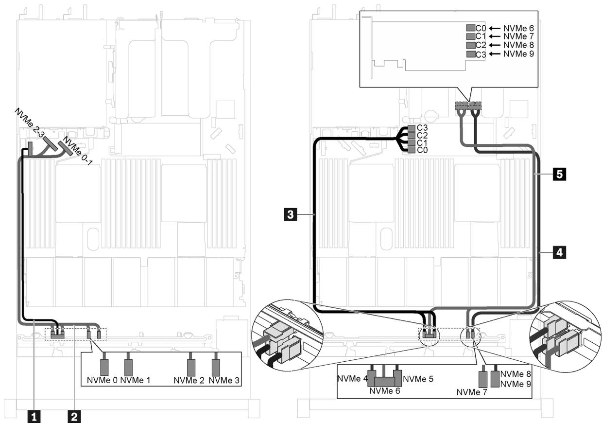
图 42. 装有十个 2.5 英寸 NVMe 硬盘、在 PCIe 插槽 2 中装有一个 1610-4P NVMe 交换适配器并在 RAID 适配器插槽中装有一个 810-4P NVMe 交换适配器的服务器型号的线缆布放
