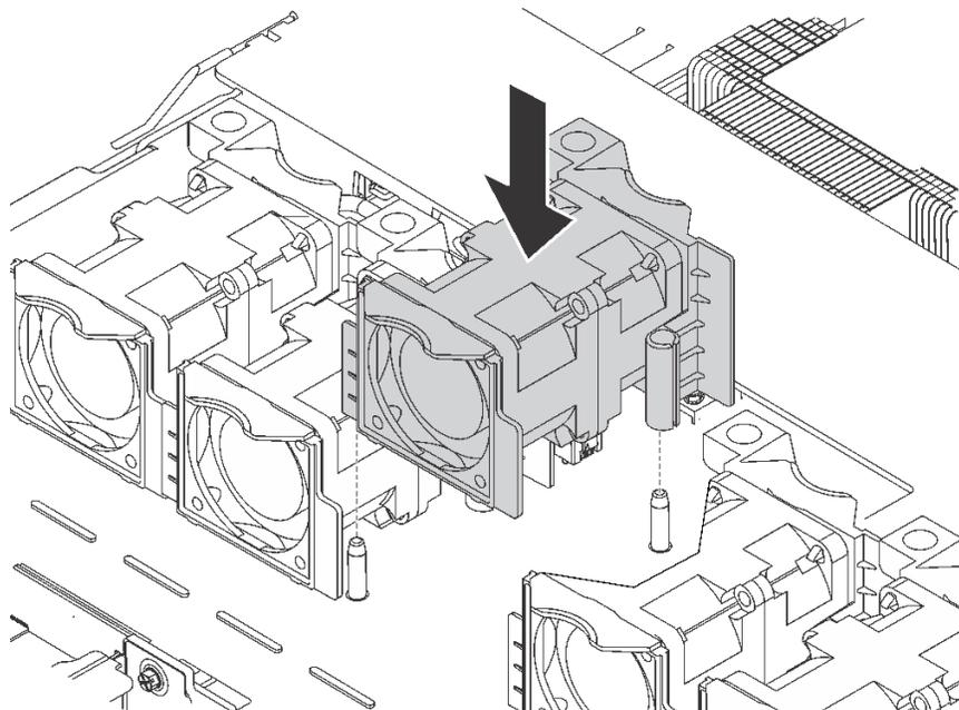
图 64. 安装系统风扇
