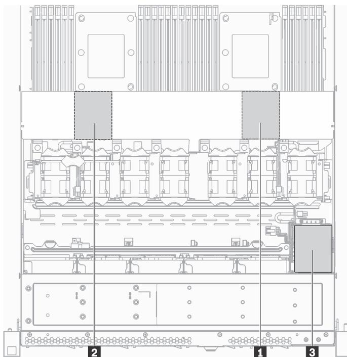
图 128. RAID 超级电容器模块位置
