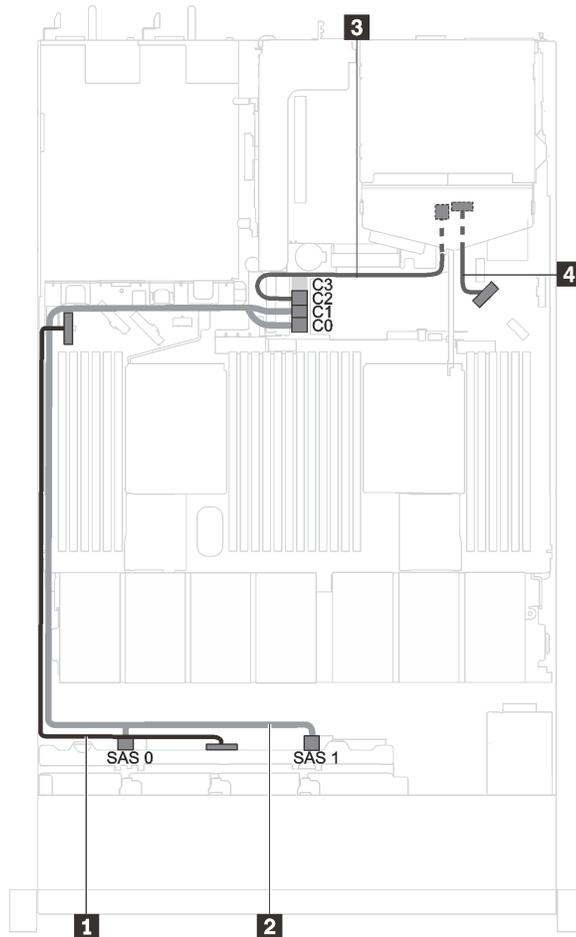
图 30. 配备八个 2.5 英寸 SAS/SATA 硬盘、一个 16i HBA/RAID 适配器和背面硬盘组合件的服务器型号线缆布放
