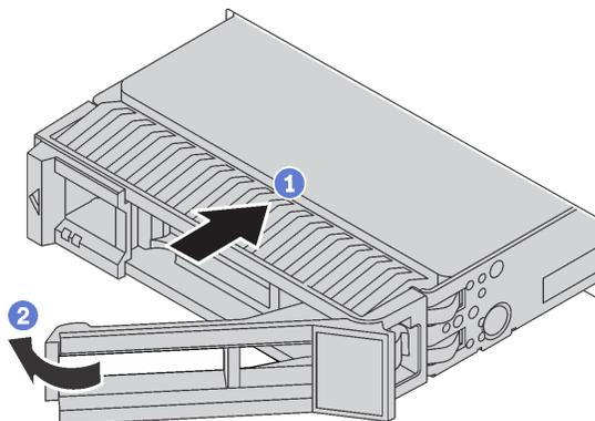
图 72. 安装热插拔硬盘
