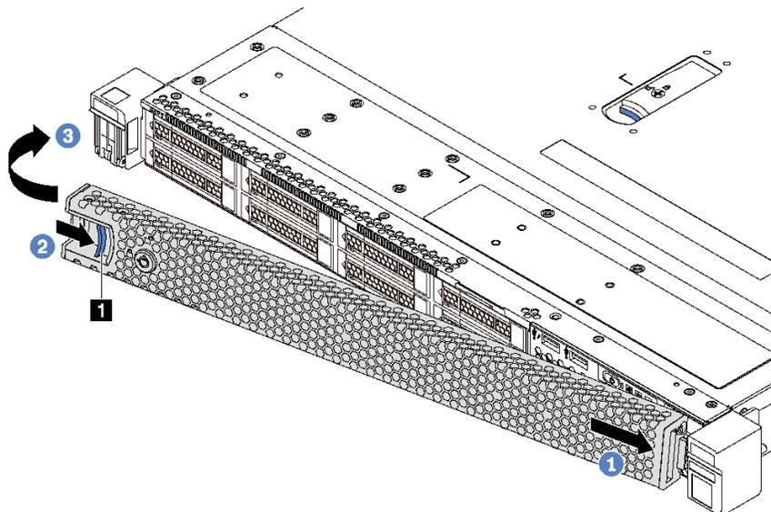
图 61. 安装安全挡板
