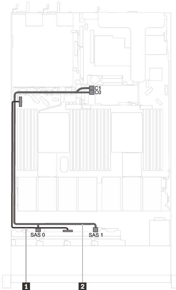
图 29. 配备八个 2.5 英寸 SAS/SATA 硬盘和一个 8i HBA/RAID 适配器的服务器型号的线缆布放
