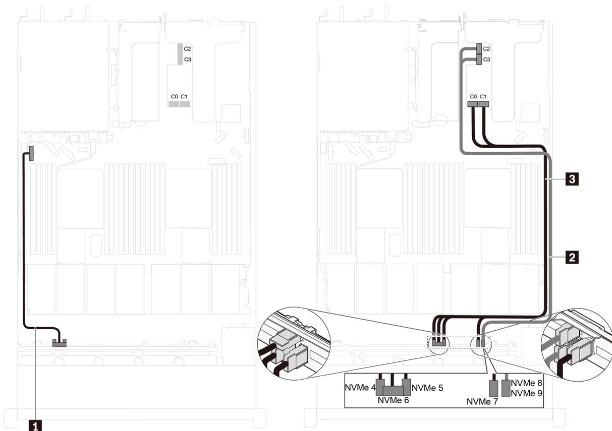
图 43. 配备十个 2.5 英寸 NVMe 硬盘并在 PCIe 插槽 2 中装有一个 NVMe 1611-8P 交换适配器的服务器型号的线缆布放
