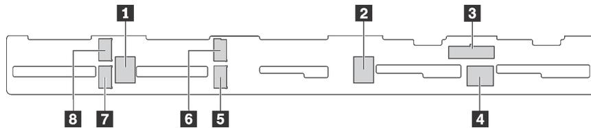
图 32. 用于十个 2.5 英寸 SAS/SATA/NVMe 硬盘的背板上的接口
