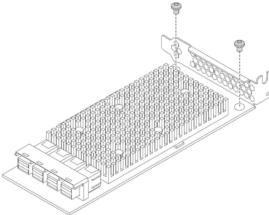
图 88. 将半高型支架安装到 RAID 适配器上
