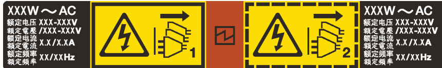
图 55. 外盖上的热插拔电源模块标签
