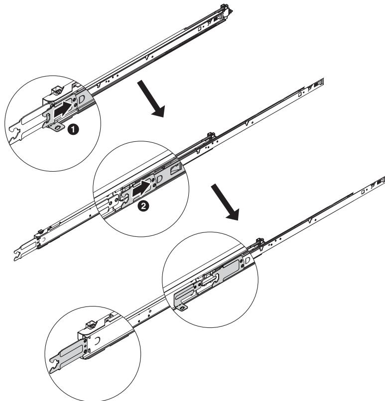
2. 使用 T8 Torx 螺絲起子，從導軌卸下 CMA 裝載托架。
