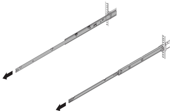
図 55. レールの引き出し
