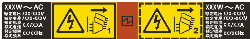
รูปภาพ 74. ป้ายแหล่งจ่ายไฟแบบ Hot-swap บนฝาครอบ
