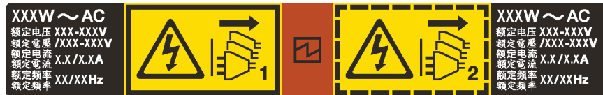
圖例 165. 蓋板上的熱抽換電源供應器標籤
