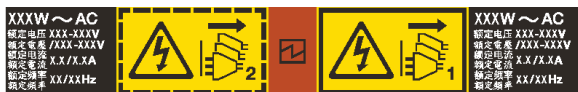
図 189. トップ・カバー上のパワー・サプライ・ユニット・ラベルの例
