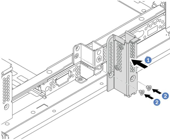
그림 310. B1 뒷면 벽 브래킷 설치(중간)
