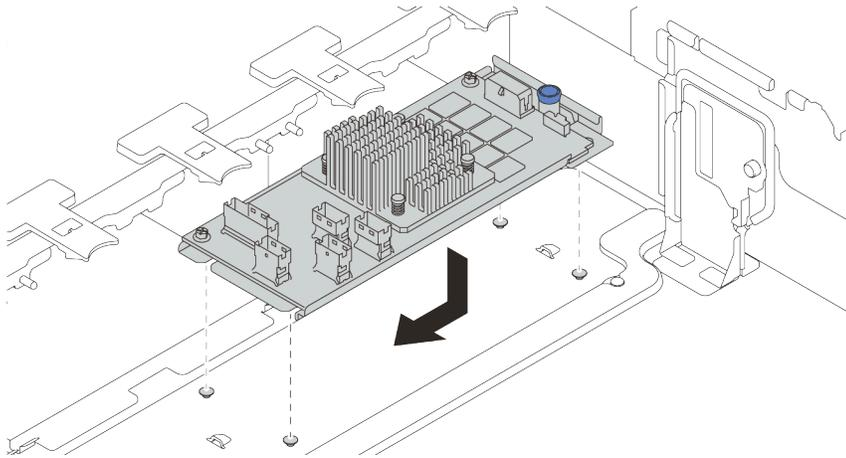
그림 235. 내부 CFF 어댑터 설치
