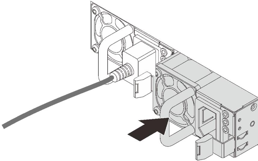
**그림 273. 핫 스왑 전원 공급 장치 설치**
