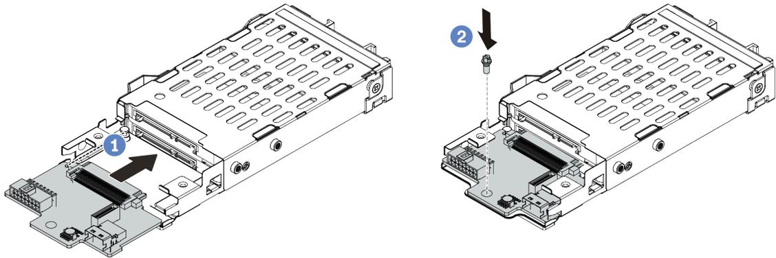
그림 334. 7mm 드라이브 백플레인 설치(하단)
