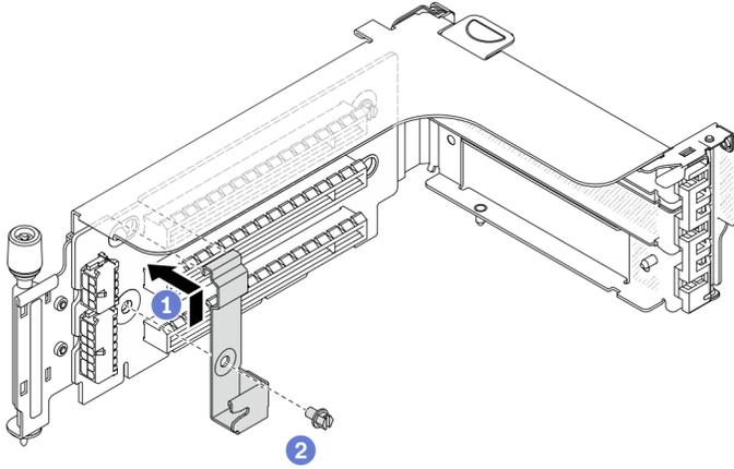
**그림 336. 7mm 드라이브 케이지 고정 클립 설치**
