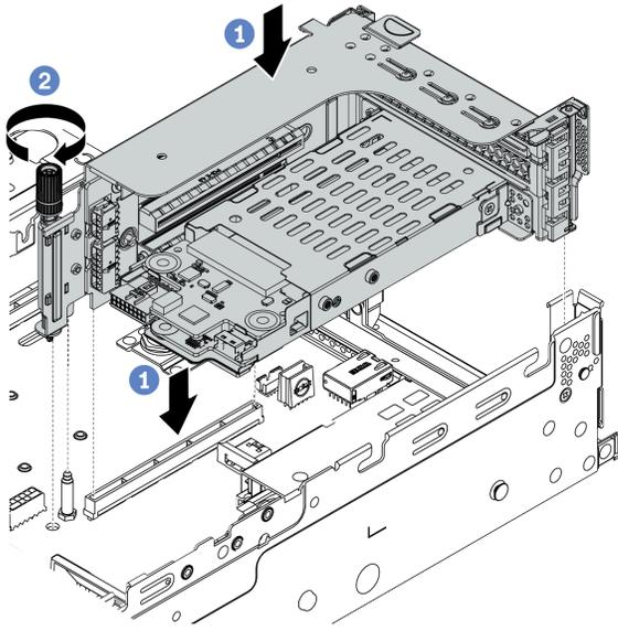
**그림 338. 라이저 어셈블리 설치**
