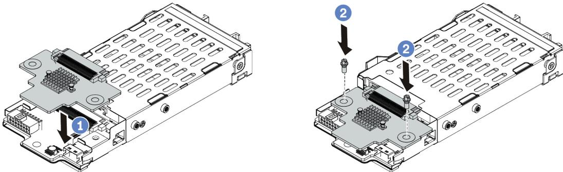
**그림 335. 7mm 드라이브 백플레인 설치(상단)**
