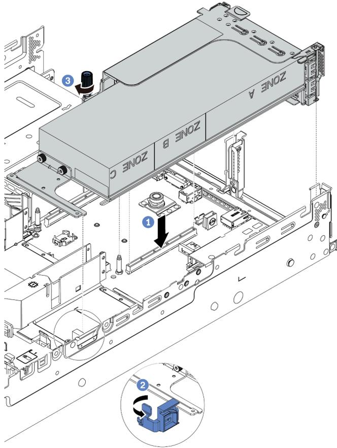
**그림 223. 라이저 어셈블리 설치**
