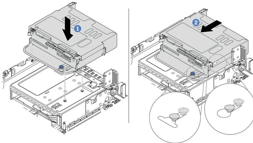
그림 318. 4 x 2.5인치 드라이브 후면 케이스 설치
