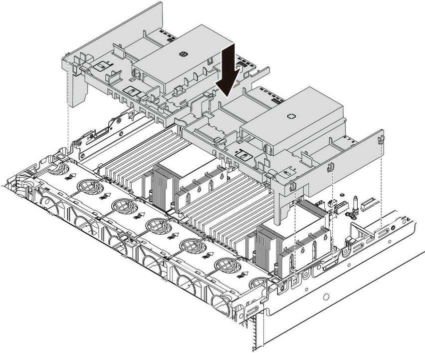
그림 199. 표준 공기 배플 설치
