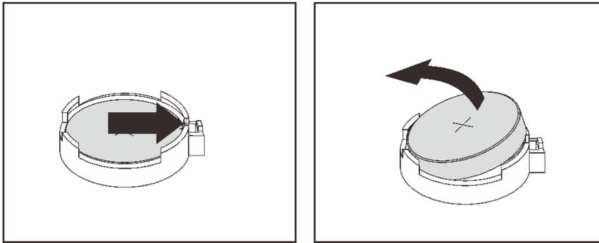
**그림 202. CMOS 배터리 제거**
