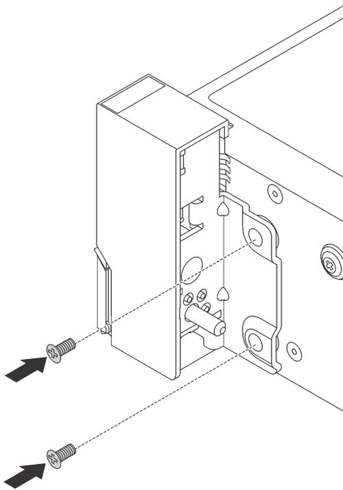
**그림 291. 나사 설치**
