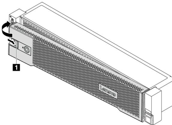
그림 344. 보안 베젤 설치
