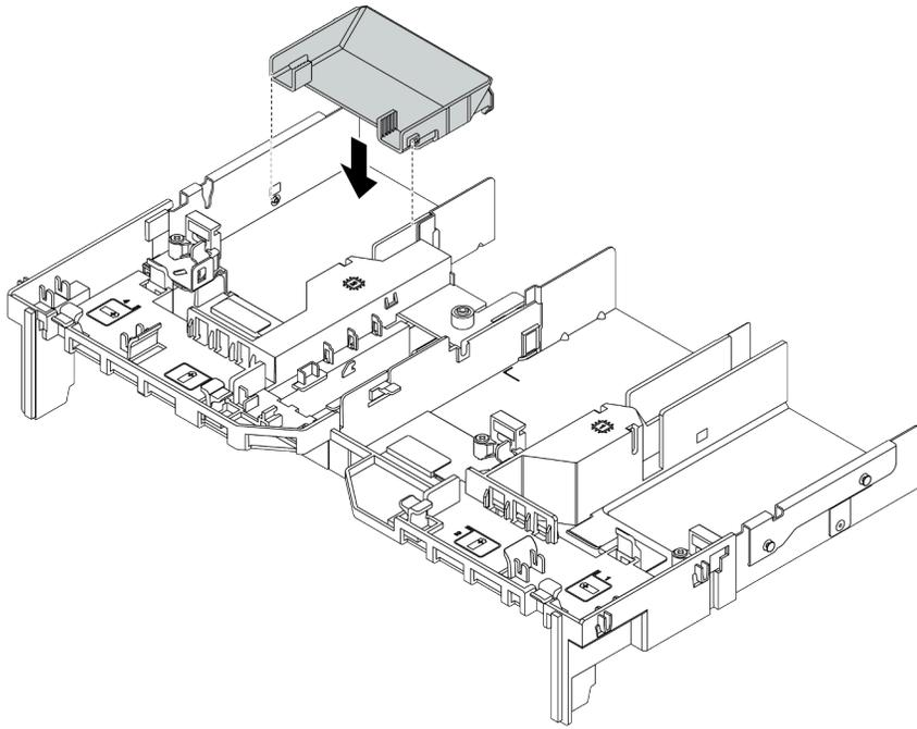
**그림 222. 추가 공기 조절 장치 설치**
