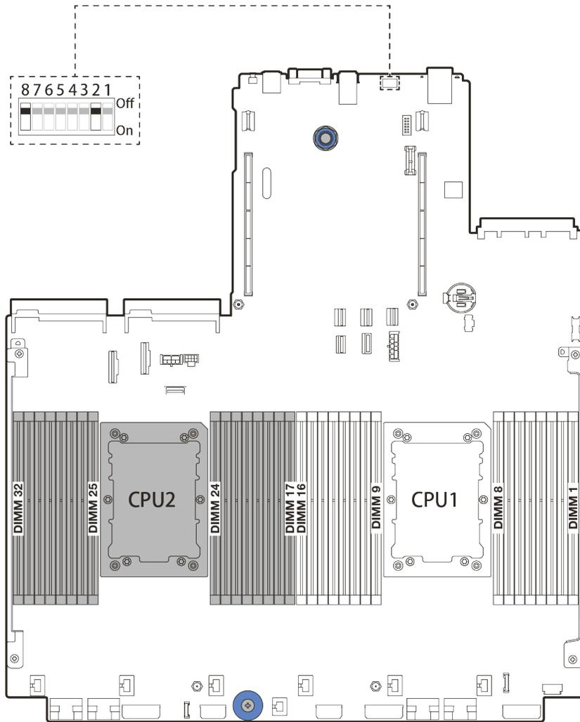
그림 13. 시스템 보드의 SW8 스위치 블록
