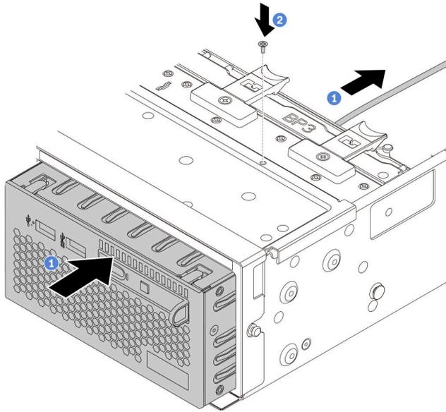
그림 214. 앞면 I/O 모듈 설치
