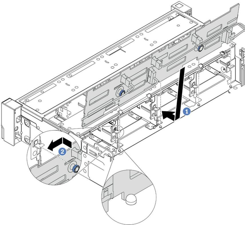
그림 208. 3.5인치 드라이브 백플레인 설치
