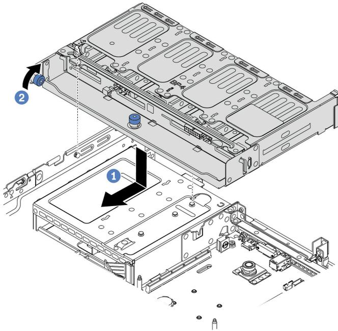
**그림 319. 8 x 2.5인치 드라이브 후면 케이스 설치**
