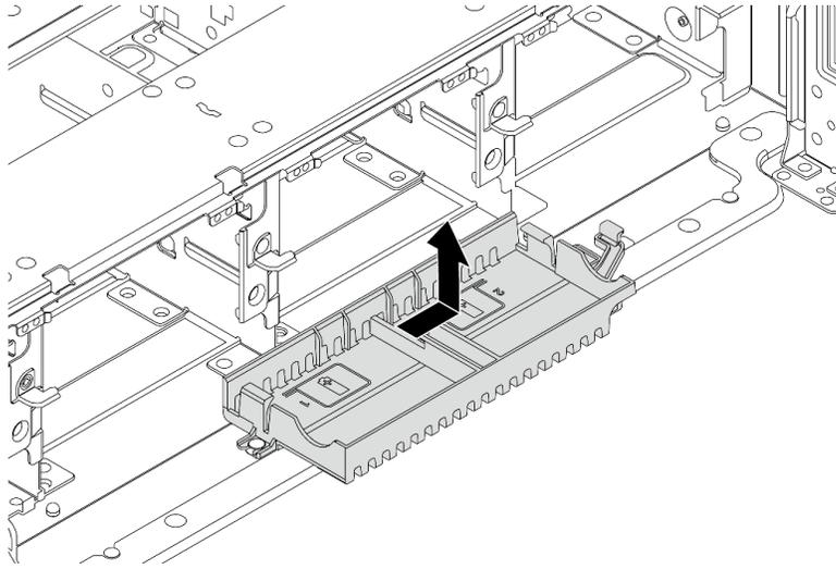
**그림 298. Supercap Holder 제거**
