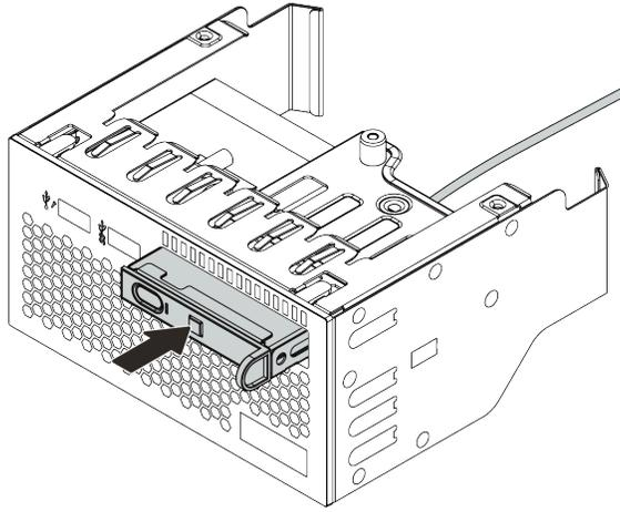
**그림 215. 내장형 진단 패널 설치**
