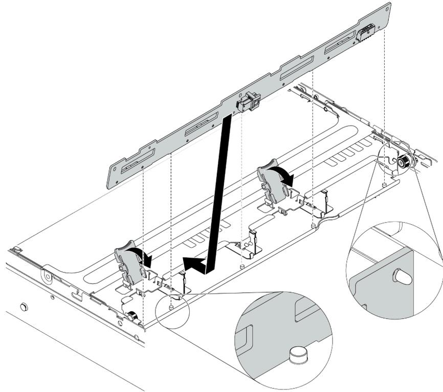
**그림 256. 3.5인치 중간 드라이브 백플레인 설치**
