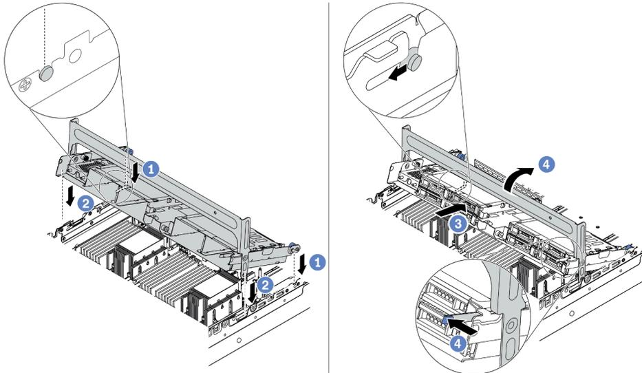
그림 257. 중간 드라이브 케이스 및 드라이브 설치
