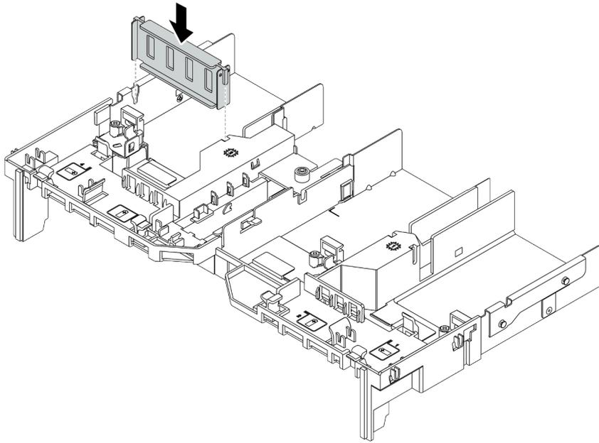
**그림 224. GPU 공기 조절 장치 필터 설치**
