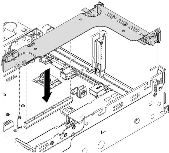
**그림 358. 라이저 어셈블리 설치**
