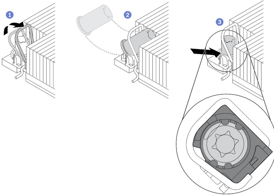
**그림 226. 방열판에 Torx T30 너트 설치**
