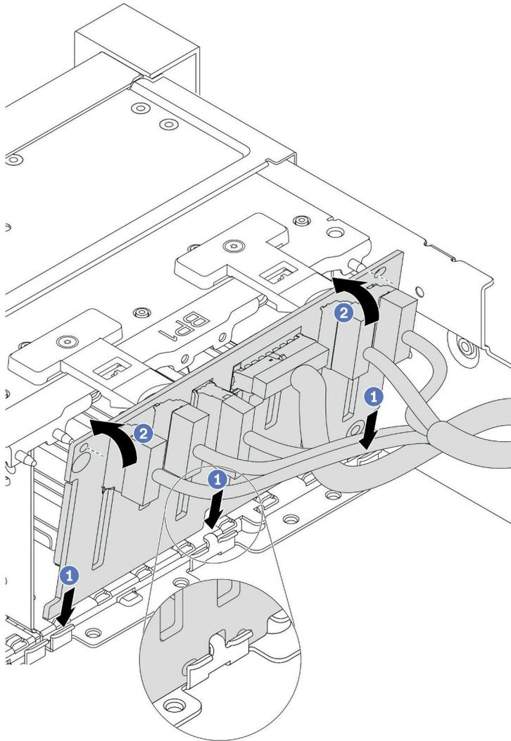
**그림 206. 2.5인치 드라이브 백플레인 설치**
