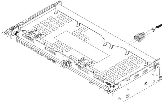
**그림 328. 상단 덮개 지원 브라켓 설치**
