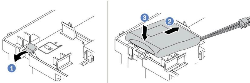
그림 302. RAID 플래시 전원 모듈 (공기 조절 장치에) 설치
