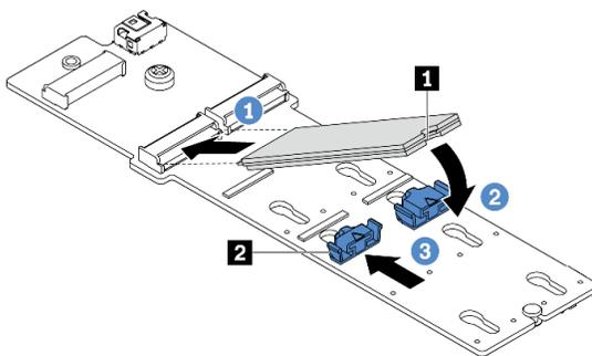
그림 245. M.2 드라이브 설치
