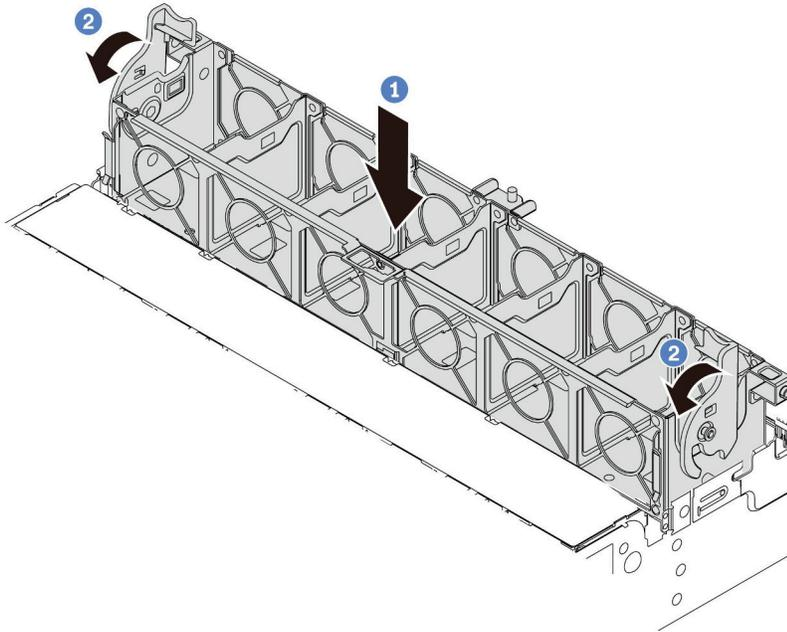
그림 351. 시스템 팬 케이스 설치
