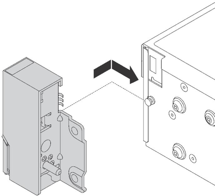
**그림 290. 랙 래치 설치**
