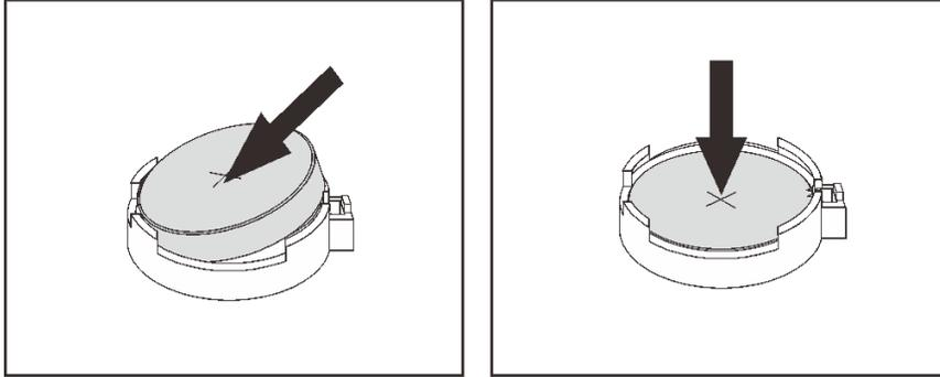
그림 203. CMOS 배터리 설치
