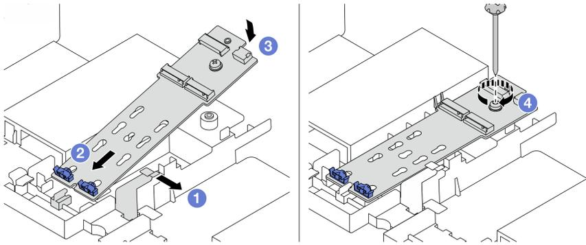
그림 247. M.2 백플레인 설치
