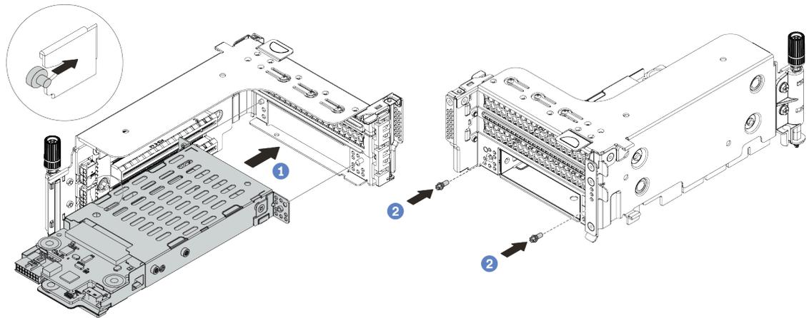
**그림 337. 7mm 드라이브 케이지 설치**
