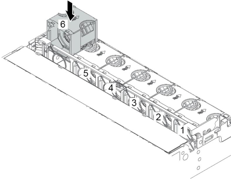
그림 349. 시스템 팬 설치
