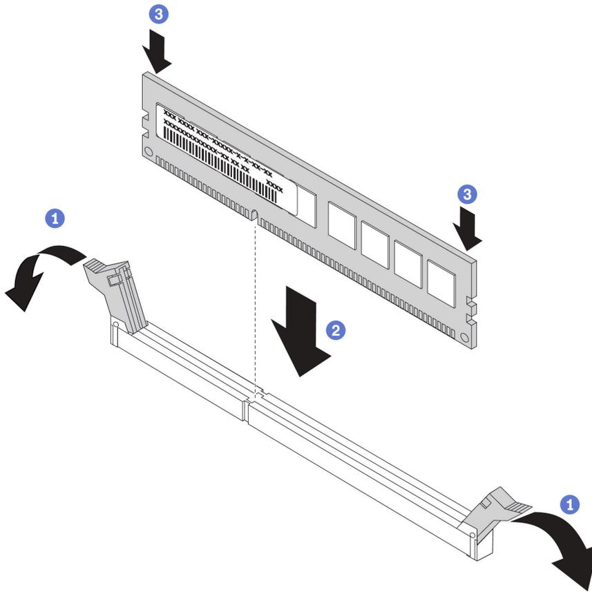
**그림 250. 메모리 모듈 설치**
