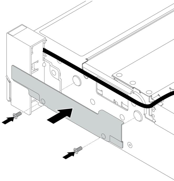
**그림 292. 케이블 고정장치 설치**
