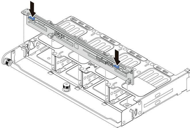
**그림 317. 8 x 2.5인치 뒷면 드라이브 백플레인 설치**
