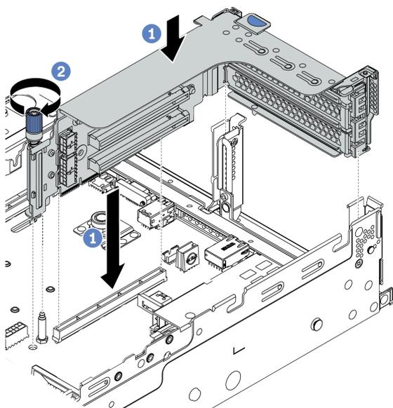
**그림 268. 라이저 어셈블리 설치**
