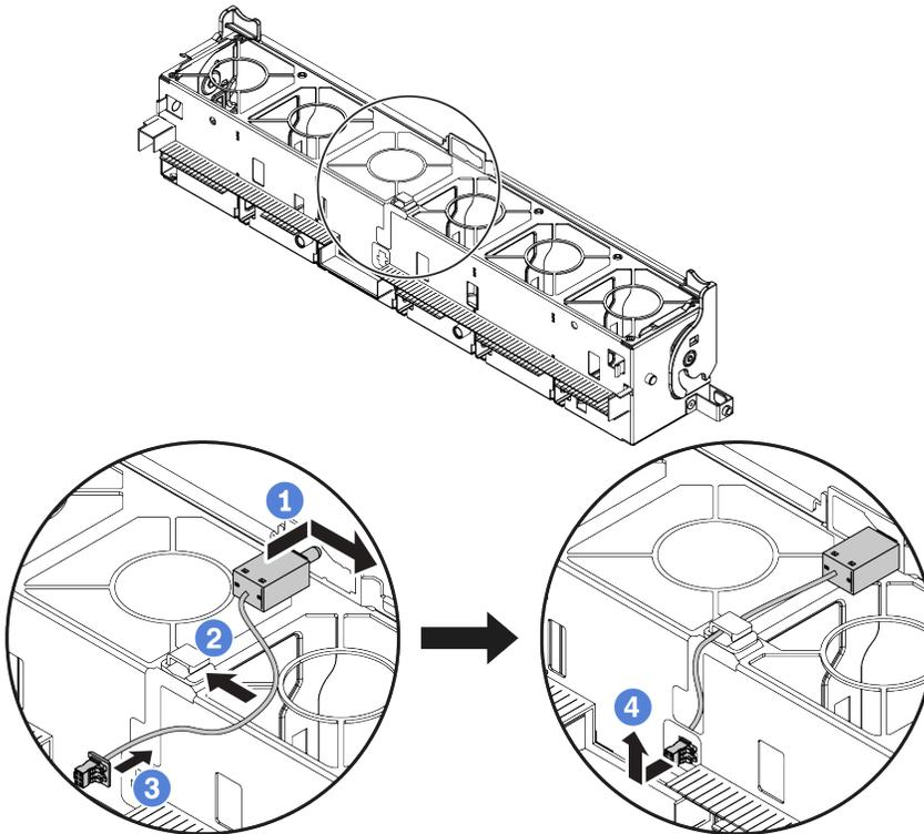
참고: 침입 스위치 케이블이 케이블 클립과 미리 절단된 슬롯을 통해 배선되어 있는지 확인하십시오. 그렇지 않으면 케이블이 팬 케이스 아래로 미끄러져 팬 케이스와 시스템 보드 사이의 접촉면이 고르지 않게 되고 팬 연결이 느슨해질 수 있습니다.
