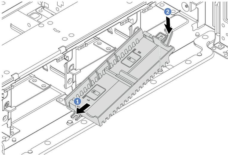
그림 299. Supercap Holder 설치
