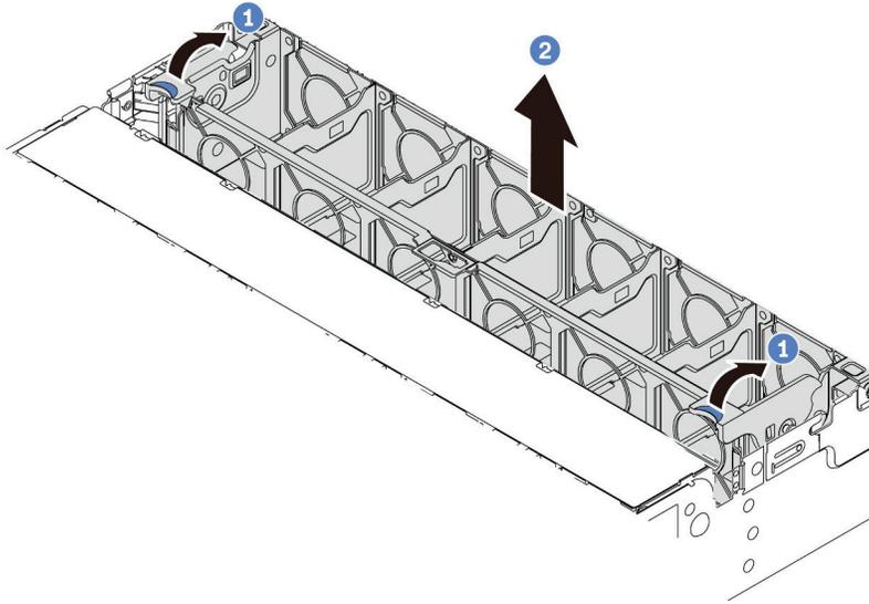
그림 350. 시스템 팬 케이스 제거
