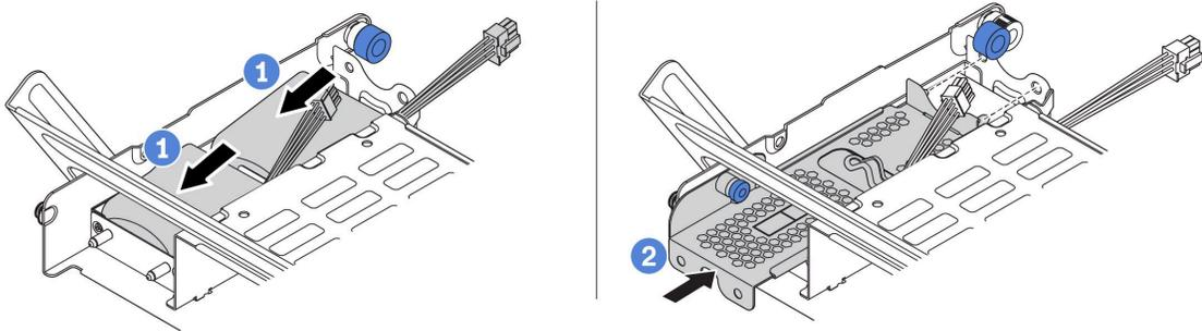
그림 305. RAID 플래시 전원 모듈 설치
