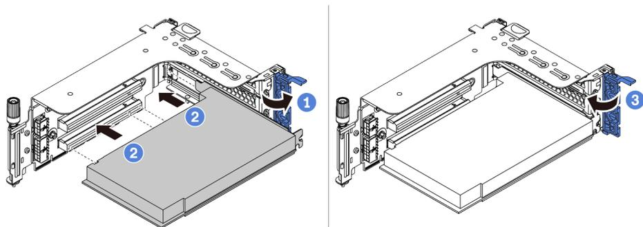
**그림 267. PCIe 어댑터 설치**
