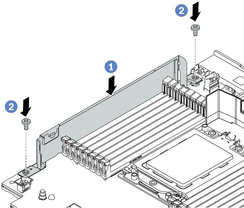
그림 201. 케이블 벽 브래킷 설치
