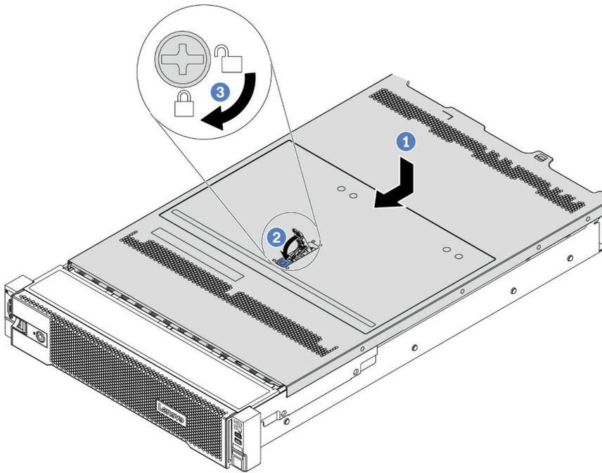
그림 362. 윗면 덮개 설치
