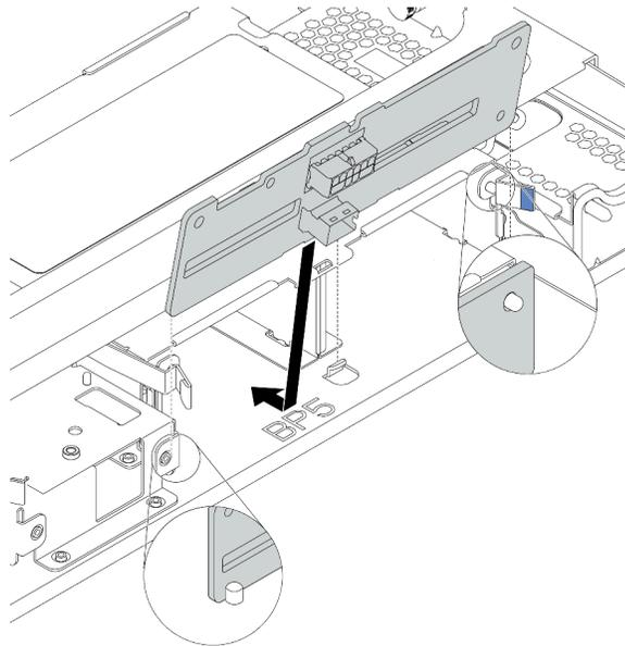
그림 255. 2.5인치 중간 드라이브 백플레인 설치
