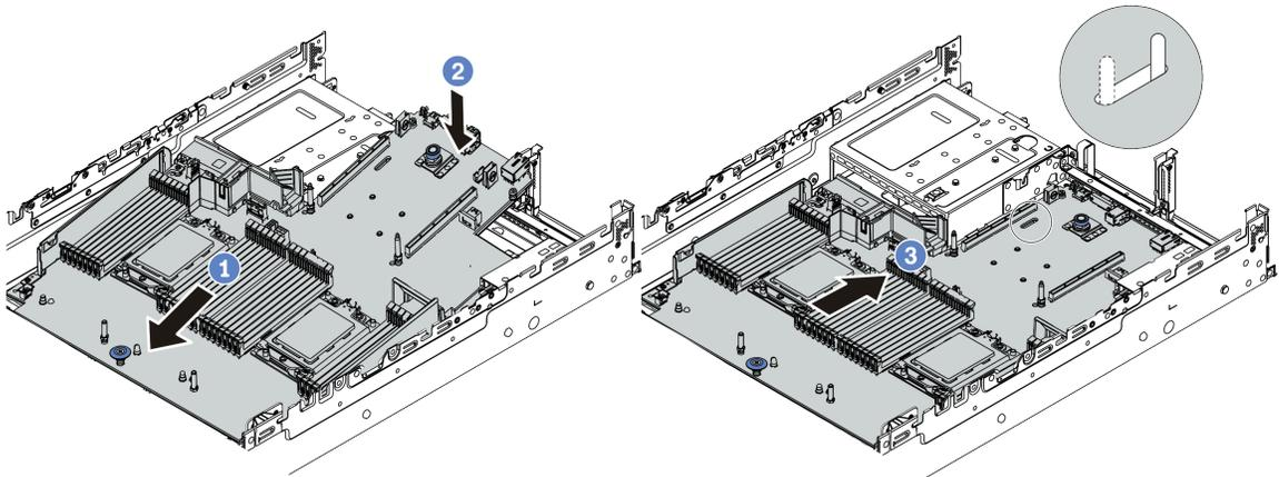
그림 347. 시스템 보드 설치
