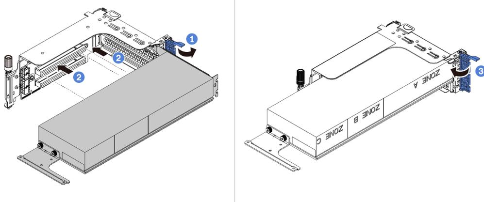
그림 221. GPU 어댑터 설치
