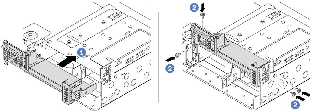
그림 311. C1 뒷면 벽 브래킷 설치(오른쪽)
