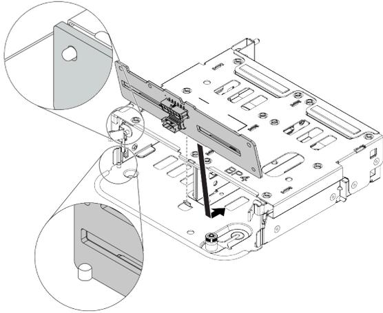
**그림 316. 4 x 2.5인치 뒷면 드라이브 백플레인 설치**
