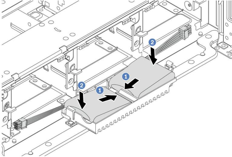
**그림 300. RAID 플래시 전원 모듈 설치**
