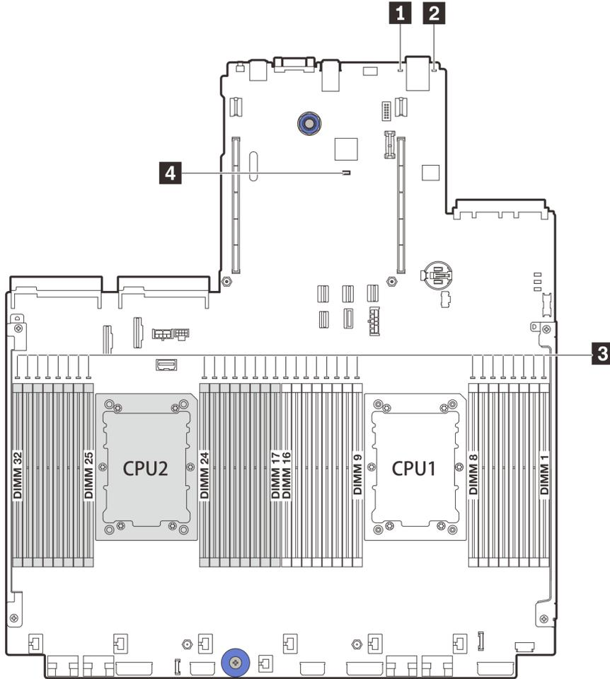
그림 12. 시스템 보드 LED
