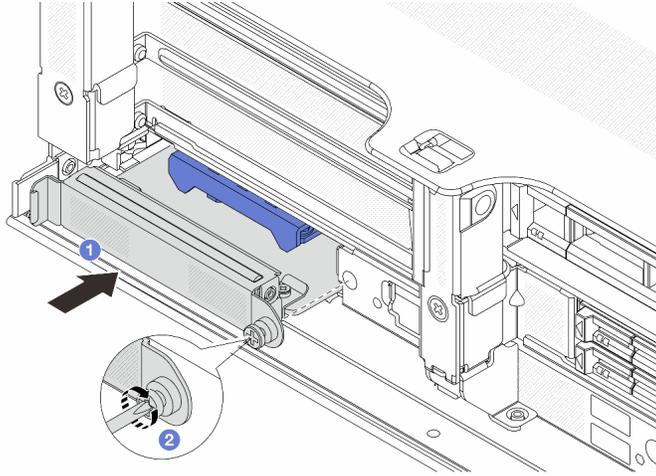
**그림 340. vSphere DSE용 OCP 사용 키트 설치**
