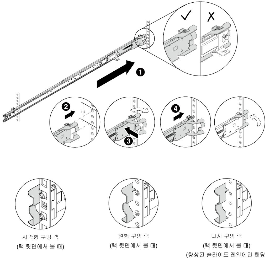
**참고:** 나사 구멍 키트로 설치하는 ThinkSystem 툴리스 슬라이드 레일 키트 v2 Enhanced에서는 지원되지만 ThinkSystem 툴리스 슬라이드 레일 키트 v2에서는 지원되지 않습니다. 이 두 가지 유형의 레일 키트를 사각형 구멍 또는 원형 구멍 키트에 설치하는 방법은 비슷합니다.
