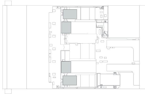
Рис. 295. В среднем отсеке для 2,5-дюймовых дисков
