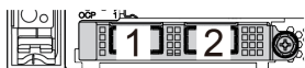
รูปภาพ 259. อะแดปเตอร์อินเทอร์เน็ต OCP 3.0 (ขั้วต่อสองขั้ว เห็นได้จากด้านหลัง)
