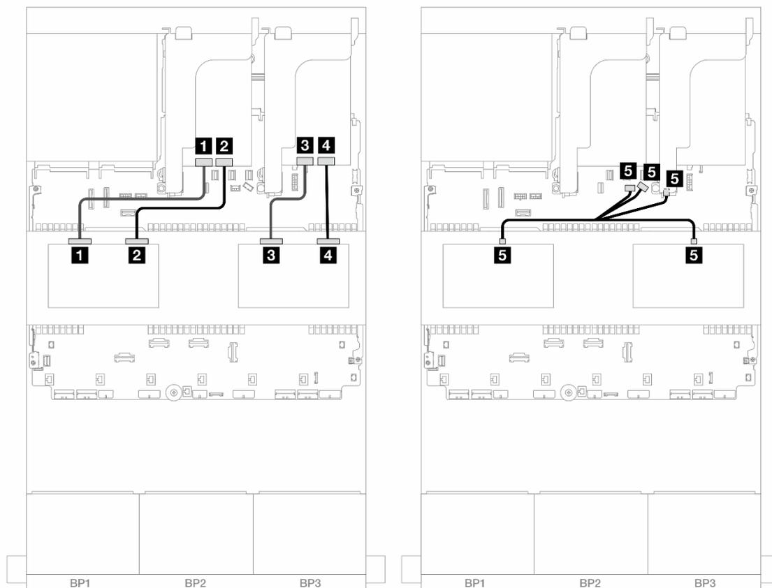
Figura 586. Disposición de los cables de la placa posterior central
