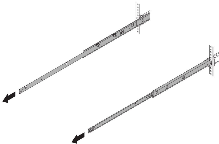
図 37. レールの引き出し
