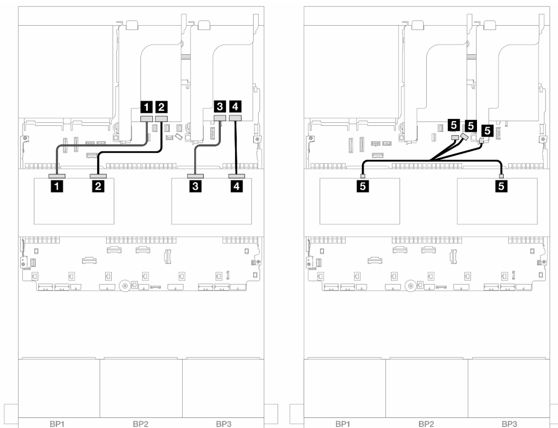
Рис. 599. Прокладка кабелей средней объединительной панели
