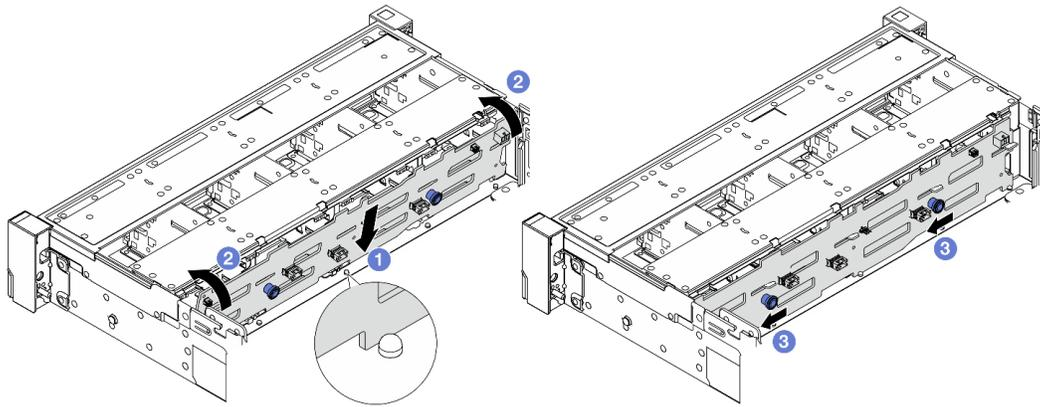
**그림 79. 앞면 3.5" 드라이브 백플레인 설치**
