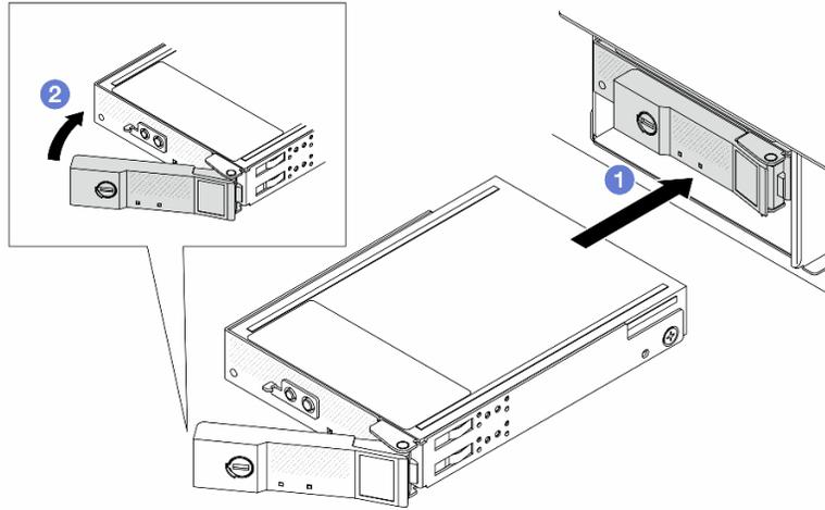
**그림 56. E3.S CMM 설치**
