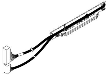
그림 7. 케이블 라이저 카드(Gen5 x8, 500/400mm)
