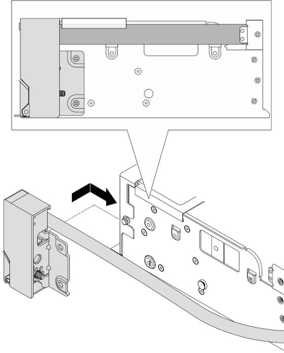
**그림 233. 랙 래치 설치**
