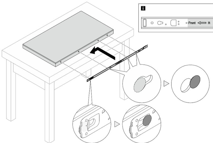
그림 34. 내부 레일 설치
