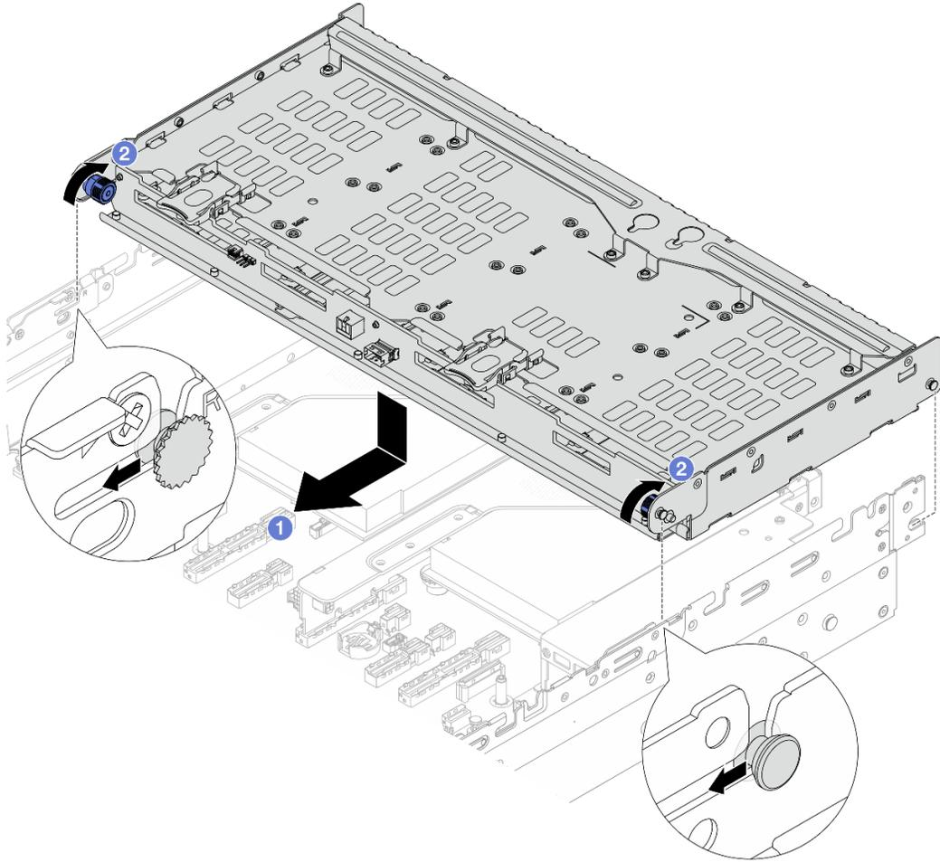
**그림 270. 4 x 3.5" 뒷면 드라이브 케이지 설치**
