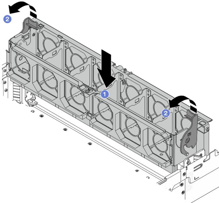
그림 313. 시스템 팬 케이스 설치
