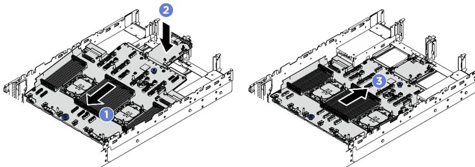
그림 305. 시스템 보드 어셈블리 설치
