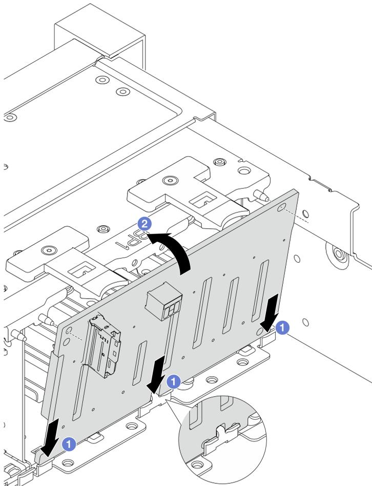
그림 78. 앞면 2.5" 드라이브 백플레인 설치
