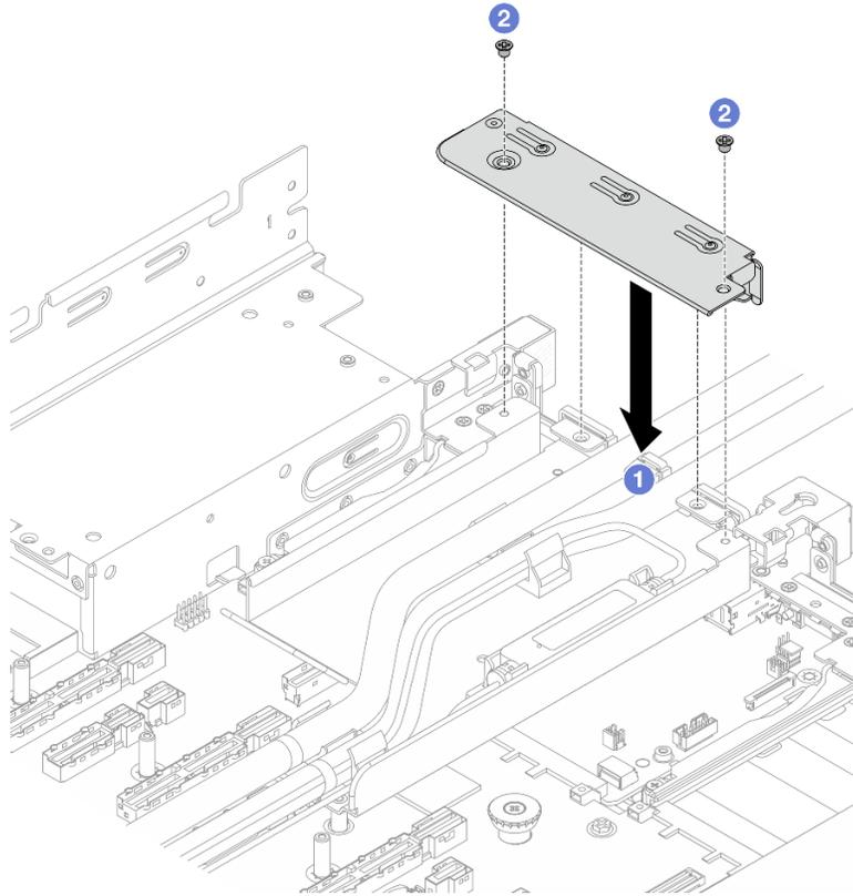
**그림 116. 1FH 브래킷 설치**
