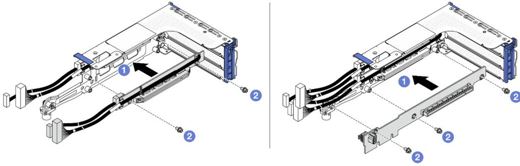
**그림 283. 3FH 라이저 케이스에 라이저 카드 설치**
