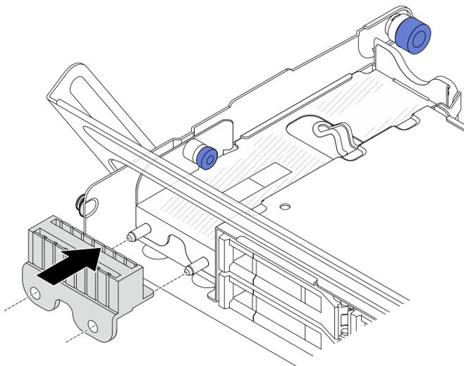
**그림 245. 고무 설치**
