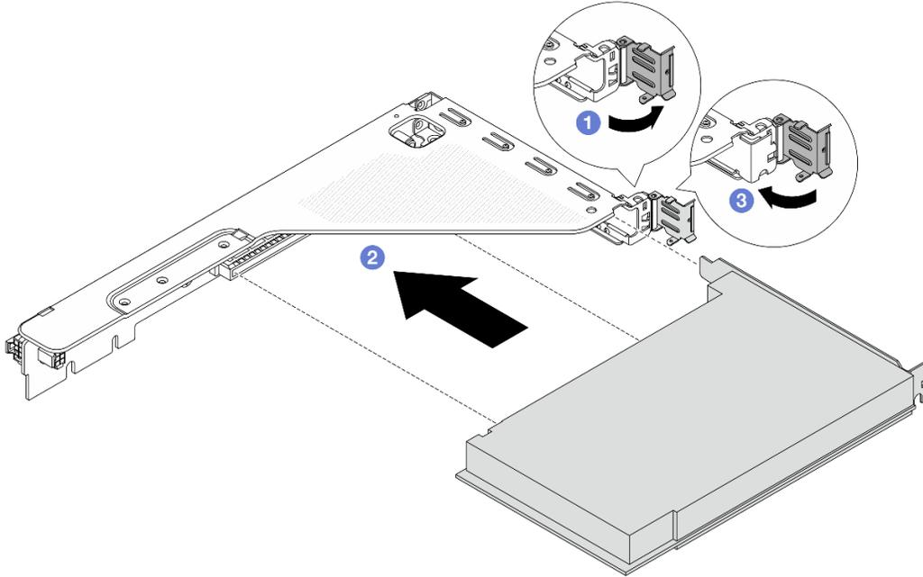
**그림 287. 1FH 라이저 케이스에 PCIe 어댑터 설치**
