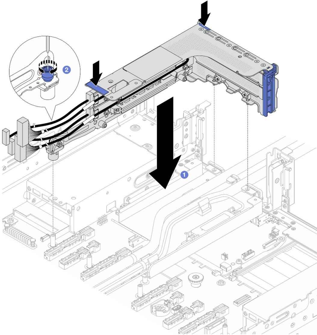
**그림 117. 3FH 라이저 케이지 설치**
