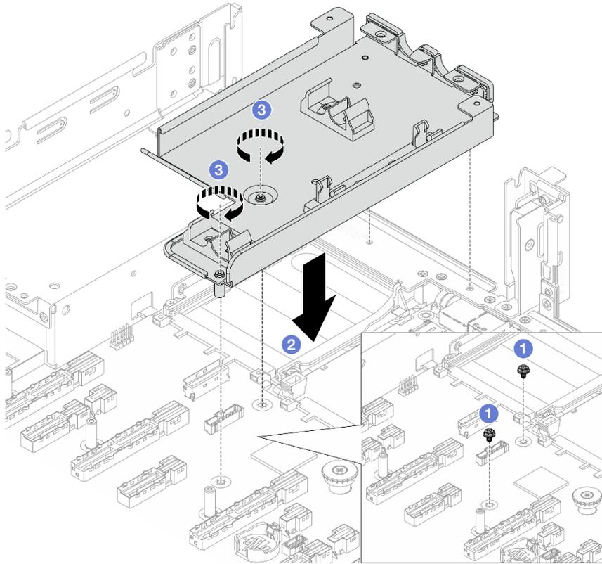
**그림 108. 호스 홀더 설치**
