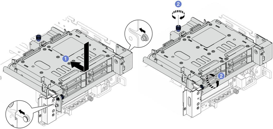
**그림 261. 4 x 2.5" 뒷면 드라이브 케이지 설치**
