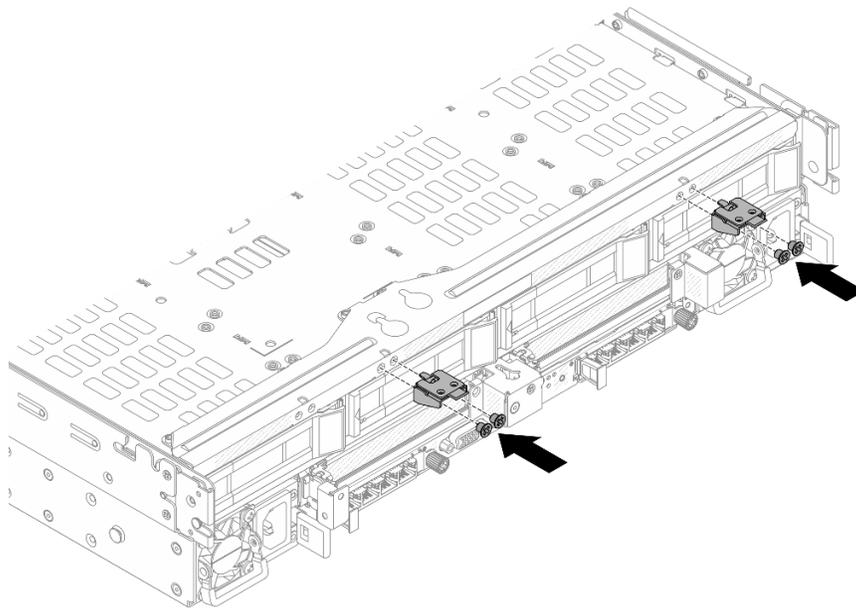
그림 271. 상단 덮개 지원 브라켓 설치
