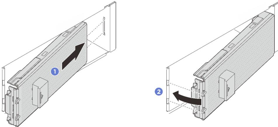
**그림 59. E3.S 베젤 설치**
