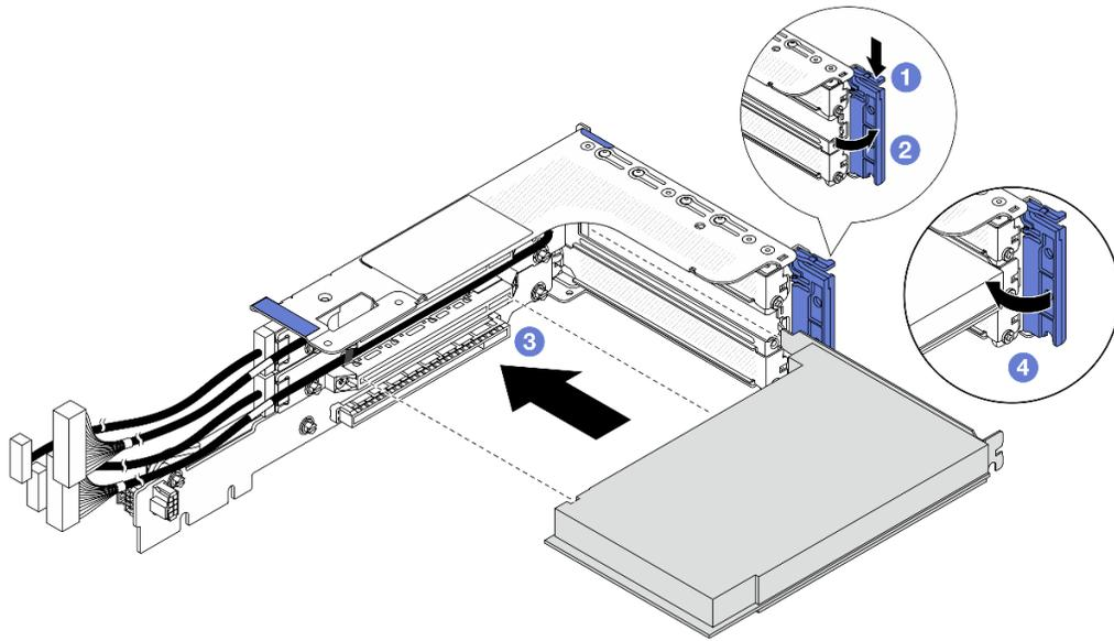
**그림 285. 3FH 라이저 케이스에 PCIe 어댑터 설치**
