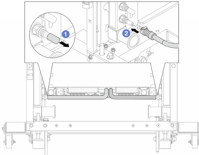
**그림 174. 퀵 커넥트 플러그 설치**
