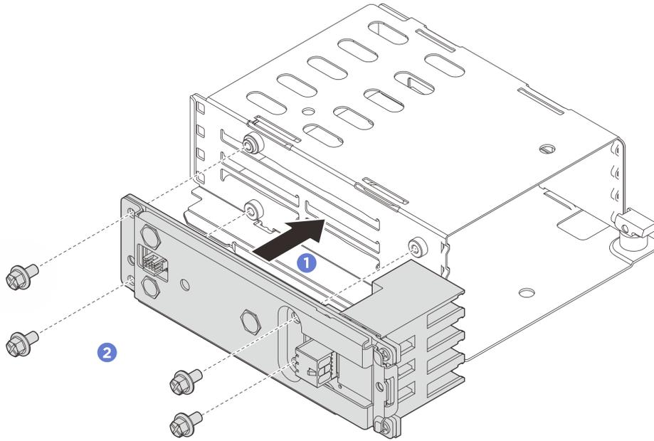
**그림 74. 백플레인 어셈블리 설치**
