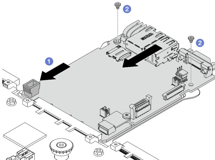
그림 308. 프로세서 보드에 시스템 I/O 보드 설치
