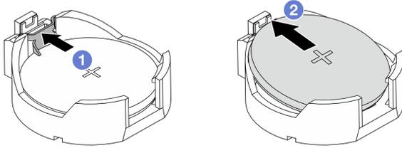
**그림 49. CMOS 배터리 제거**
