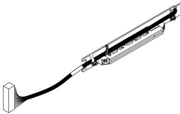
그림 8. 케이블 라이저 카드(Gen5 x8, 350mm)
