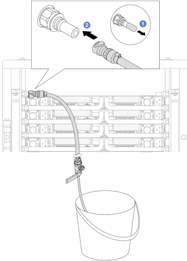
**그림 192. 공급 측에 블리드 키트 설치**
