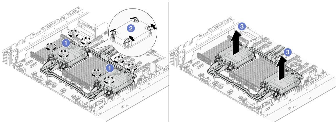
**그림 106. Processor Neptune Core Module 제거**
