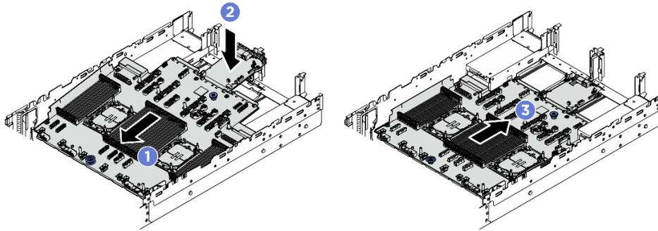
그림 309. 시스템 보드 어셈블리 설치
