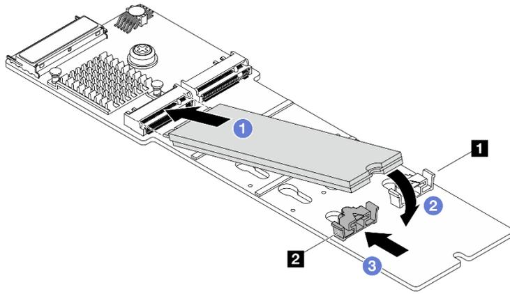
그림 91. M.2 드라이브 설치
