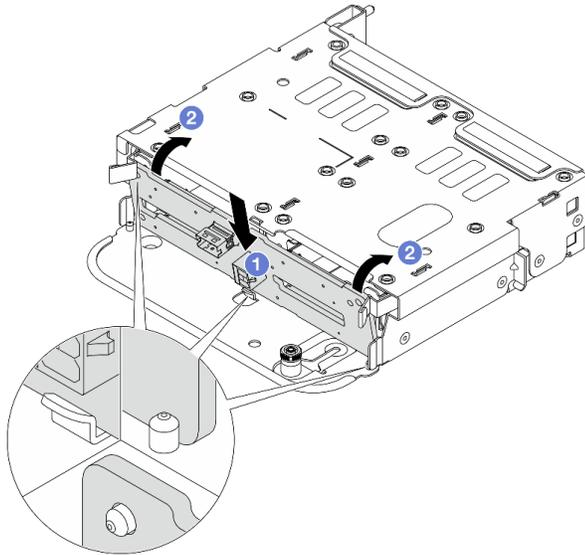
**그림 256. 4 x 2.5" 뒷면 드라이브 백플레인 설치**
