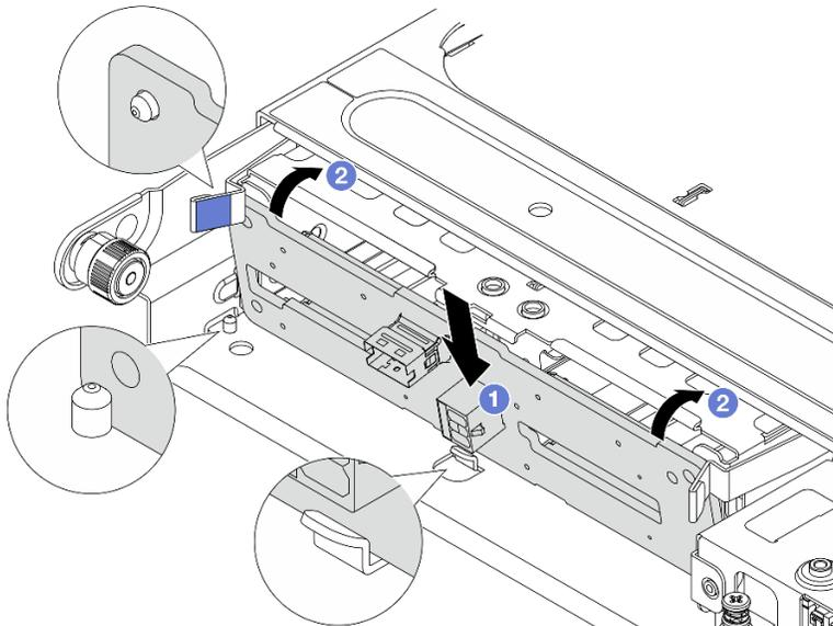
그림 207. 2.5" 중간 드라이브 백플레인 설치
