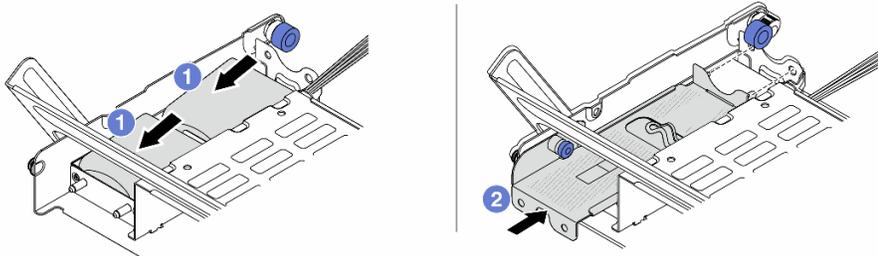
**그림 244. 중간 드라이브 케이스에 RAID 플래시 전원 모듈 설치**
