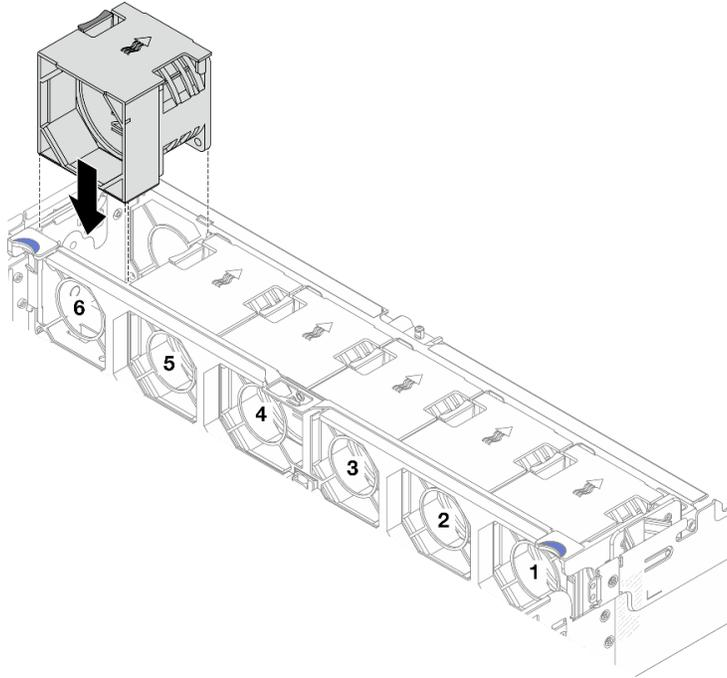
그림 311. 시스템 팬 설치
