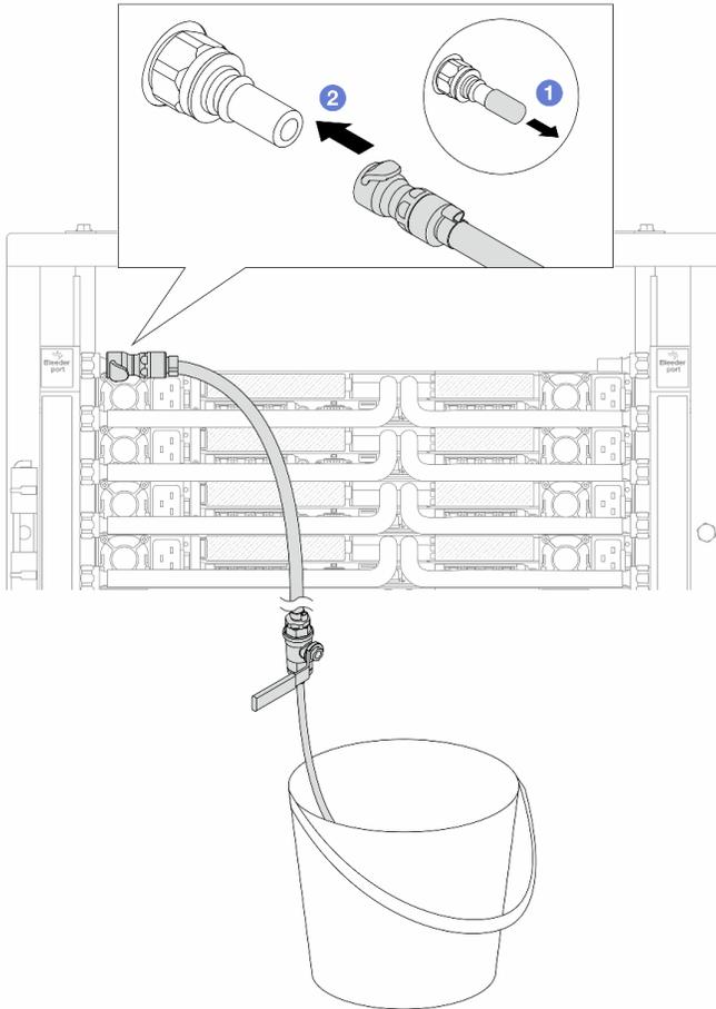
**그림 175. 공급 측에 블리드 키트 설치**
