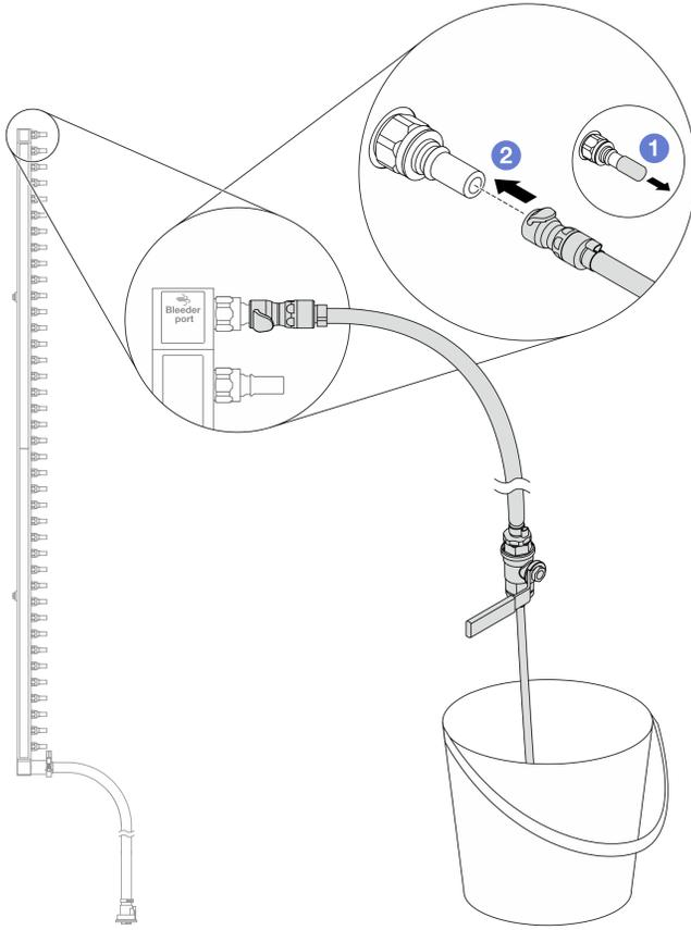
**그림 184. 공급 측에 블리드 키트 설치**
