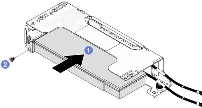
**그림 284. 2LP 라이저 케이스에 PCIe 어댑터 설치**
