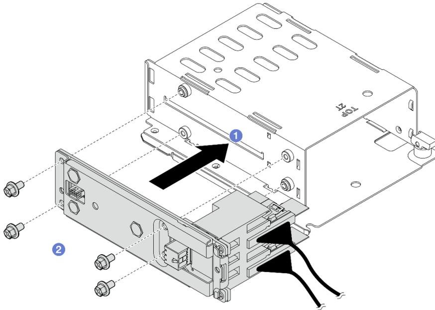
그림 62. 백플레인 설치
