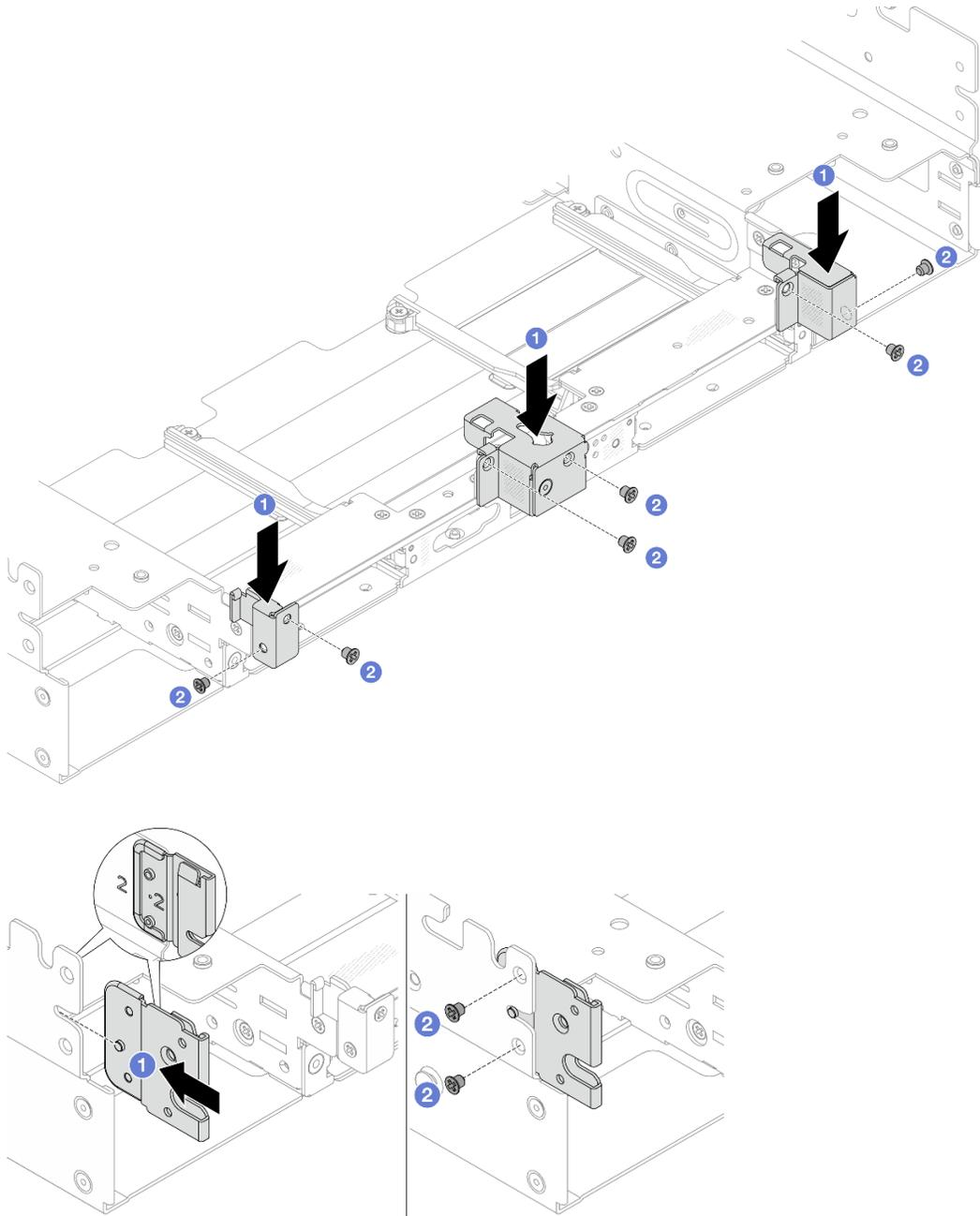
**그림 268. 4 x 3.5" 뒷면 드라이브 케이지 어셈블리용 뒷면 벽 브래킷 설치**
