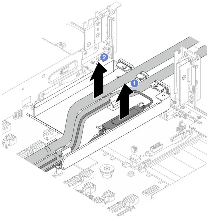
**그림 105. 호스 분리 및 누수 감지 센서 모듈**
