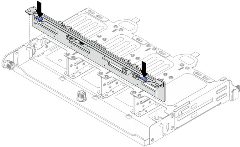
그림 257. 8 x 2.5" 뒷면 드라이브 백플레인 설치
