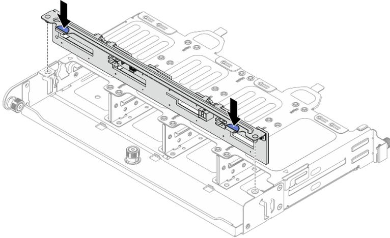
**그림 265. 8 x 2.5" 뒷면 드라이브 백플레인 설치**
