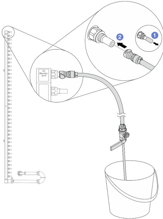
**그림 162. 공급 측에 블리드 키트 설치**
