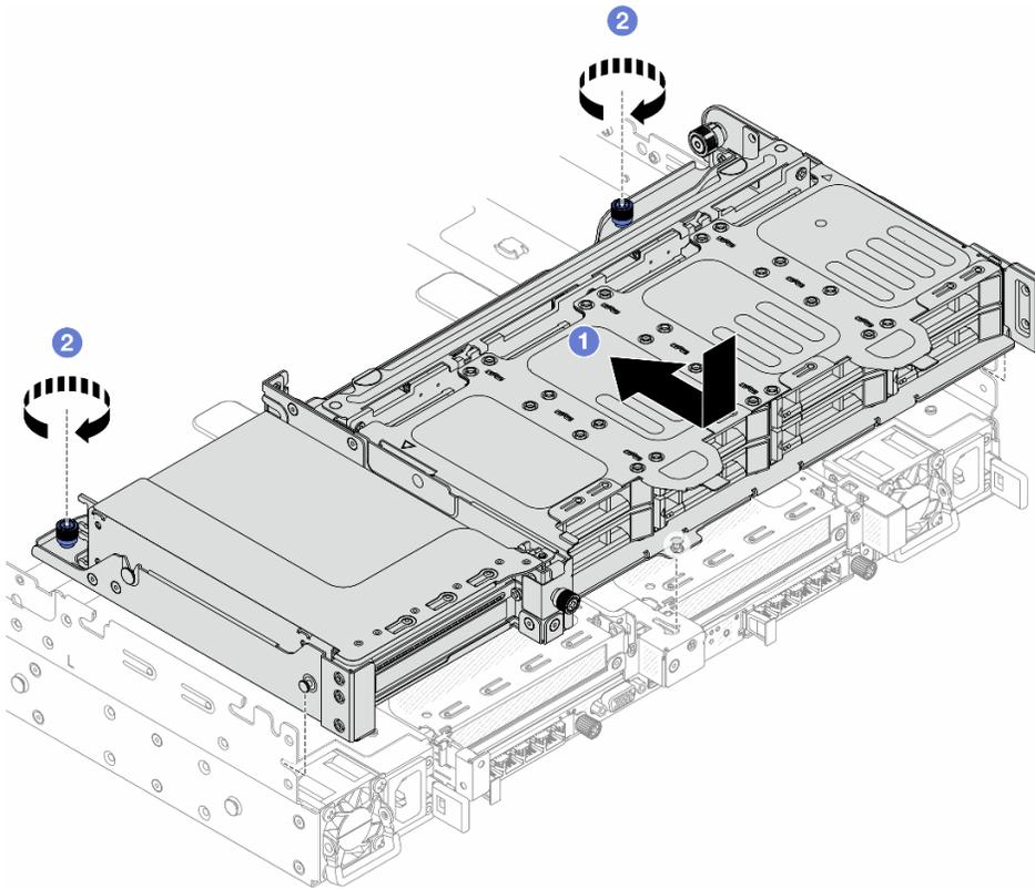
**그림 266. 8 x 2.5" 뒷면 드라이브 케이스 설치**
