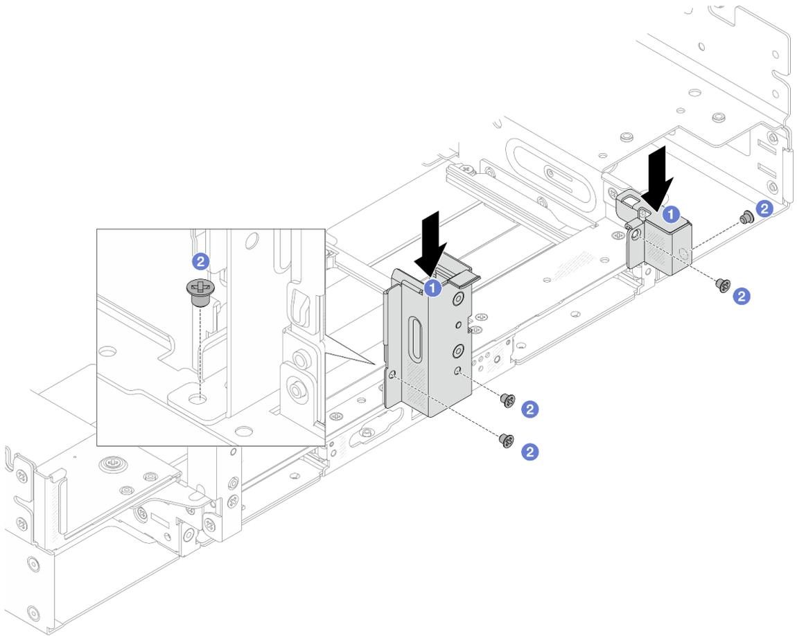
**그림 260. 4 x 2.5" 뒷면 드라이브 케이지 어셈블리용 뒷면 벽 브래킷 설치**
