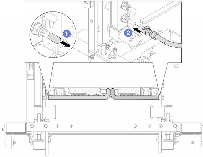
**그림 190. 퀵 커넥트 플러그 설치**
