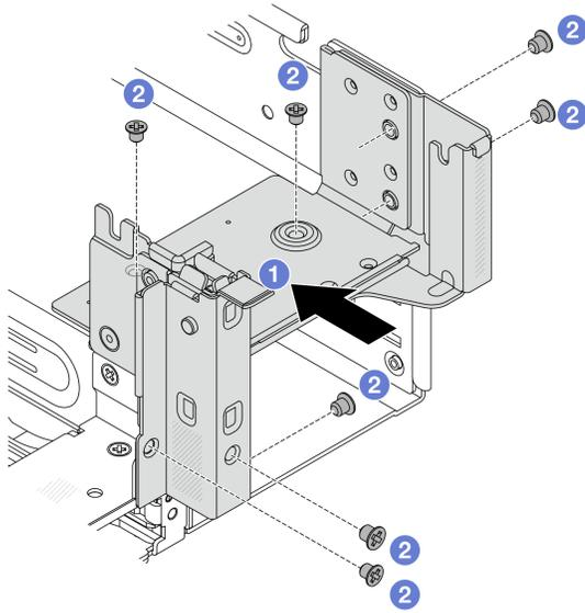
그림 252. 오른쪽 뒷면 벽 브래킷 설치
