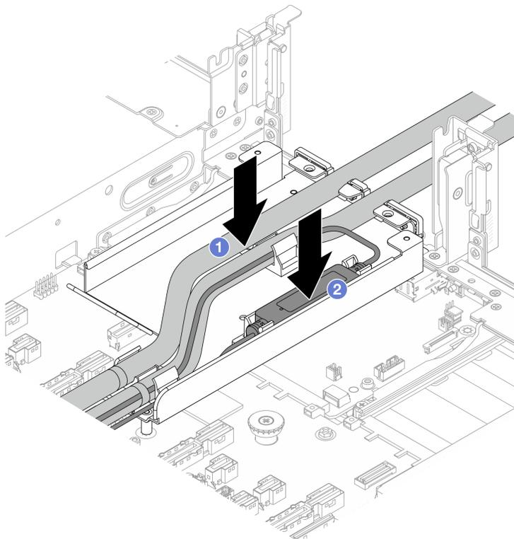
**그림 114. 호스 배치 및 누수 감지 센서 모듈**
