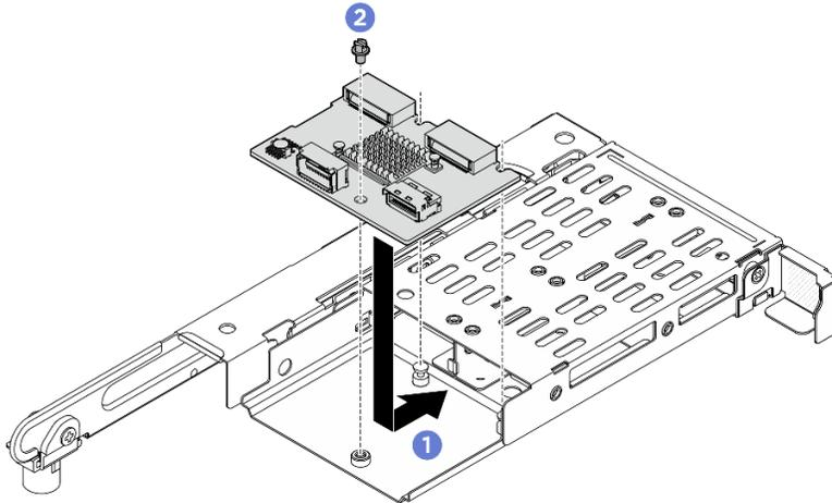
그림 149. 1FH M.2 라이저 케이스에 M.2 백플레인 설치
