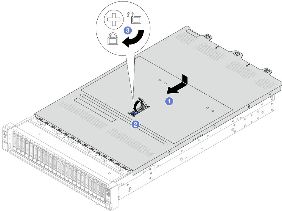
**그림 315. 윗면 덮개 설치**
