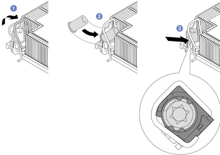
**그림 85. 방열판에 Torx T30 너트 설치**
