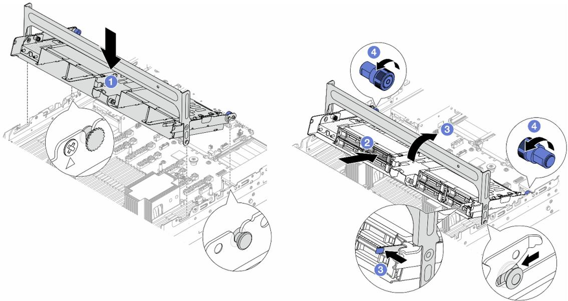
**그림 208. 중간 드라이브 케이스 및 드라이브 설치**
