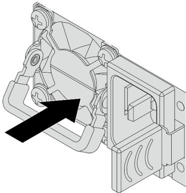
**그림 215. 핫 스왑 전원 공급 장치 설치**
