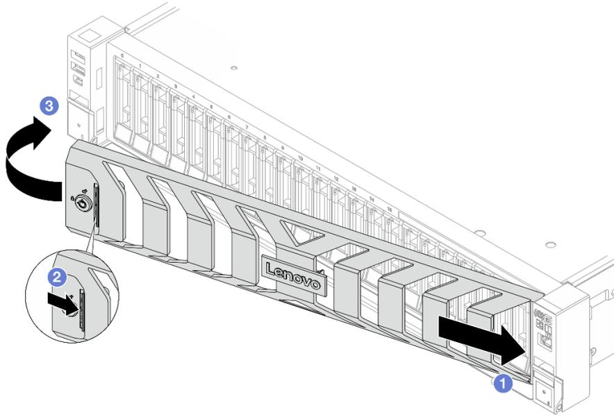
**그림 293. 보안 베젤 설치**
