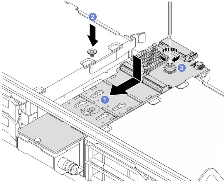
**그림 97. 중간 드라이브 케이스에 M.2 백플레인 설치**
