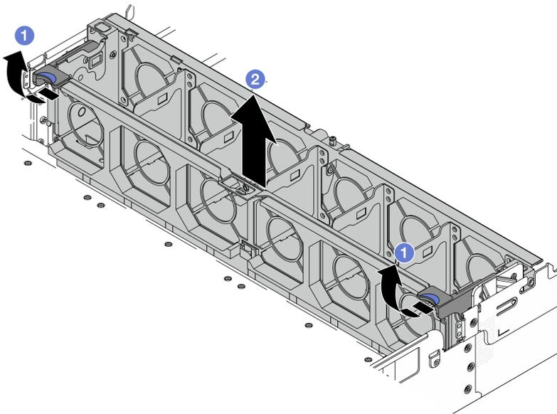
그림 312. 시스템 팬 케이스 제거
