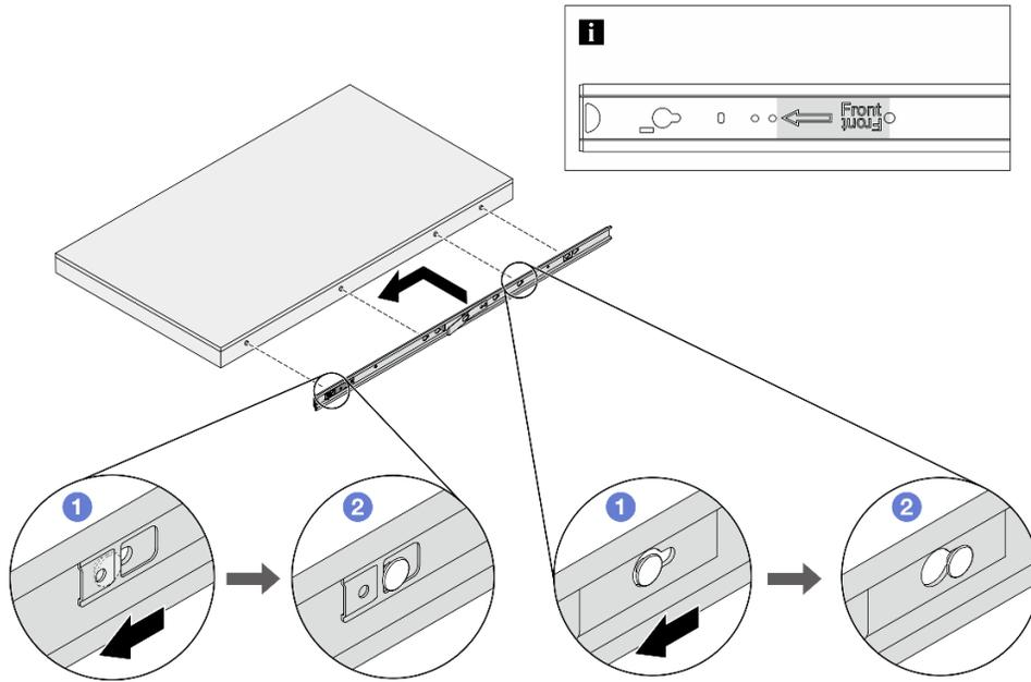
그림 24. 내부 레일 설치
