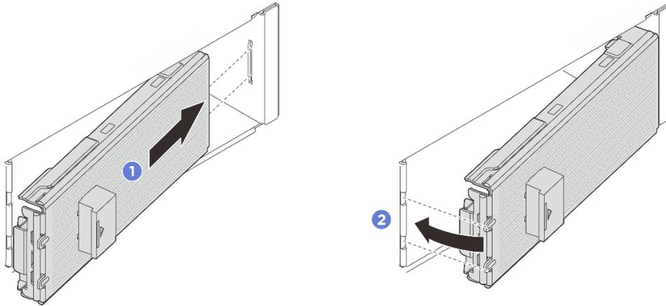
그림 71. E3.S 베젤 설치
