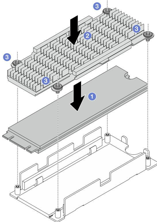
**그림 128. M.2 드라이브 설치**
