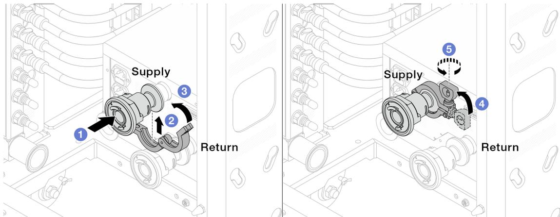
**그림 169. 볼 밸브 설치**
