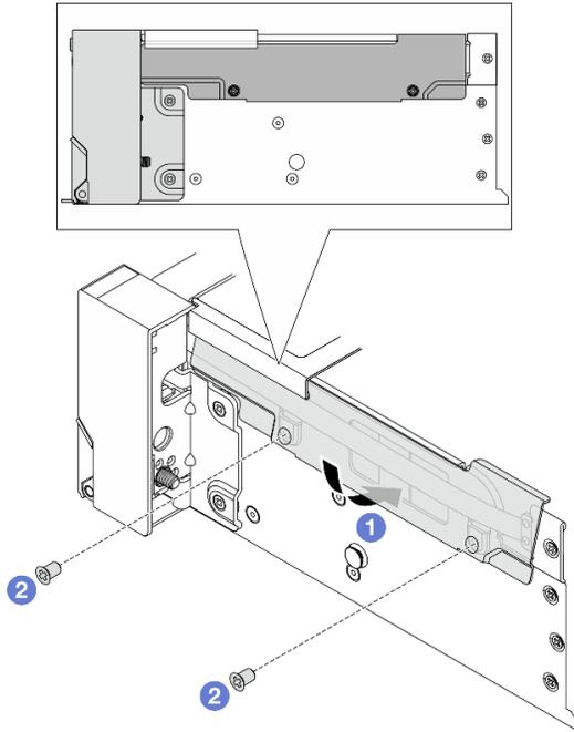
**그림 235. 케이블 고정장치 설치**
