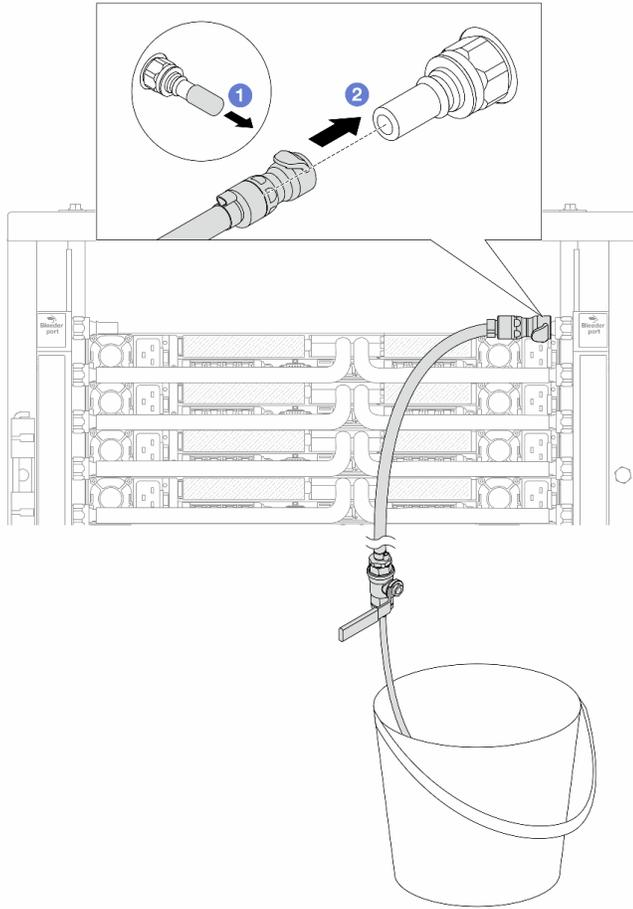
**그림 178. 리턴 측에 블리드 키트 설치**
