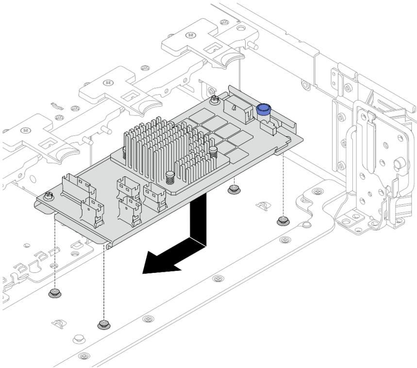
**그림 87. 내부 CFF 어댑터 설치**
