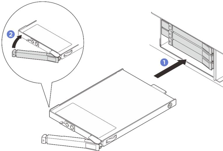
**그림 68. E3.S 핫 스왑 드라이브 설치**
