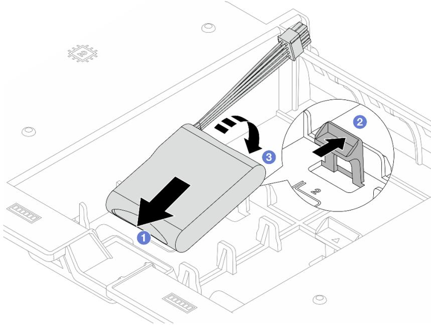
**그림 240. 공기 조절 장치에 RAID 플래시 전원 모듈 설치**
