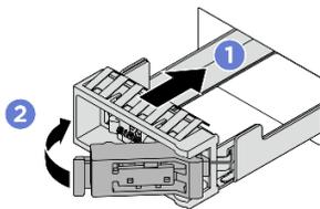
**그림 120. M.2 드라이브 트레이 설치**
