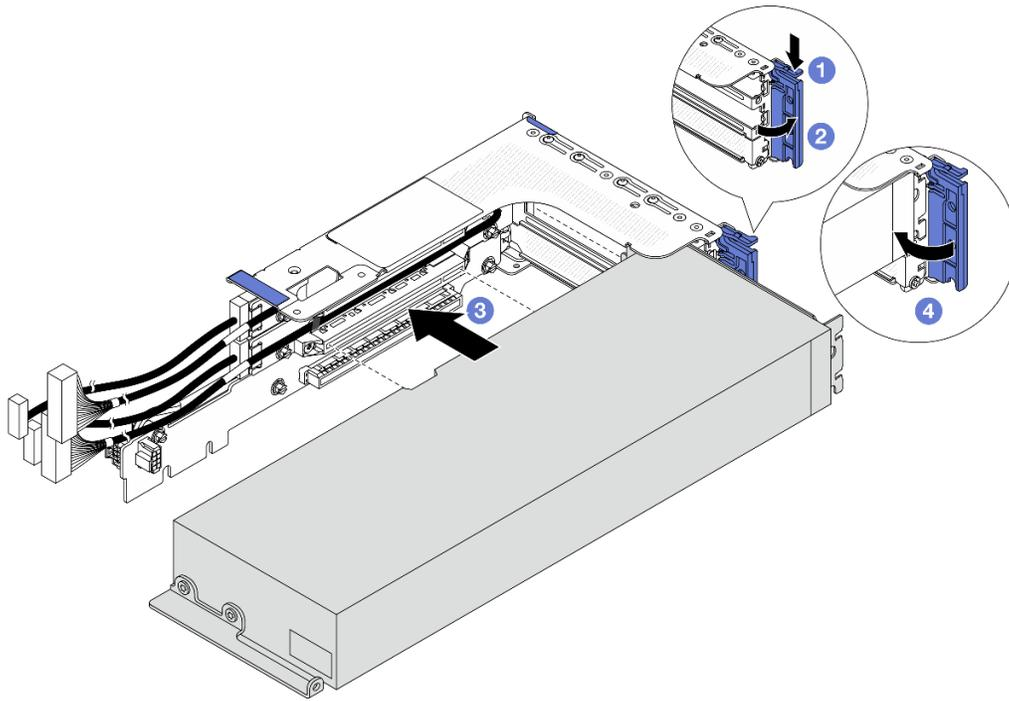
그림 82. GPU 어댑터 설치
