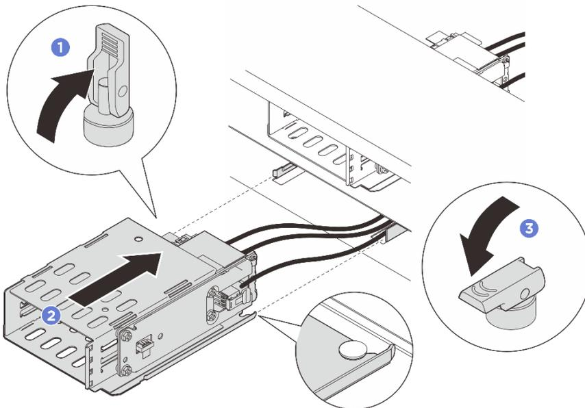
**그림 75. E3.S 1T 케이스 설치**
