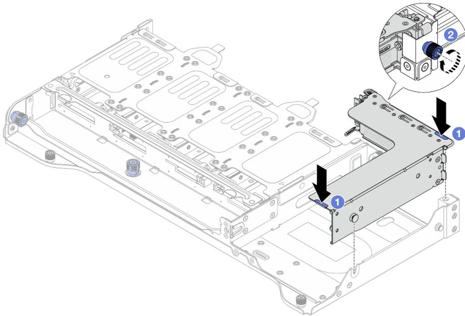
**그림 289. 2FH 라이저 어셈블리 설치**
