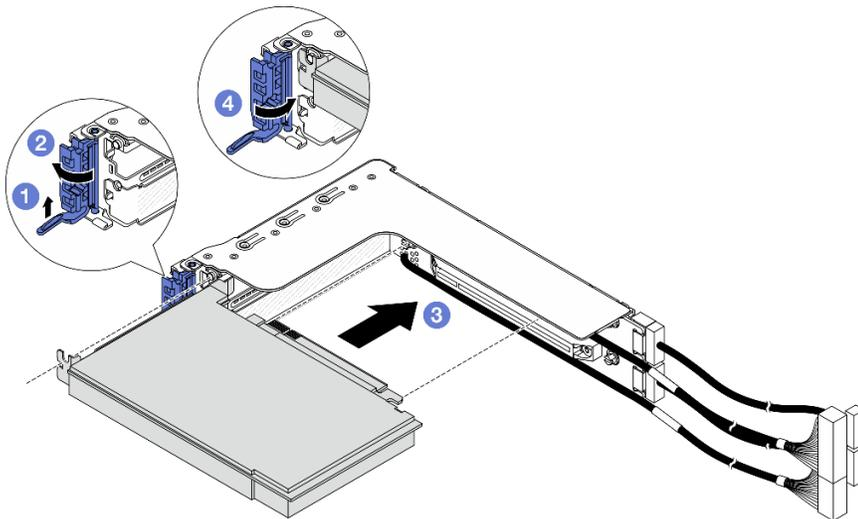
**그림 286. 2FH 라이저 케이스에 PCIe 어댑터 설치**
