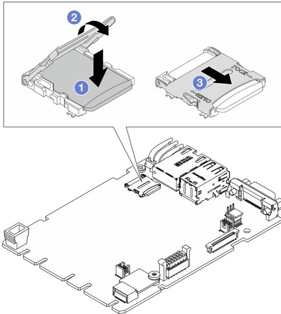
그림 203. MicroSD 카드 설치
