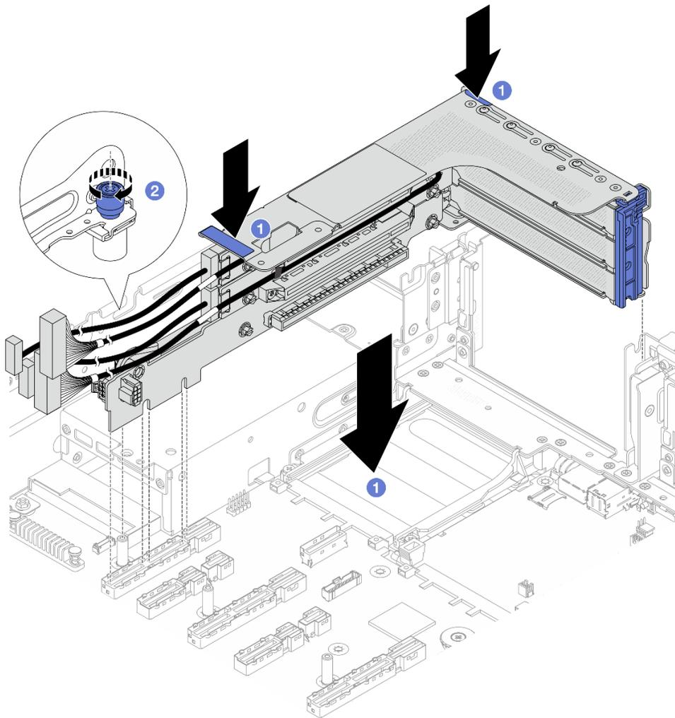
그림 288. 3FH 라이저 어셈블리 설치
