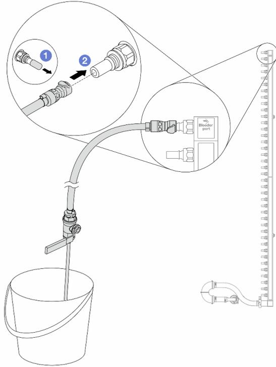
**그림 164. 리턴 측에 블리드 키트 설치**
