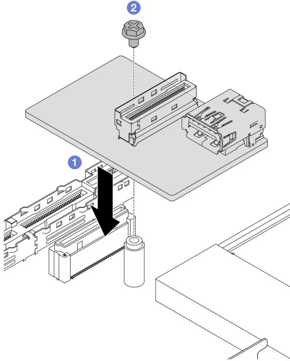
그림 317. USB I/O 보드 설치
