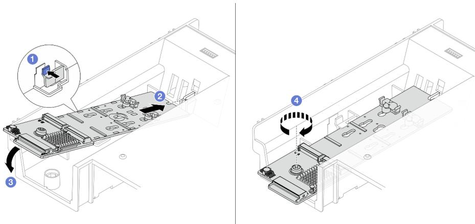
그림 96. 공기 조절 장치에 M.2 백플레인 설치
