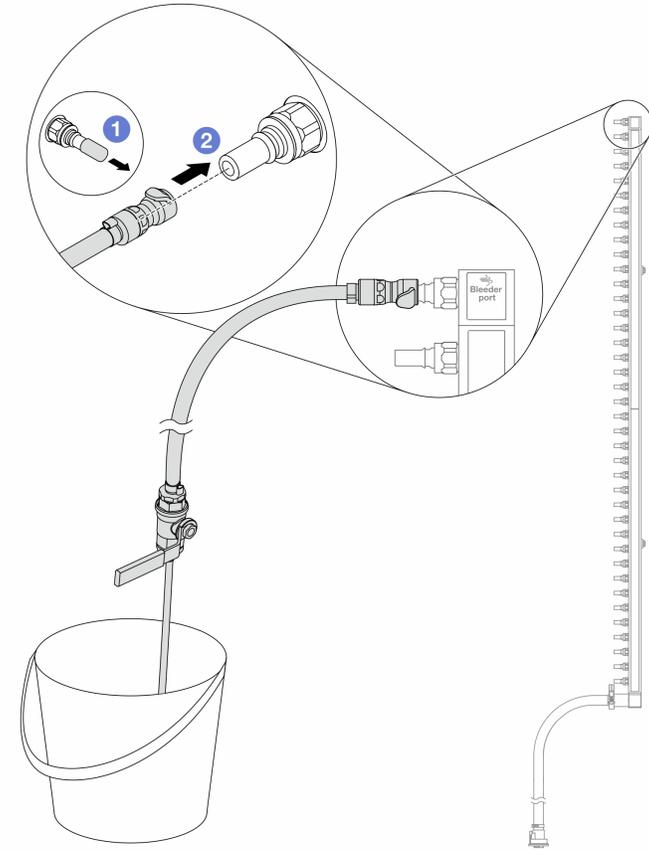
**그림 186. 리턴 측에 블리드 키트 설치**
