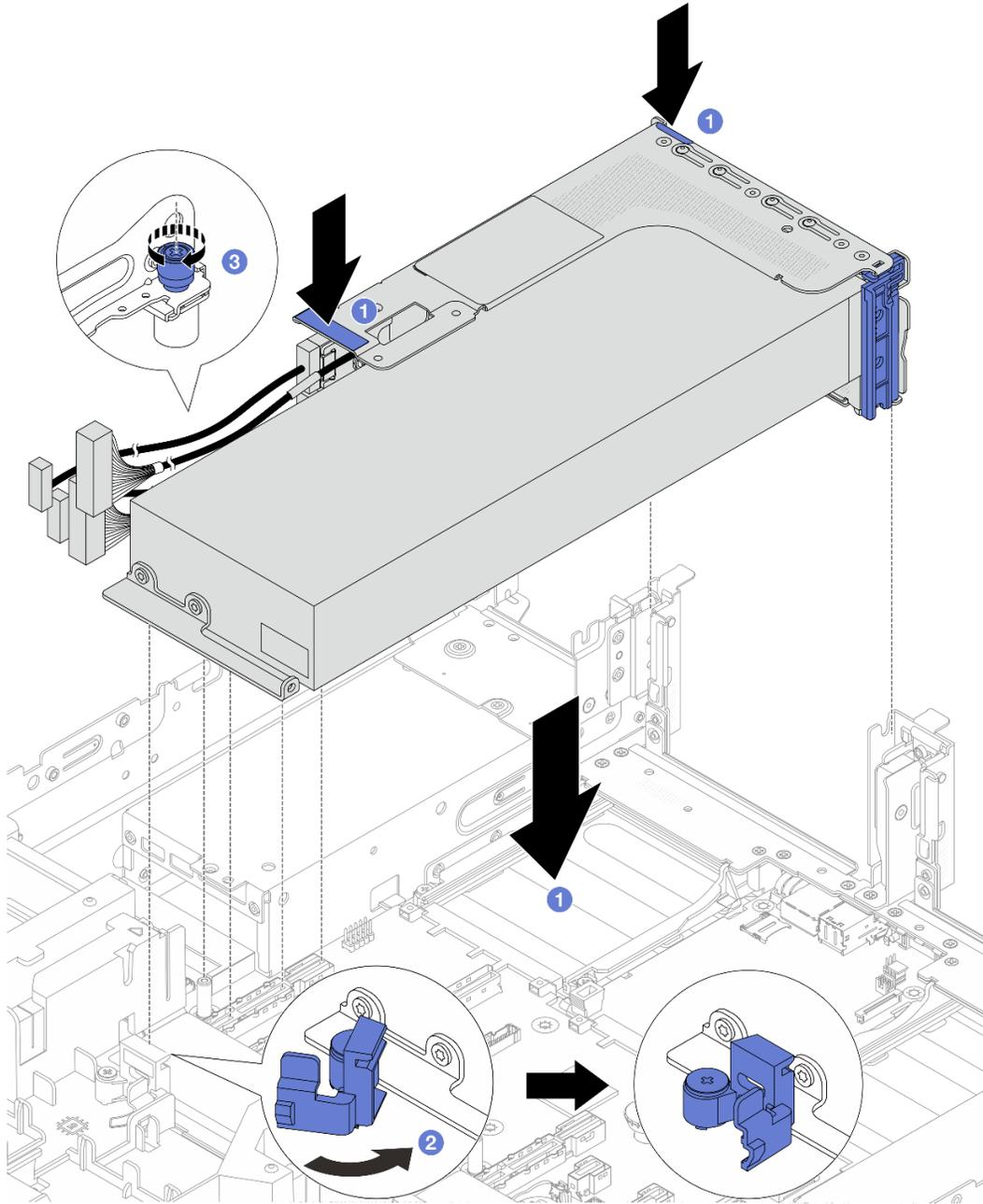
**그림 83. GPU 어댑터로 라이저 어셈블리 설치**
