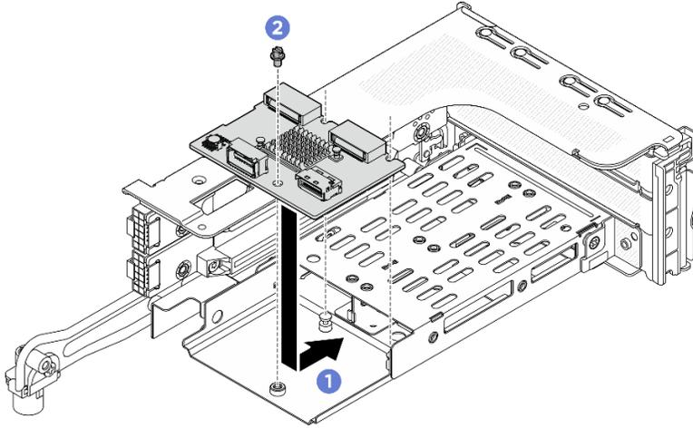
그림 148. 3FH M.2 라이저 케이스에 M.2 백플레인 설치
