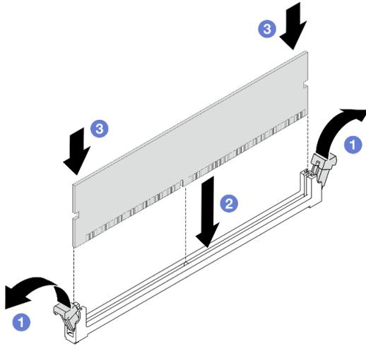
**그림 201. 메모리 모듈 설치**
