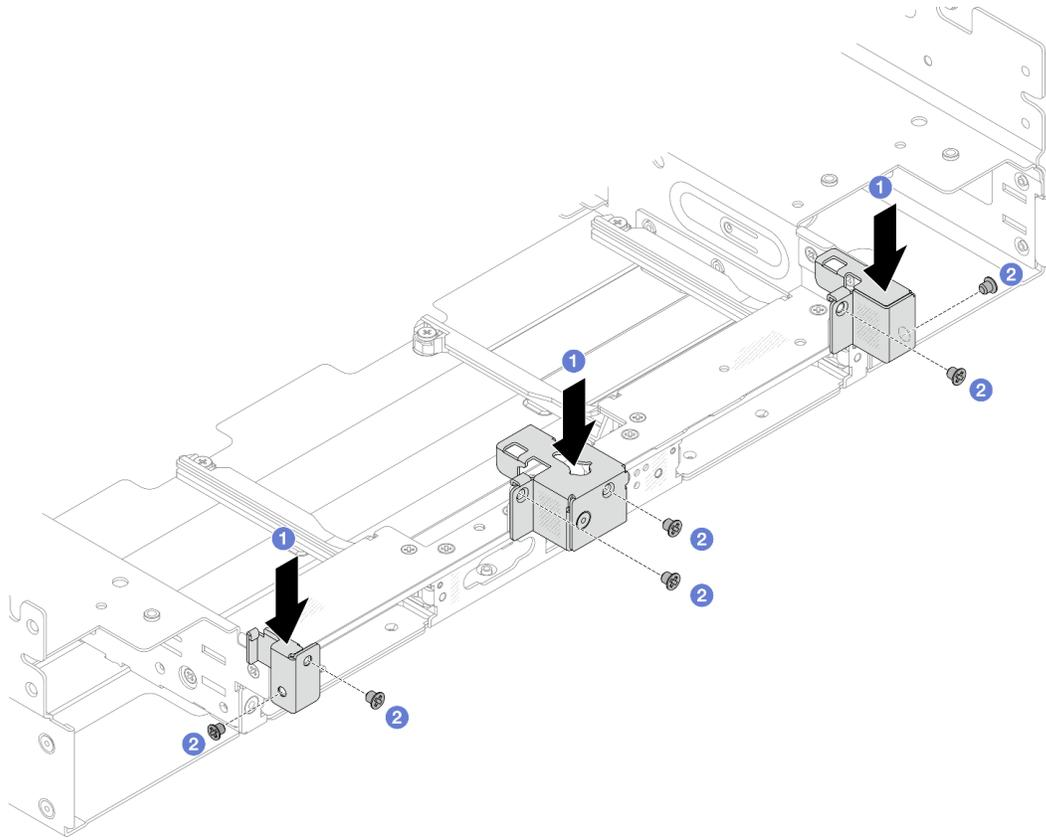
**그림 264. 8 x 2.5" 뒷면 드라이브 케이지 어셈블리용 뒷면 벽 브래킷 설치**
