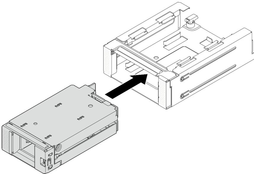
**그림 143. 케이스 프레임에 앞면 M.2 드라이브 케이스 설치**
