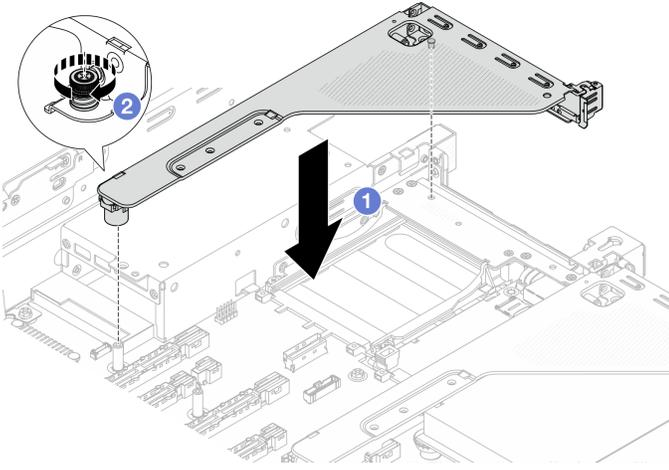
**그림 300. 라이저 어셈블리 설치**
