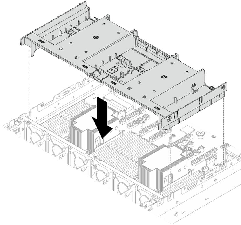
**그림 45. 공기 조절 장치 설치**
