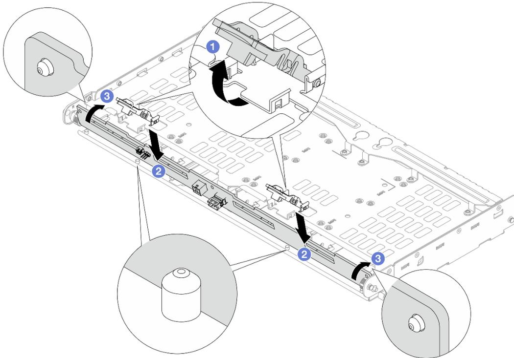
그림 258. 4 x 3.5" 뒷면 드라이브 백플레인 설치
