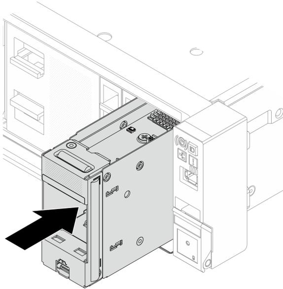
**그림 142. 새시에 앞면 M.2 드라이브 케이스 설치**
