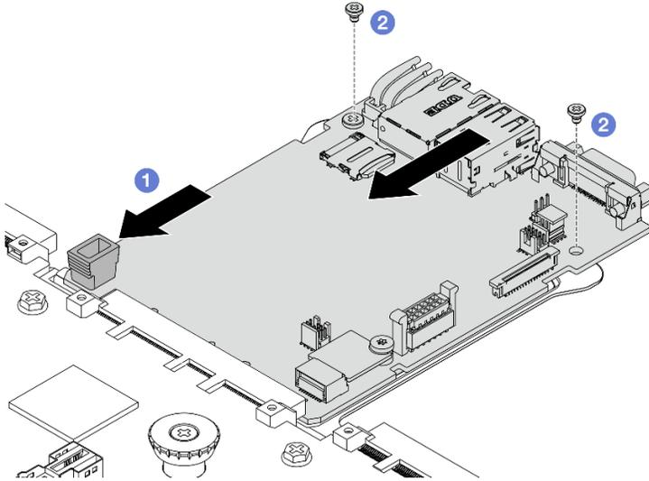
그림 304. 프로세서 보드에 시스템 I/O 보드 설치
