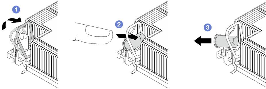
Рис. 84. Снятие гайки Torx T30 с радиатора
