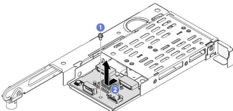
Рис. 147. Снятие объединительной панели M.2 с отсека платы-адаптера Riser 1FH M.2
