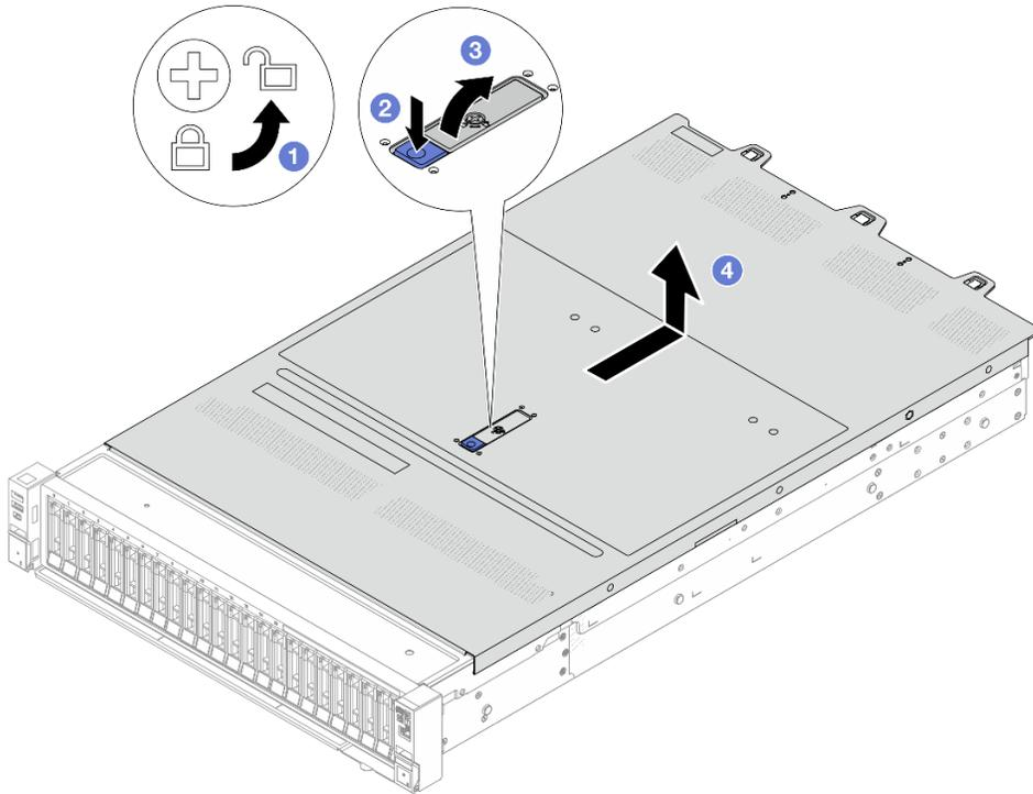
Рис. 314. Снятие верхнего кожуха
