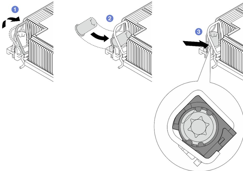
Рис. 85. Установка гайки Torx T30 в радиатор
