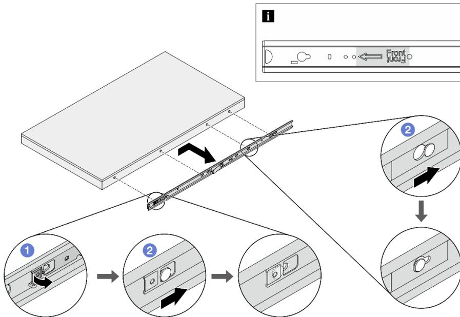
Рис. 22. Снятие внутренних направляющих
