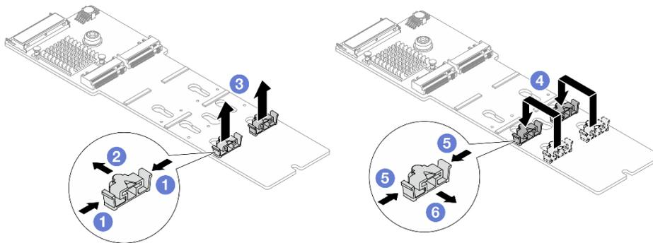
Рис. 89. Регулировка фиксатора M.2
