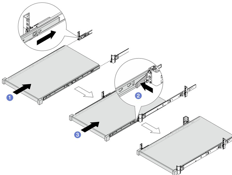
Рис. 26. Установка сервера
