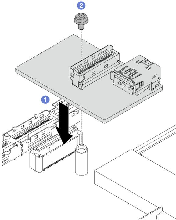
Рис. 317. Установка платы ввода-вывода USB
