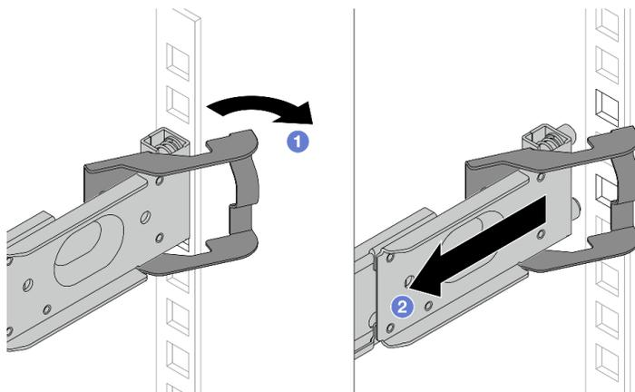
Рис. 14. Снятие направляющей сзади
