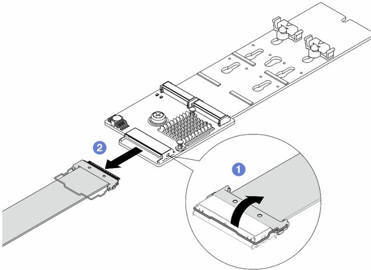
Рис. 92. Отключение кабеля M.2
