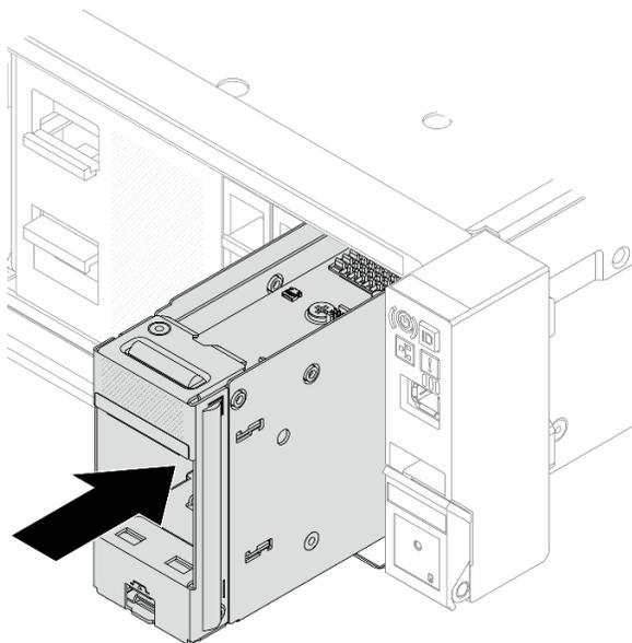
Рис. 142. Установка переднего отсека для дисков M.2 в раму
