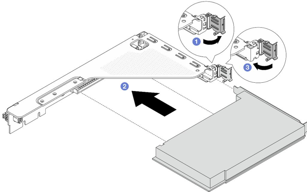
Рис. 287. Установка адаптера PCIe в отсек платы-адаптера Riser 1FH
