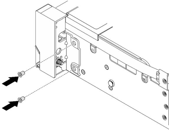
Рис. 234. Установка винтов
