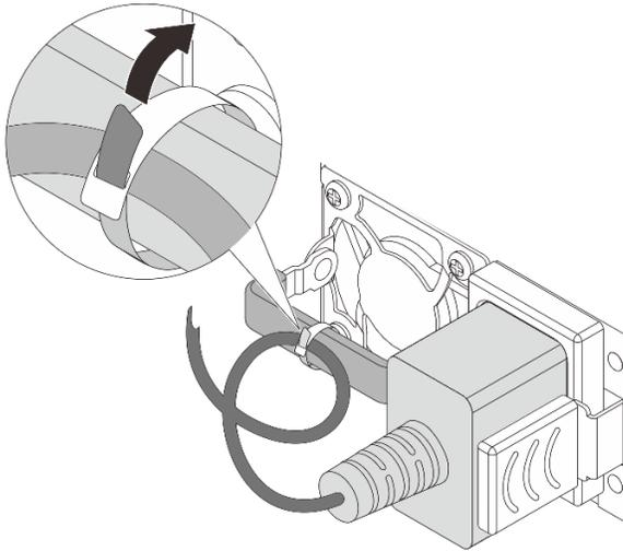
Рис. 216. Прокладка и привязывание шнура питания
