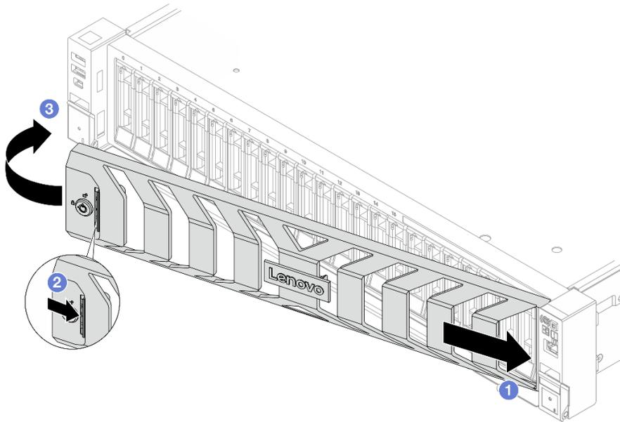
Рис. 293. Установка защитной панели
