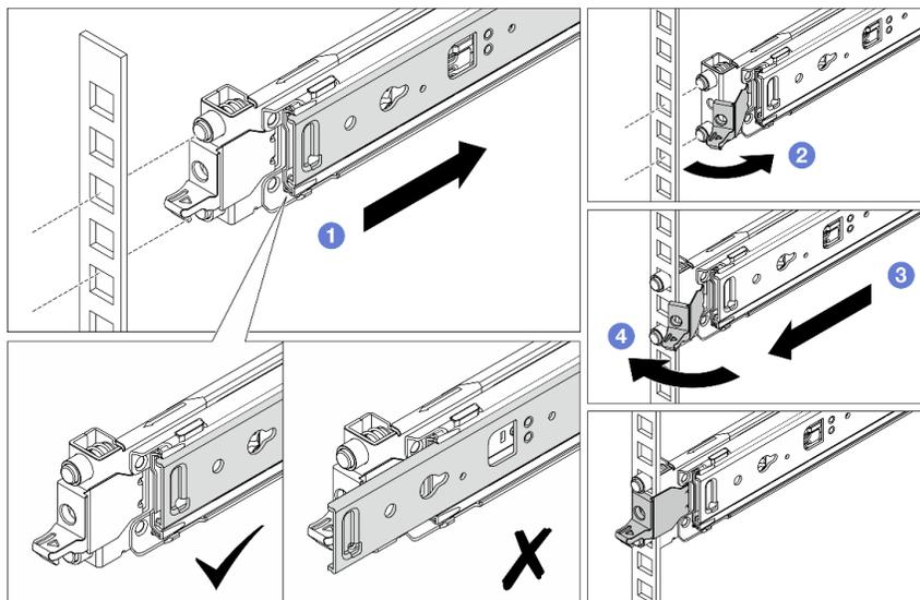
Рис. 18. Установка передних крепежных контактов
