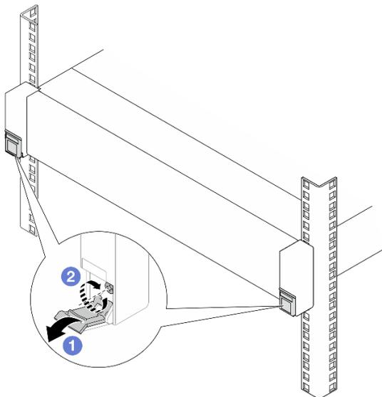
Рис. 38. Фиксация сервера на лицевой стороне стойки
