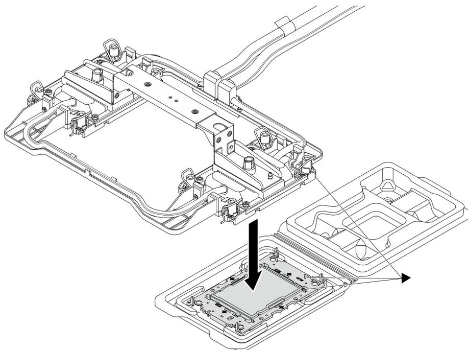
Рис. 109. Установка процессора
