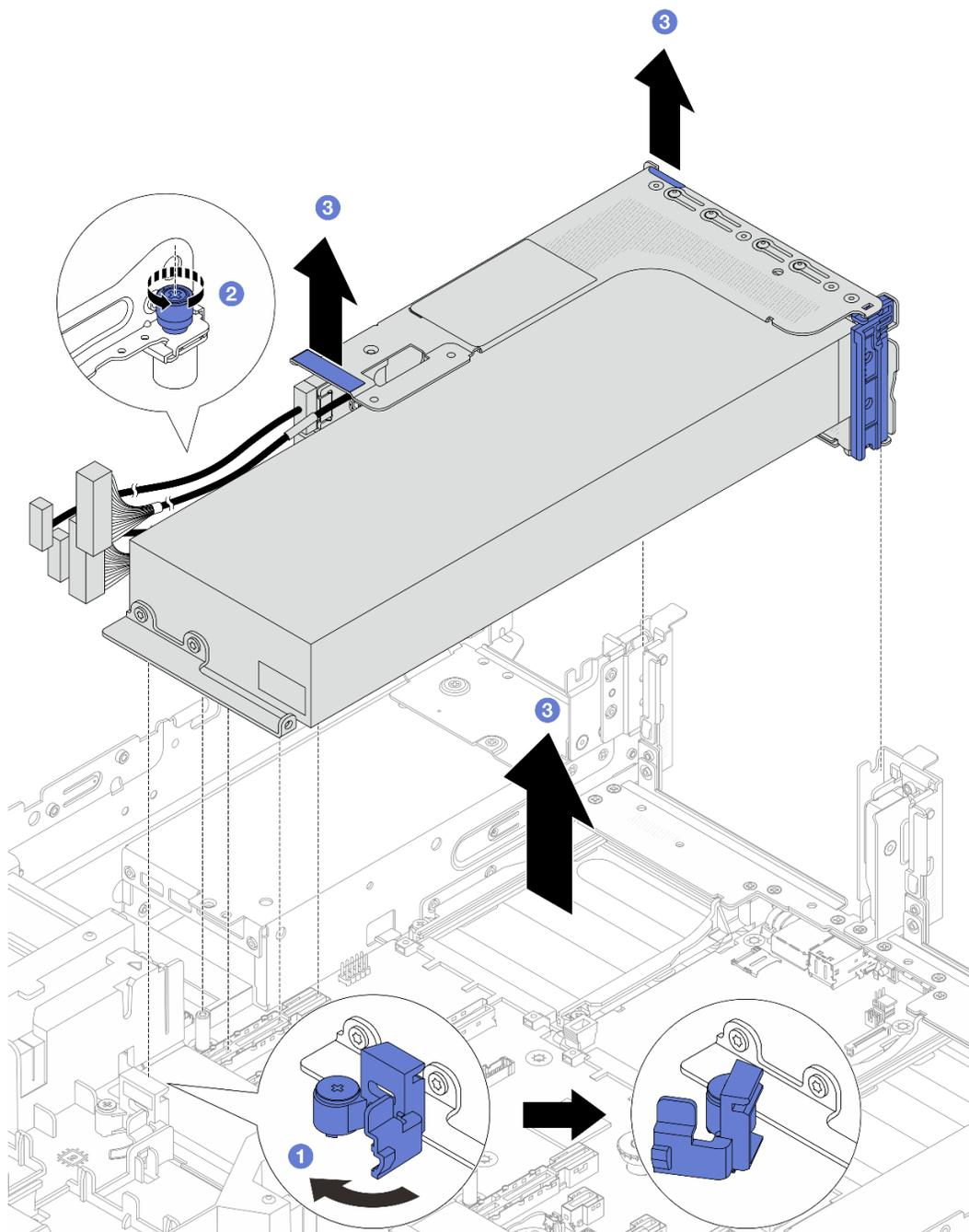
Рис. 80. Снятие блока платы-адаптера Riser
