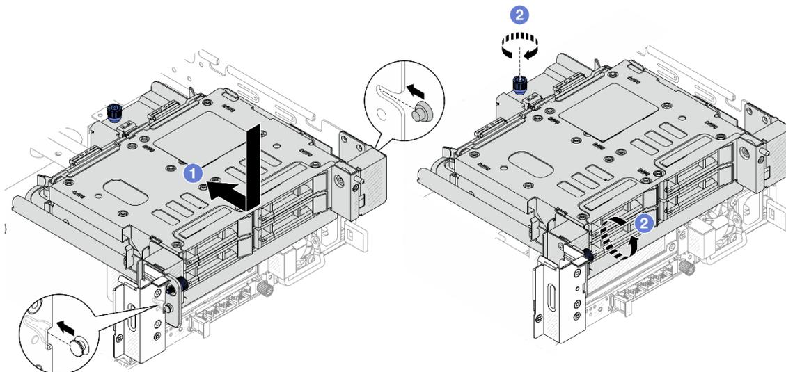
Рис. 261. Установка заднего отсека для четырех 2,5-дюймовых дисков
