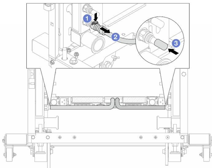
Рис. 159. Отсоединение быстроразъемного соединителя
