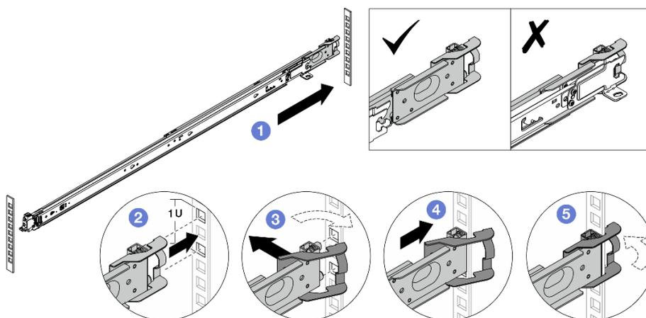
Рис. 17. Установка задних крепежных контактов
