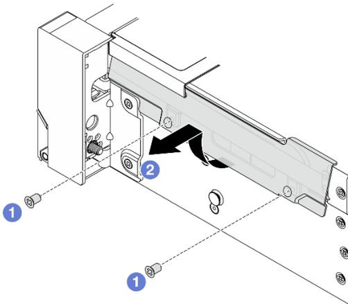
Рис. 230. Снятие фиксатора кабелей
