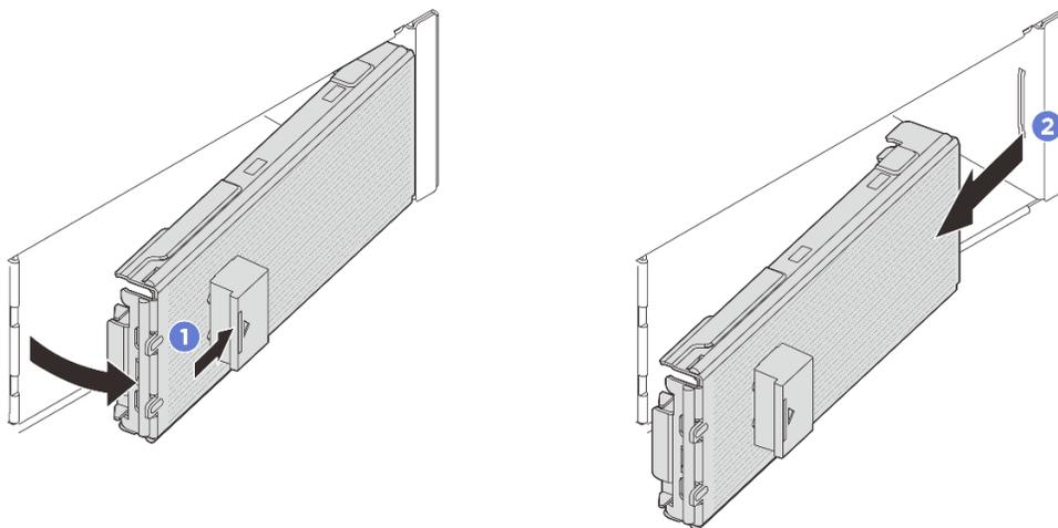
Рис. 64. Снятие панели E3.S
