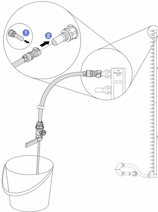
Рис. 164. Установка комплекта отводной трубки на стороне возврата
