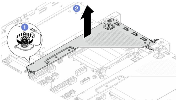
Рис. 295. Снятие блока платы-адаптера Riser
