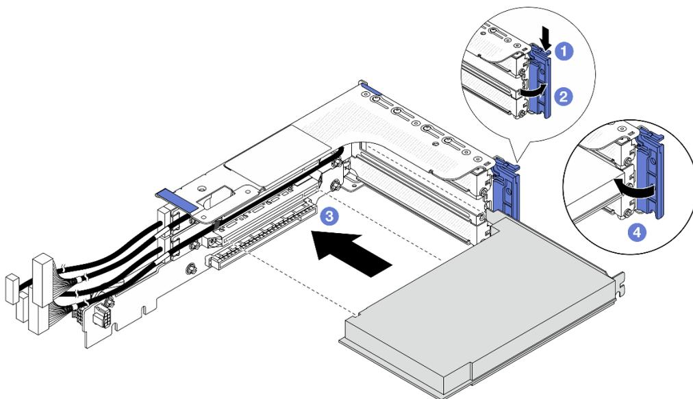
Рис. 285. Установка адаптера PCIe в отсек платы-адаптера Riser 3FH
