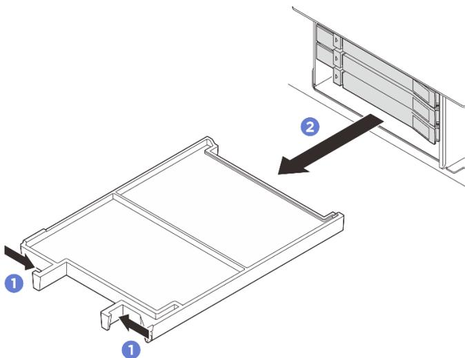
Рис. 67. Снятие заглушки отсека
