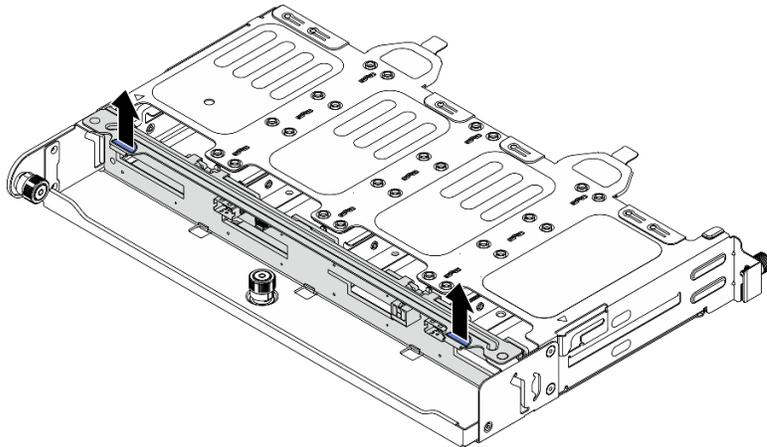
Рис. 263. Снятие задней объединительной панели для восьми 2,5-дюймовых дисков
