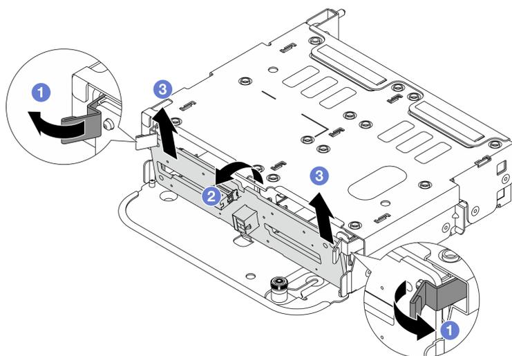
Рис. 253. Снятие задней объединительной панели для четырех 2,5-дюймовых дисков
