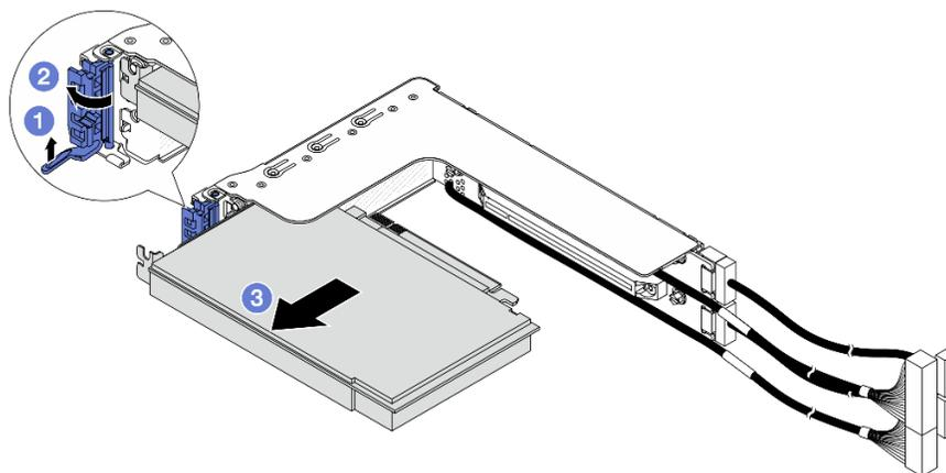
Рис. 280. Снятие адаптера PCIe с отсека платы-адаптера Riser 2FH
