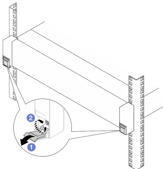
Рис. 27. Фиксация сервера на лицевой стороне стойки
