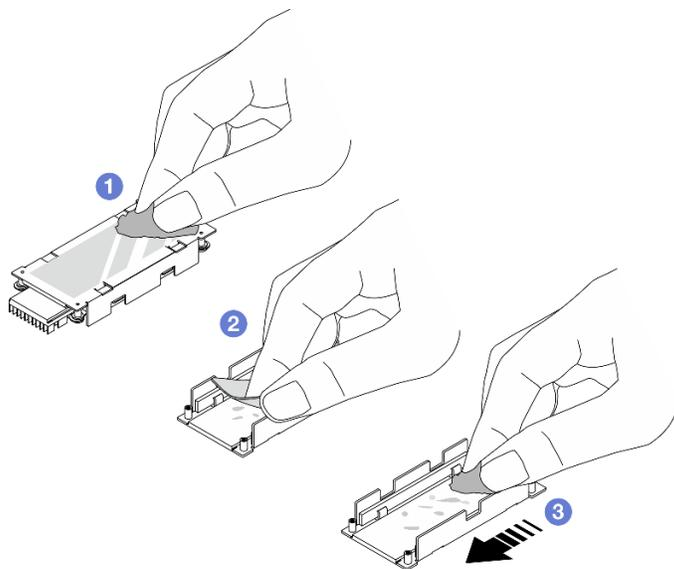
Рис. 126. Очистка радиатора и нижней пластины
