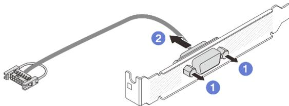
Рис. 297. Разборка модуля последовательного порта
