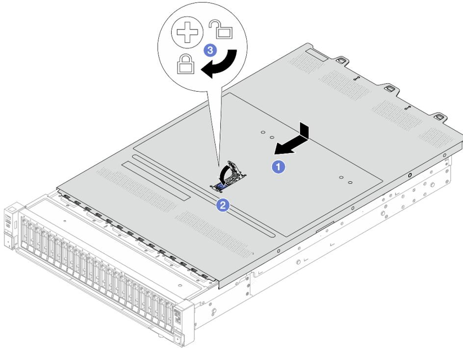
Рис. 315. Установка верхнего кожуха
