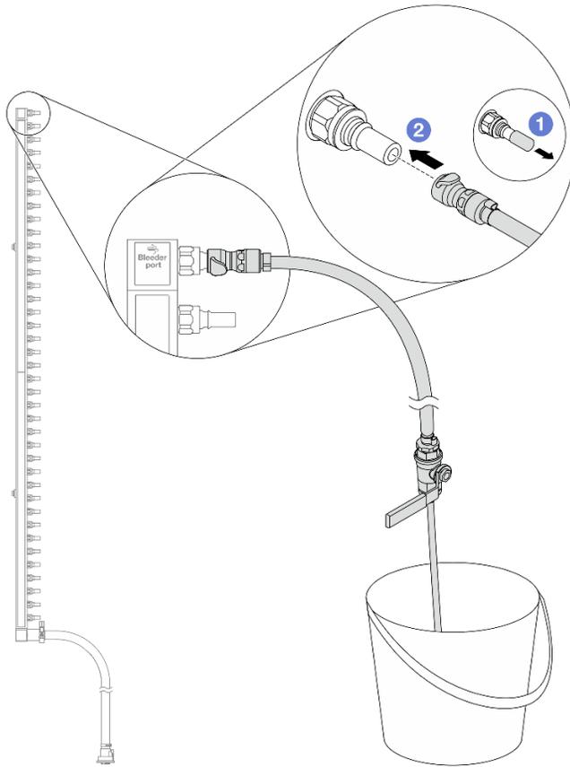
Рис. 184. Установка комплекта отводной трубки на стороне подачи
