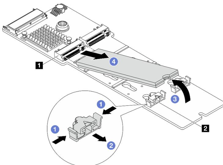
Рис. 88. Снятие диска M.2
