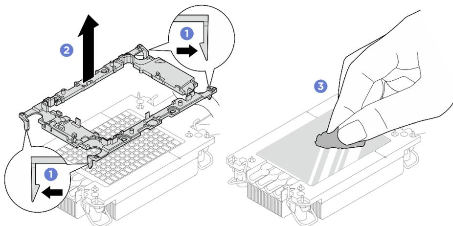
Рис. 222. Снятие держателя процессора с радиатора
