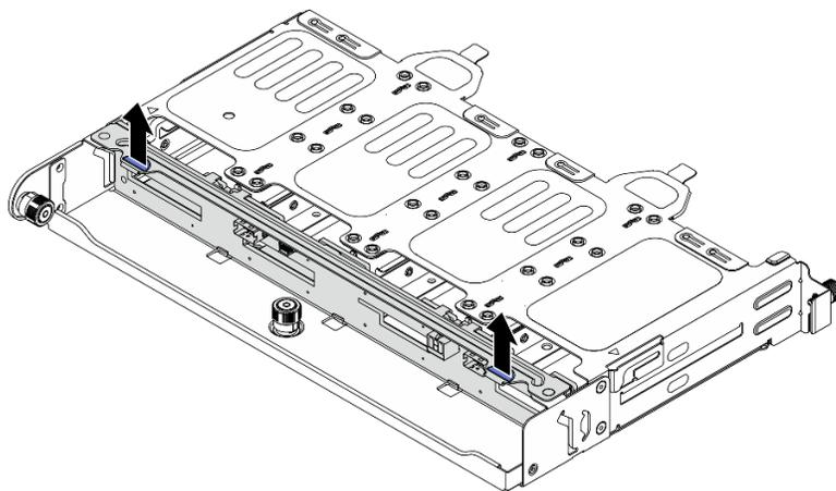
Рис. 254. Снятие задней объединительной панели для восьми 2,5-дюймовых дисков
