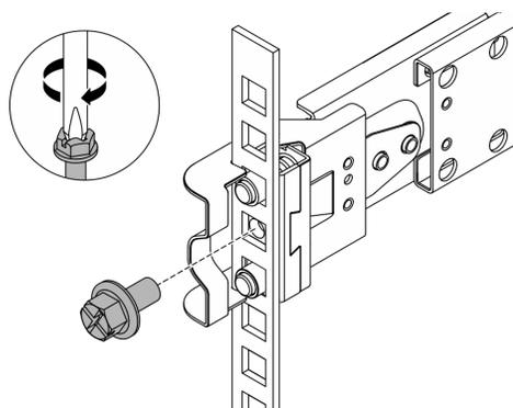
Рис. 28. Фиксация сервера на задней стороне стойки
