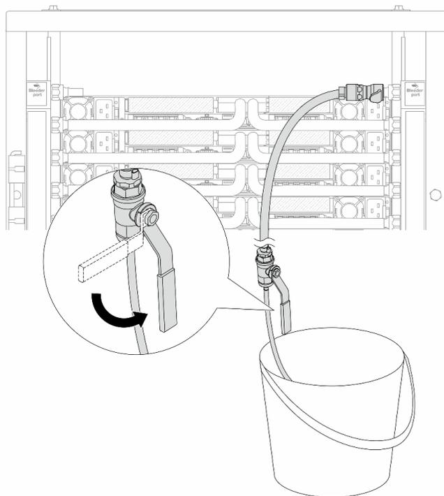
Рис. 179. Открытие клапана отводной трубки на стороне возврата
