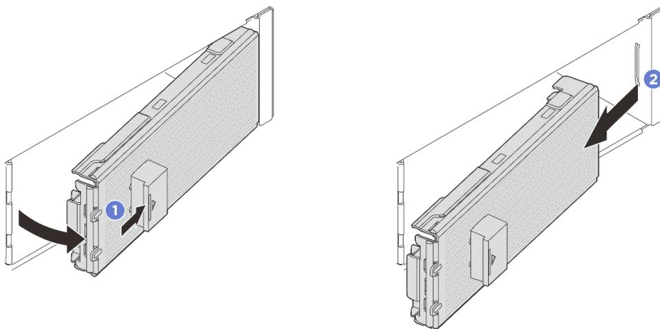
Рис. 66. Снятие панели E3.S
