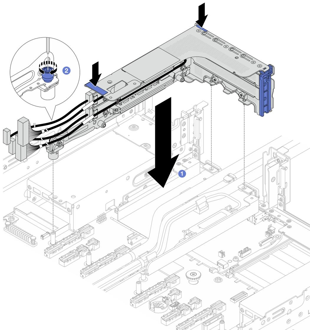
Рис. 117. Установка отсека платы-адаптера Riser 3FH
