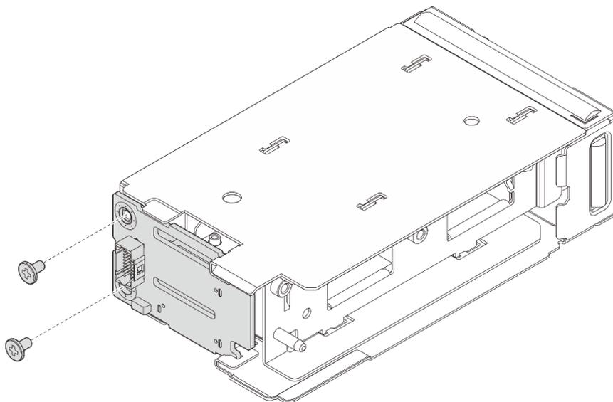
Рис. 136. Снятие передней объединительной панели загрузки M.2
