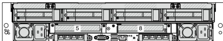
Рис. 5. Вид сзади с двумя гнездами PCIe
