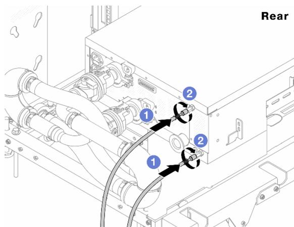
Рис. 173. Задняя сторона блока CDU
