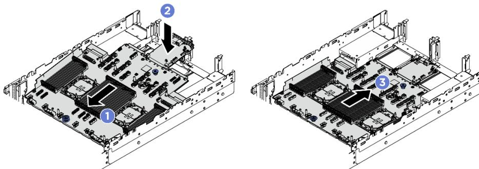
Рис. 309. Установка блока материнской платы
