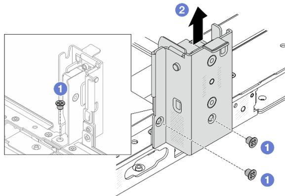
Рис. 248. Снятие средней скобы задней стенки
