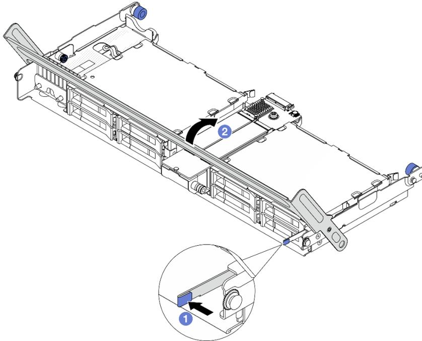
Рис. 98. Закрытие ручки среднего отсека для дисков
