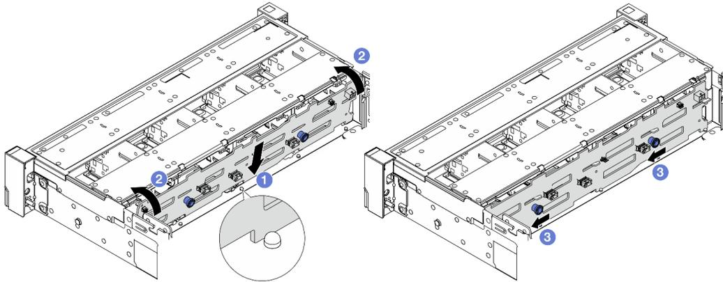
Рис. 79. Установка передней объединительной панели для 3,5-дюймовых дисков
