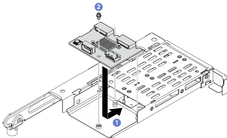
Рис. 149. Установка объединительной панели M.2 в отсек платы-адаптера Riser 1FH M.2
