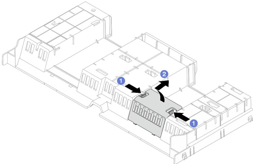
Рис. 43. Снятие заглушки дефлектора
