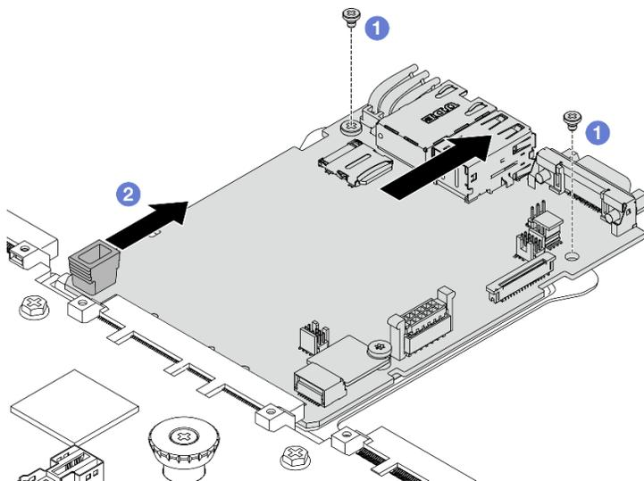
Рис. 303. Снятие системной платы ввода-вывода с процессорной платы
