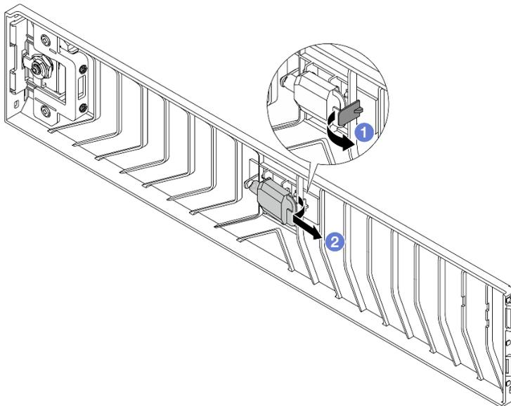
Рис. 292. Снятие ключа
