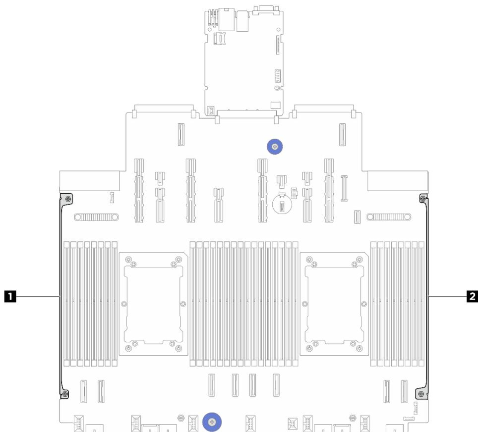
Рис. 46. Расположение стенок для кабелей
