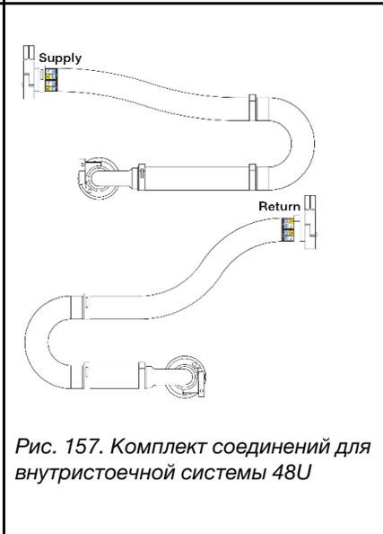
Рис. 157. Комплект соединений для внутривыставочной системы 48U
