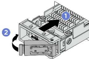
Рис. 122. Установка блока дисков M.2
