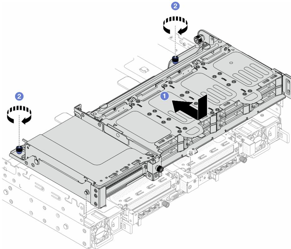
Рис. 266. Установка заднего отсека для восьми 2,5-дюймовых дисков
