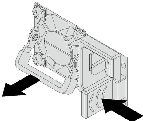
Рис. 211. Снятие оперативно заменяемого модуля блока питания
