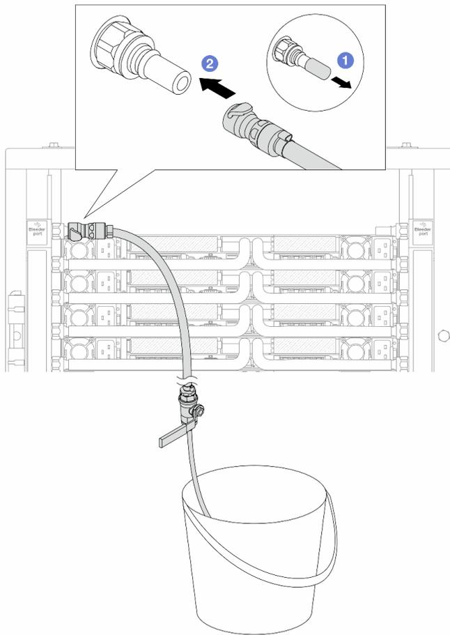
Рис. 175. Установка комплекта отводной трубки на стороне подачи
