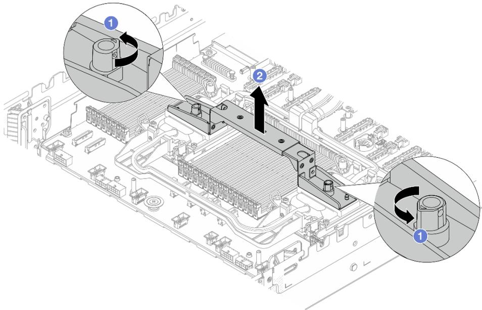
Рис. 112. Снятие ручки модуля
