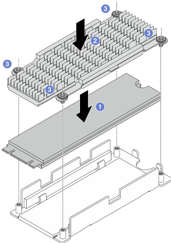
Рис. 128. Установка диска M.2
