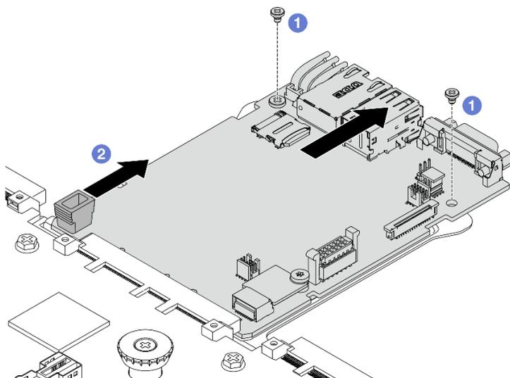
Рис. 307. Снятие системной платы ввода-вывода с процессорной платы
