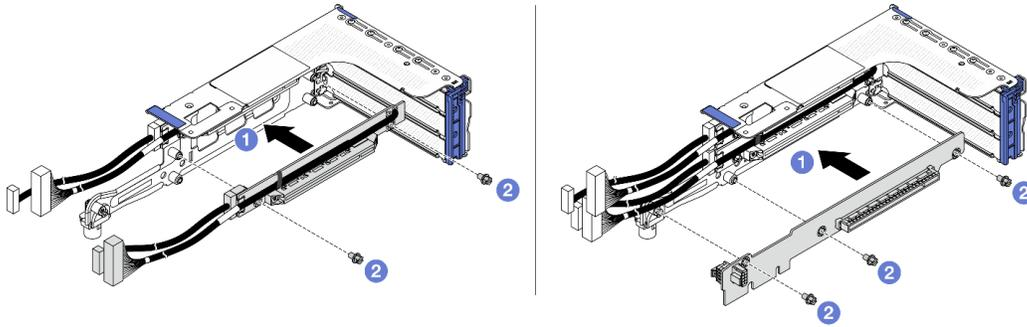
Рис. 283. Установка плат-адаптеров Riser в отсек платы-адаптера 3FH
