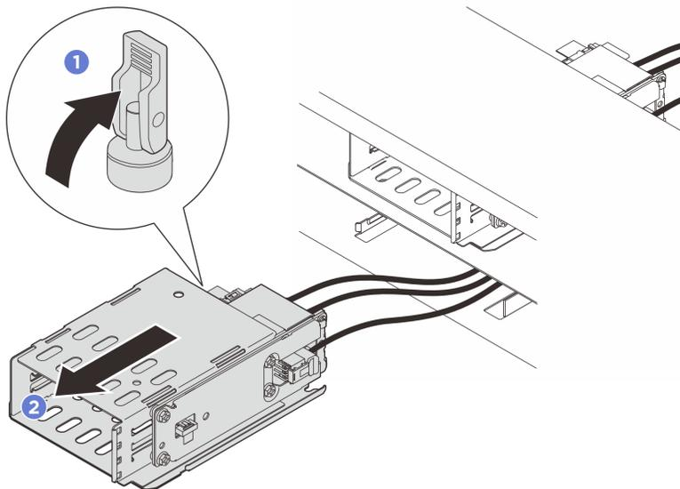
Рис. 72. Снятие отсека E3.S 1T
