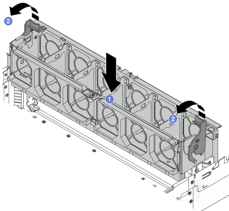
Рис. 313. Установка отсека вентиляторов компьютера
