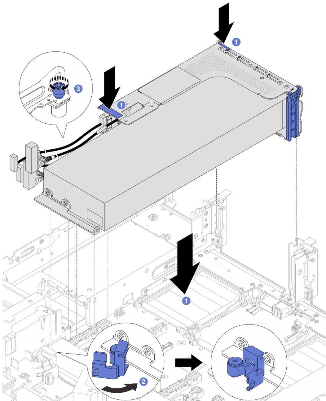
Рис. 83. Установка блока платы-адаптера Riser с адаптером графического процессора
