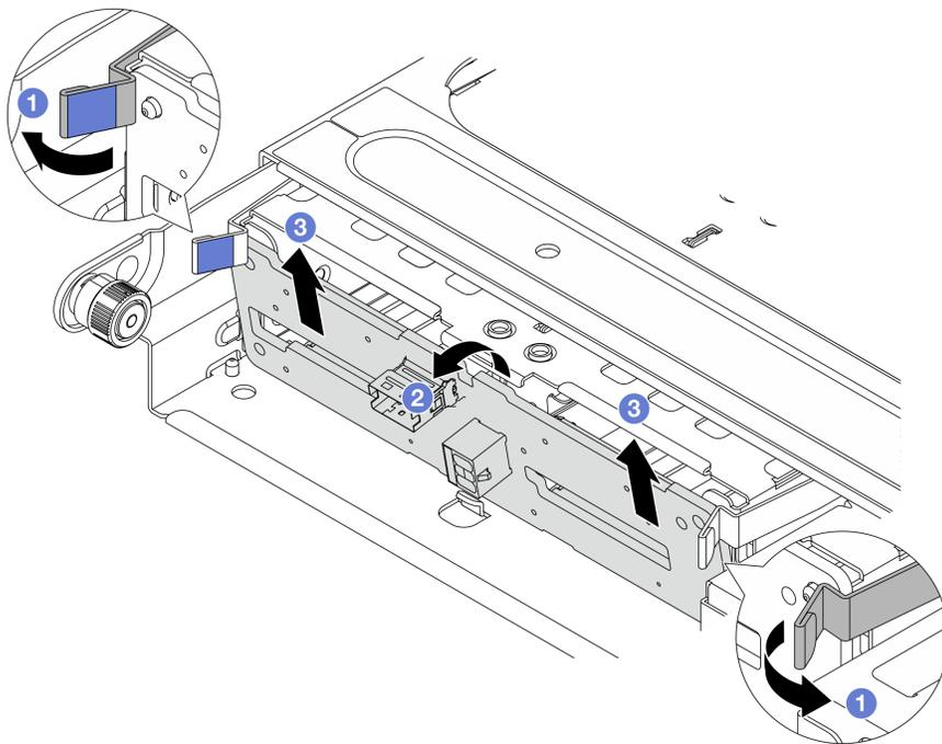
Рис. 205. Снятие средней объединительной панели для 2,5-дюймовых дисков
