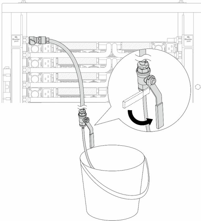
*Рис. 177. Открытие клапана отводной трубки на стороне подачи*
