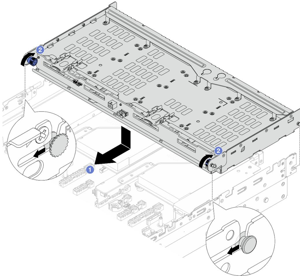
Рис. 270. Установка заднего отсека для четырех 3,5-дюймовых дисков
