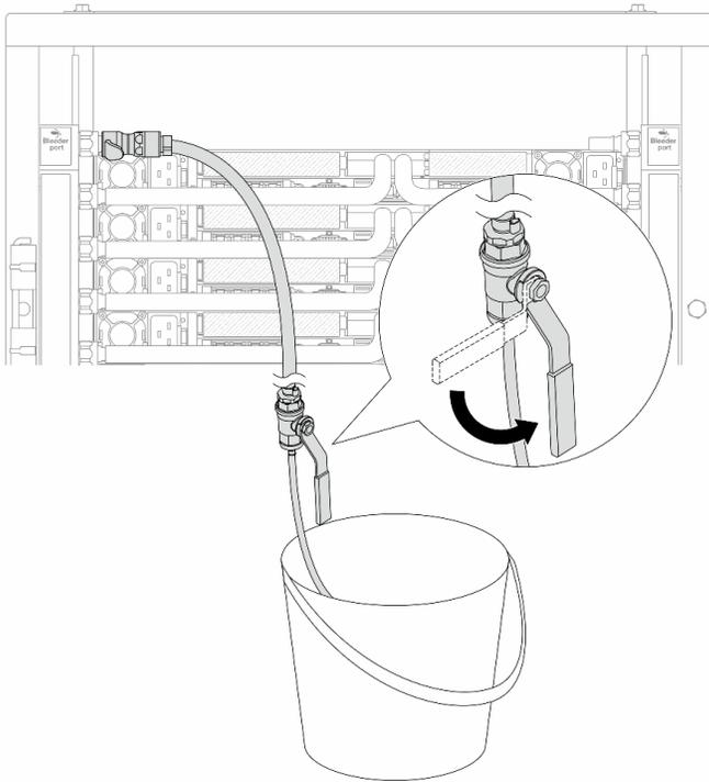
Рис. 198. Открытие клапана отводной трубы на стороне подачи
