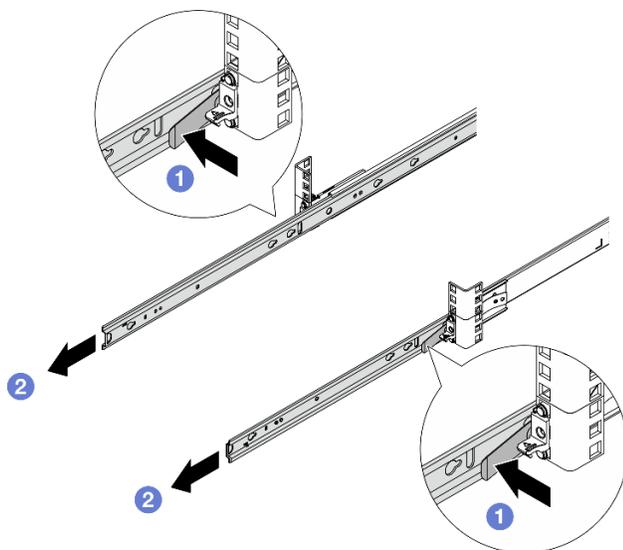
Рис. 23. Снятие внутренних направляющих
