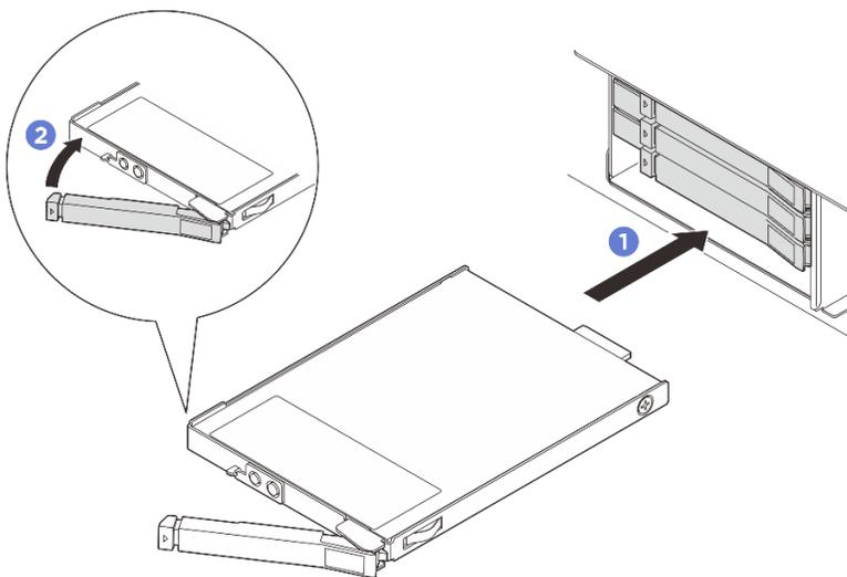
Рис. 68. Установка оперативно заменяемого диска E3.S
