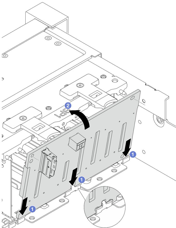
Рис. 78. Установка передней объединительной панели для 2,5-дюймовых дисков
