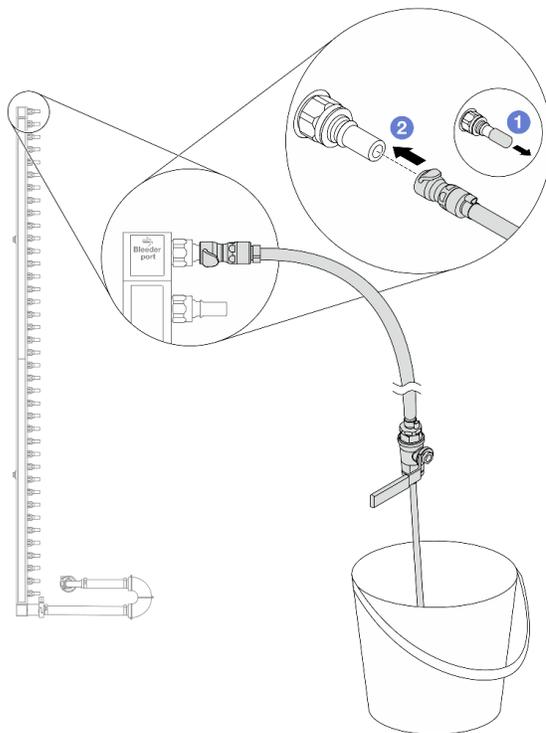
Рис. 162. Установка комплекта отводной трубки на стороне подачи
