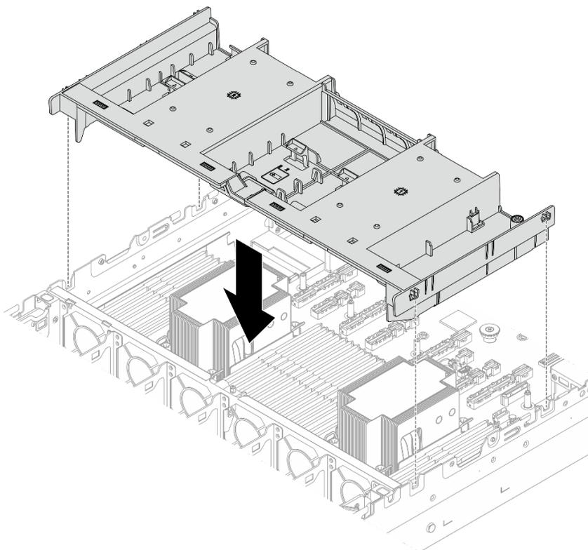
Рис. 45. Установка дефлектора
