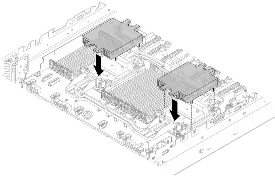
Рис. 113. Установка кожухов плат охлаждения
