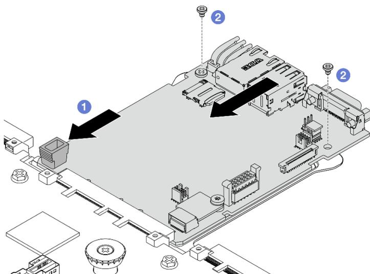
Рис. 304. Установка системной платы ввода-вывода на процессорную плату
