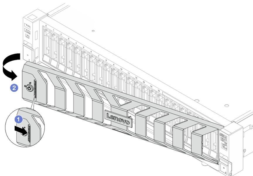
Рис. 291. Снятие защитной панели
