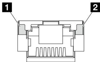
Рис. 325. Светодиодные индикаторы на Порт управления системой ХСС (10/100/1000 Мбит/с)
