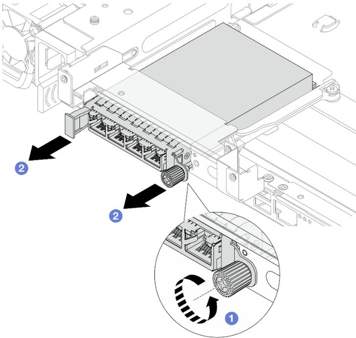
Рис. 272. Снятие заднего модуля OCP
