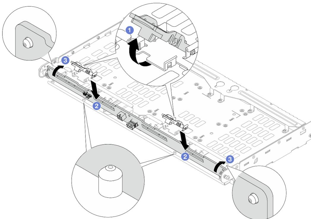
Рис. 258. Установка задней объединительной панели для четырех 3,5-дюймовых дисков
