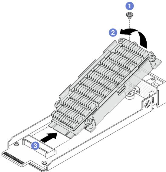
Рис. 123. Снятие диска M.2 с радиатором
