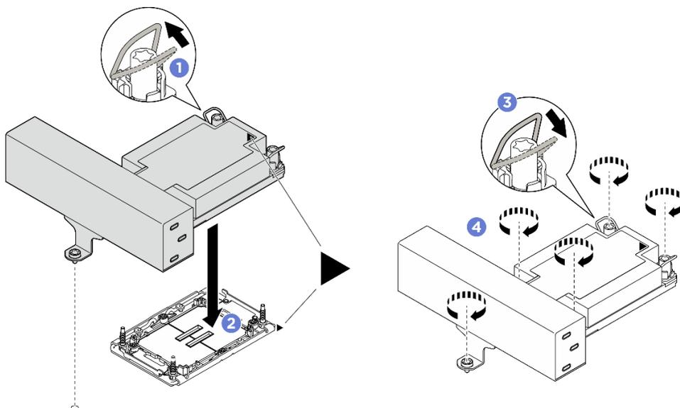
Рис. 229. Установка T-образного PNM 1U повышенной мощности
