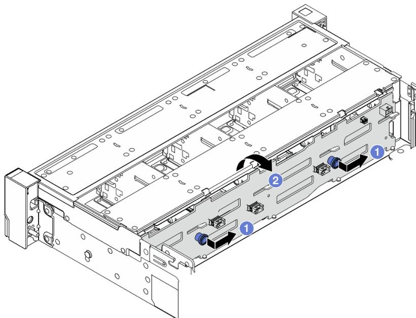
Рис. 77. Снятие передней объединительной панели для 3,5-дюймовых дисков
