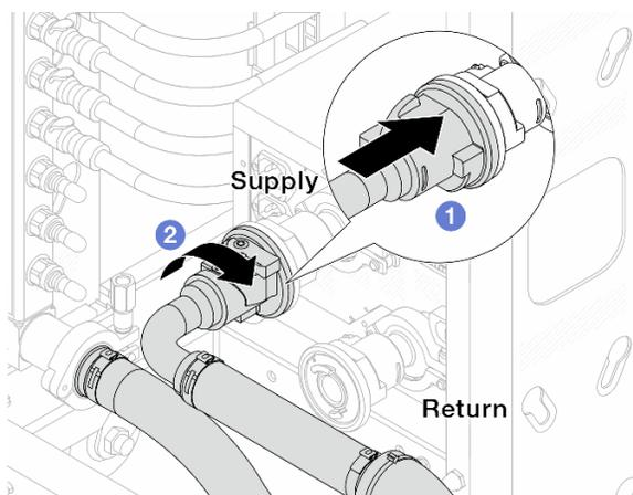
Рис. 171. Подключение шаровых клапанов
