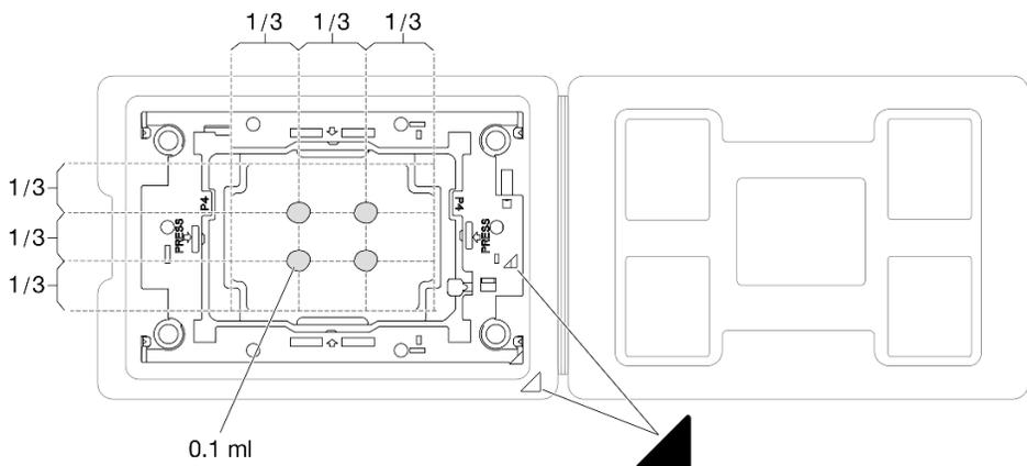
Рис. 225. Нанесение термопасты на процессор в транспортировочном лотке
