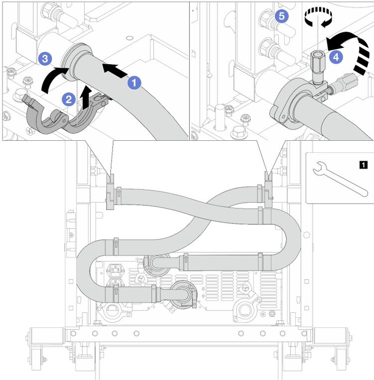
Рис. 170. Установка комплекта соединений
