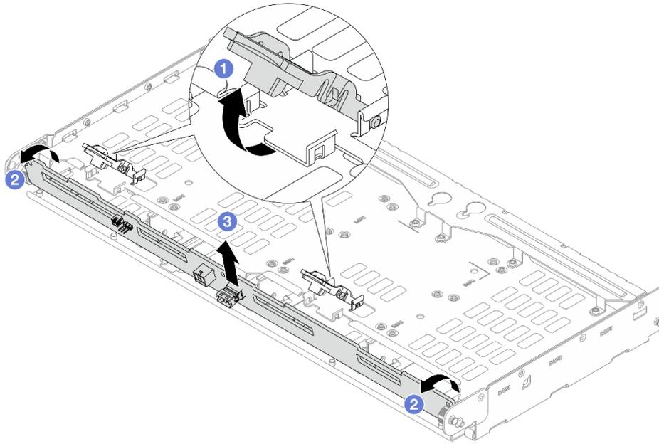
Рис. 255. Снятие задней объединительной панели для четырех 3,5-дюймовых дисков
