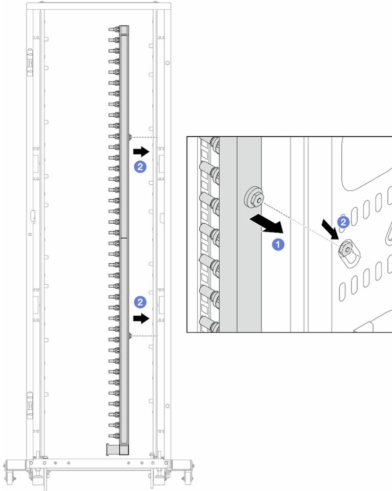
Рис. 167. Установка коллектора
