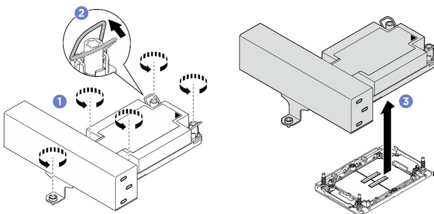
Рис. 219. Снятие T-образного модуля PNM 1U повышенной мощности
