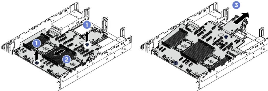
Рис. 306. Снятие блока материнской платы
