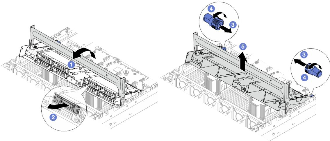
Рис. 204. Снятие среднего отсека для дисков
