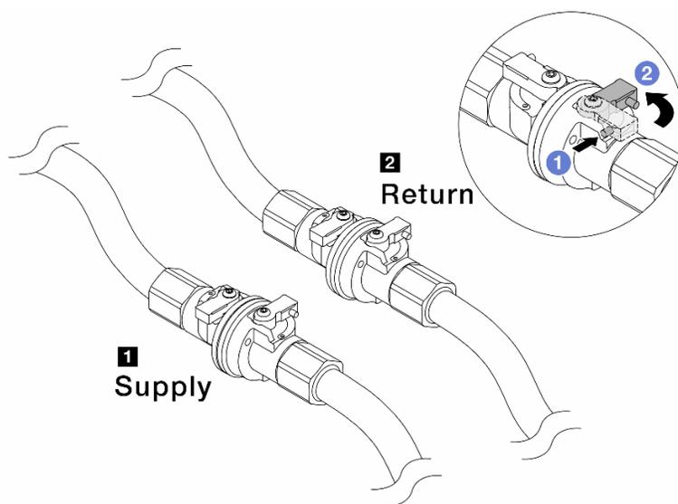
Рис. 181. Закрытие шаровых клапанов
