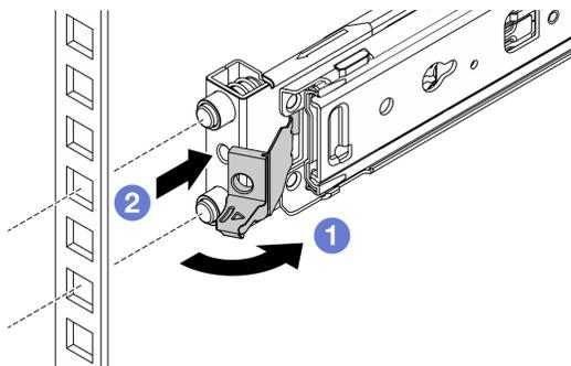
Рис. 13. Снятие направляющей спереди
