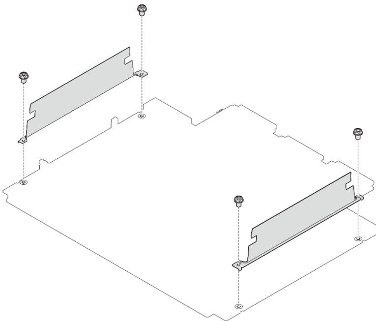
Рис. 47. Снятие стенок для кабелей
