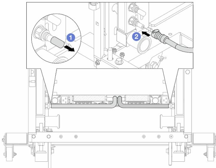
Рис. 190. Установка быстроразъемного соединителя
