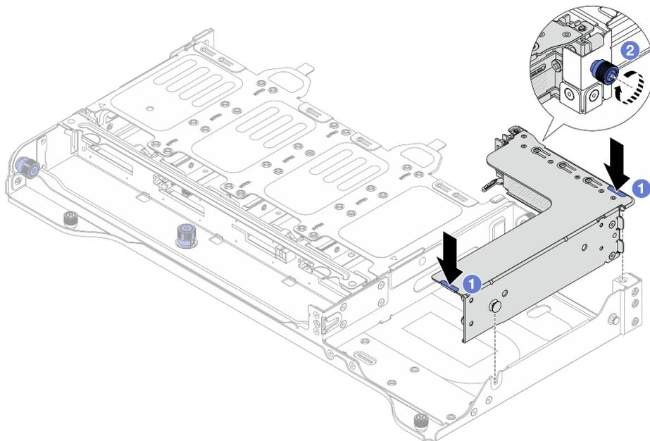
Рис. 289. Установка блока платы-адаптера Riser 2FH
