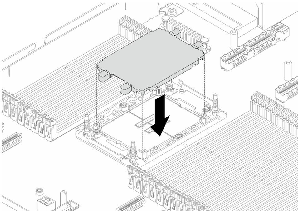
Рис. 110. Установка кожуха гнезда процессора
