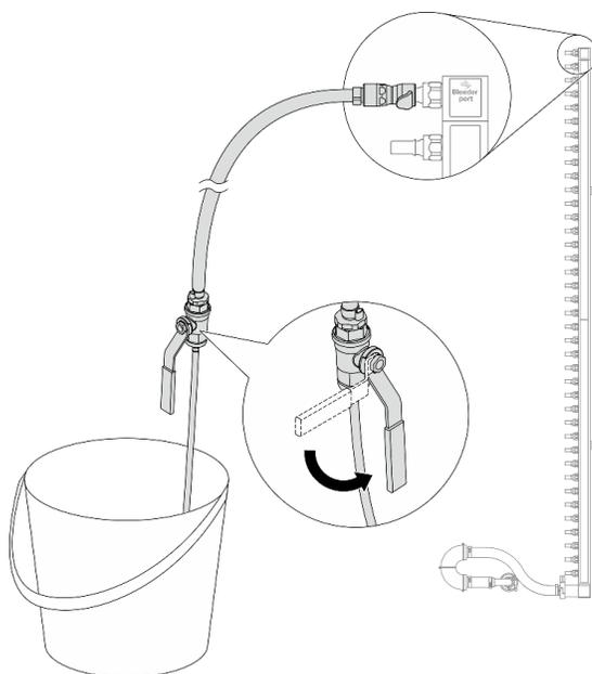
Рис. 165. Открытие клапана отводной трубки
