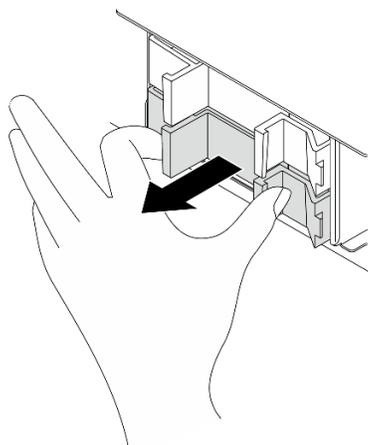
Рис. 55. Снятие заглушки отсека
