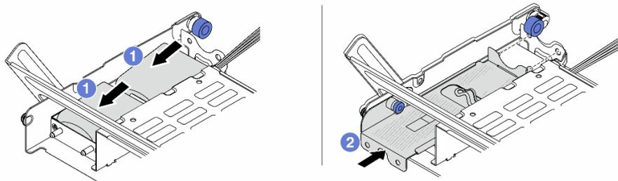
Рис. 244. Установка модуля питания флэш-памяти RAID в средний отсек для дисков
