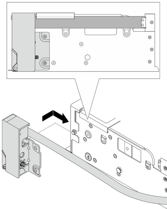
Рис. 233. Установка защелки стойки
