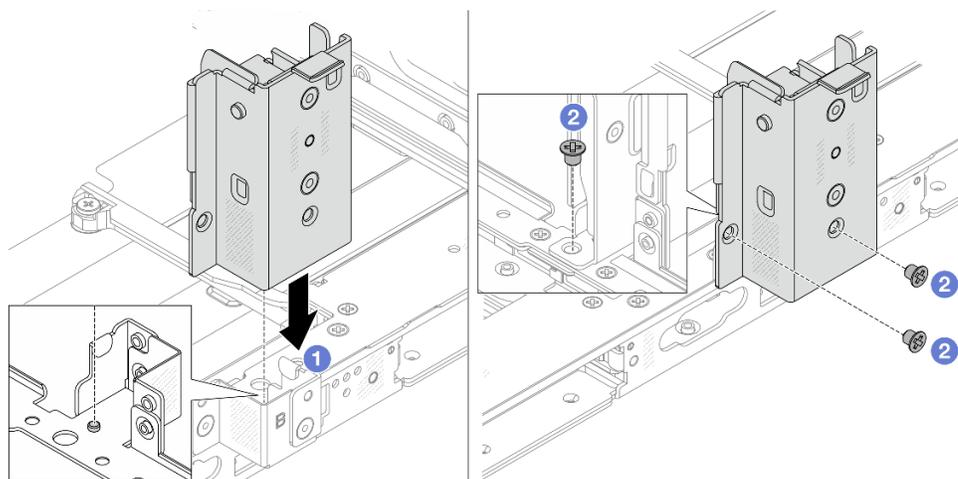
Рис. 251. Установка средней скобы задней стенки
