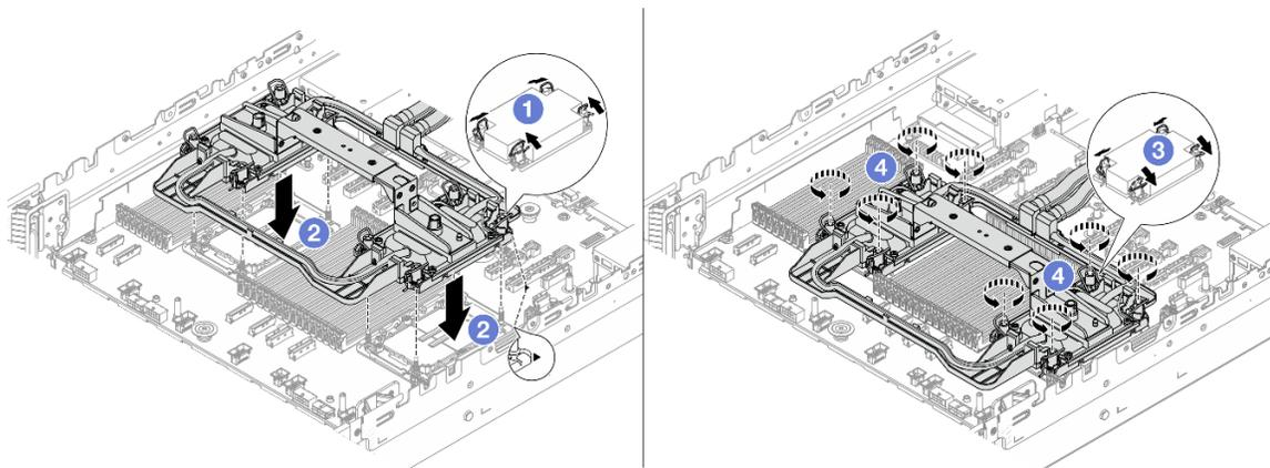
Рис. 111. Установка Processor Neptune Core Module
