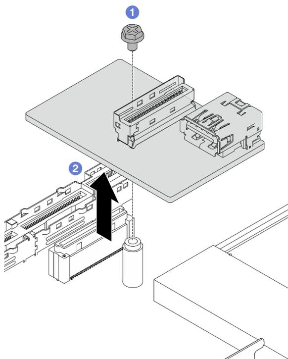
Рис. 316. Снятие платы ввода-вывода USB
