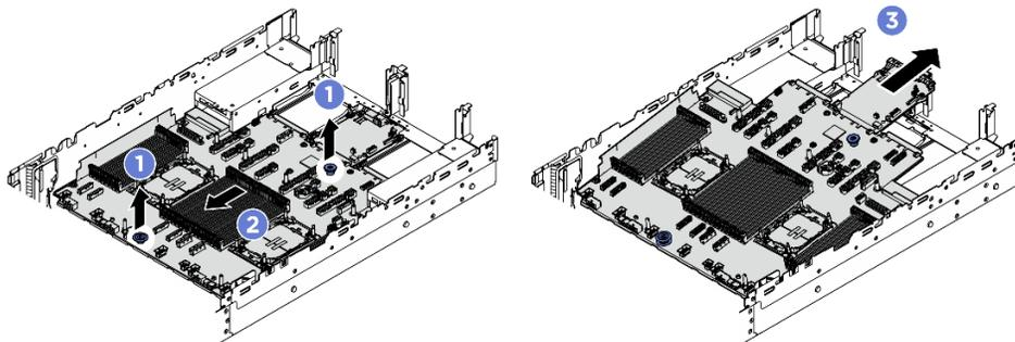
Рис. 302. Снятие блока материнской платы
