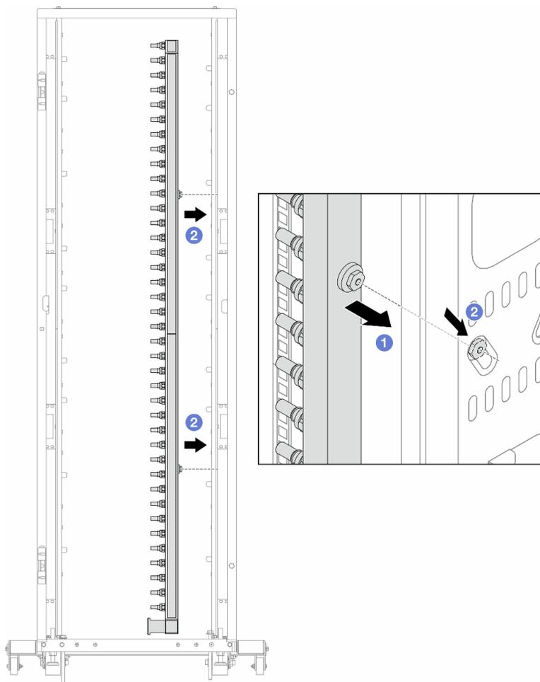
Рис. 189. Установка коллектора
