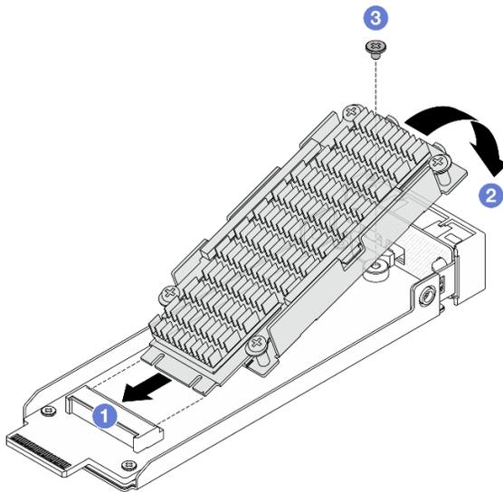
Рис. 130. Установка диска M.2 с радиатором
