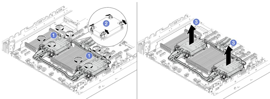
Рис. 106. Снятие Processor Neptune Core Module
