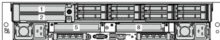
Рис. 4. Вид сзади с четырьмя гнездами PCIe
