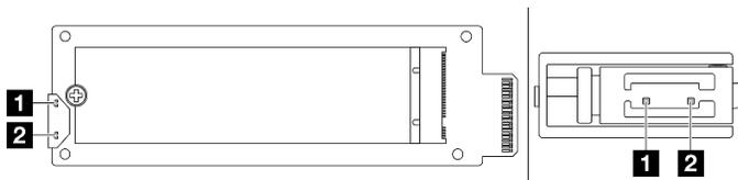
Рис. 329. Светодиодные индикаторы интерпозера M.2
