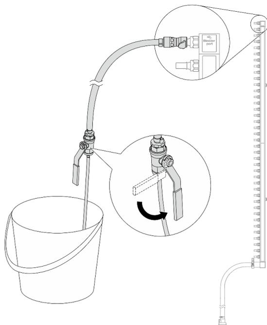
Рис. 187. Открытие клапана отводной трубки
