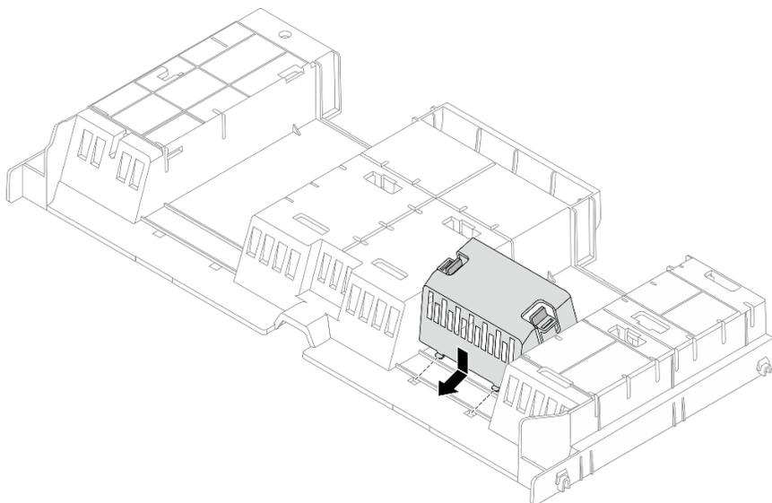
Рис. 44. Установка заглушки дефлектора
