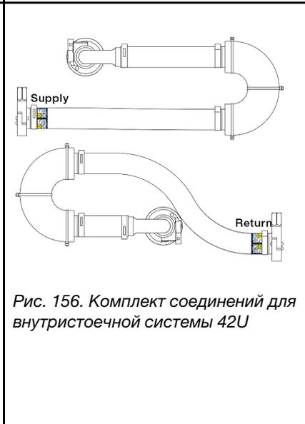
Рис. 156. Комплект соединений для внутривыставочной системы 42U
