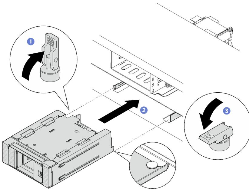
Рис. 144. Установка переднего отсека для дисков M.2 с корпусом
