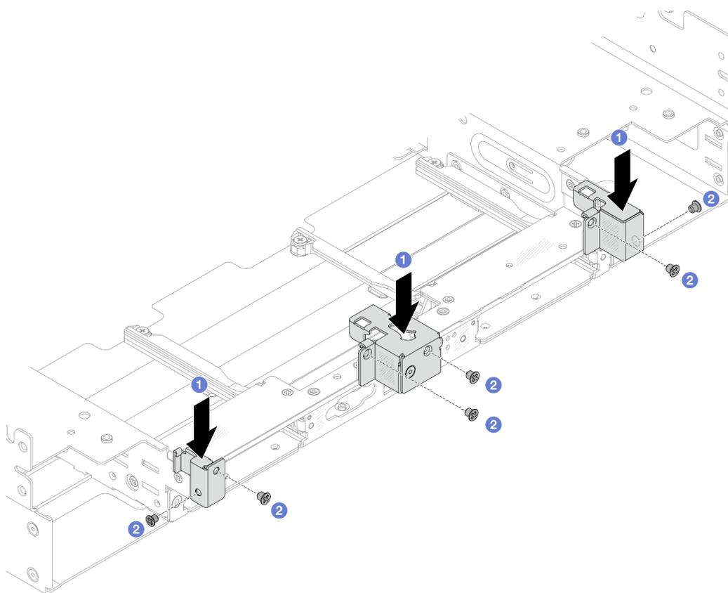
Рис. 264. Установка скоб задней стенки для блока заднего отсека для восьми 2,5-дюймовых дисков
