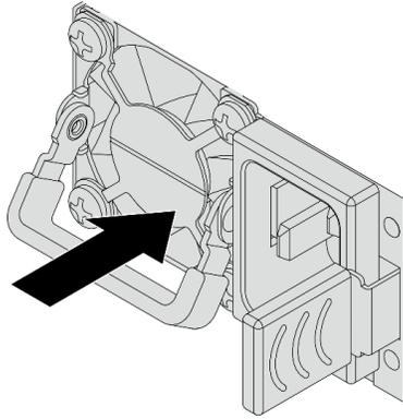
Рис. 215. Установка оперативно заменяемого модуля блока питания
