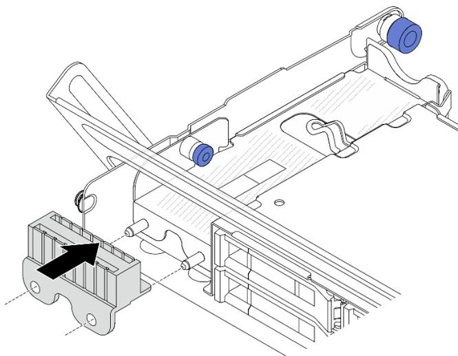
Рис. 245. Установка резины
