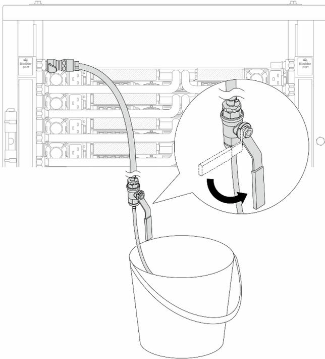
Рис. 180. Открытие клапана отводной трубки на стороне подачи
