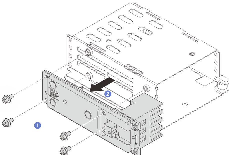
Рис. 73. Снятие блока объединительной панели
