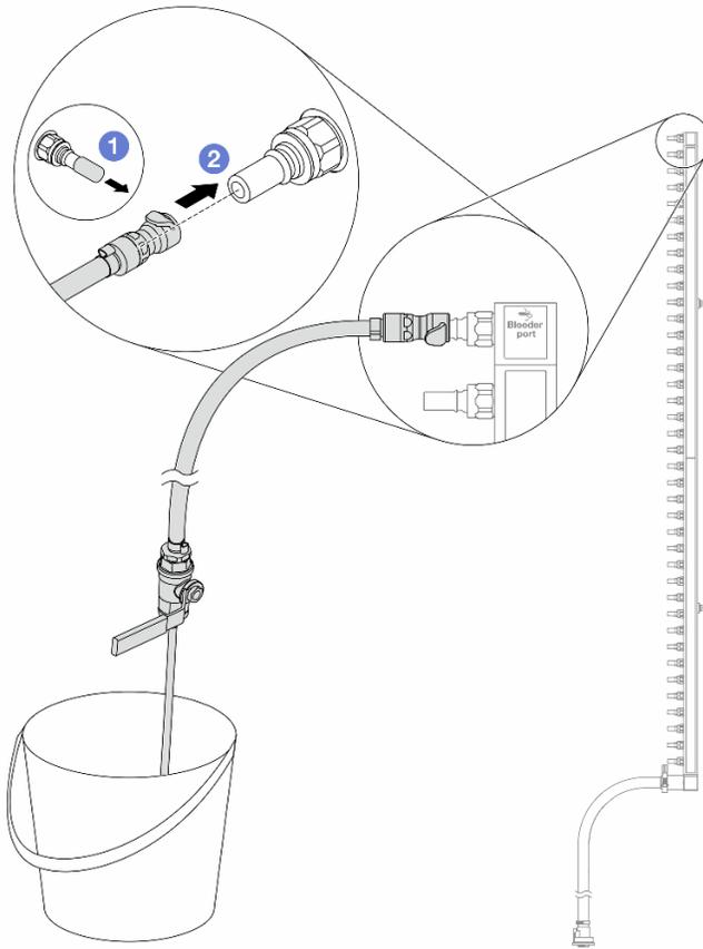
Рис. 186. Установка комплекта отводной трубки на стороне возврата
