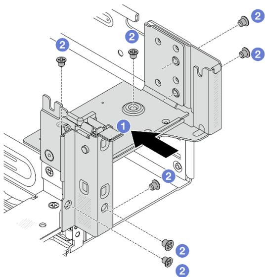
Рис. 252. Установка правой скобы задней стенки
