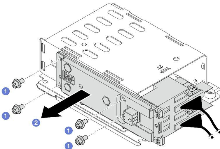
Рис. 61. Снятие объединительной панели
