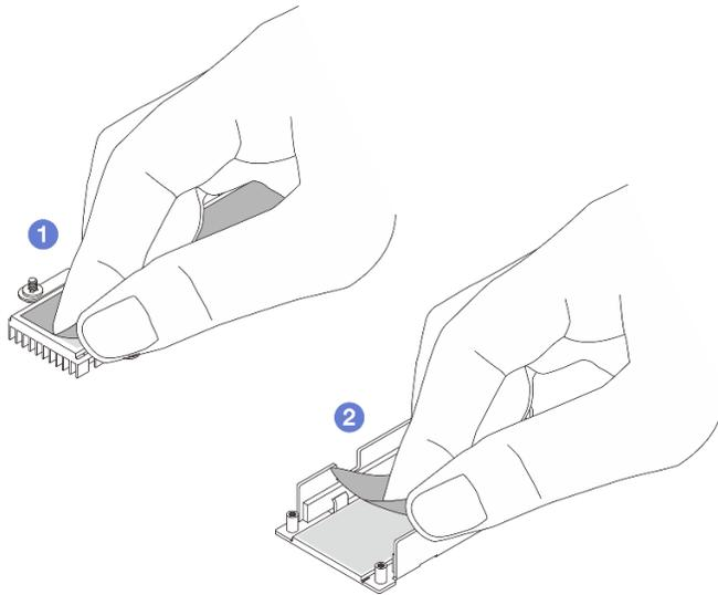
Рис. 127. Снятие пленок
