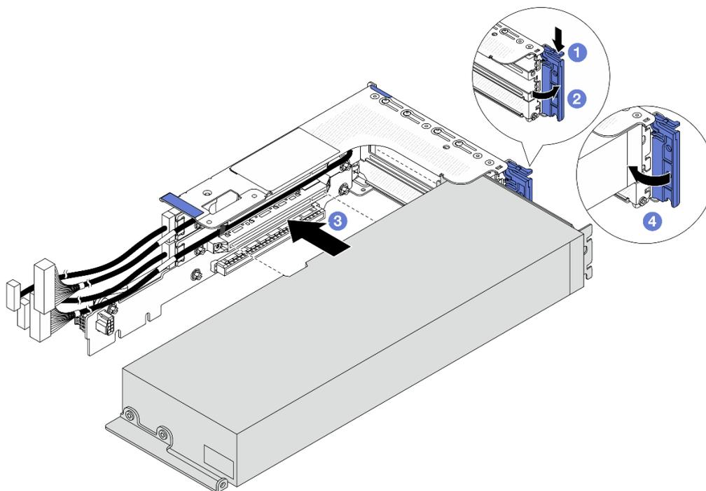
Рис. 82. Установка адаптера графического процессора
