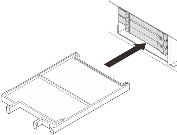
Рис. 69. Установка заглушки отсека
