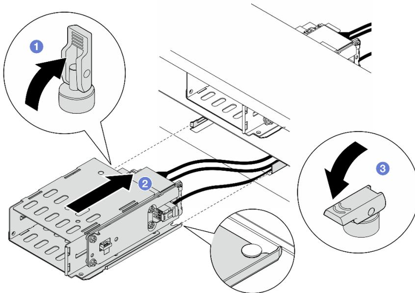
Рис. 63. Установка отсека E3.S 2T
