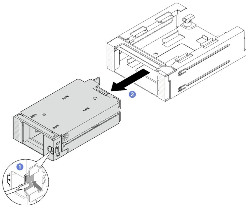
Рис. 134. Снятие переднего отсека для дисков M.2 с корпуса отсека
