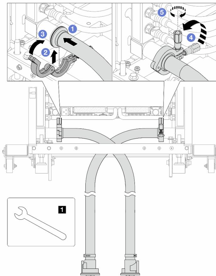
Рис. 191. Установка комплекта шланга
