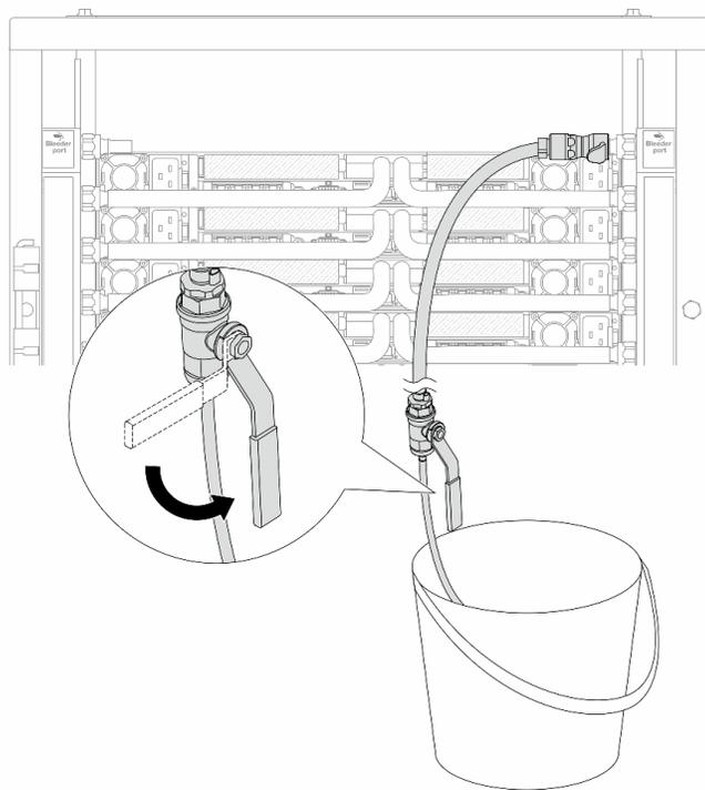
Рис. 197. Открытие клапана отводной трубки на стороне возврата
