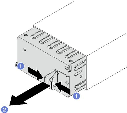
Рис. 214. Снятие заглушки модуля блока питания
