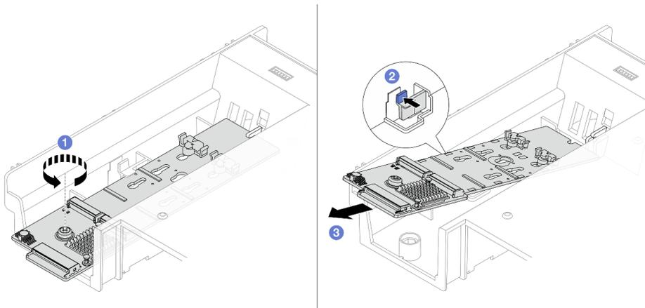
Рис. 93. Снятие объединительной панели M.2 с дефлектора
