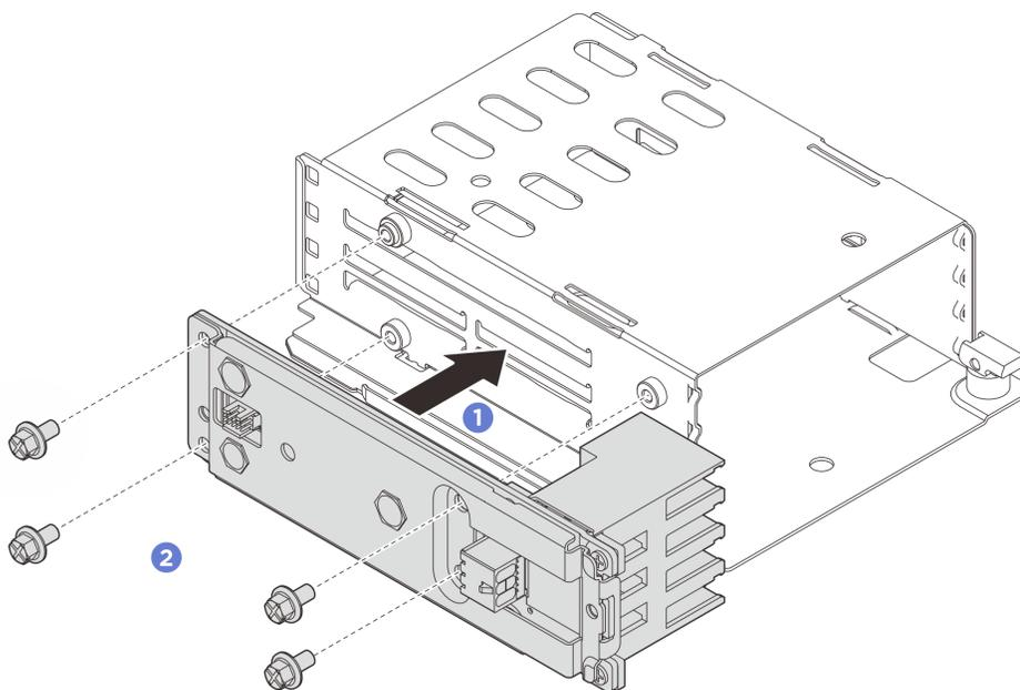
Рис. 74. Установка блока объединительной панели
