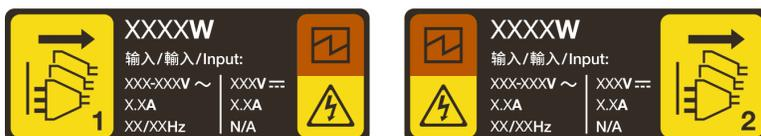
Рис. 213. Пример этикетки модуля блока питания на верхнем кожухе
