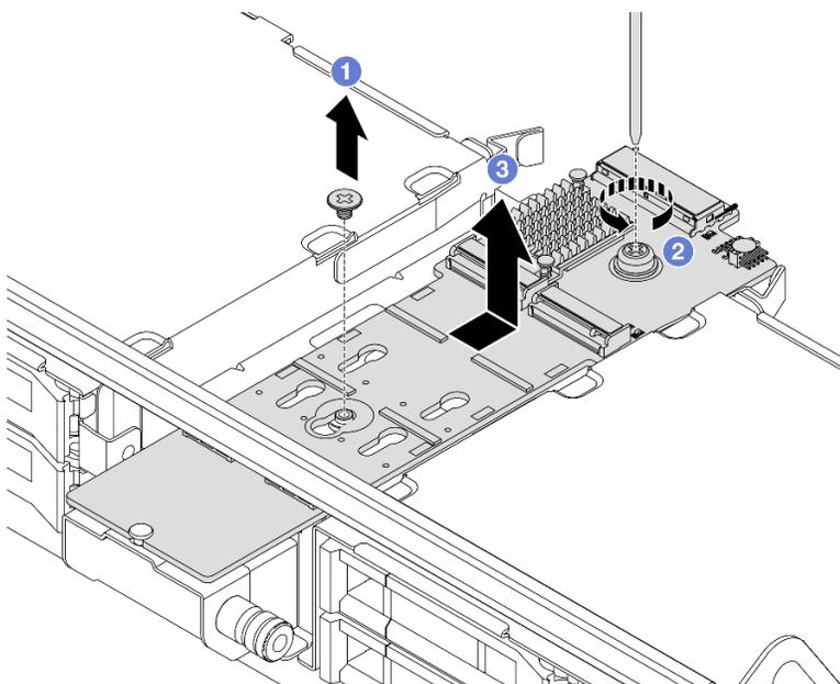
Рис. 95. Снятие объединительной панели M.2 со среднего отсека для дисков
