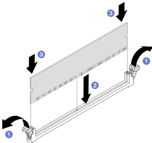
Рис. 201. Установка модуля памяти
