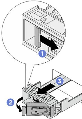
Рис. 121. Снятие лотка для дисков M.2
