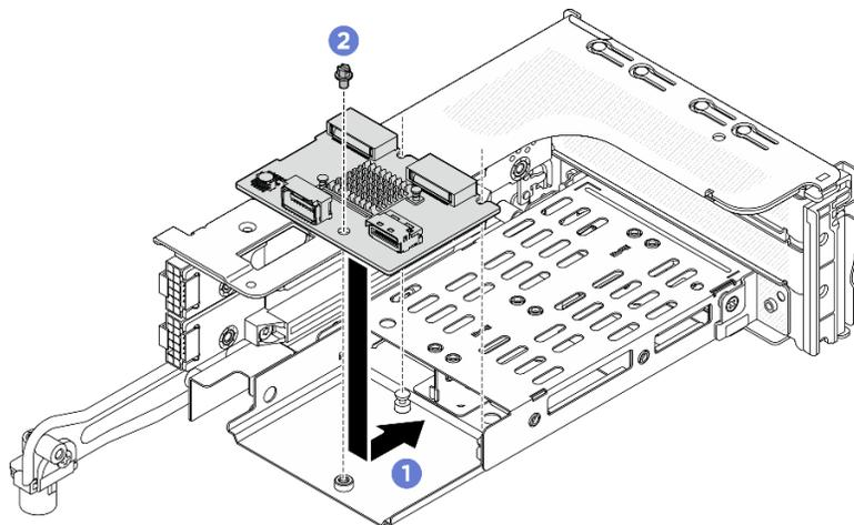
Рис. 148. Установка объединительной панели M.2 в отсек платы-адаптера Riser 3FH M.2
