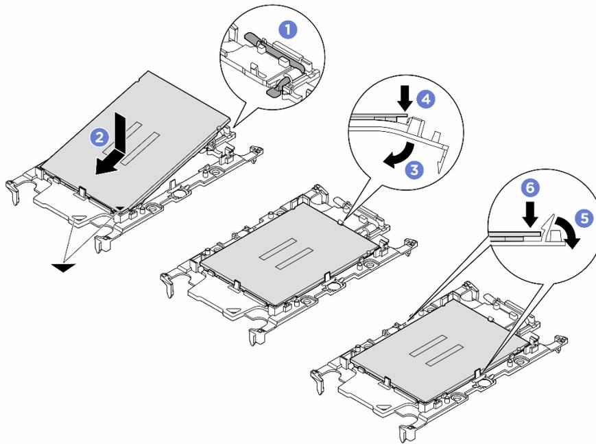
Рис. 224. Установка держателя процессора
