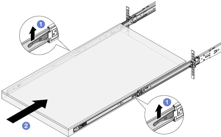
Рис. 37. Блокировка направляющих и установка сервера
