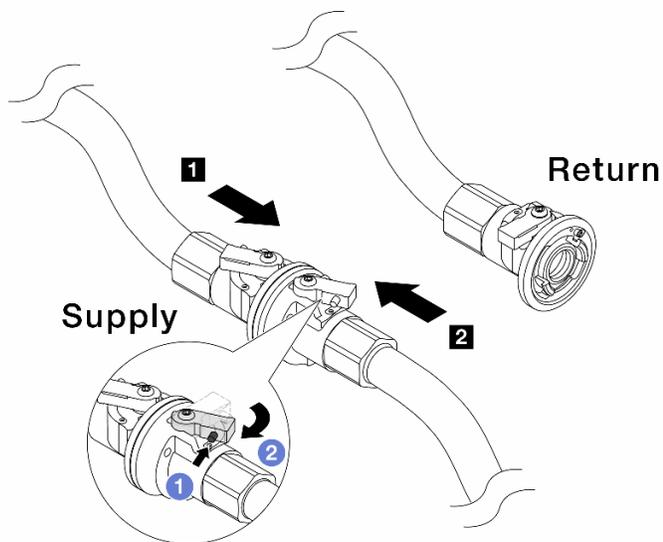
Рис. 196. Подключение разъема на стороне подачи объекта к разъему на стороне подачи коллектора
