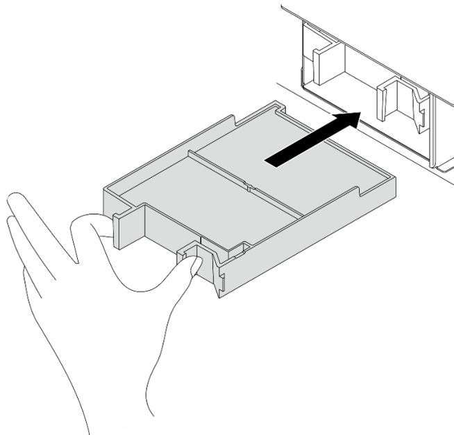
Рис. 53. Установка заглушки отсека CMM
