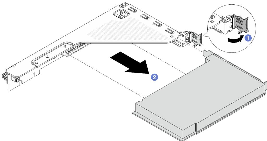
Рис. 281. Снятие адаптера PCIe с отсека платы-адаптера Riser 1FH
