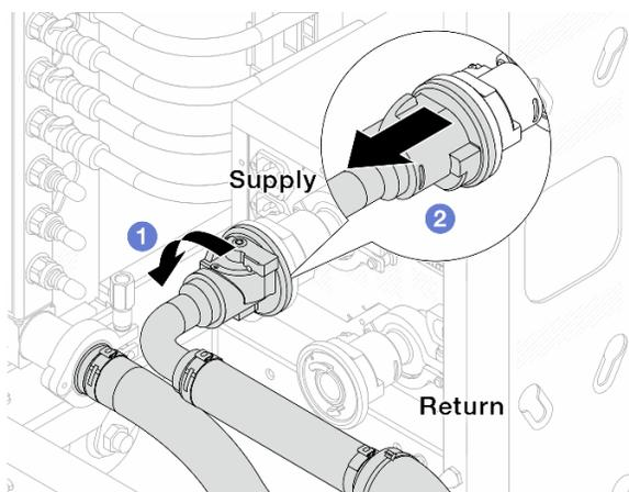
Рис. 160. Снятие комплекта соединений
