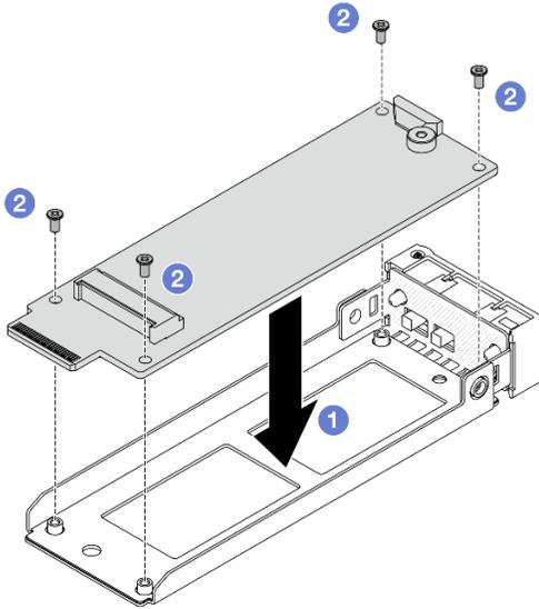
Рис. 129. Установка интерпозера M.2
