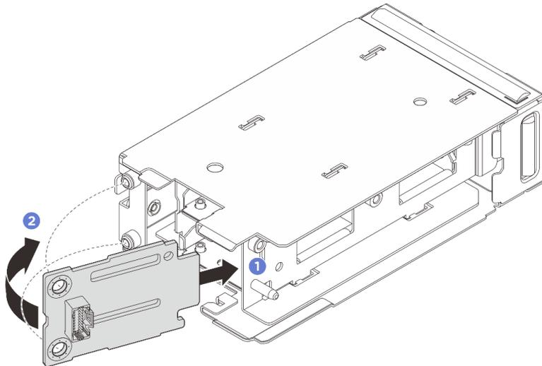
Рис. 139. Установка объединительной панели загрузки M.2
