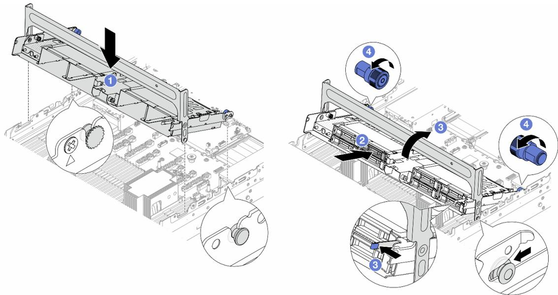
Рис. 208. Установка среднего отсека для диска и дисков
