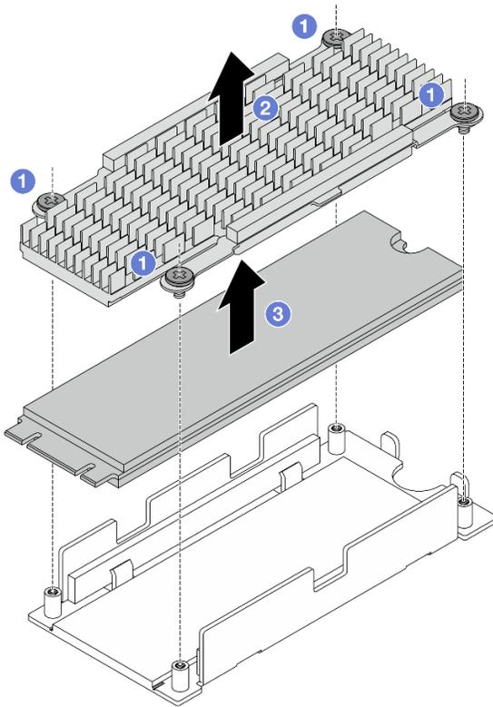
Рис. 125. Снятие диска M.2
