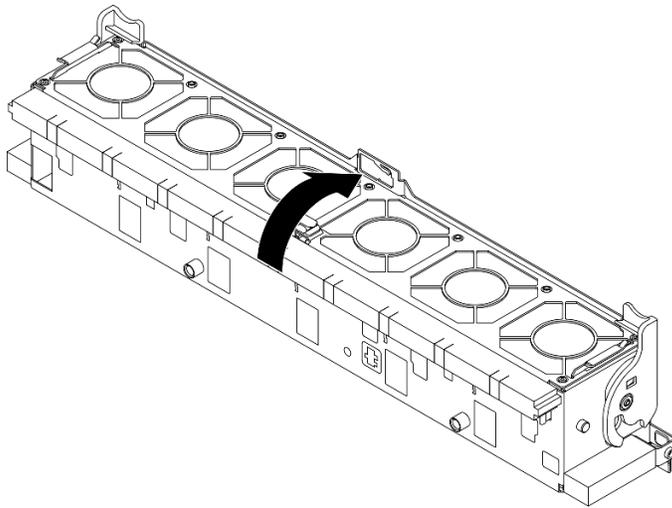
Рис. 100. Поворот отсека вентиляторов
