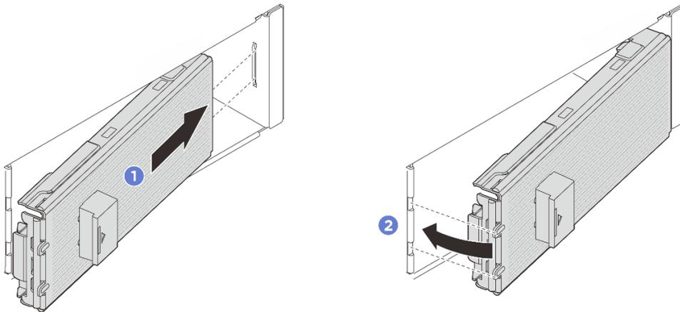
Рис. 59. Установка панели E3.S
