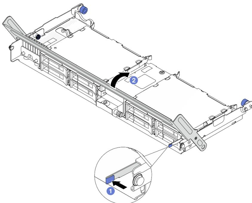
Рис. 246. Закрытие ручки отсека для диска
