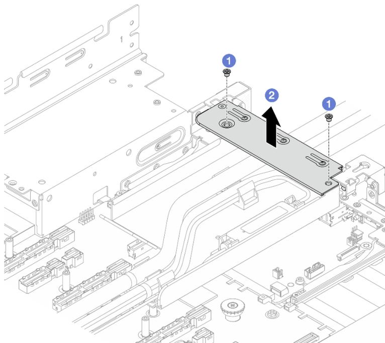
Рис. 103. Снятие скобы 1FH
