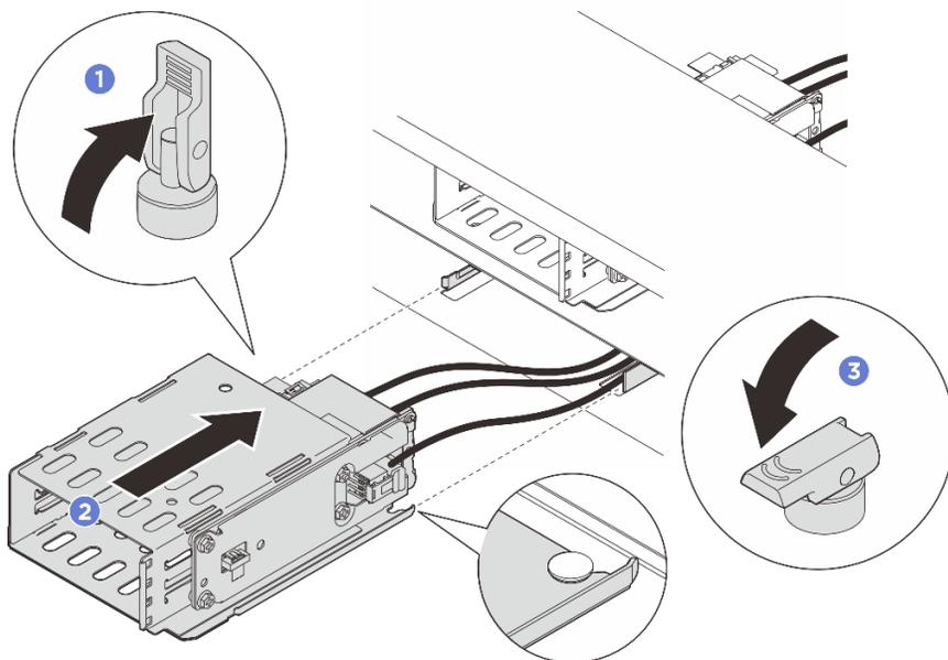
Рис. 75. Установка отсека E3.S 1T
