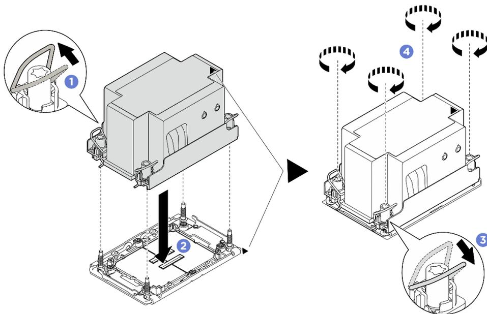
Рис. 228. Установка стандартного PNM 2U
