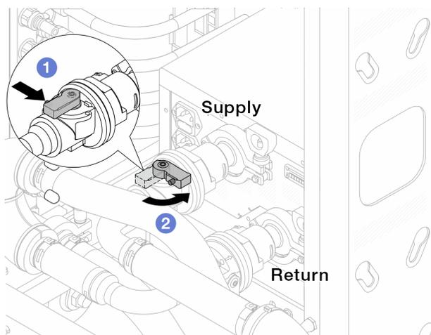
Рис. 158. Закрытие шаровых клапанов
