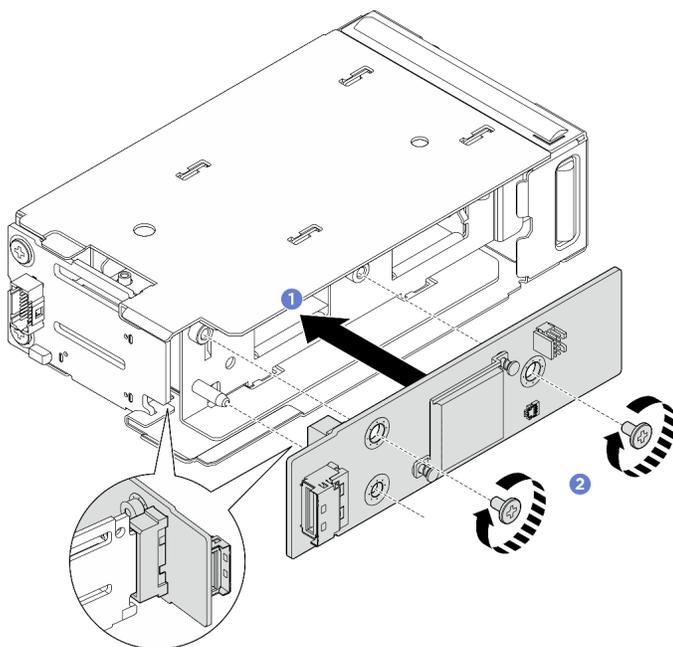
Рис. 141. Установка передней платы контроллера M.2
