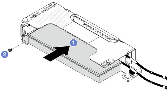
Рис. 284. Установка адаптера PCIe в отсек платы-адаптера Riser 2LP
