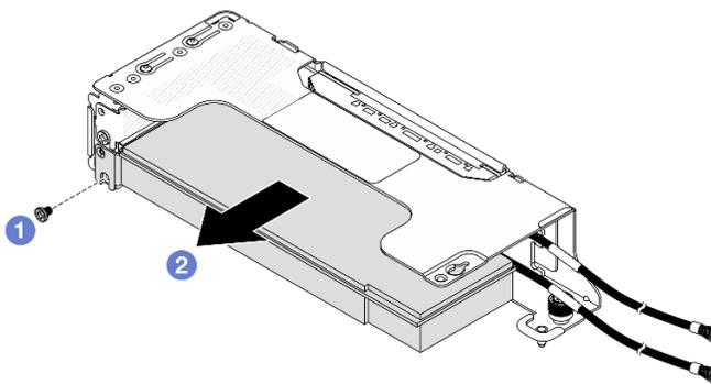
Рис. 278. Снятие адаптера PCIe с отсека платы-адаптера Riser 2LP
