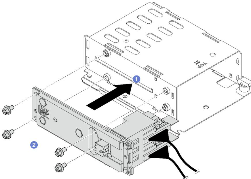
Рис. 62. Установка объединительной панели
