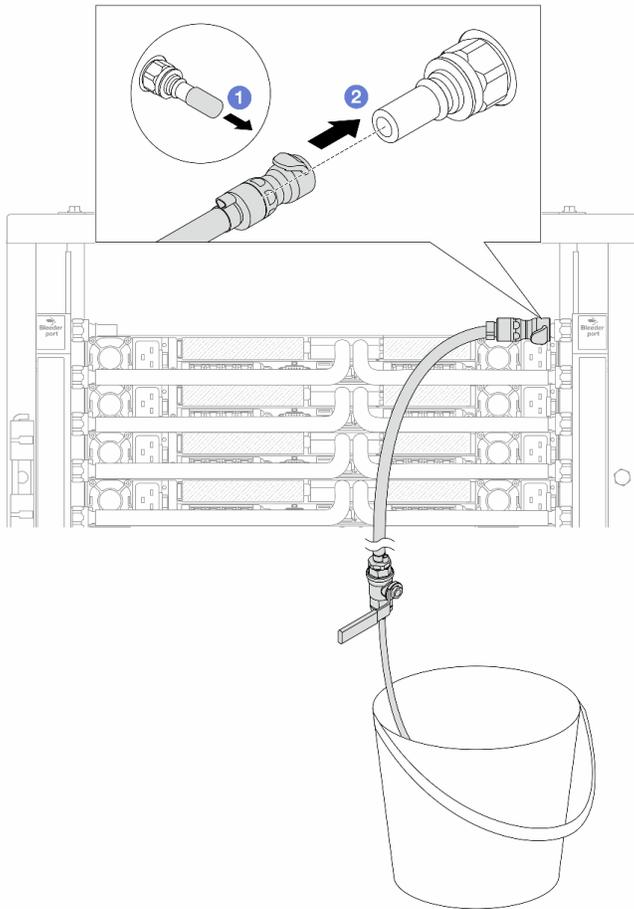
Рис. 178. Установка комплекта отводной трубки на стороне возврата
