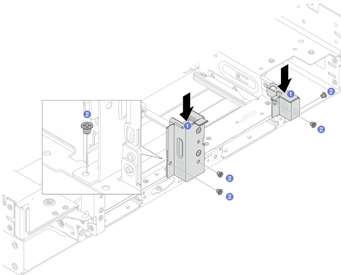
Рис. 260. Установка скоб задней стенки для заднего отсека для четырех 2,5-дюймовых дисков
