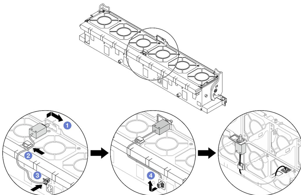
Рис. 102. Установка датчика вмешательства
