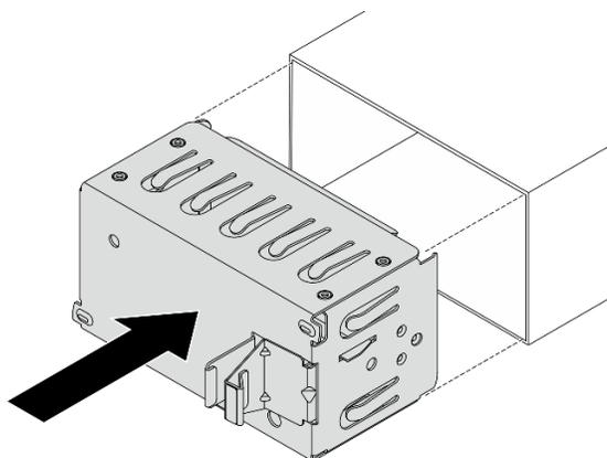
Рис. 212. Установка заглушки модуля блока питания
