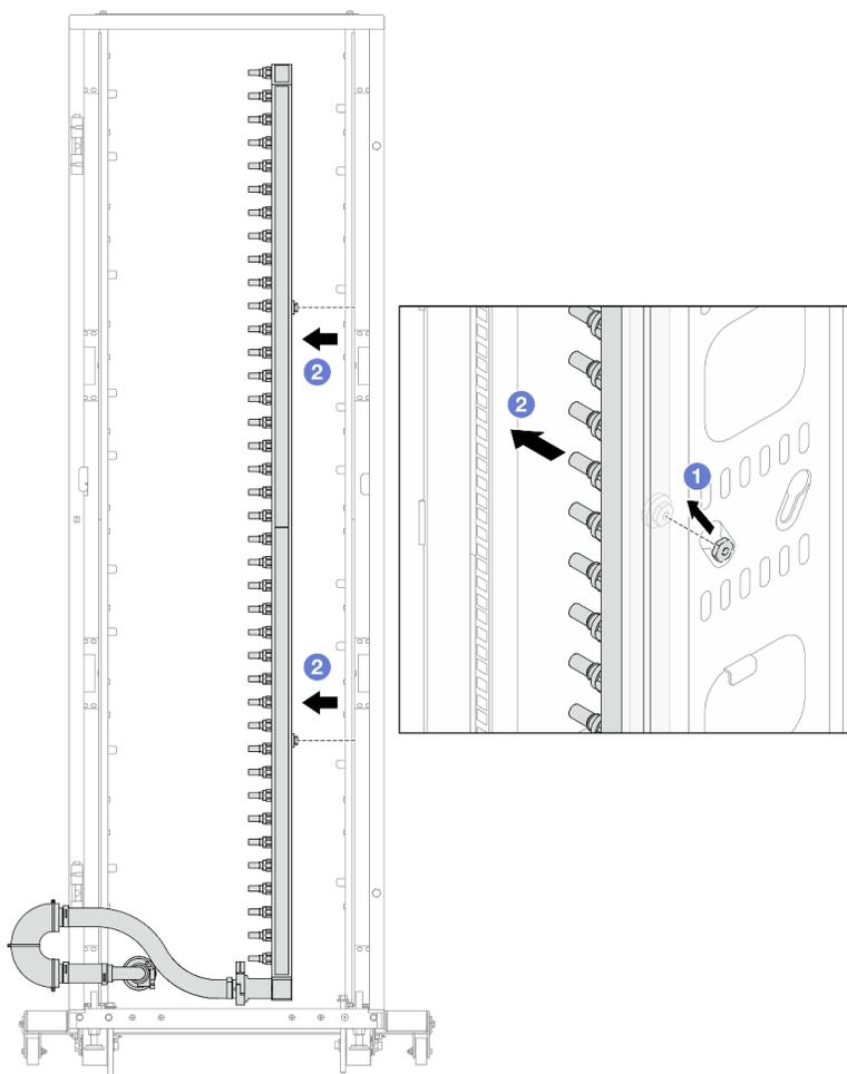
Рис. 161. Снятие коллектора
