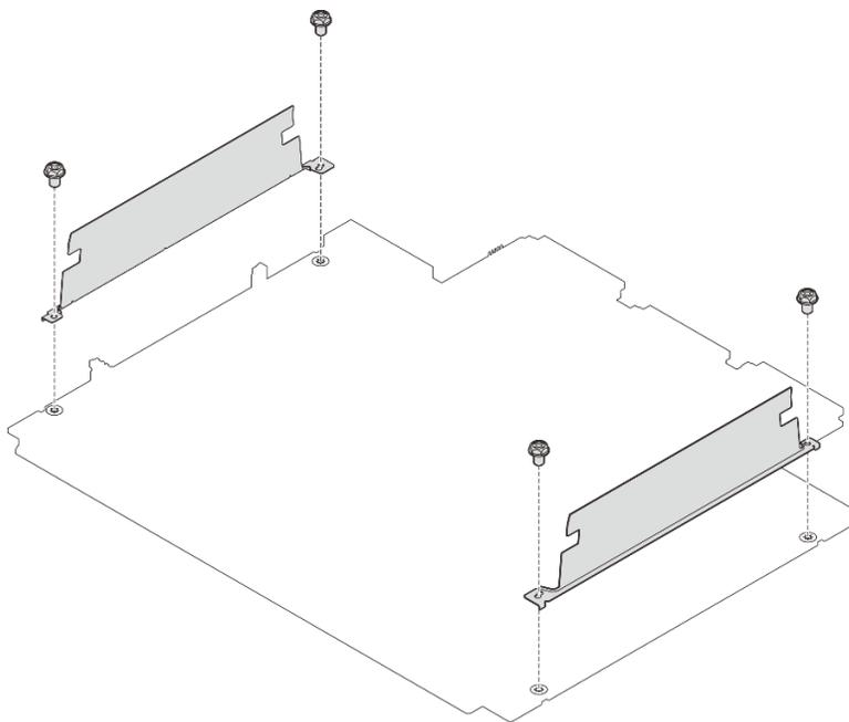
Рис. 48. Установка стенок для кабелей
