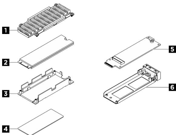
Рис. 118. Компоненты блока оперативно заменяемых дисков M.2
