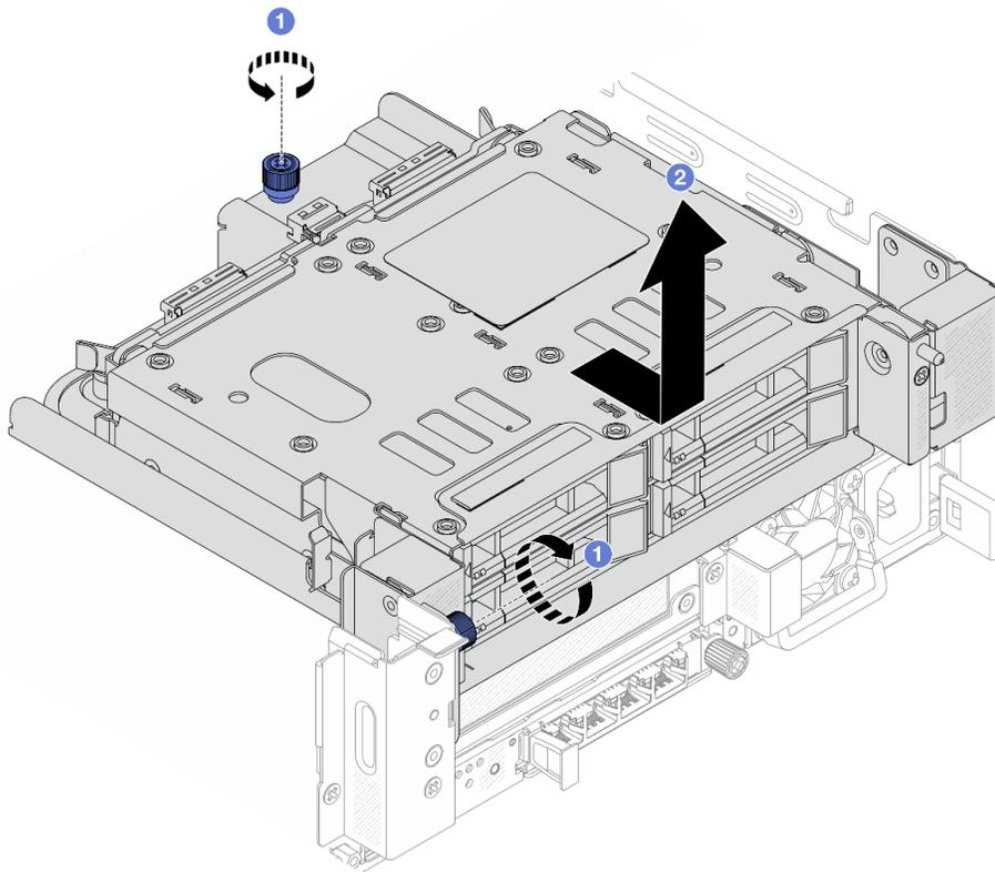
Рис. 259. Снятие заднего отсека для четырех 2,5-дюймовых дисков
