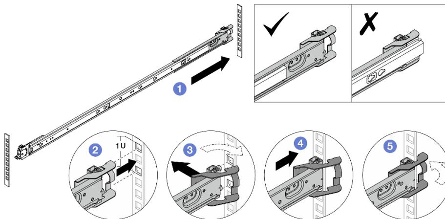
Рис. 15. Установка задних крепежных контактов
