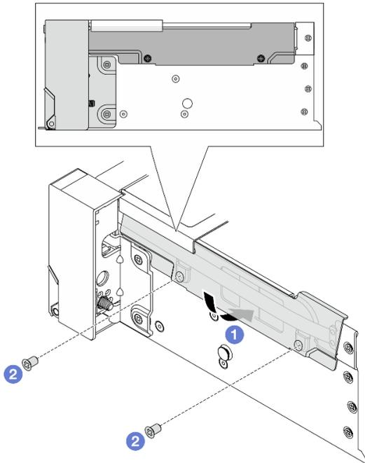
Рис. 235. Установка фиксатора кабелей
