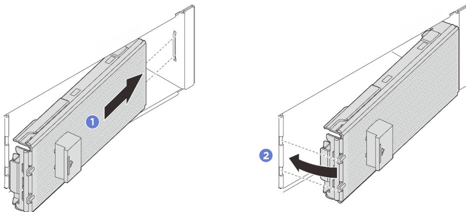
Рис. 71. Установка панели E3.S
