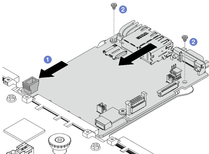
Рис. 308. Установка системной платы ввода-вывода на процессорную плату
