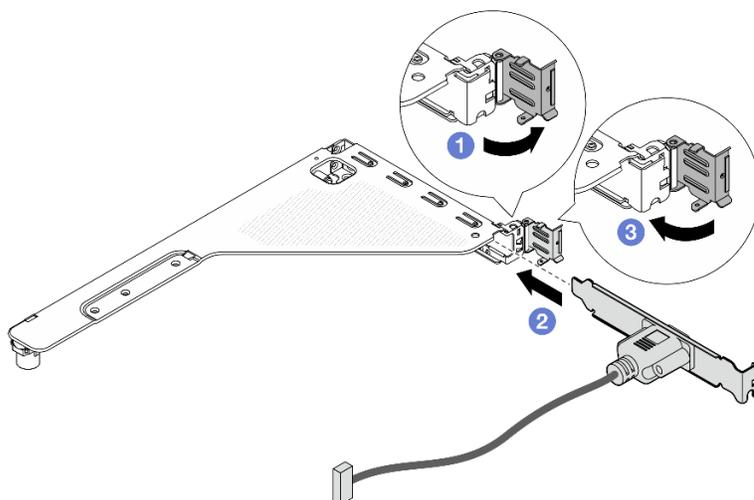
Рис. 299. Установка модуля последовательного порта
