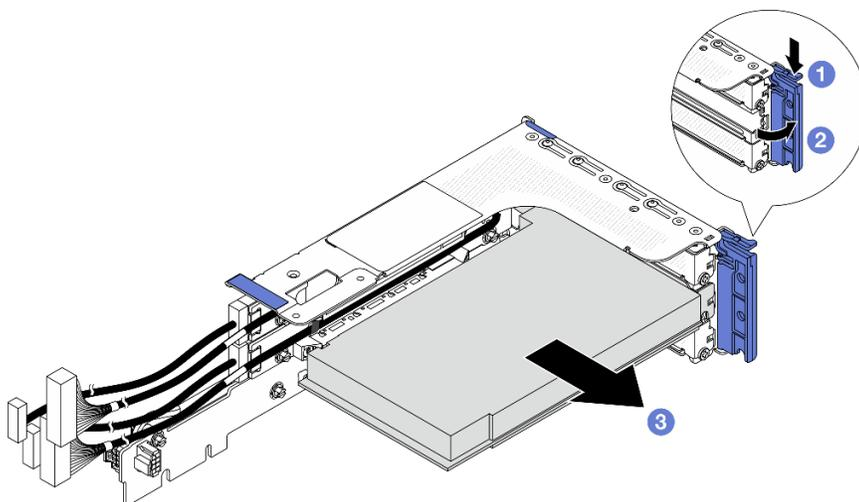
Рис. 279. Снятие адаптера PCIe с отсека платы-адаптера Riser 3FH
