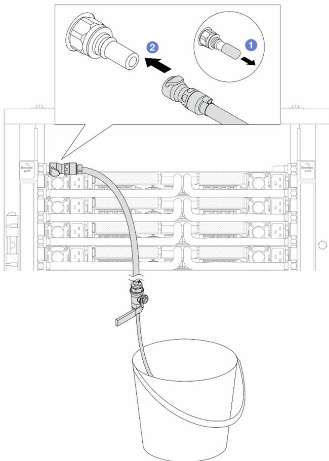
Рис. 192. Установка комплекта отводной трубки на стороне подачи
