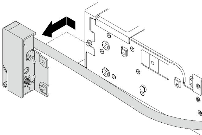
Рис. 232. Снятие защелки стойки
