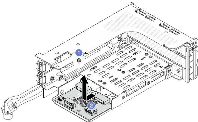
Рис. 146. Снятие объединительной панели M.2 с отсека платы-адаптера Riser 3FH M.2
