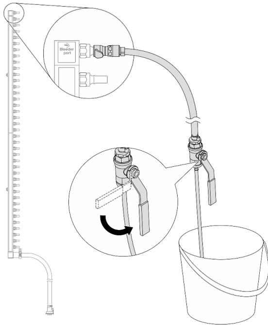
Рис. 185. Открытие клапана отводной трубки
