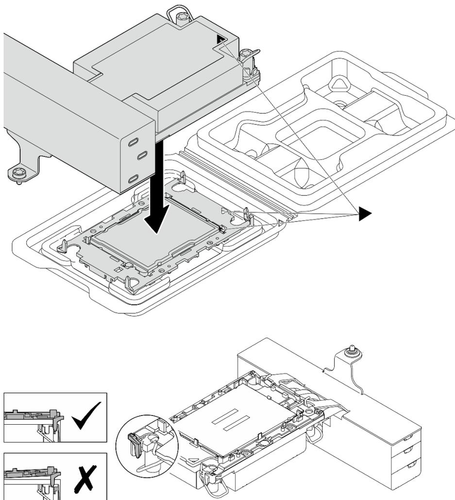
Рис. 226. Сборка модуля процессора с радиатором (PHM), когда процессор находится в транспортировочном лотке
