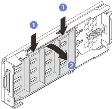
Рис. 58. Снятие внутренней пластины
