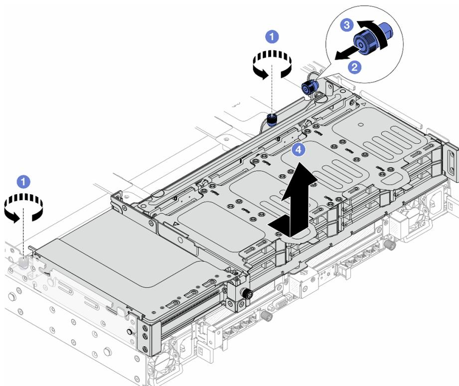
Рис. 262. Снятие заднего отсека для восьми 2,5-дюймовых дисков
