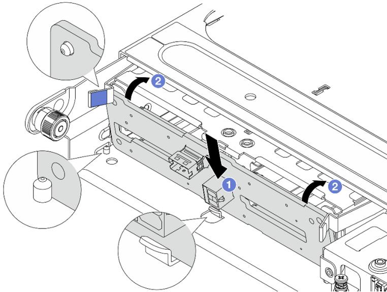
Рис. 207. Установка средней объединительной панели для 2,5-дюймовых дисков
