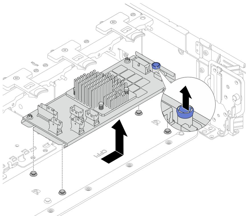
Рис. 86. Снятие внутреннего адаптера CFF
