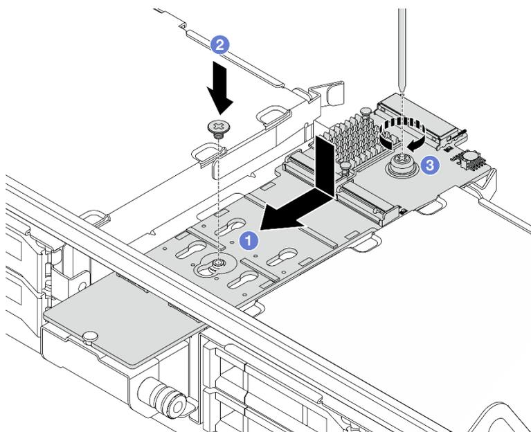
Рис. 97. Установка объединительной панели M.2 в средний отсек для дисков
