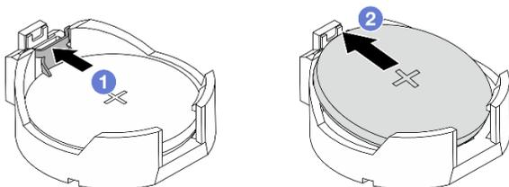
Рис. 49. Снятие батарейки CMOS
