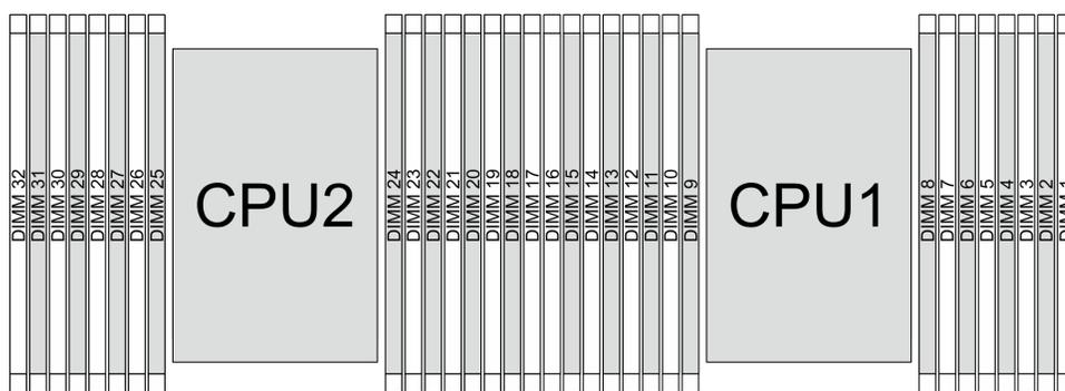
Рис. 1. Гнезда модулей памяти на процессорной плате
