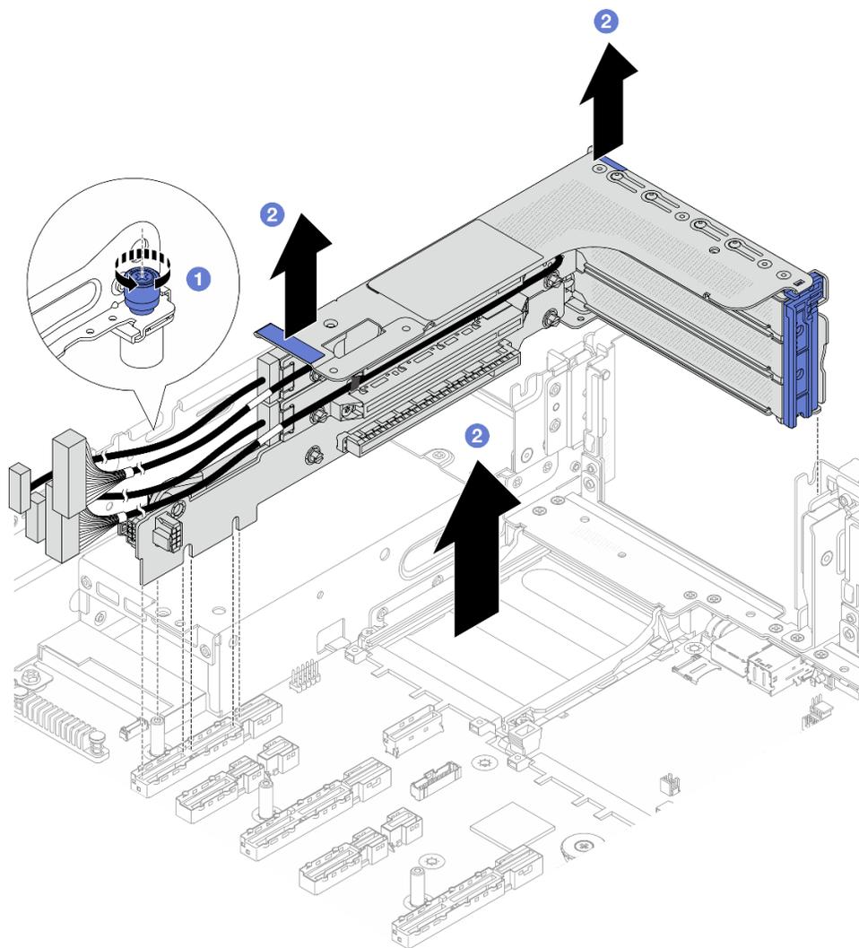
Рис. 276. Снятие блока платы-адаптера Riser 3FH
