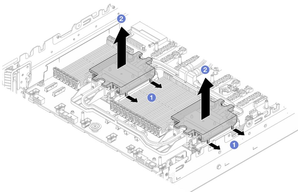
Рис. 334. Снятие кожуха платы охлаждения
