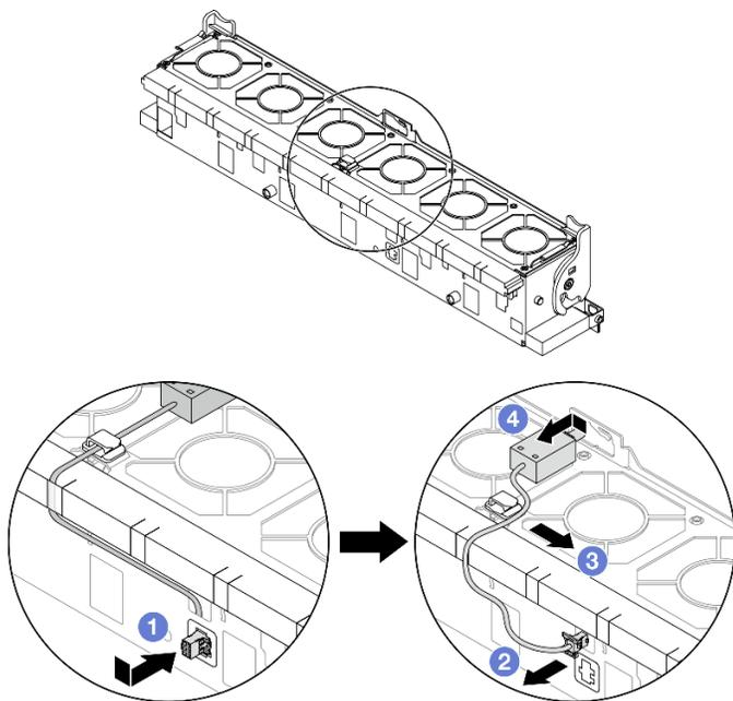
Рис. 101. Снятие датчика вмешательства
