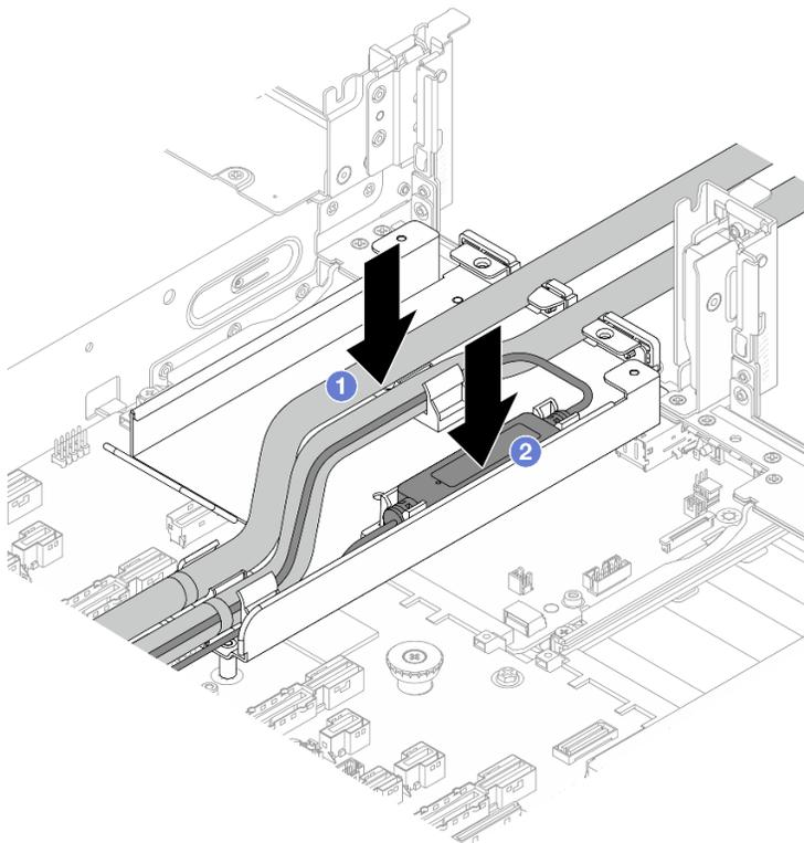
Рис. 114. Размещение шлангов и модуль датчика обнаружения утечки
