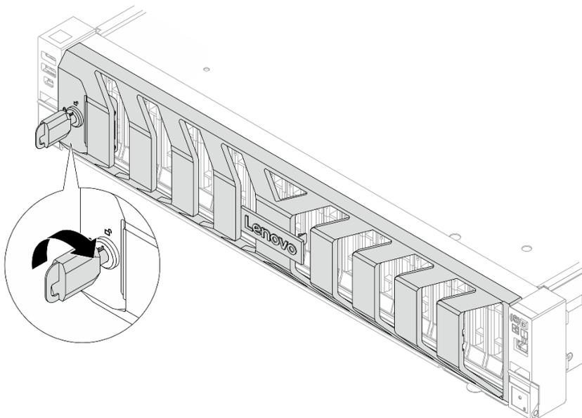
Рис. 290. Разблокирование защитной панели
