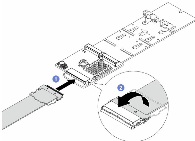
Рис. 99. Подключение кабеля M.2
