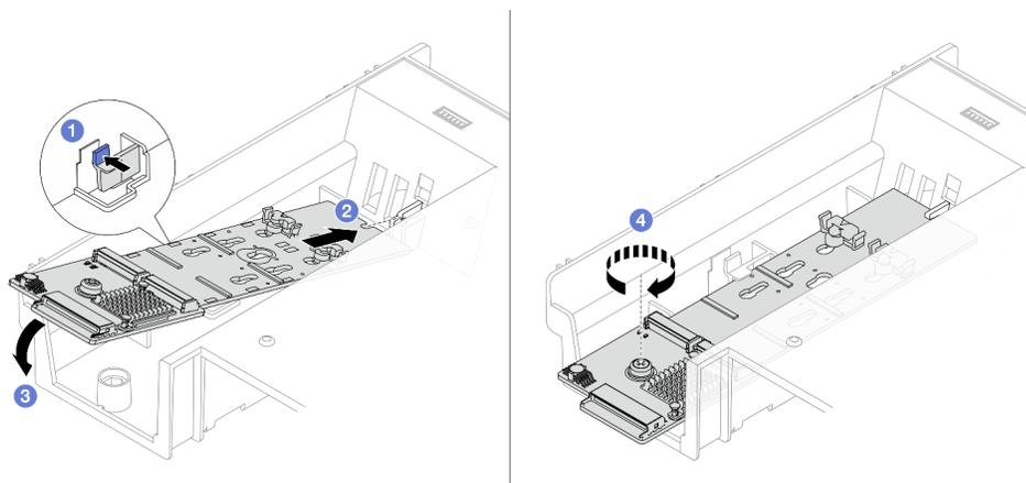
Рис. 96. Установка объединительной панели M.2 на дефлектор
