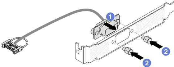
Рис. 298. Сборка модуля последовательного порта
