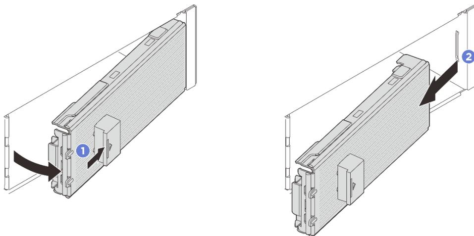
Рис. 54. Снятие панели E3.S
