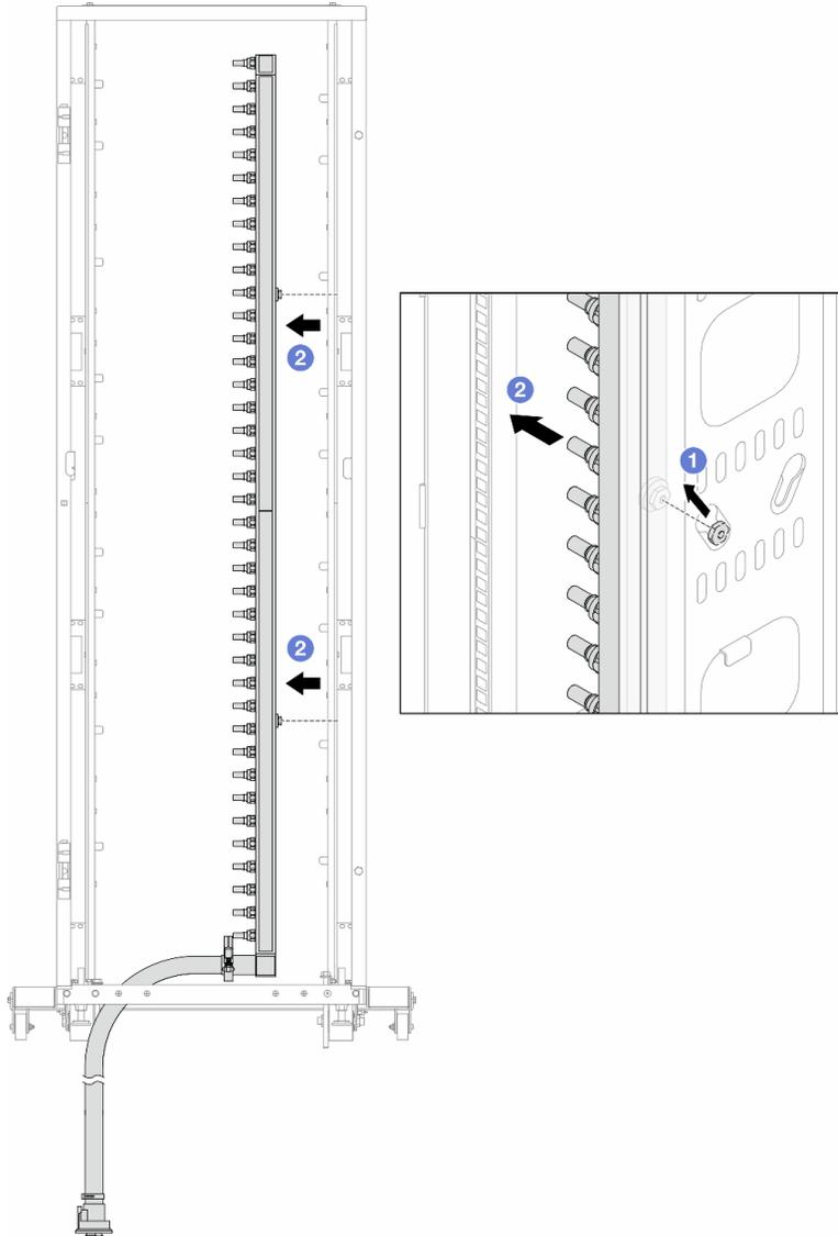
Рис. 183. Снятие коллектора
