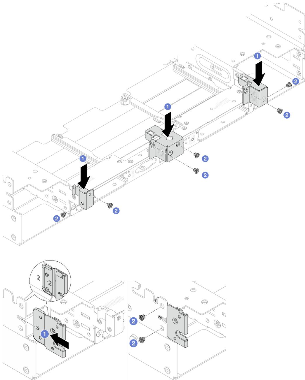
Рис. 268. Установка скоб задней стенки для блока заднего отсека для четырех 3,5-дюймовых дисков
