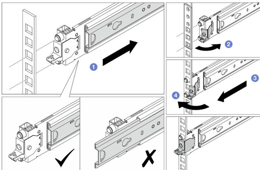
Рис. 16. Установка передних крепежных контактов
