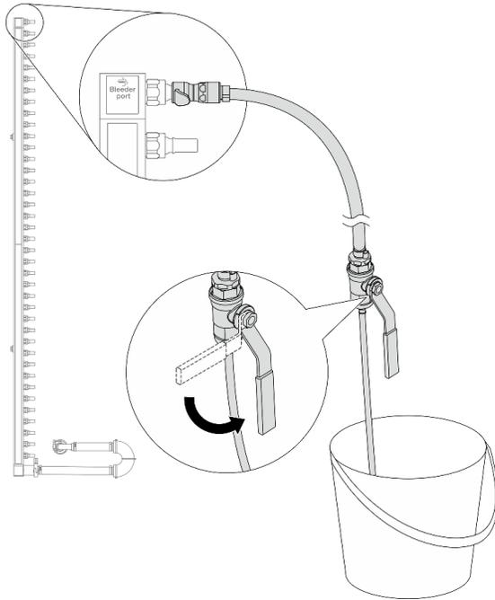
Рис. 163. Открытие клапана отводной трубки
