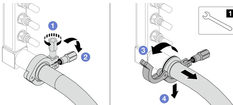
Рис. 166. Отделение коллектора от комплекта соединений
