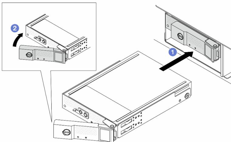
Рис. 56. Установка СММ E3.S
