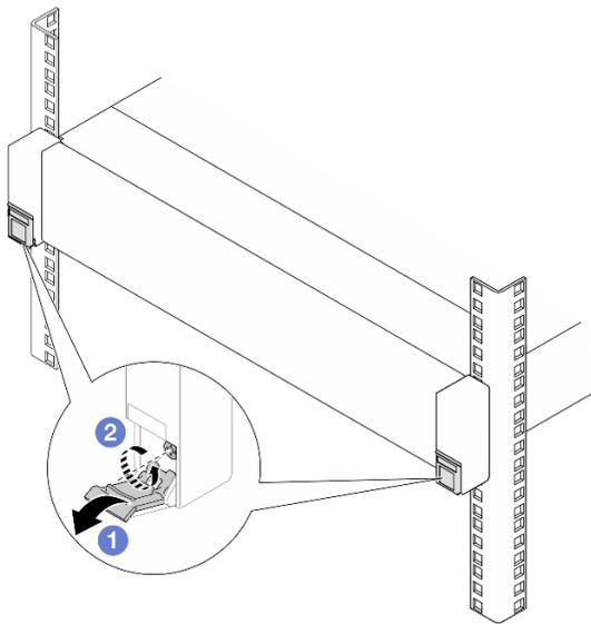
Рис. 19. Ослабление винтов в защелках стойки
