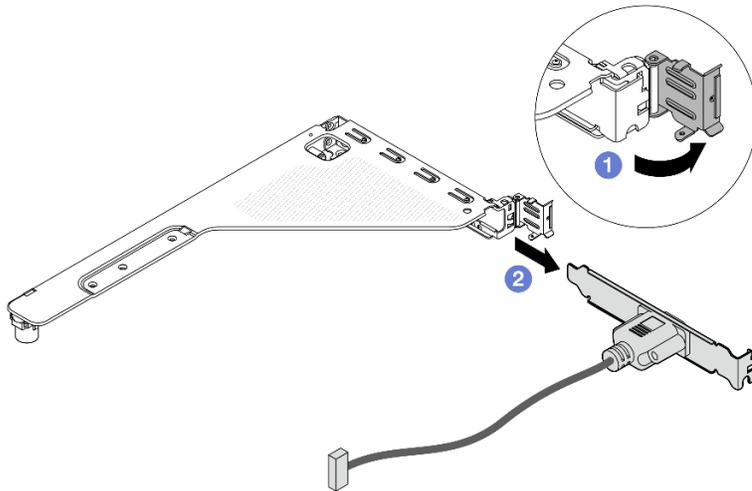
Рис. 296. Извлечение модуля последовательного порта
