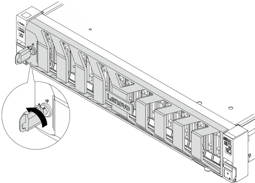
Рис. 294. Блокировка защитной панели
