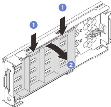
Рис. 70. Снятие внутренней пластины
