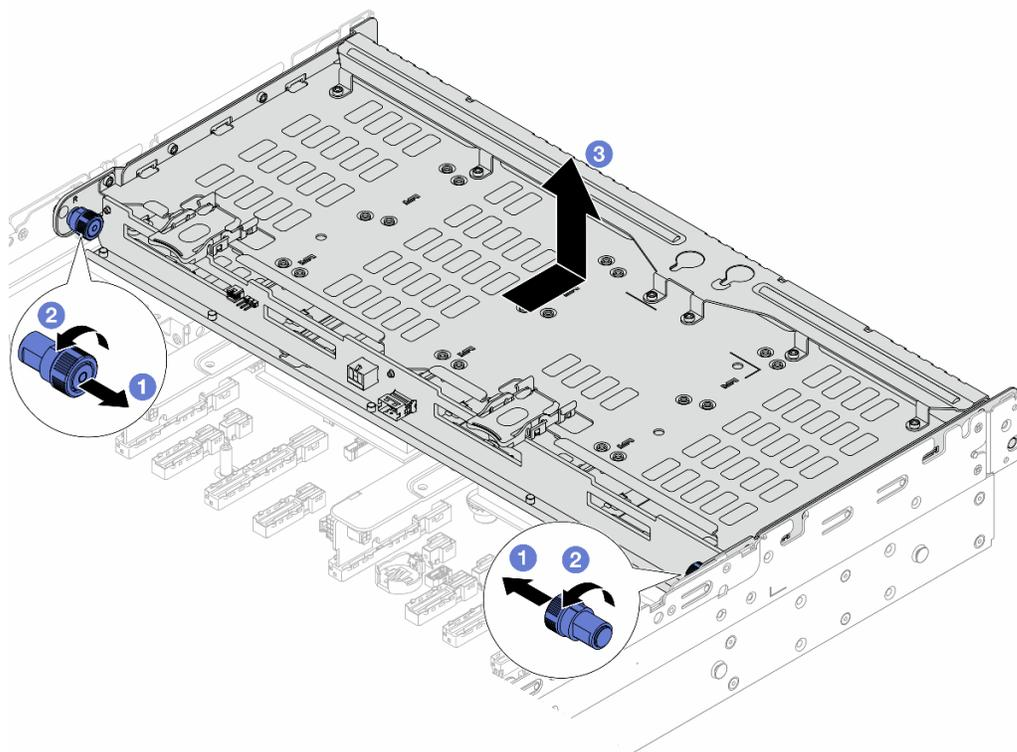
Рис. 267. Снятие заднего отсека для четырех 3,5-дюймовых дисков
