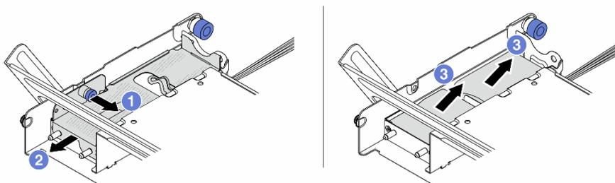
Рис. 243. Снятие модуля питания флэш-памяти RAID со среднего отсека для дисков
