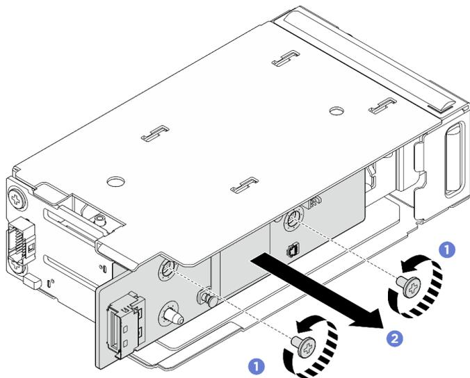
Рис. 135. Снятие передней платы контроллера M.2
