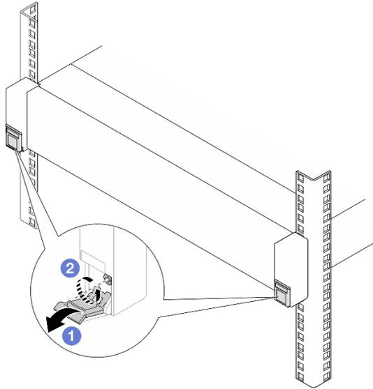
Рис. 29. Отсоединение сервера от стойки
