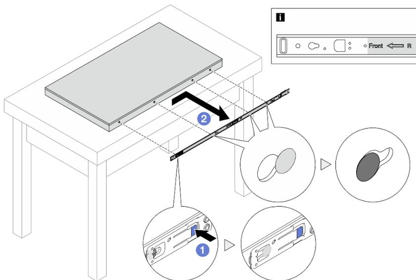
Рис. 32. Снятие внутренних направляющих
