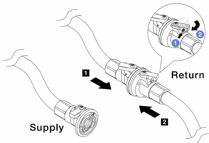
Рис. 193. Подключение разъема на стороне подачи объекта к разъему на стороне возврата коллектора
