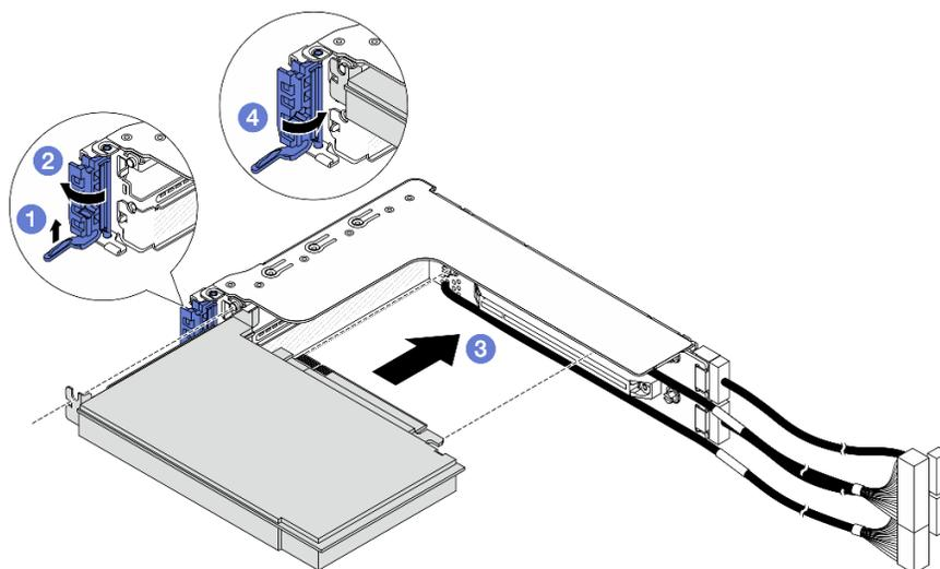
Рис. 286. Установка адаптера PCIe в отсек платы-адаптера Riser 2FH
