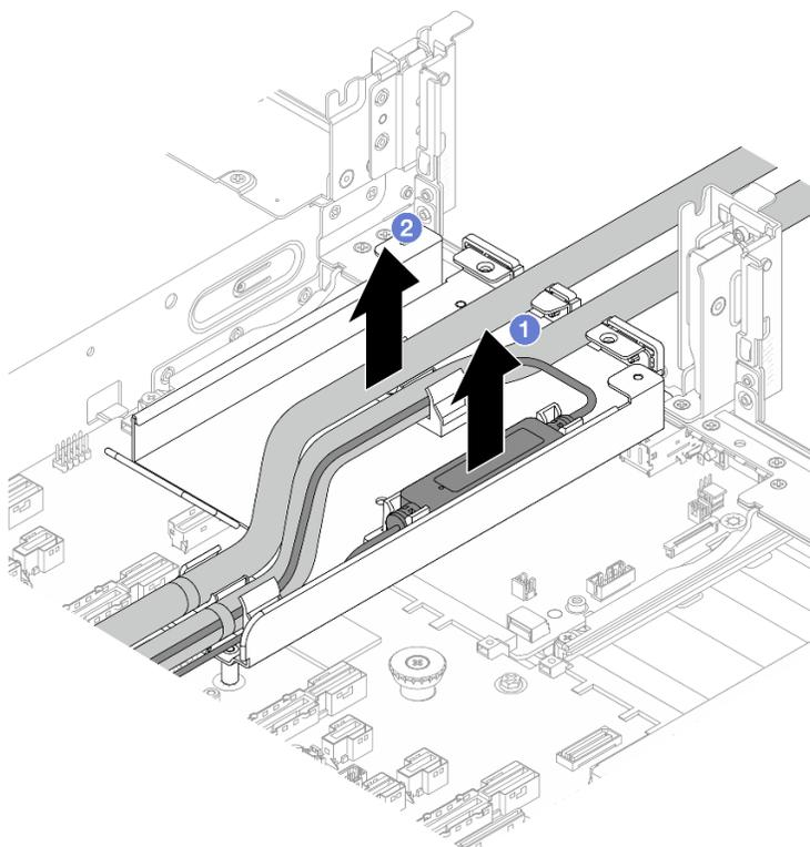
Рис. 105. Отсоединение шлангов и компонента «модуль датчика обнаружения утечки»
