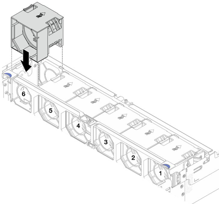
Рис. 311. Установка вентилятора компьютера
