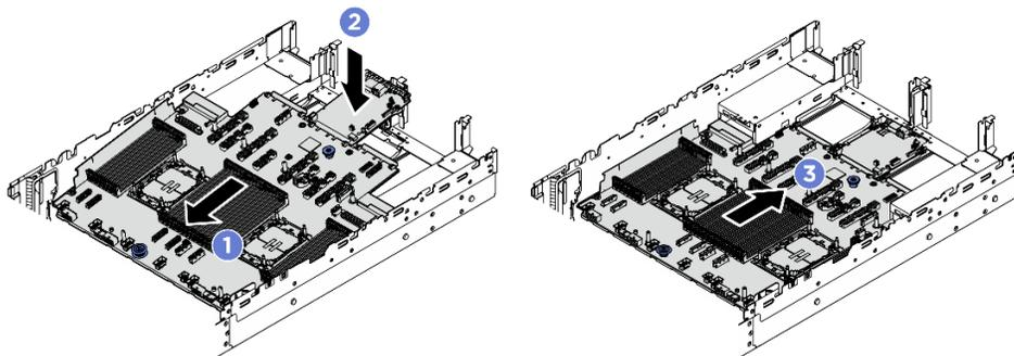
Рис. 305. Установка блока материнской платы
