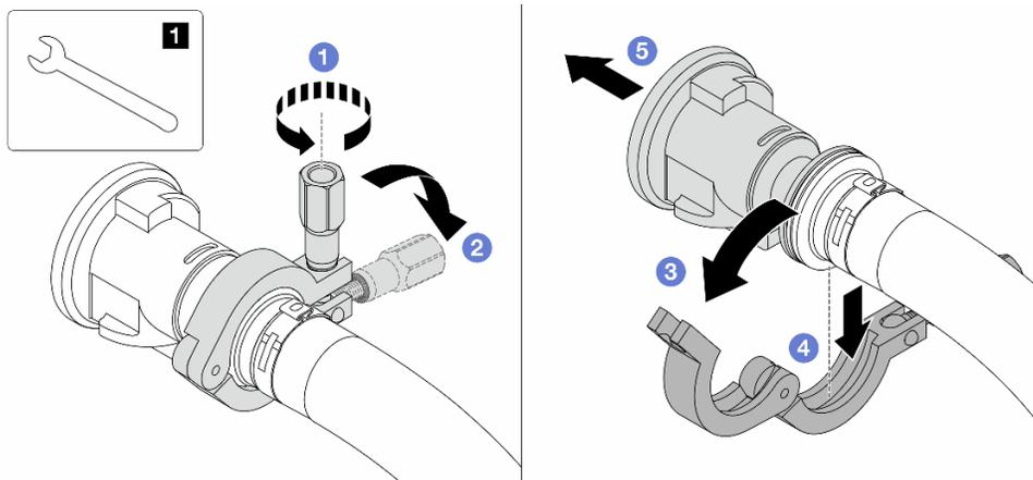
Рис. 168. Отделение шаровых клапанов
