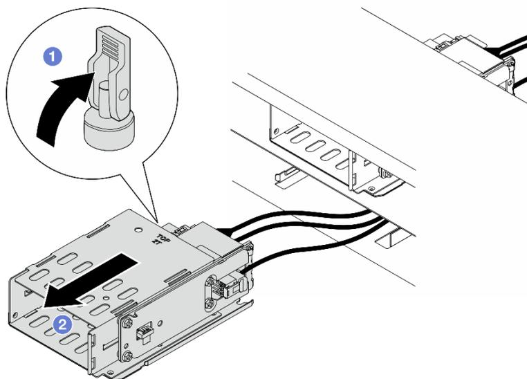
Рис. 60. Снятие отсека Е3.S 2Т
