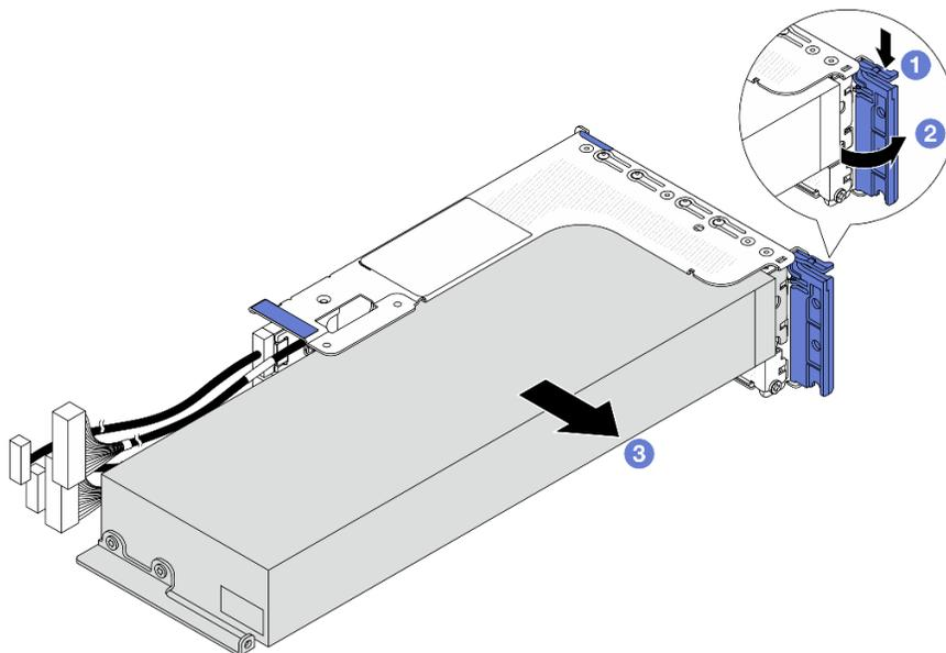
Рис. 81. Снятие адаптера графического процессора
