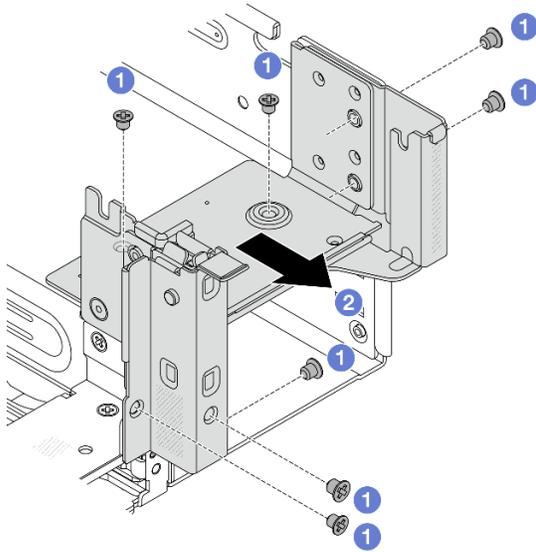
Рис. 249. Снятие правой скобы задней стенки
