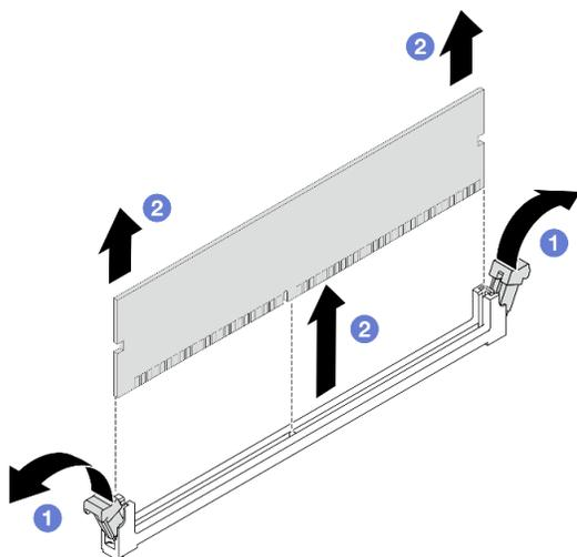
Рис. 200. Снятие модуля памяти
