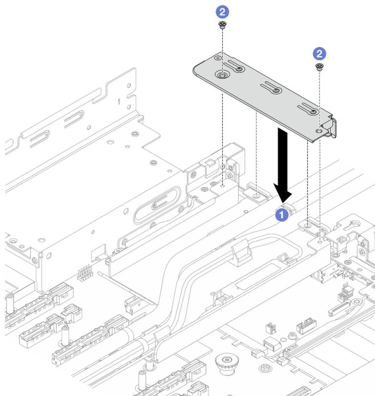
Рис. 116. Установка кронштейна 1FH
