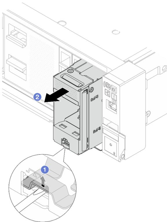
Рис. 133. Снятие переднего отсека для дисков M.2 с рамы
