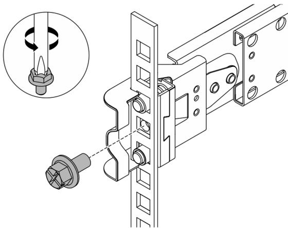
Рис. 12. Снятие винта М6
