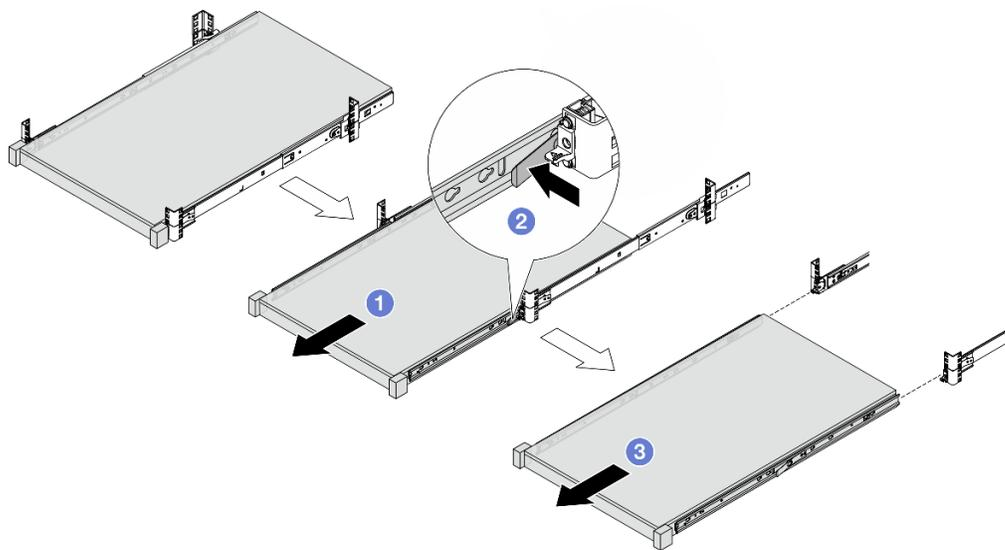
Рис. 21. Снятие сервера
