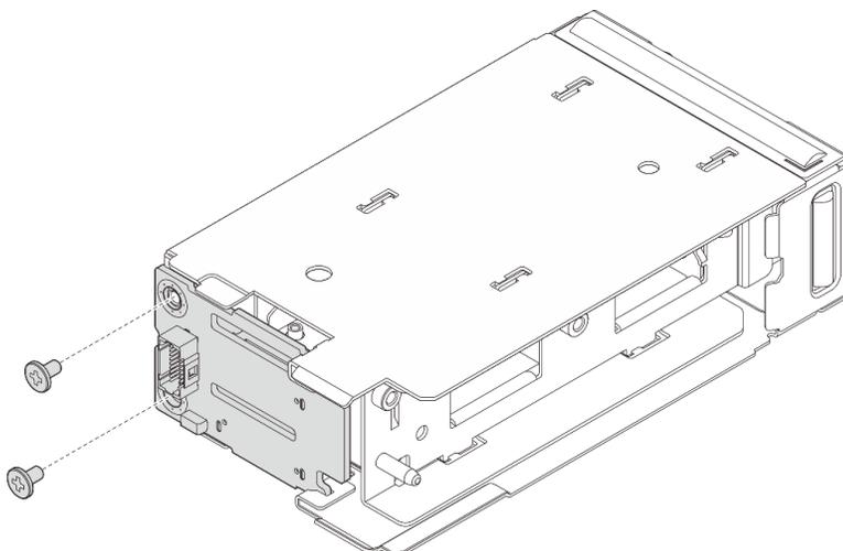
Рис. 140. Установка объединительной панели загрузки M.2
