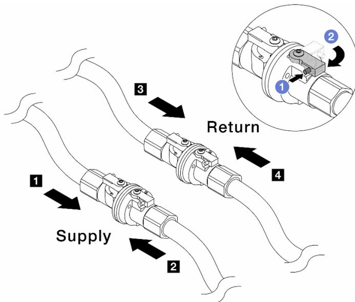
Рис. 199. Открытие шаровых клапанов
