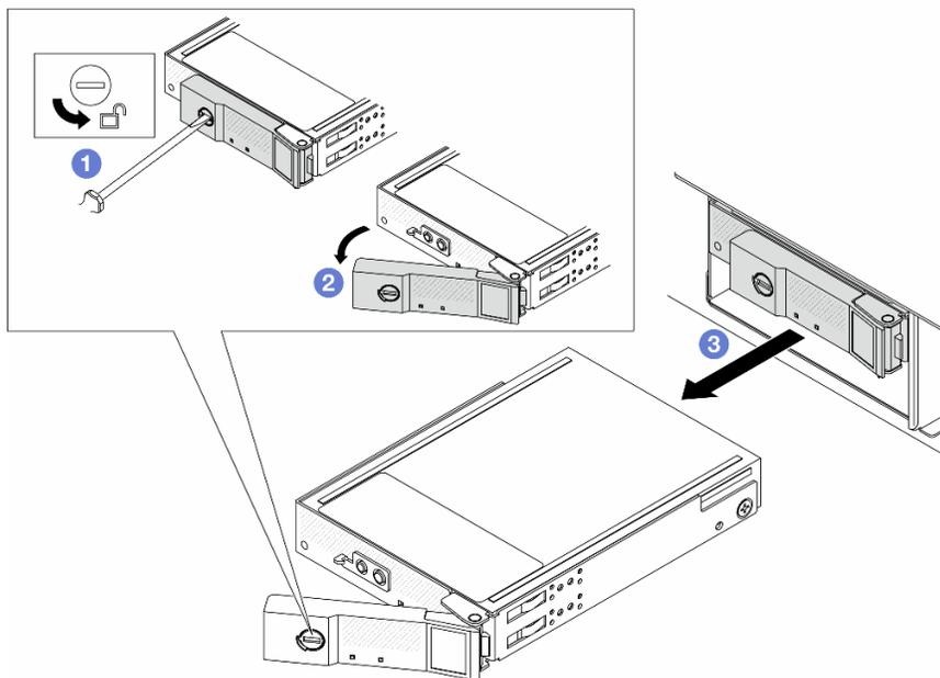
Рис. 52. Снятие СММ
