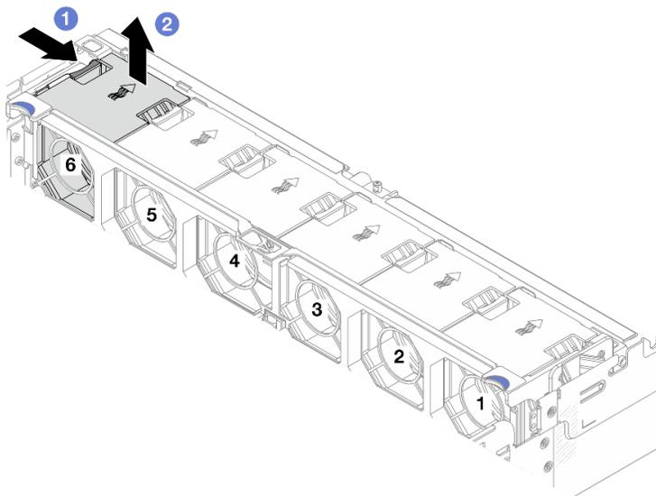
Рис. 310. Снятие вентилятора компьютера
