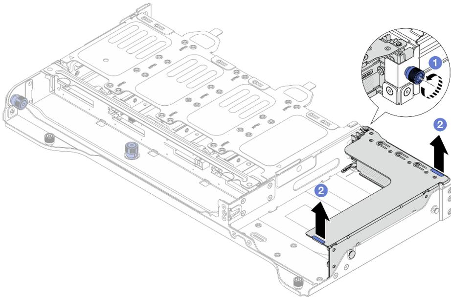
Рис. 277. Снятие блока платы-адаптера Riser 2FH
