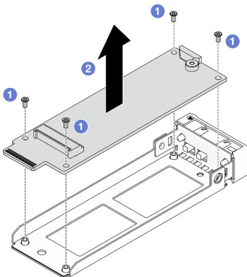
Рис. 124. Снятие интерпозера M.2
