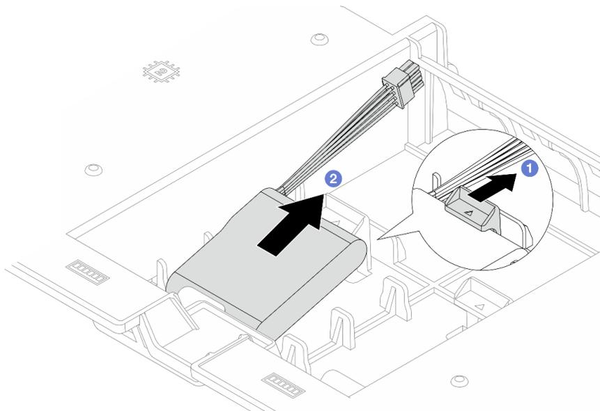
Рис. 239. Снятие модуля питания флэш-памяти RAID с дефлектора
