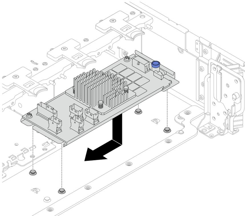
Рис. 87. Установка внутреннего адаптера CFF
