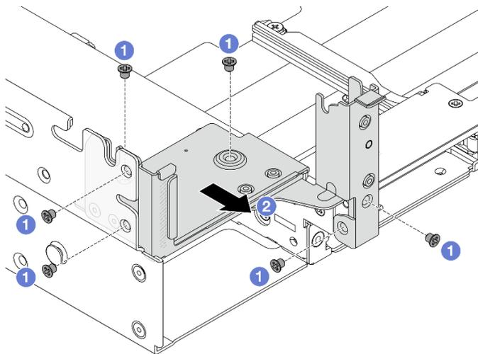
Рис. 247. Снятие левой скобы задней стенки
