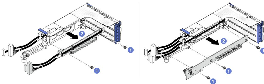
Рис. 282. Снятие плат-адаптеров Riser с отсека платы-адаптера Riser
