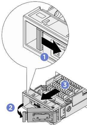
Рис. 119. Снятие блока оперативно заменяемых дисков M.2
