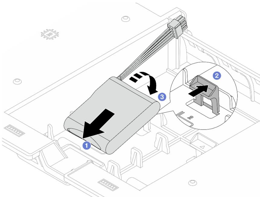
Рис. 240. Установка модуля питания флэш-памяти RAID на дефлектор
