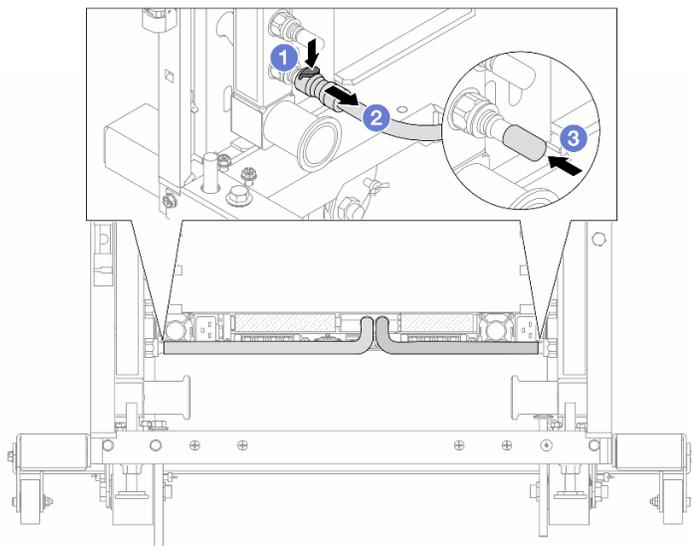
Рис. 182. Отсоединение быстроразъемного соединителя
