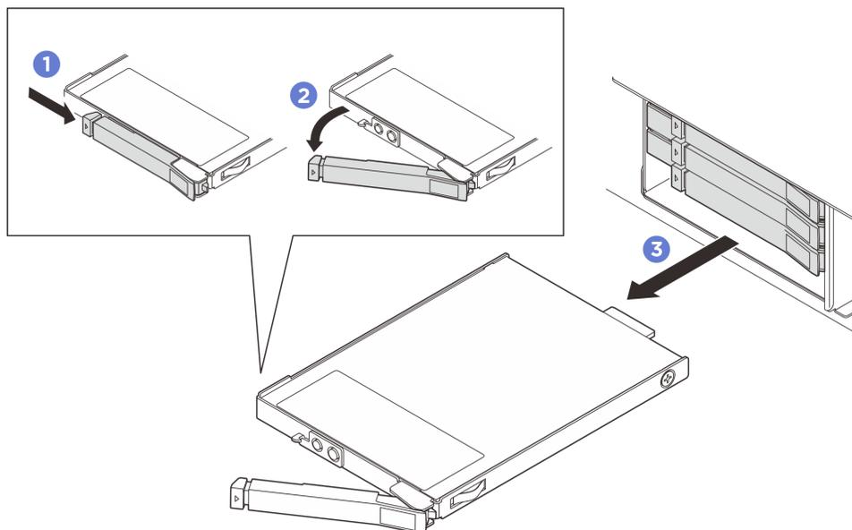
Рис. 65. Снятие оперативно заменяемого диска E3.S
