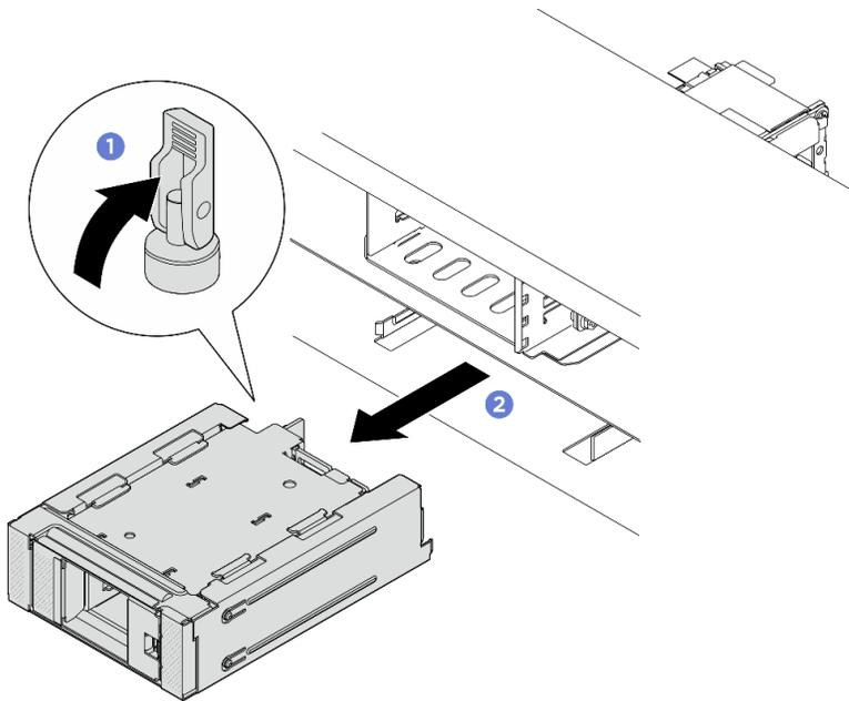
Рис. 132. Снятие переднего отсека для дисков M.2 с рамой отсека
