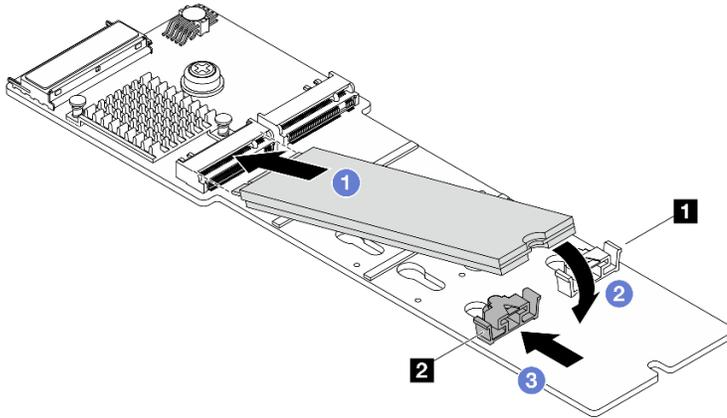
Рис. 91. Установка диска M.2
