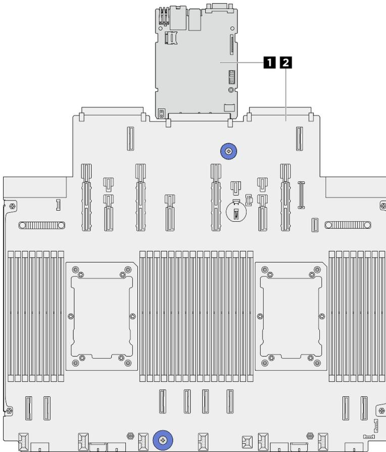
Рис. 301. Компоновка блока материнской платы
