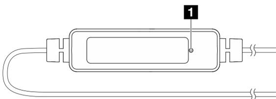
Рис. 324. Светодиодный индикатор обнаружения утечки жидкости
