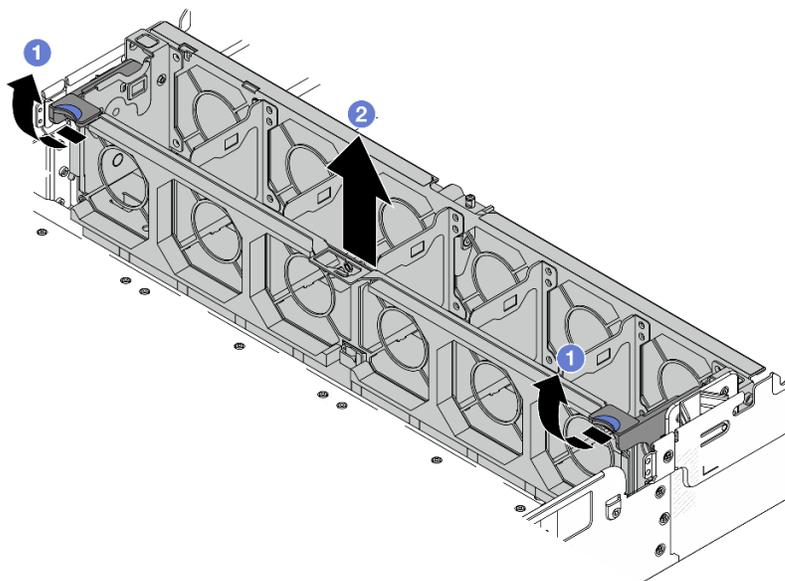
Рис. 312. Снятие отсека вентиляторов компьютера
