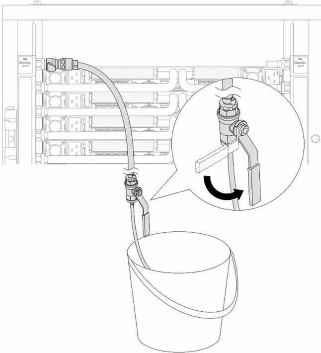
*Рис. 194. Открытие клапана отводной трубки на стороне подачи*
