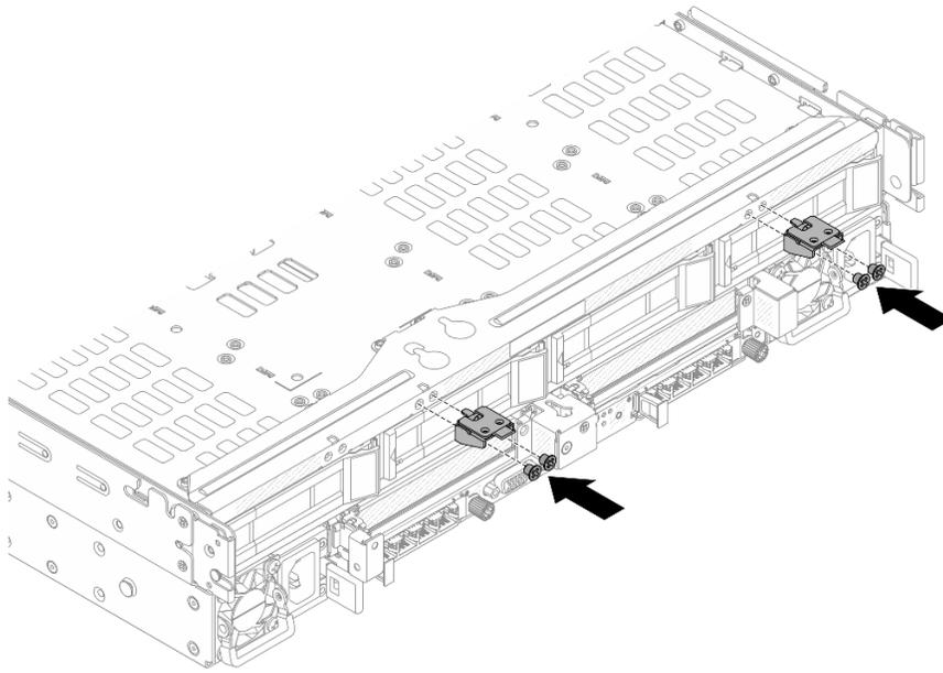
Рис. 271. Установка опорной скобы верхнего кожуха
