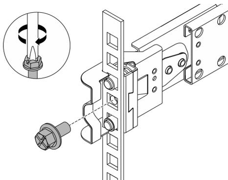
Рис. 39. Фиксация сервера на задней стороне стойки
