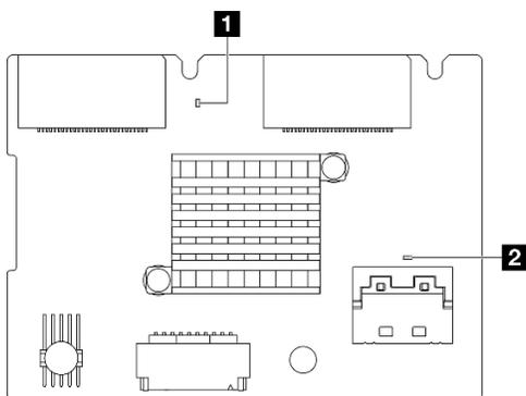
Рис. 330. Светодиодные индикаторы задней объединительной панели M.2
