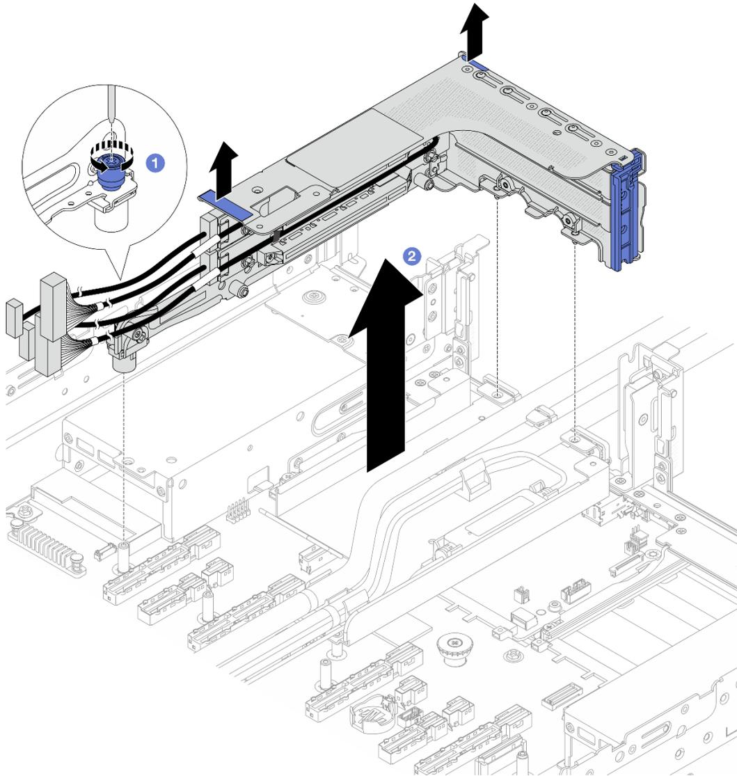
Рис. 104. Снятие отсека платы-адаптера Riser 3FH
