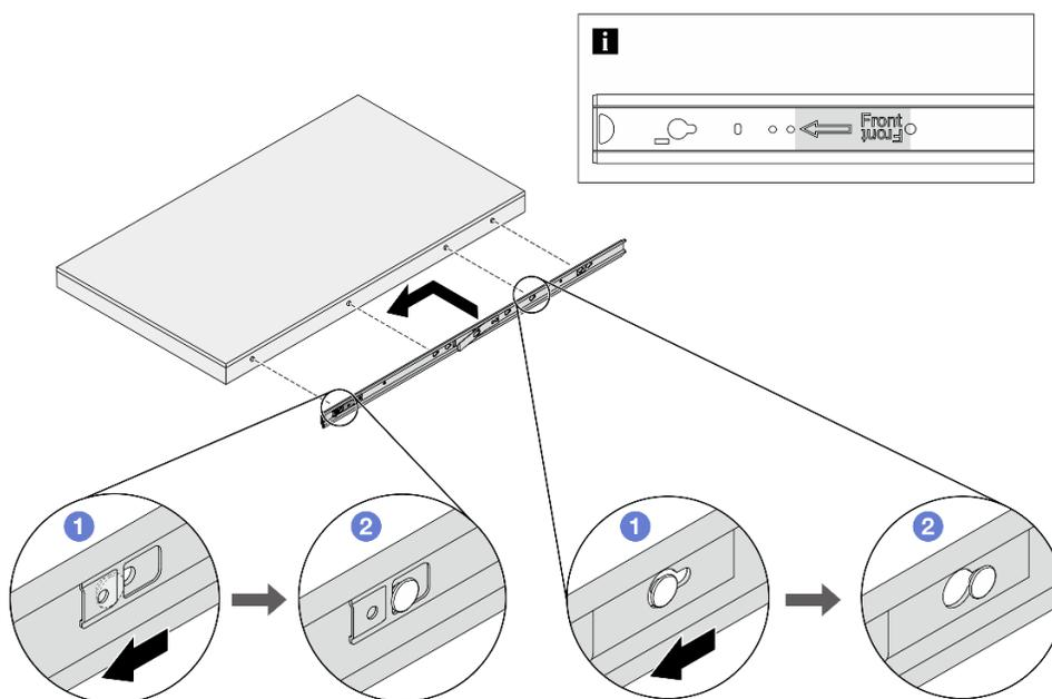
Рис. 24. Установка внутренних направляющих
