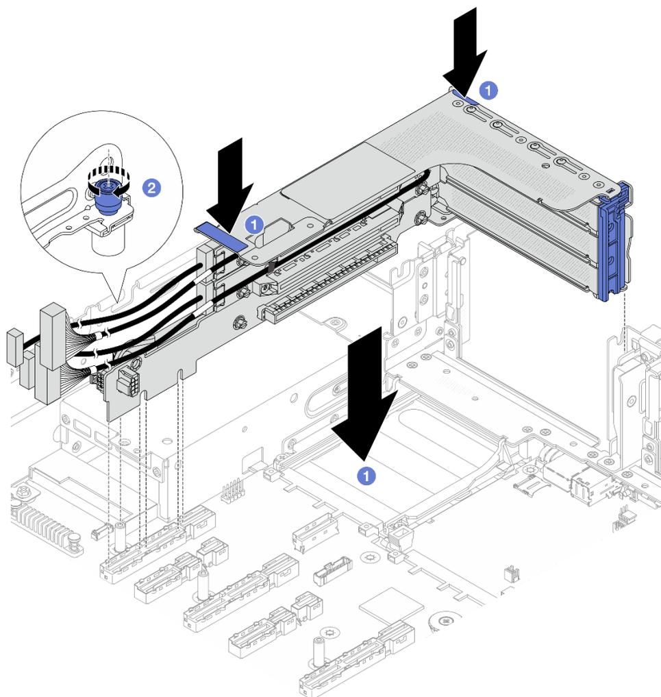
Рис. 288. Установка блока платы-адаптера Riser 3FH
