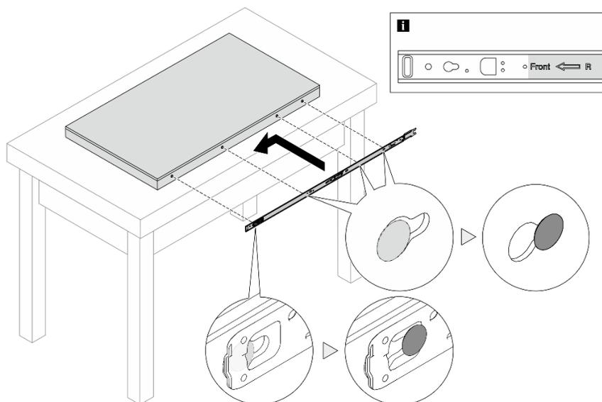
Рис. 34. Установка внутренних направляющих
