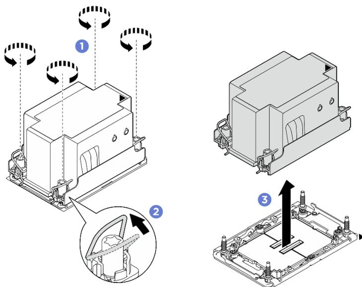
Рис. 218. Снятие стандартного модуля PNM 2U
