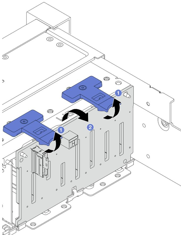
Рис. 76. Снятие передней объединительной панели для 2,5-дюймовых дисков
