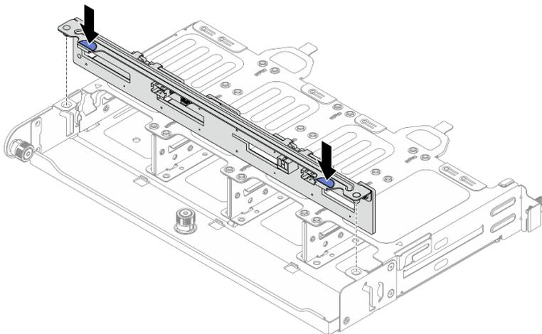
Рис. 257. Установка задней объединительной панели для восьми 2,5-дюймовых дисков
