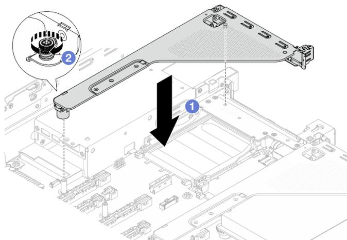
Рис. 300. Установка блока платы-адаптера Riser
