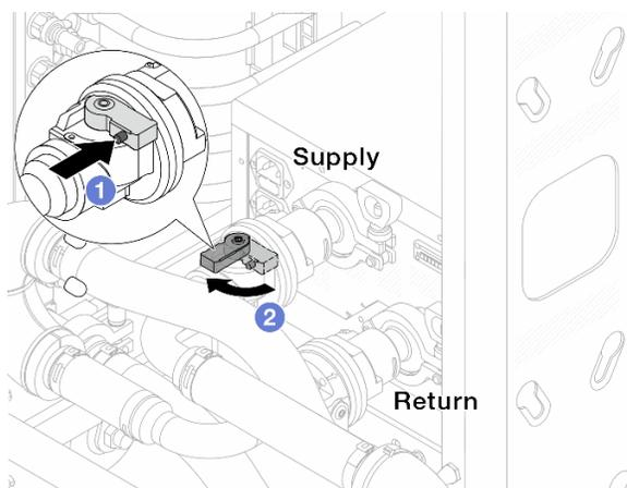
Рис. 176. Открытие шаровых клапанов
