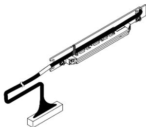
Рис. 10. Кабельная плата-адаптер Riser (Gen5 x16, 300 мм)
