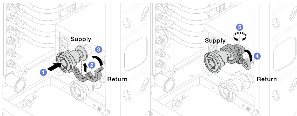
Рис. 169. Установка шаровых клапанов
