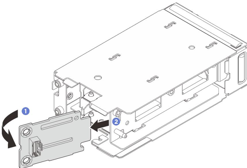
Рис. 137. Снятие передней объединительной панели загрузки M.2
