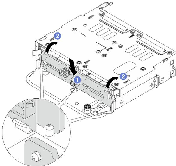
Рис. 256. Установка задней объединительной панели для четырех 2,5-дюймовых дисков
