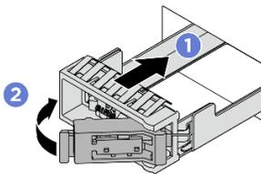
Рис. 120. Установки лотка для дисков M.2
