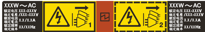
Abbildung 199. Hot-Swap-Netzteil-Etikett auf der Abdeckung
