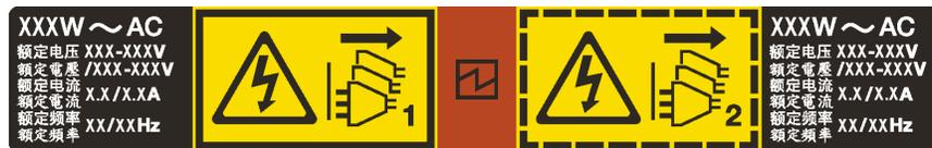
Abbildung 199. Hot-Swap-Netzteil-Etikett auf der Abdeckung
