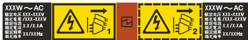
Figura 138. Etichetta dell'alimentatore hot-swap sul coperchio
