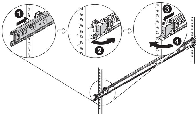
**3.** 手順 1 および 2 を繰り返して、右側のレールをラックの反対側に取り付けます。
