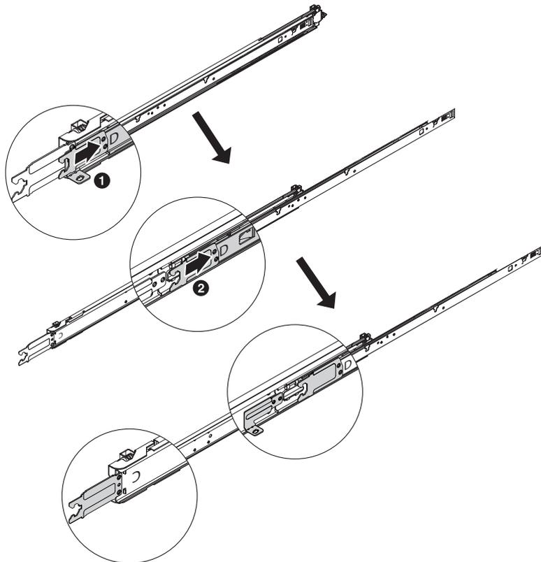
2. T8 Torx ドライバーを使用して、レールから CMA 取り付けブラケットを取り外します。
