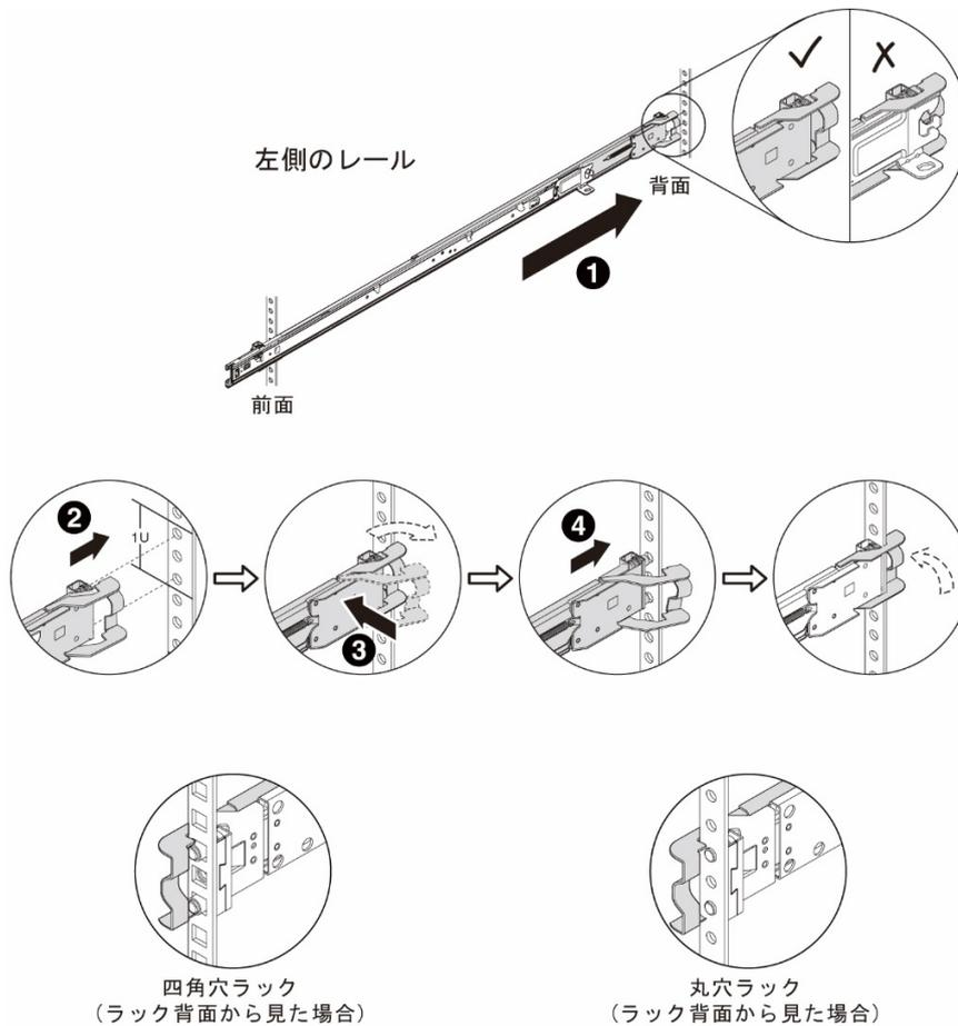
**2.** 左側のレールの前部取り付けブラケットを取り付けます。
