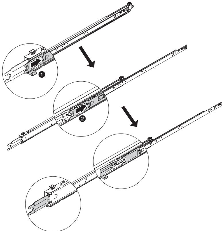
2. Remova os suportes de montagem CMA dos trilhos usando uma chave de fenda T8 Torx.
