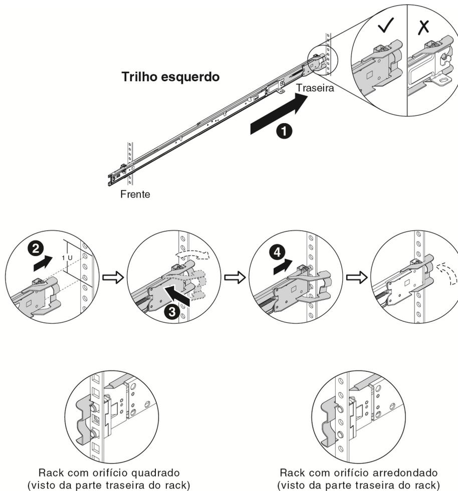
**2.** Instale o suporte de montagem frontal do trilho esquerdo.
