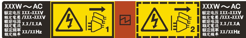
รูปภาพ 196. ป้ายแหล่งจ่ายไฟแบบ Hot-swap บนฝาครอบ
