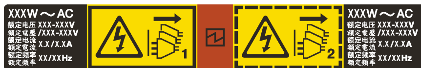
รูปภาพ 199. ป้ายแหล่งจ่ายไฟแบบ Hot-swap บนฝาครอบ
