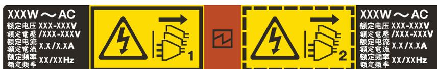
圖例 138. 蓋板上的熱抽換電源供應器標籤
