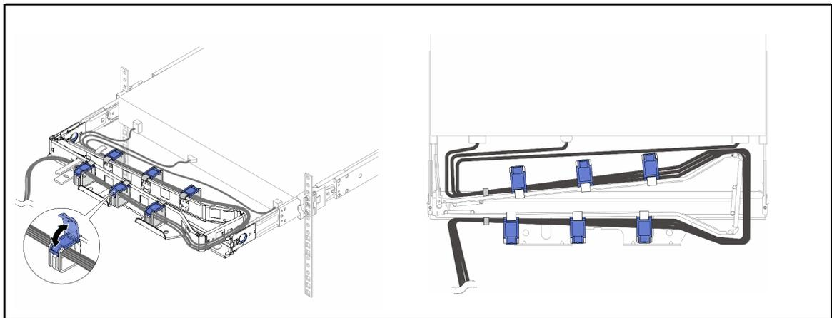
Schritt 2. Verwenden Sie die Kabelbinder, um die Kabel fest an der Vorder- und Rückseite des Kabelträgers zu befestigen.
