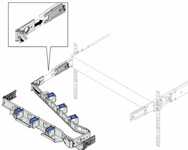
Schritt 2. Richten Sie die zwei äußeren Befestigungsklammern an den äußeren Laschen der Schiene aus. Schieben Sie diese dann, bis sie einrasten.
