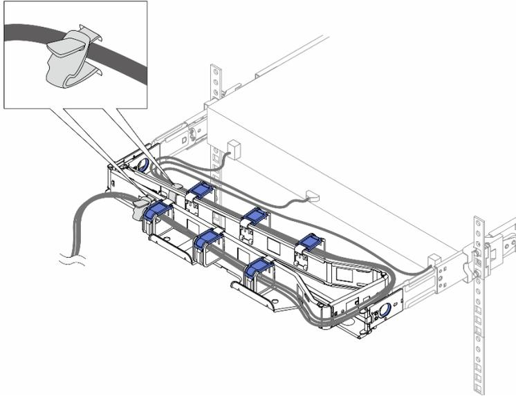
**Achtung:** Schieben Sie die Schiene vorsichtig vor und zurück, um sicherzustellen, dass die Kabel nicht geknickt werden, sich nicht verklemmen und nicht in den U-förmigen Bereich unter dem Server hängen.
