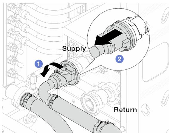
Figura 142. Rimozione del set di collegamento
