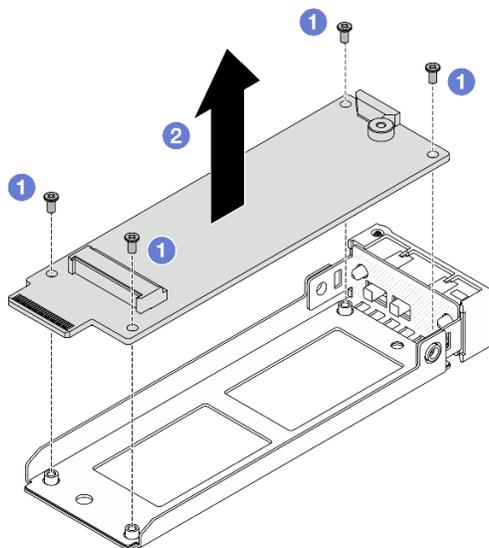
Figura 110. Rimozione dell'interposer M.2
