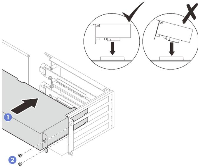
Figura 57. Installazione di un adattatore PCIe
