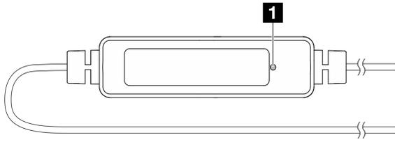
Figura 254. LED di rilevamento perdite
