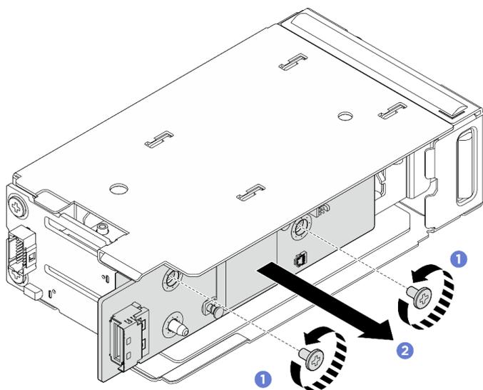
Figura 120. Rimozione della scheda di controllo M.2 anteriore
