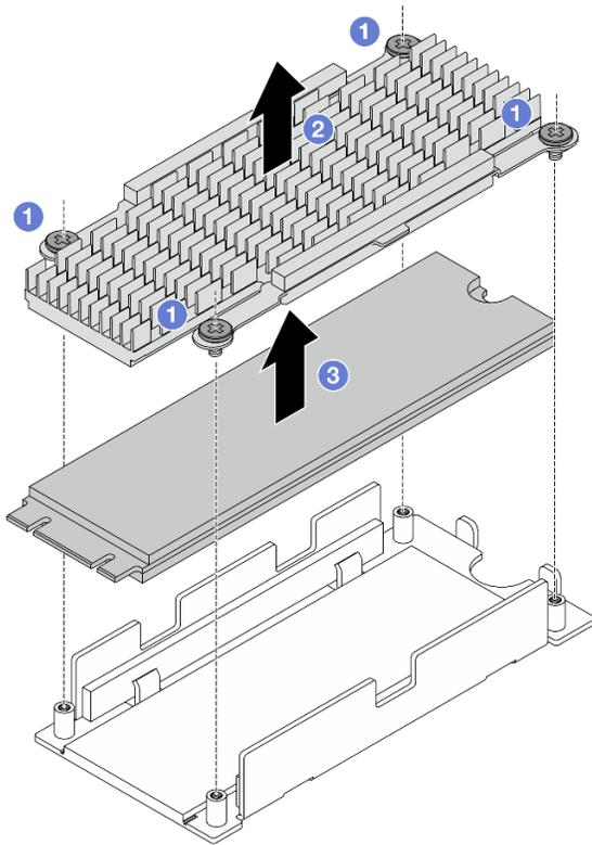
Figura 111. Rimozione dell'unità M.2
