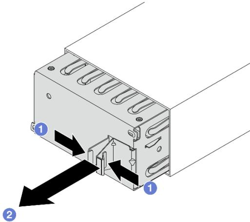
Figura 72. Rimozione dell'elemento di riempimento dell'unità di alimentazione
