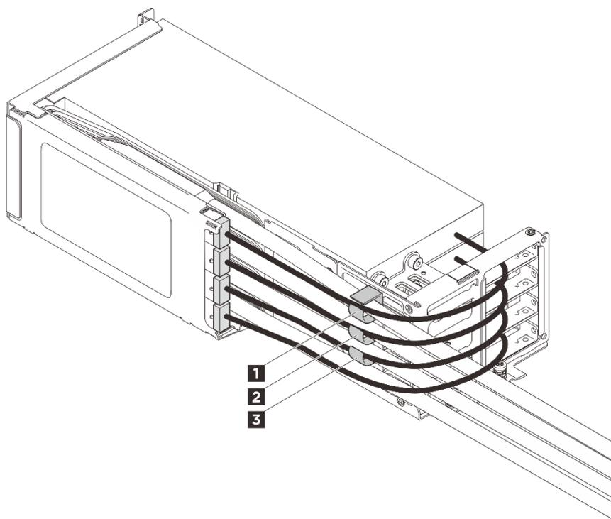
Figura 61. Fermacavi dell'assieme verticale anteriore
