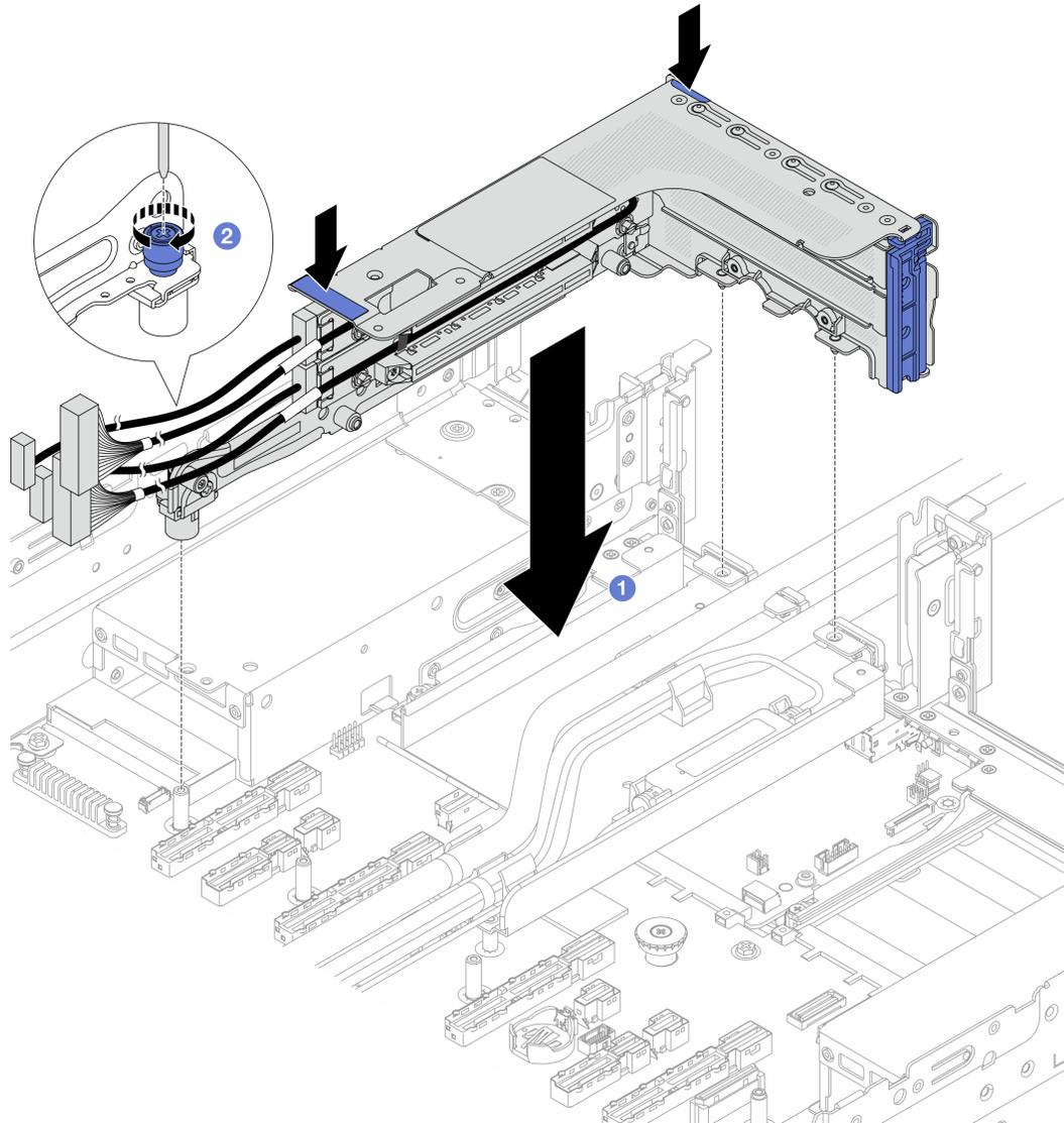
Figura 103. Installazione del telaio verticale 3FH
