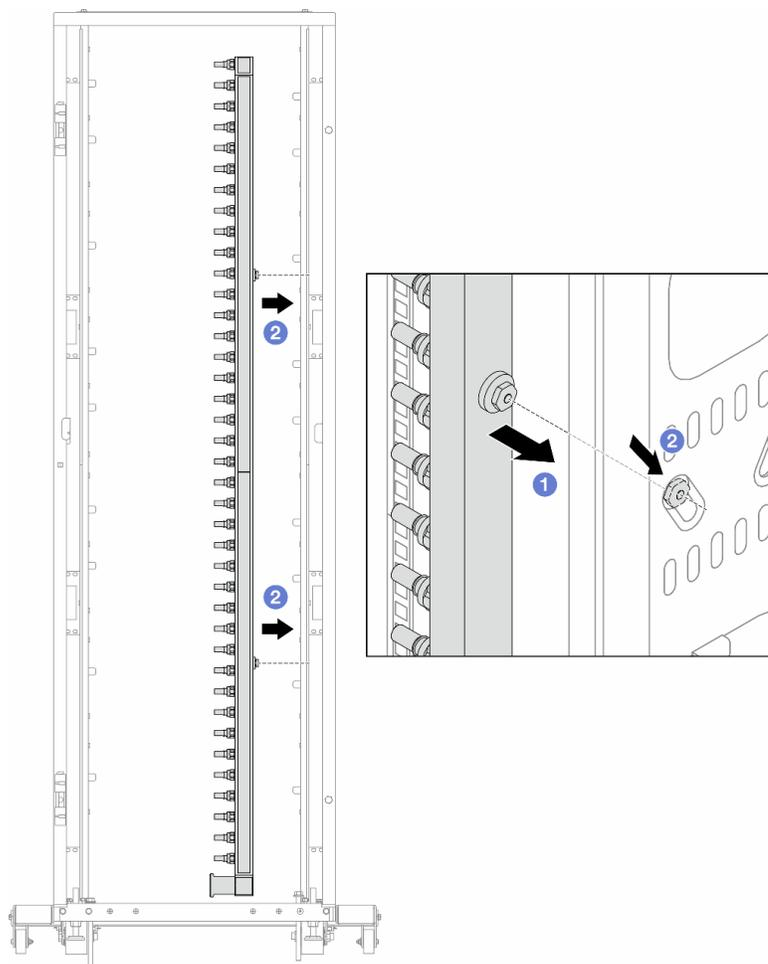
Figura 171. Installazione del collettore
