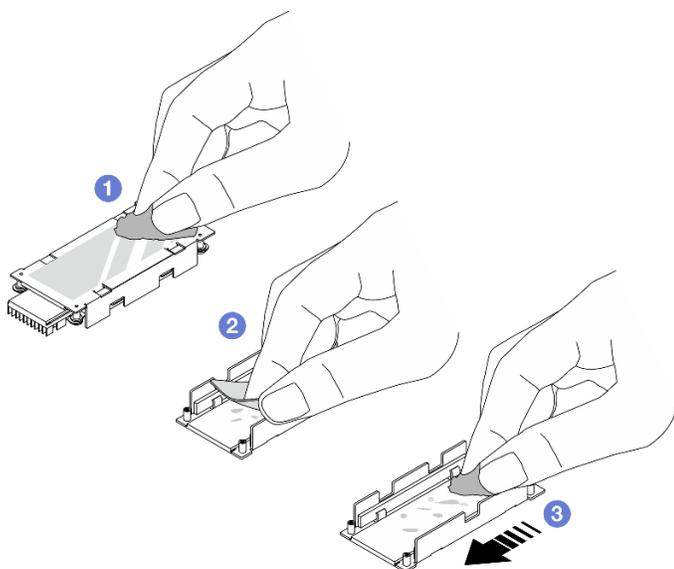
Figura 112. Pulizia del dissipatore di calore e della piastra inferiore
