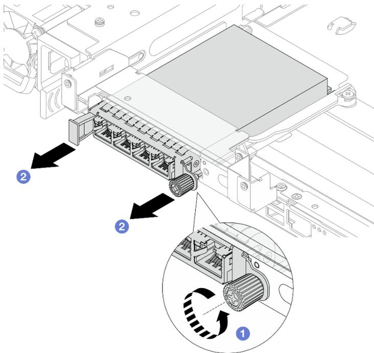
Figura 208. Rimozione del modulo OCP posteriore
