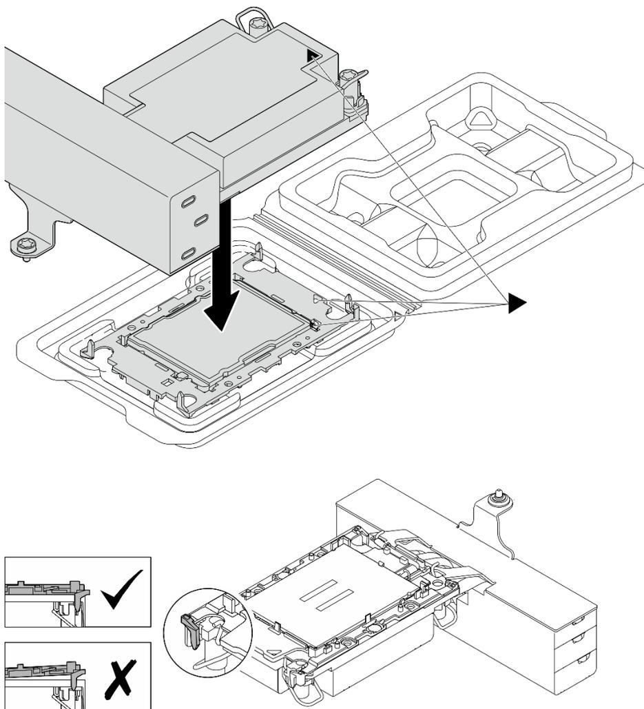
Figura 195. Assemblaggio del PHM con il processore nella confezione di spedizione
