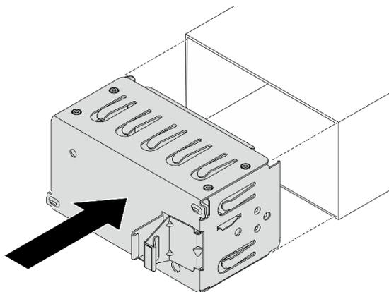
Figura 70. Installazione dell'elemento di riempimento dell'unità di alimentazione
