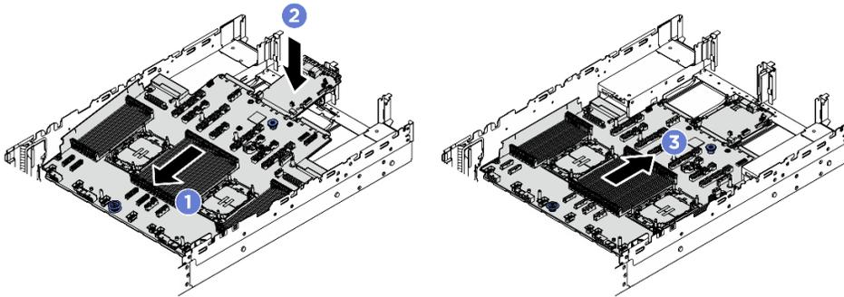
Figura 234. Installazione dell'assieme della scheda di sistema
