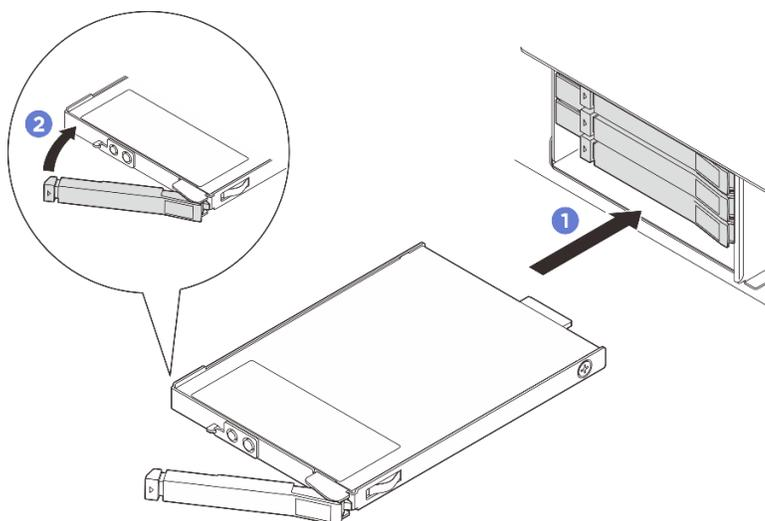
Figura 41. Installazione di un'unità hot-swap E3.S
