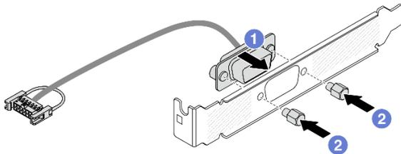
Figura 227. Assemblaggio del modulo della porta seriale
