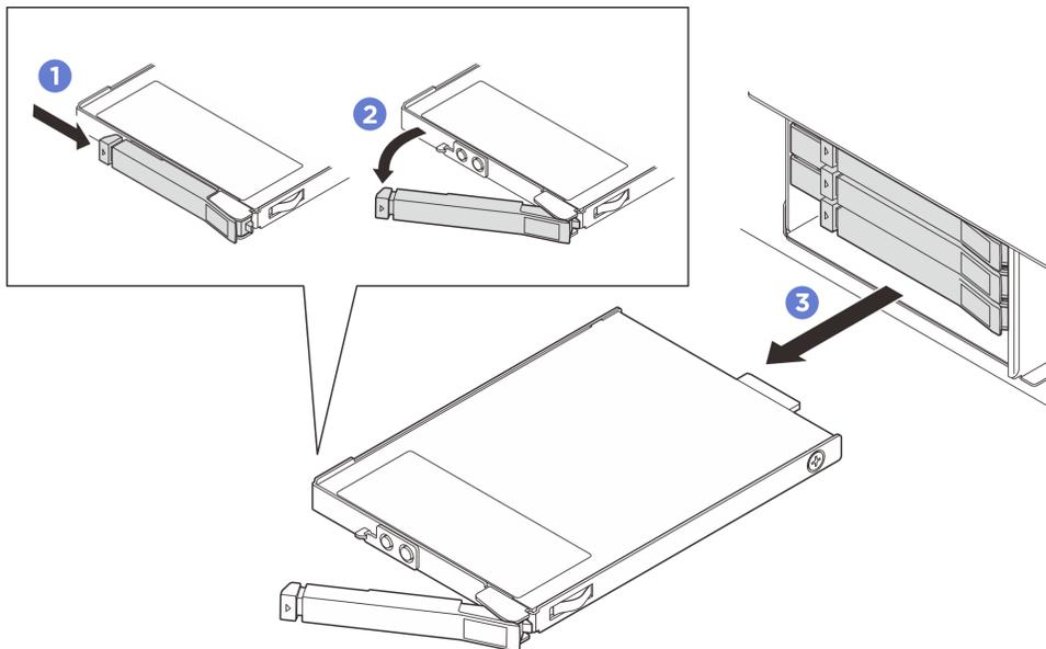
Figura 38. Rimozione di un'unità hot-swap E3.S
