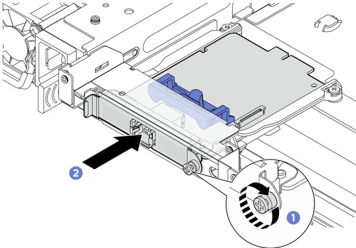
Figura 133. Installazione dell'adattatore NIC di gestione
