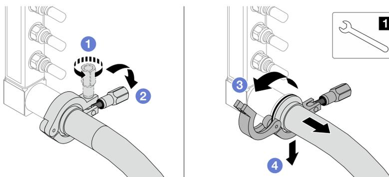
Figura 148. Separazione del collettore dal set di collegamento
