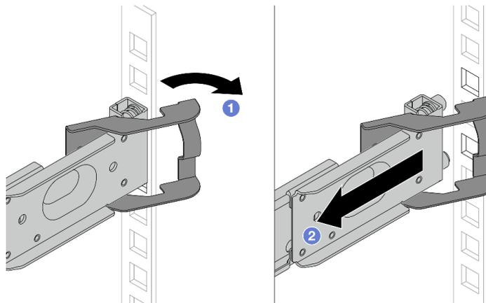
Figura 4. Rimozione della guida sulla parte posteriore
