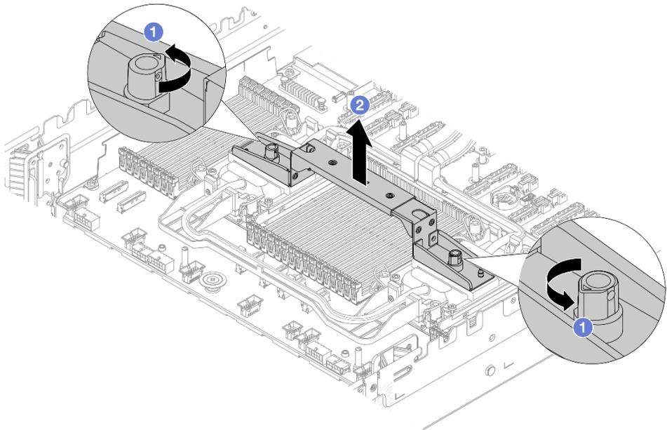
Figura 98. Rimozione della maniglia del modulo
