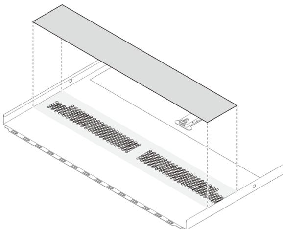
Figura 244. Coperchio superiore in mylar
