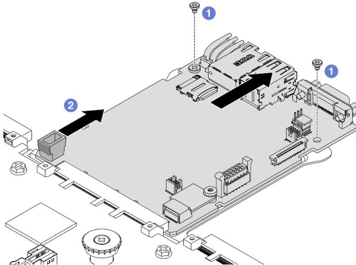
Figura 232. Separazione della scheda I/O di sistema dalla scheda del processore
