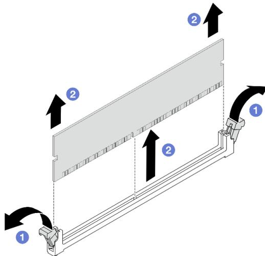
Figura 182. Rimozione del modulo di memoria
