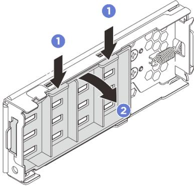
Figura 43. Rimozione della piastra interna
