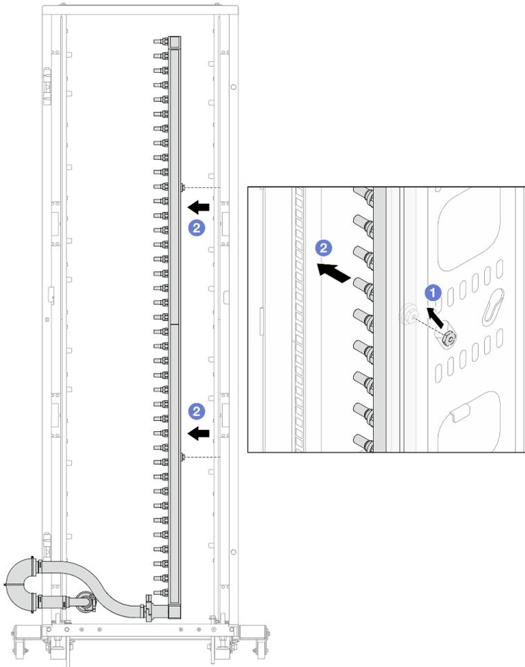
Figura 143. Rimozione del collettore
