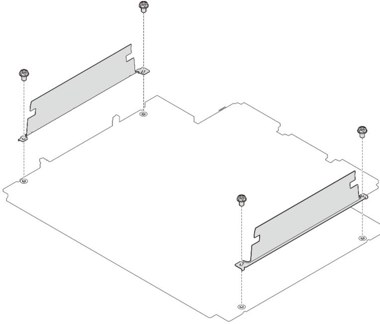
Figura 33. Rimozione delle pareti dei cavi
