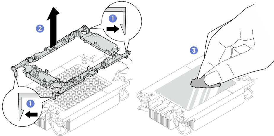
Figura 191. Separazione di una piastra del processore dal dissipatore di calore
