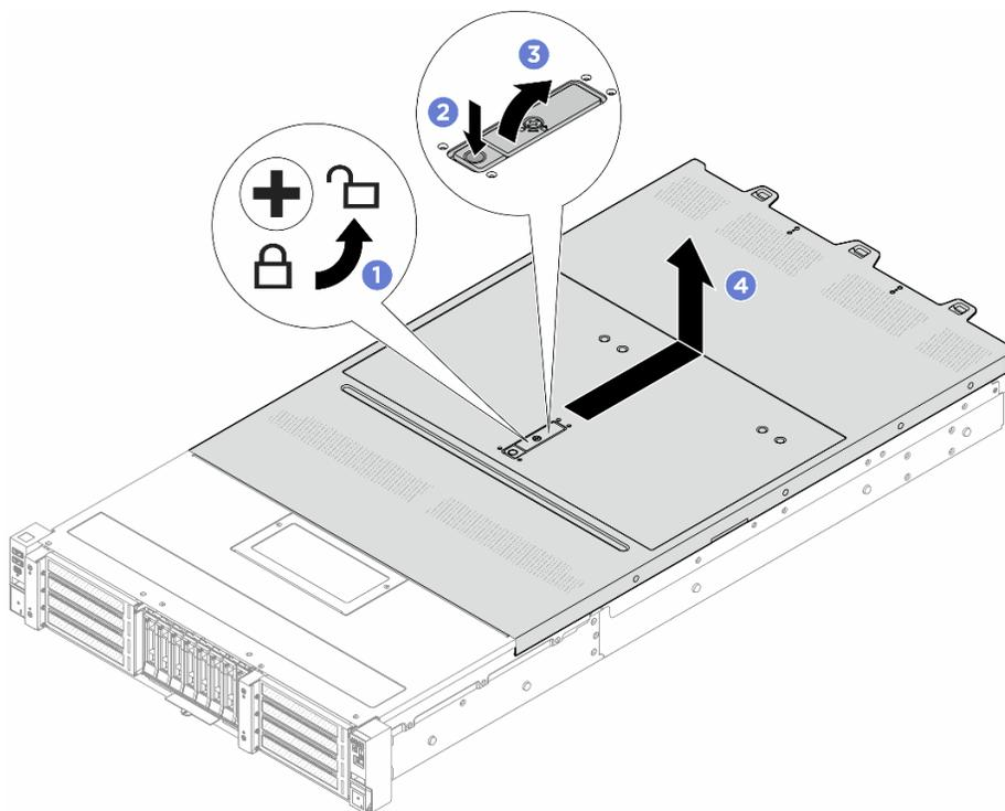
Figura 243. Rimozione del coperchio superiore
