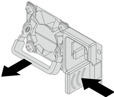
Figura 69. Rimozione dell'unità di alimentazione hot-swap
