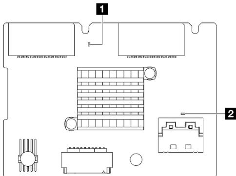
Figura 257. LED del backplane M.2 posteriore
