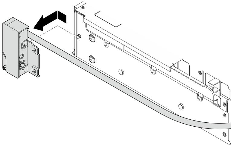
Figura 201. Rimozione del fermo del rack
