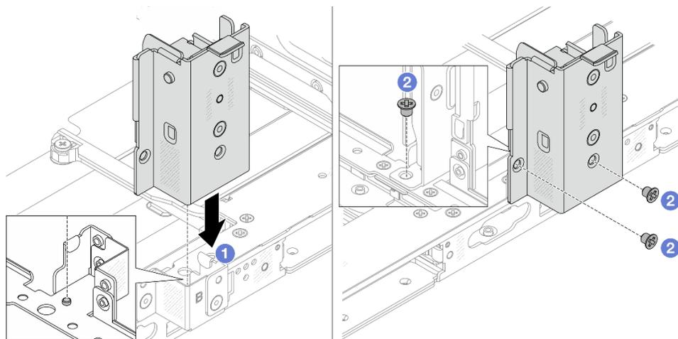
Figura 222. Installazione della staffa posteriore centrale per il montaggio a parete
