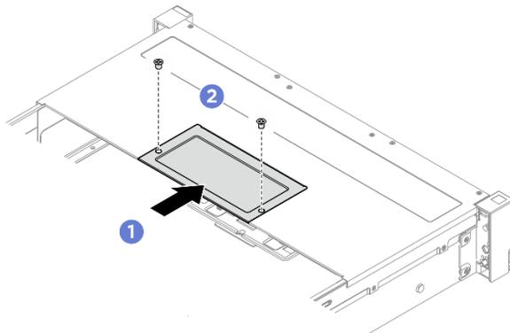
Figura 26. Installazione della piastra di copertura
