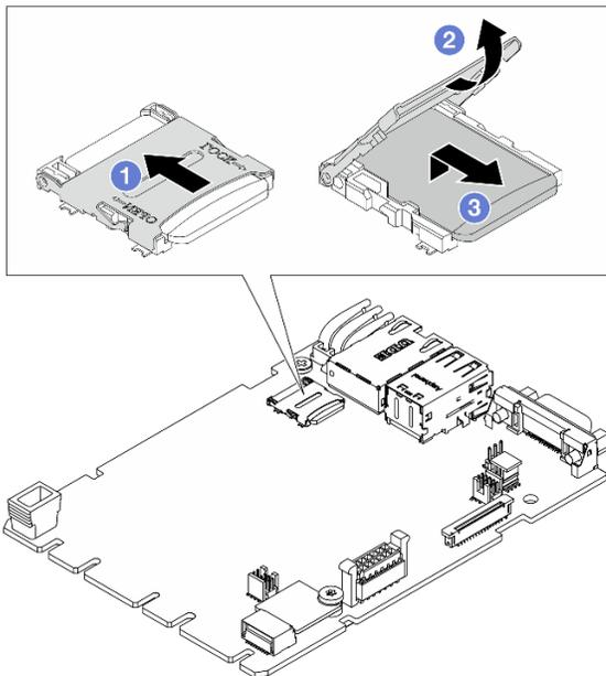
Figura 184. Rimozione della scheda MicroSD
