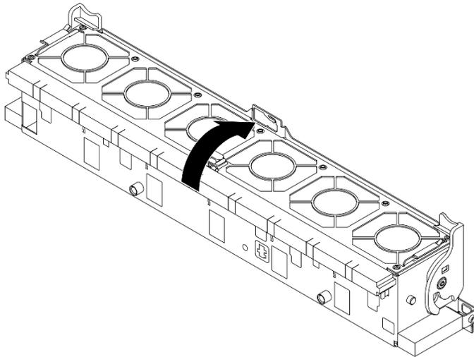
*Figura 86. Rotazione dell'alloggiamento della ventola*
