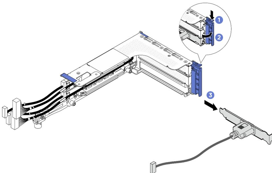
Figura 225. Rimozione del modulo della porta seriale
