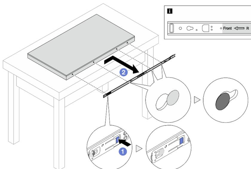
Figura 10. Rimozione delle guide interne
