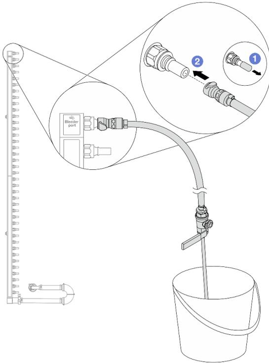
Figura 144. Installazione del kit di sfiato sul lato di alimentazione
