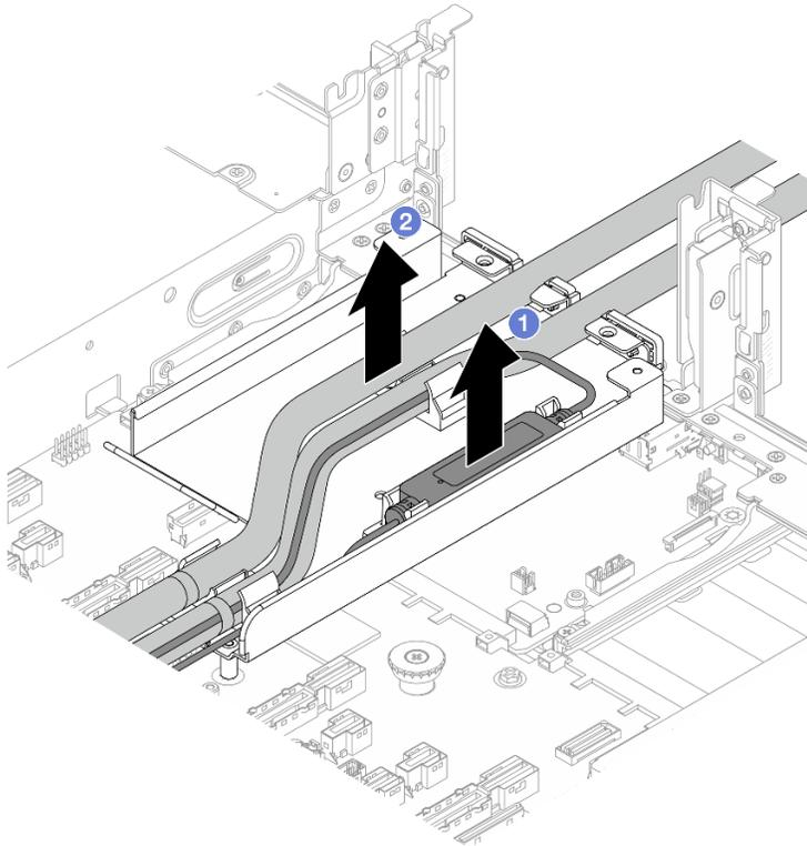
Figura 91. Sganciamento di tubi e modulo del sensore di rilevamento dei liquidi
