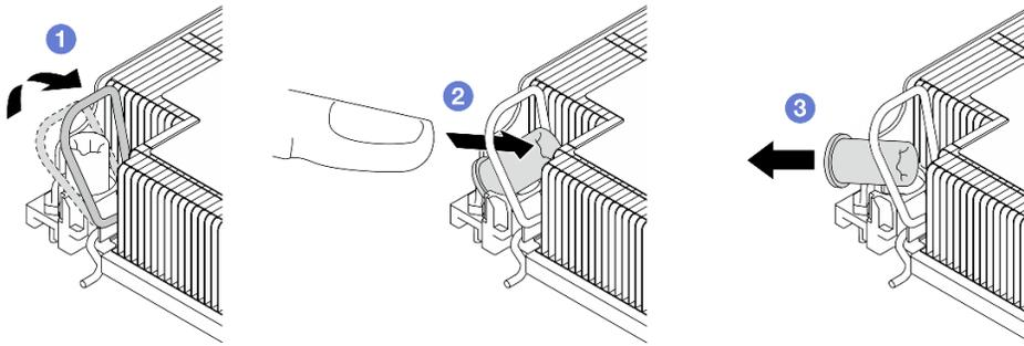
Figura 65. Rimozione di un dado Torx T30 dal dissipatore di calore
