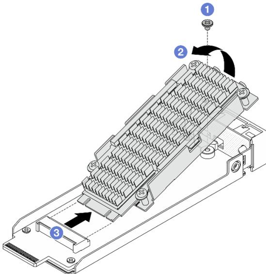
Figura 109. Rimozione dell'unità M.2 con dissipatore di calore
