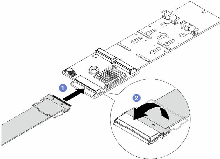
Figura 85. Collegamento del cavo M.2
