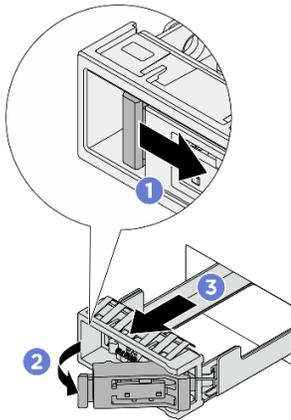
Figura 107. Rimozione del vassoio di un'unità M.2
