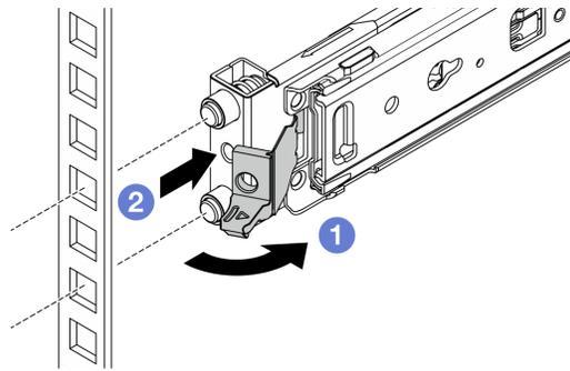
Figura 3. Rimozione della guida sulla parte anteriore
