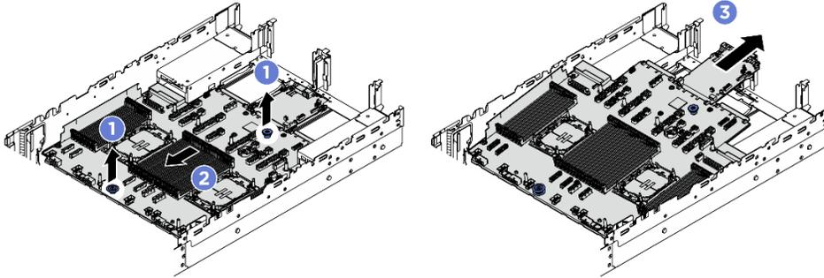
Figura 231. Rimozione dell'assieme della scheda di sistema
