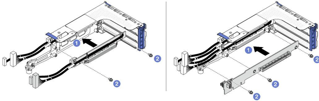
Figura 215. Installazione delle schede verticali nel telaio verticale 3FH
