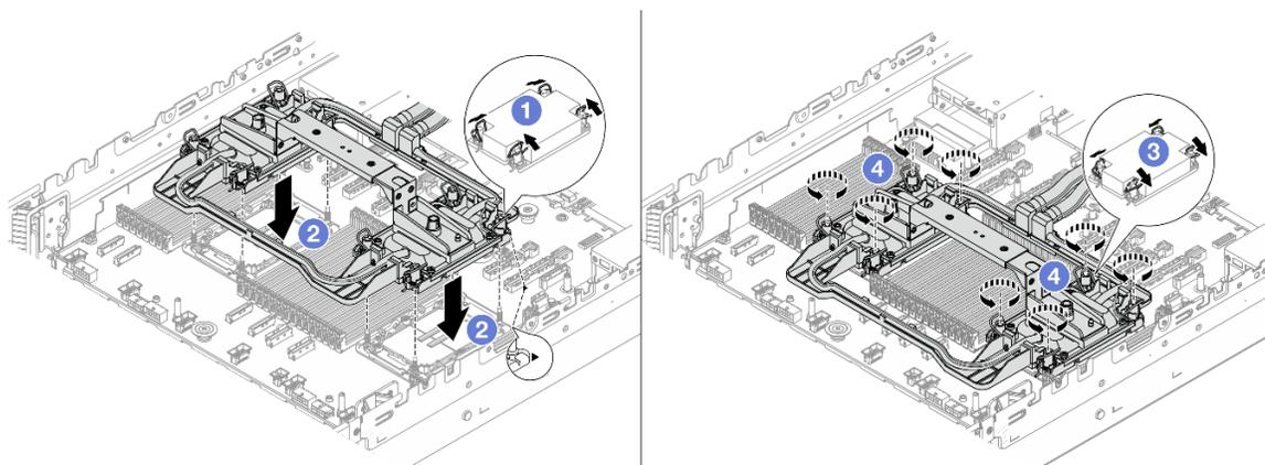
Figura 97. Installazione del Processor Neptune Core Module
