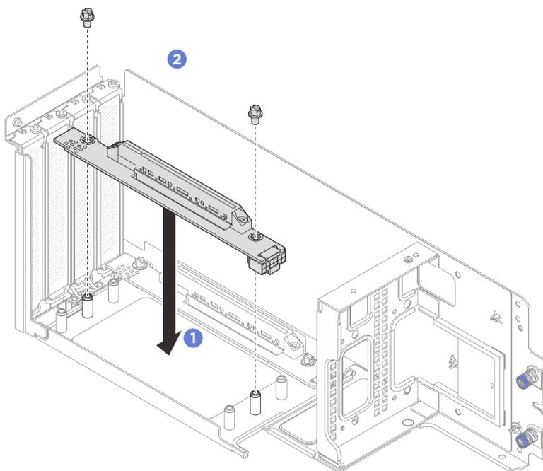
Figura 63. Installazione della scheda verticale
