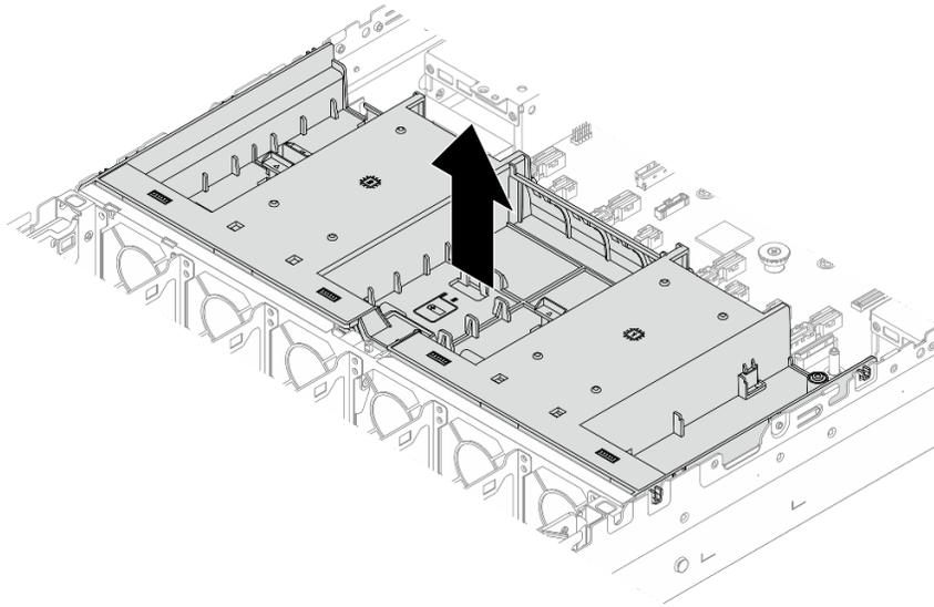
Figura 27. Rimozione del deflettore d'aria
