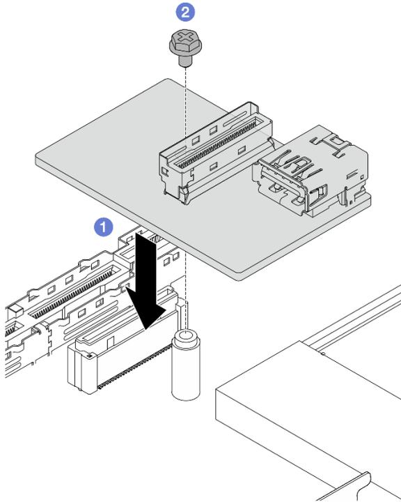
Figura 247. Installazione della scheda I/O USB
