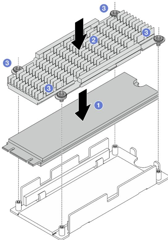
Figura 114. Installazione dell'unità M.2
