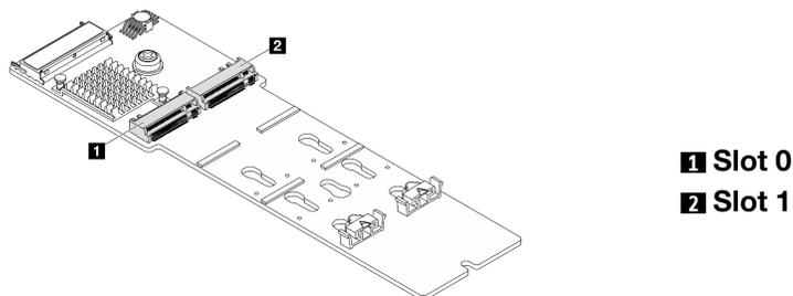
Figura 80. Slot dell'unità M.2
