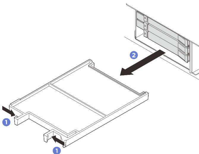
Figura 40. Rimozione di un elemento di riempimento del vano
