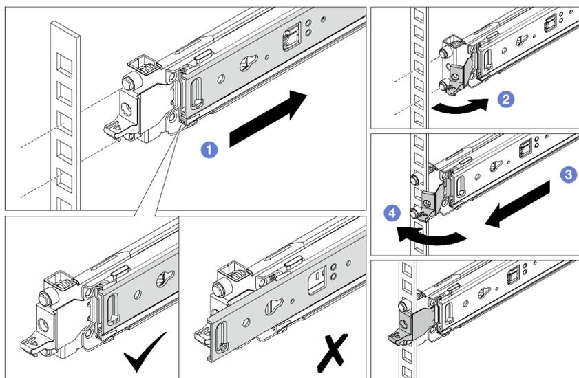
Figura 6. Installazione dei piedini di montaggio anteriori
