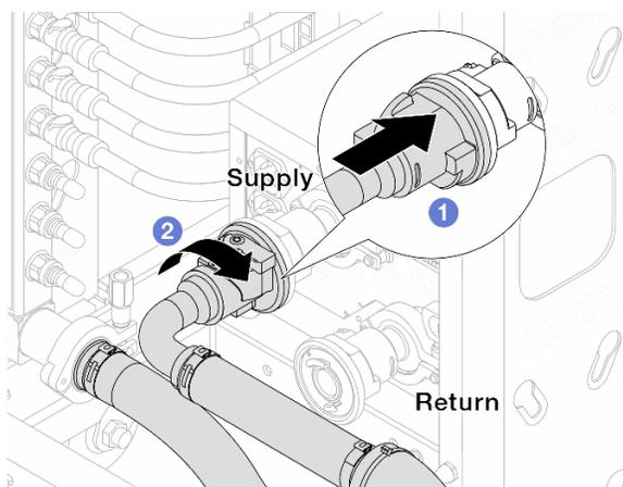
Figura 153. Collegamento delle valvole a sfera
