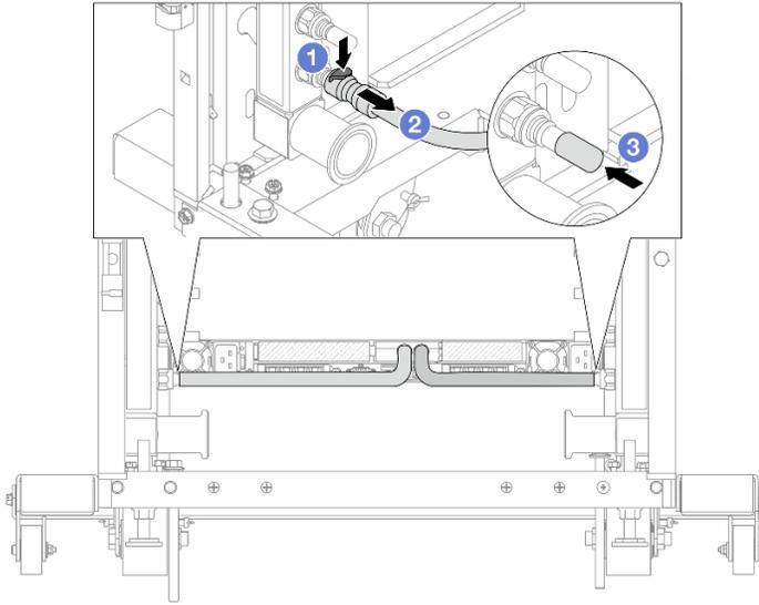
Figura 141. Rimozione della presa di collegamento
