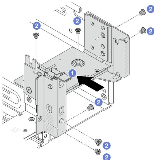
Figura 223. Installazione della staffa posteriore destra per il montaggio a parete
