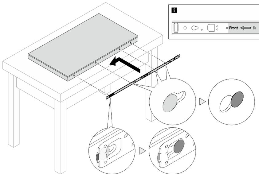
Figura 12. Installazione delle guide interne
