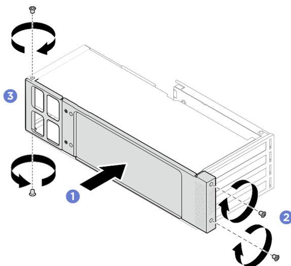
Figura 59. Installazione della staffa di supporto laterale
