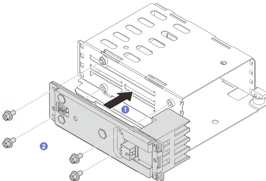
Figura 50. Installazione dell'assieme backplane
