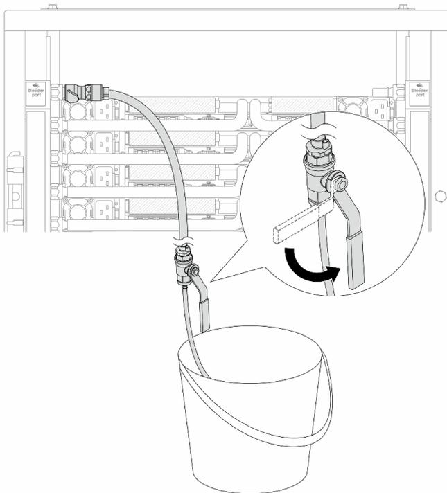
*Figura 159. Apertura della valvola di sfiato sul lato di alimentazione*
