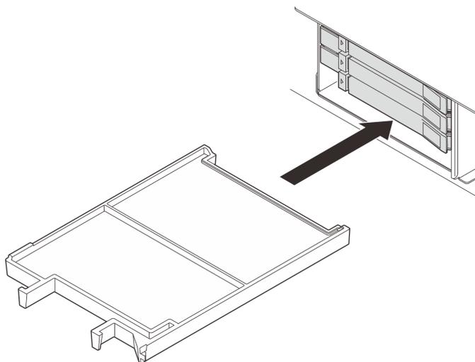
Figura 42. Installazione di un elemento di riempimento del vano
