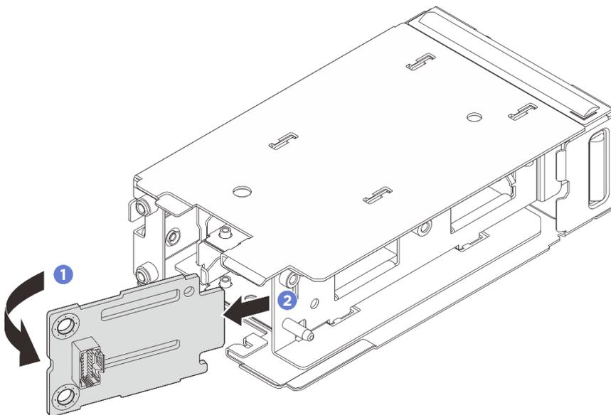
Figura 122. Rimozione del backplane di avvio M.2 anteriore
