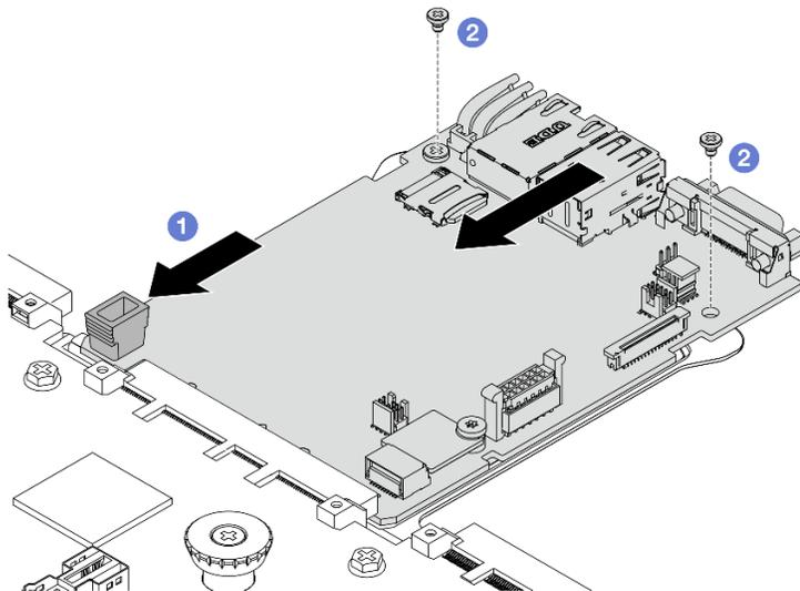
Figura 237. Installazione della scheda I/O di sistema sulla scheda del processore
