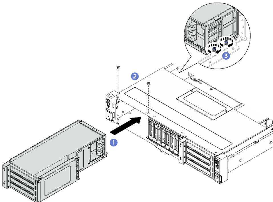
Figura 60. Installazione dell'assieme verticale anteriore
