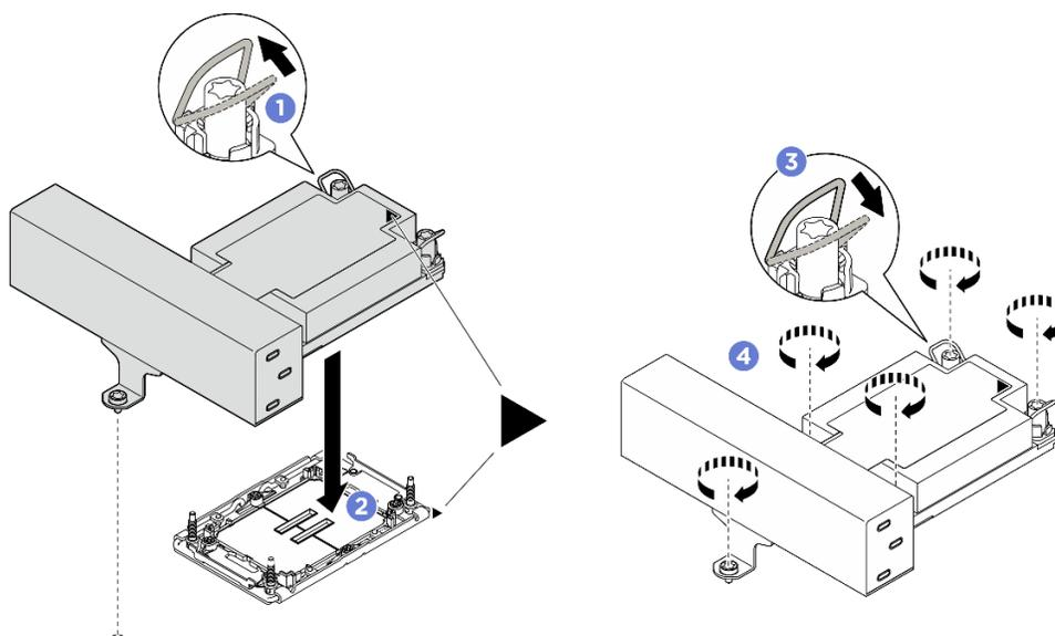
Figura 198. Installazione di un PHM ad alte prestazioni a forma di T 1U
