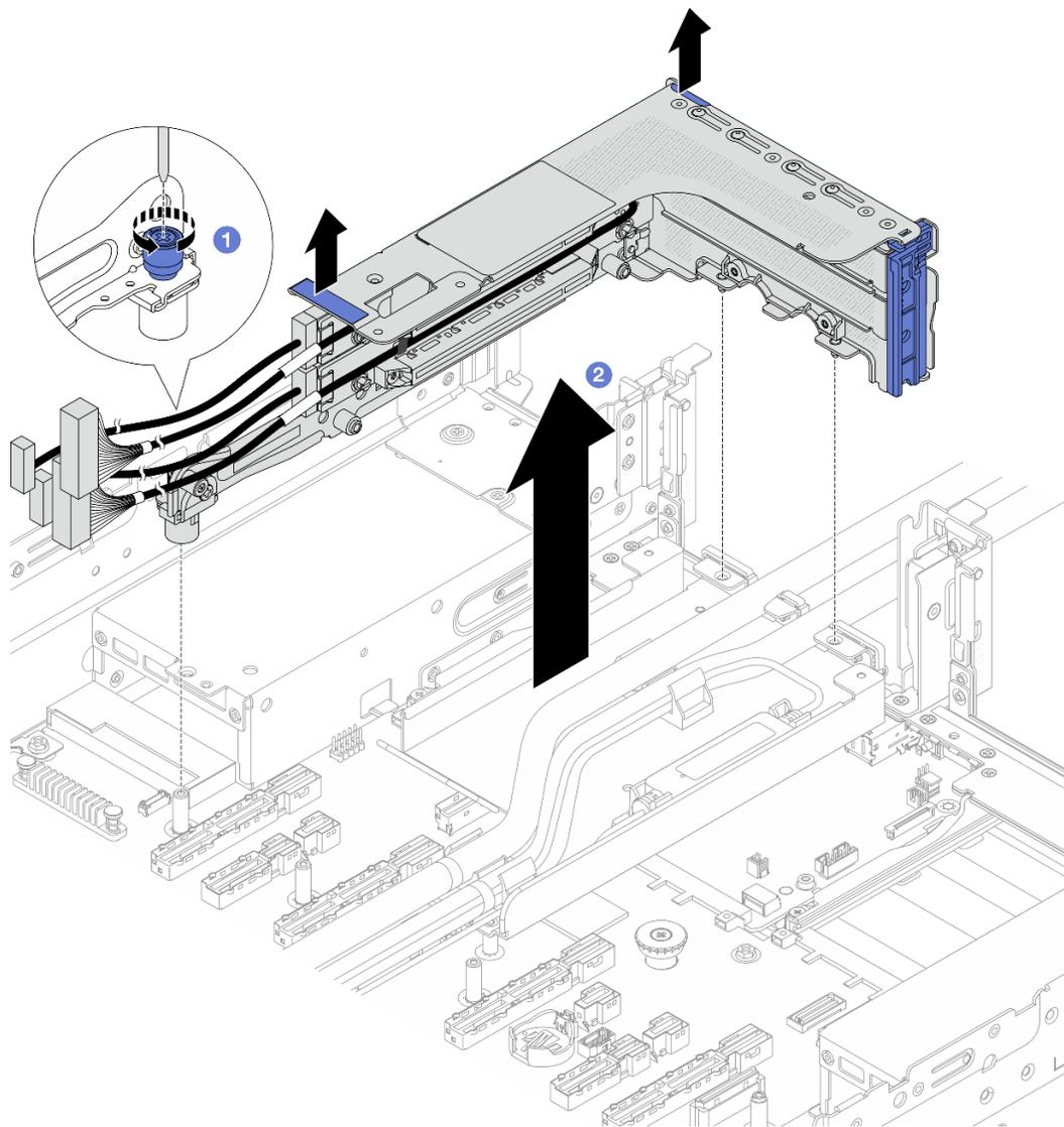
Figura 90. Rimozione del telaio verticale 3FH
