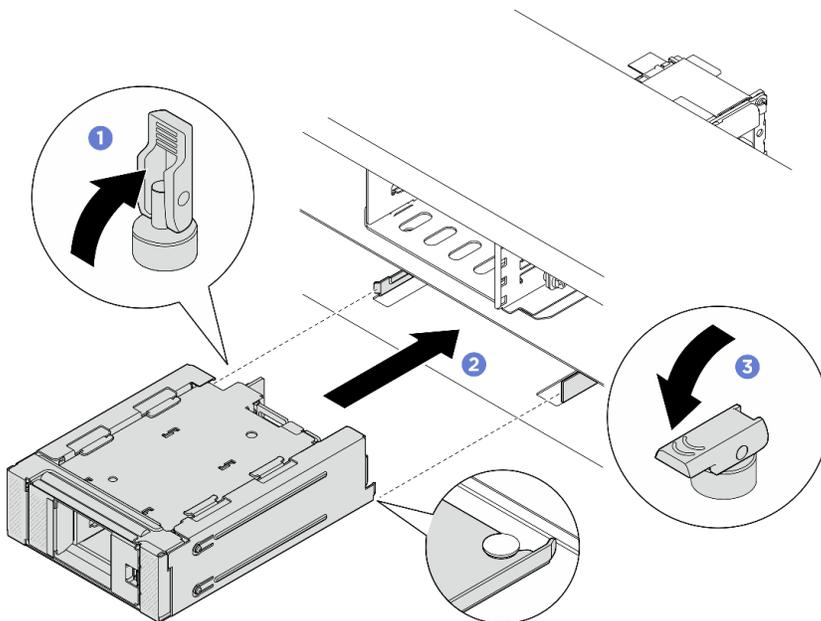
Figura 128. Installazione del telaio unità M.2 anteriore con l'intelaiatura
