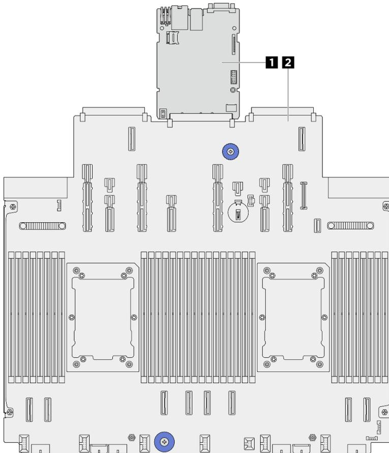
Figura 230. Layout dell'assieme della scheda di sistema
