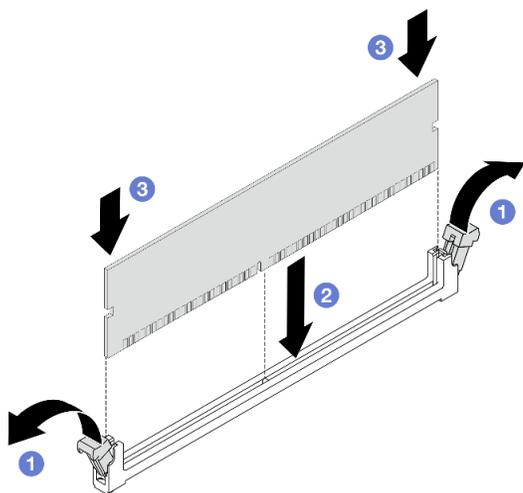
Figura 183. Installazione del modulo di memoria
