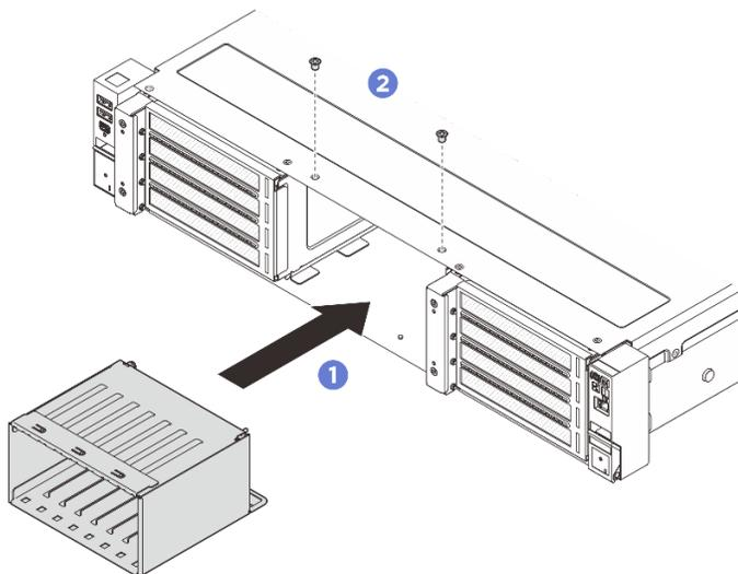
Figura 24. Installazione del telaio dell'unità da 2,5"
