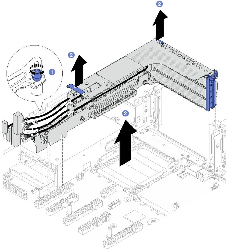
Figura 212. Rimozione dell'assieme verticale 3FH
