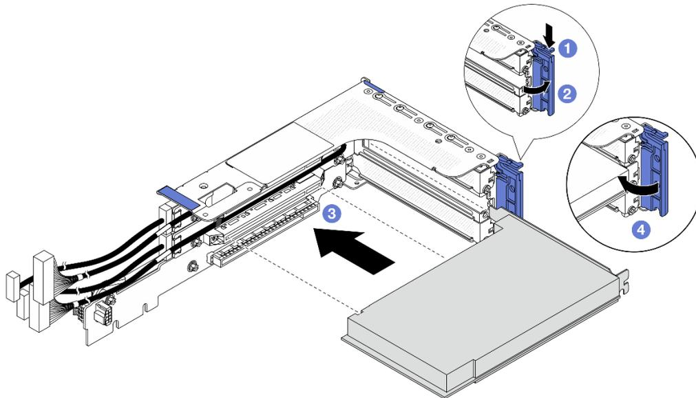
Figura 216. Installazione di un adattatore PCIe nel telaio verticale 3FH
