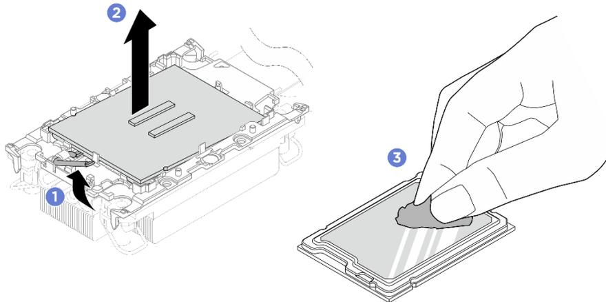
Figura 190. Separazione di un processore dal dissipatore di calore e dalla piastra
