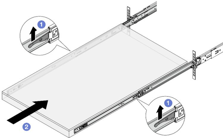
Figura 15. Blocco delle guide e scorrimento del server
