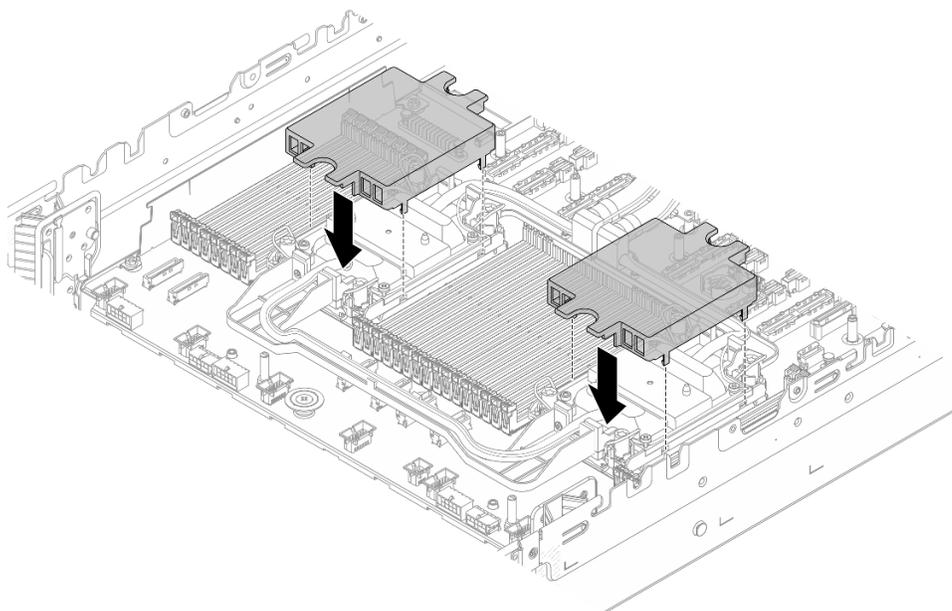
Figura 99. Installazione dei coperchi della piastra a freddo
