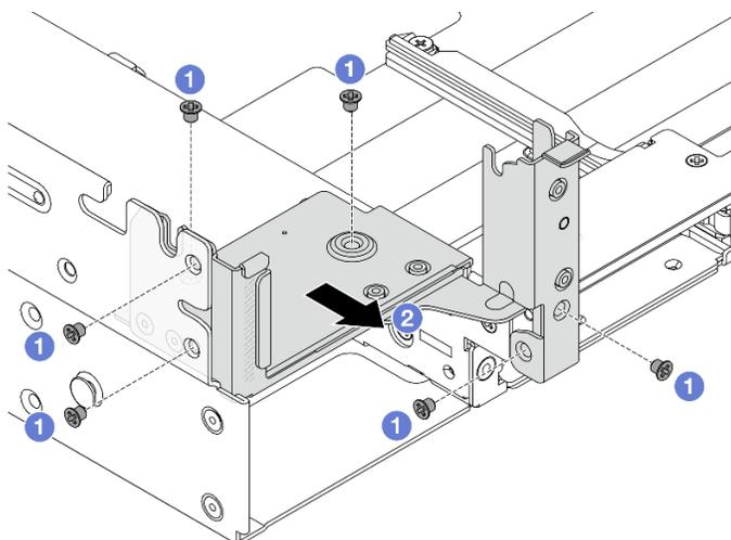
Figura 218. Rimozione della staffa posteriore sinistra per il montaggio a parete
