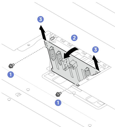
Figura 22. Rimozione del backplane dell'unità da 2,5"
