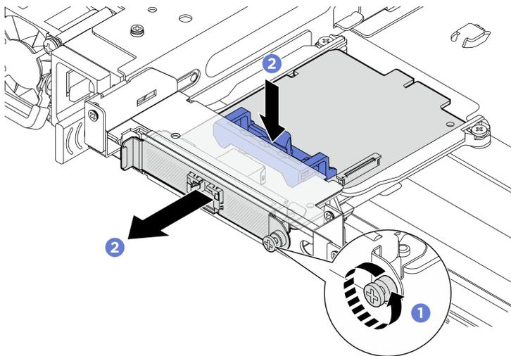
Figura 132. Rimozione dell'adattatore NIC di gestione
