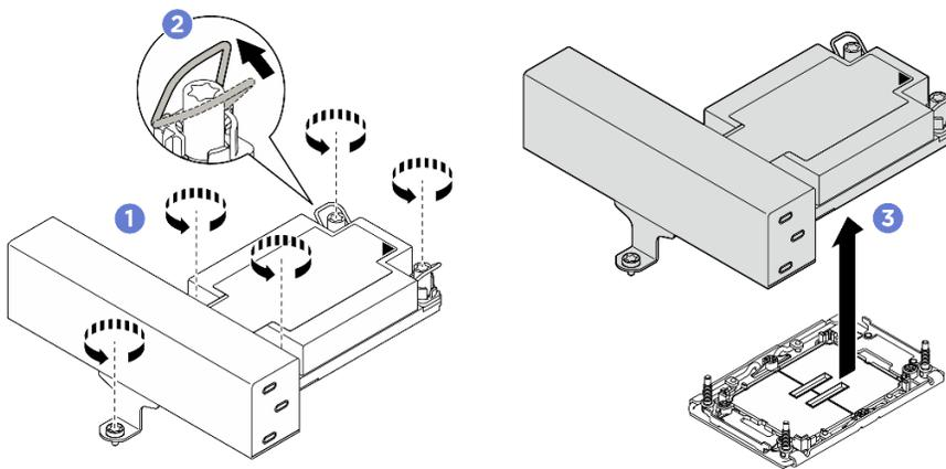
Figura 188. Rimozione di un PHM 1U ad alte prestazioni a T
