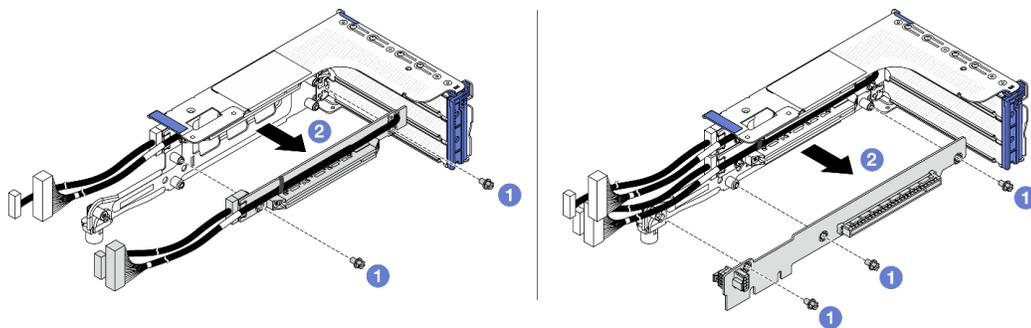
Figura 214. Rimozione delle schede verticali dal telaio verticale
