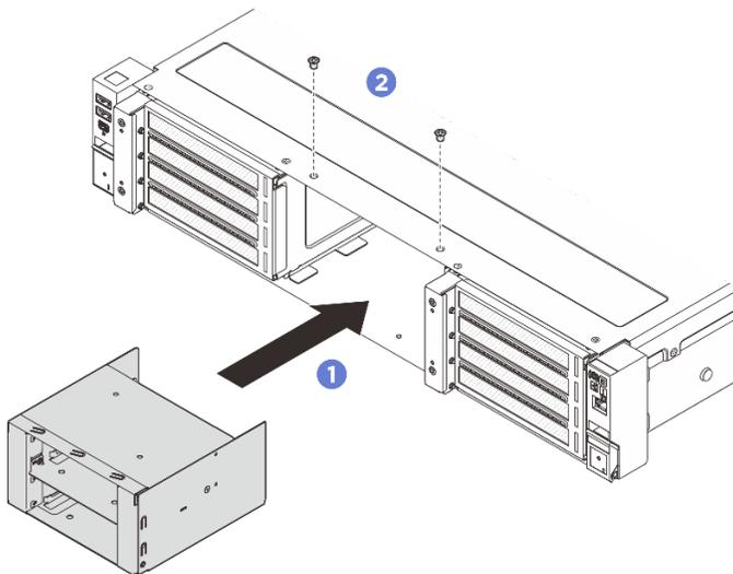
Figura 49. Installazione del telaio E3.S
