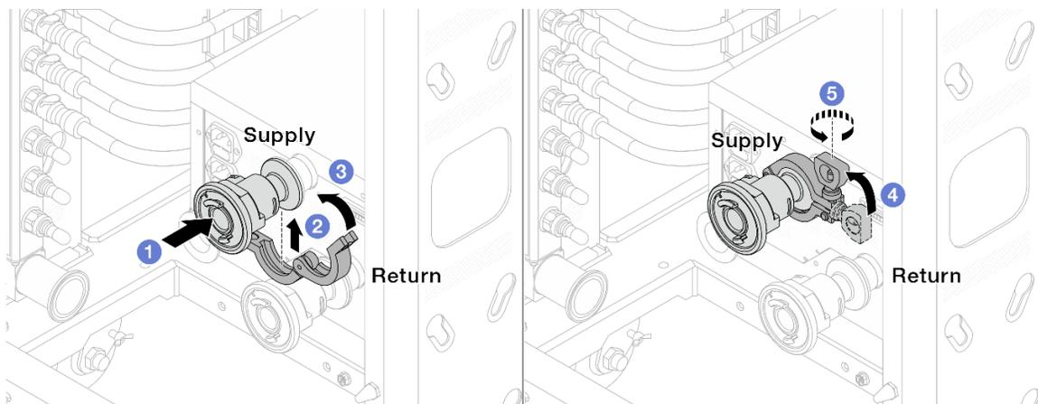
Figura 151. Installazione delle valvole a sfera
