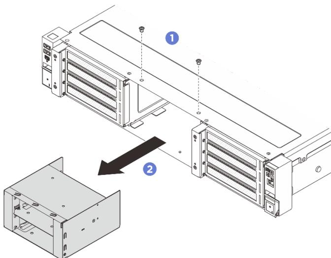
Figura 48. Rimozione del telaio unità E3.S
