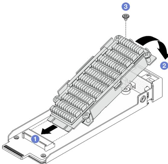
Figura 116. Installazione dell'unità M.2 con dissipatore di calore
