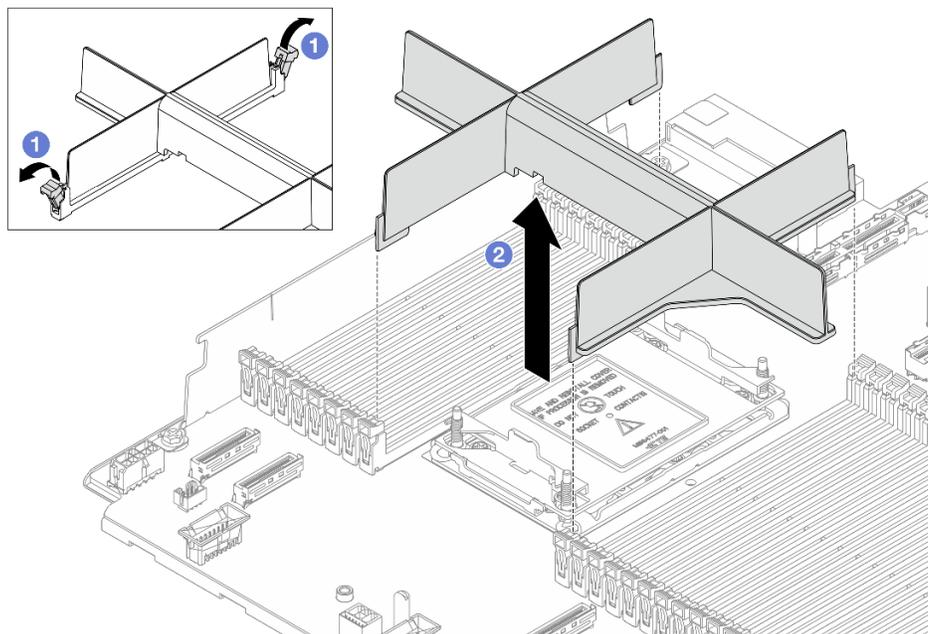
Figura 196. Rimozione di un elemento di riempimento del PHM
