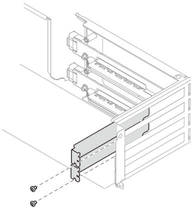
Figura 55. Elemento di riempimento dello slot PCIe
