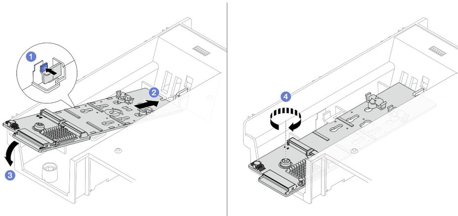
Figura 84. Installazione del backplane M.2 sul deflettore d'aria
