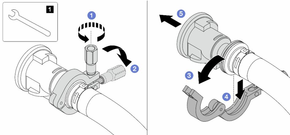
Figura 150. Separazione delle valvole a sfera
