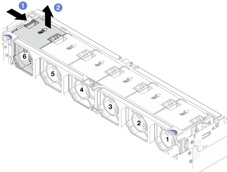
Figura 239. Rimozione della ventola del sistema
