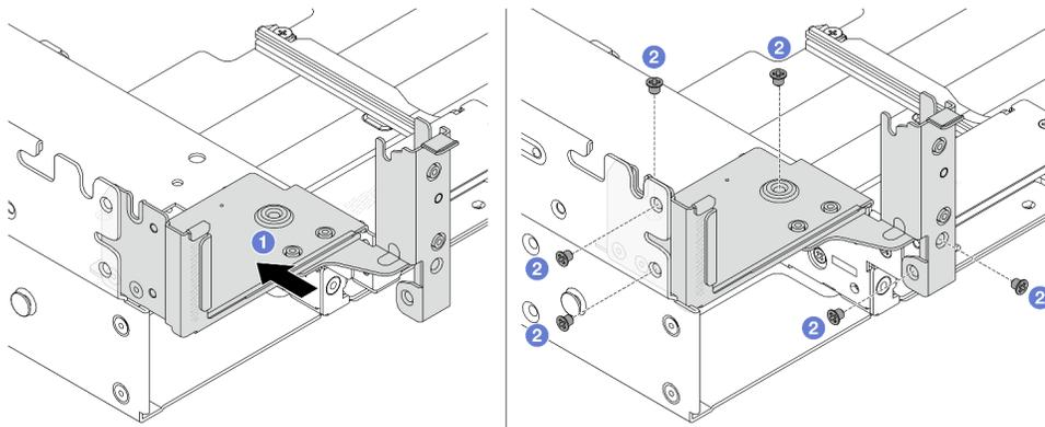
Figura 221. Installazione della staffa posteriore sinistra per il montaggio a parete
