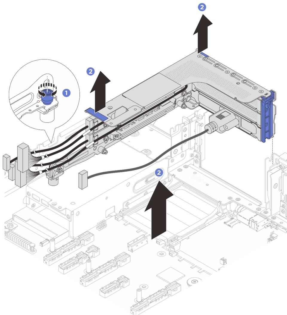
Figura 224. Rimozione dell'assieme verticale
