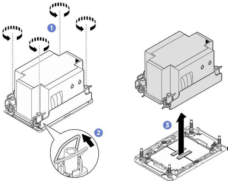
Figura 187. Rimozione di un PHM 2U standard
