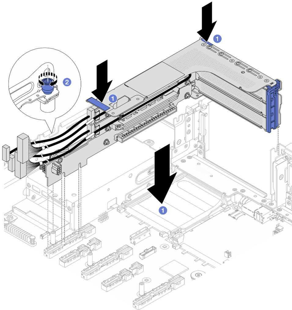
Figura 217. Installazione dell'assieme verticale 3FH
