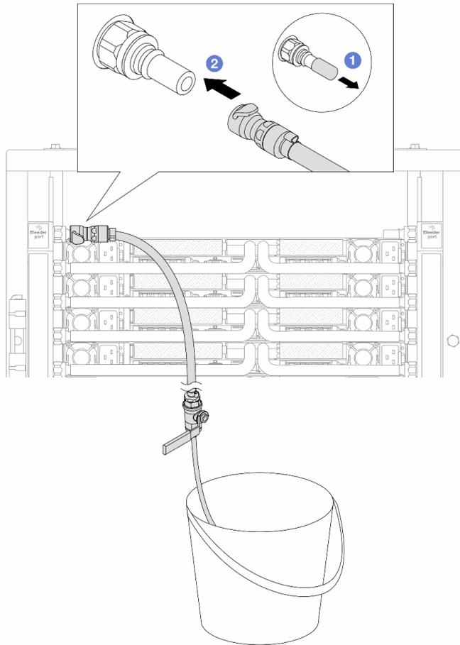
Figura 174. Installazione del kit di sfiato sul lato di alimentazione
