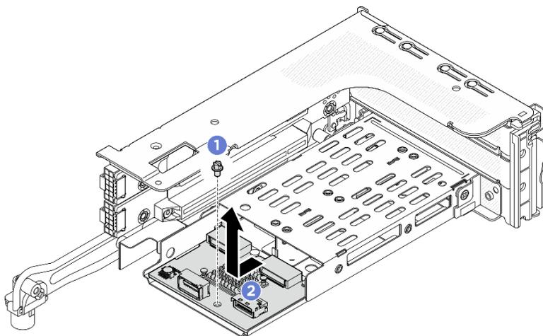
Figura 130. Rimozione del backplane M.2 dal telaio verticale M.2 3FH.
