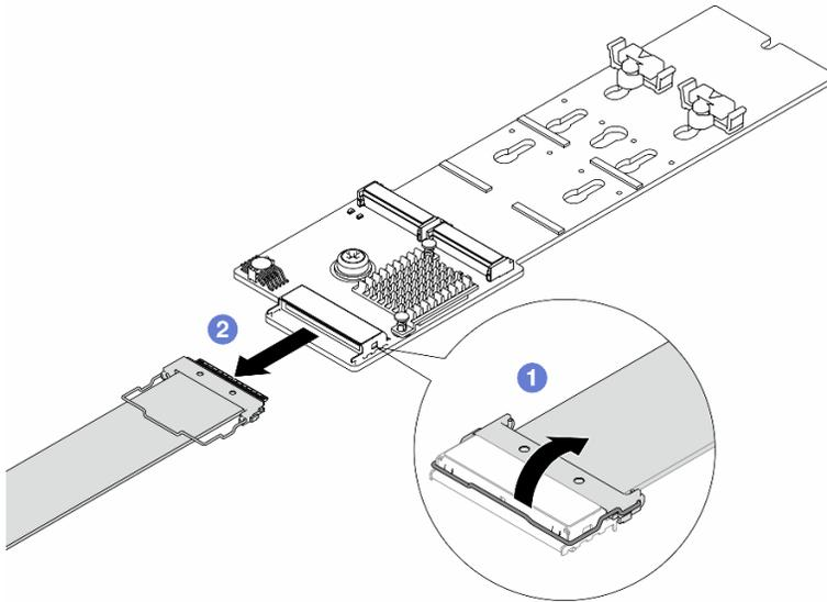
Figura 82. Scollegamento del cavo M.2
