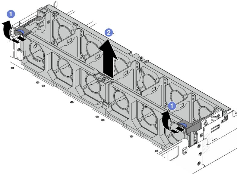
Figura 241. Rimozione dell'alloggiamento delle ventole di sistema
