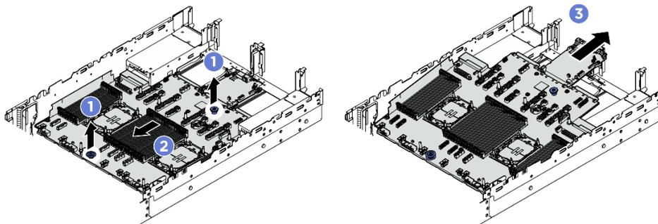
Figura 235. Rimozione dell'assieme della scheda di sistema
