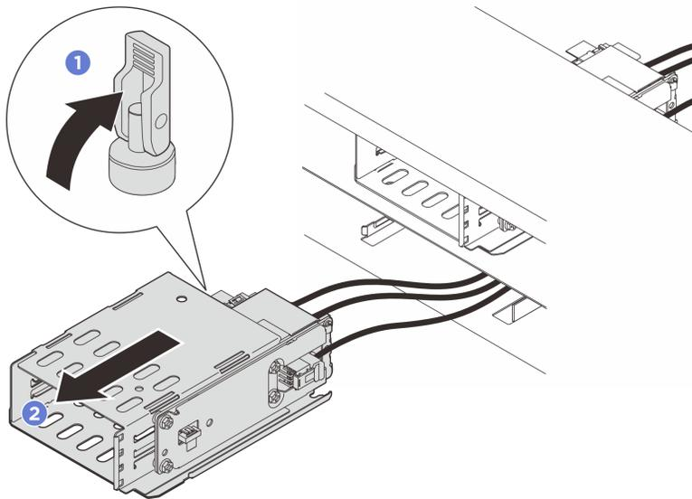
Figura 46. Rimozione del telaio 1T E3.S
