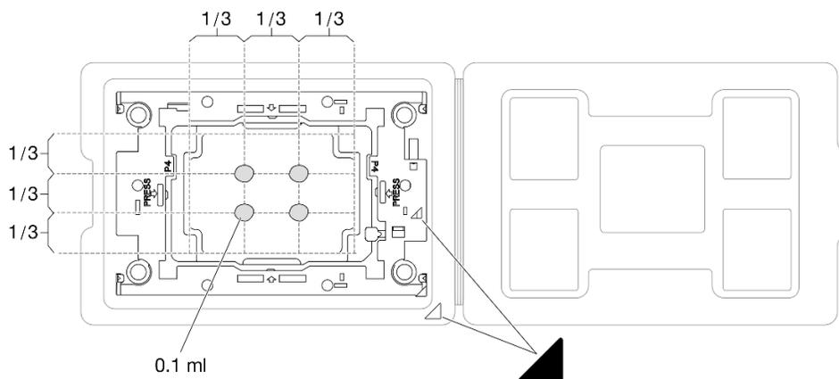
Figura 194. Applicazione del lubrificante termico con il processore nella confezione di spedizione
