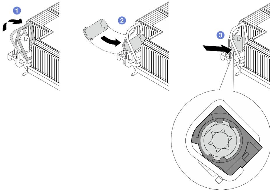
Figura 66. Installazione di un dado Torx T30 nel dissipatore di calore
