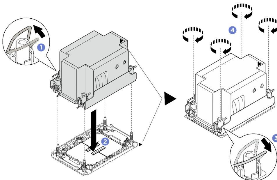
Figura 197. Installazione di un PHM 2U standard
