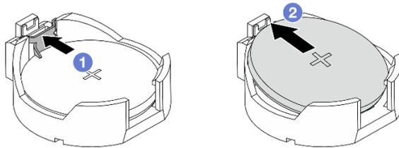
Figura 35. Rimozione della batteria CMOS
