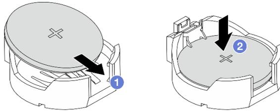
**Nota:** Prima di installare la batteria nel socket, assicurarsi che il lato positivo sia rivolto verso l'alto.
