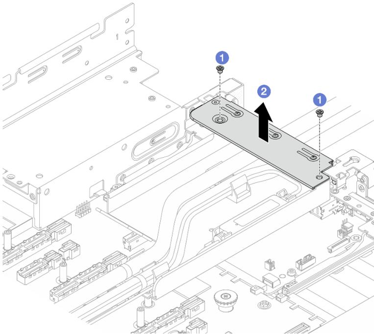
Figura 89. Rimozione della staffa 1FH
