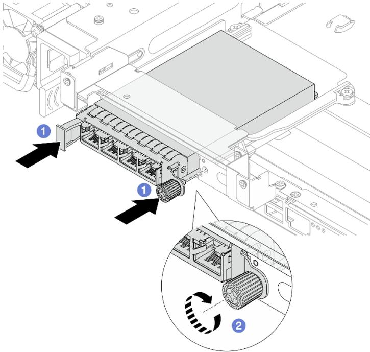
Figura 209. Installazione del modulo OCP posteriore
