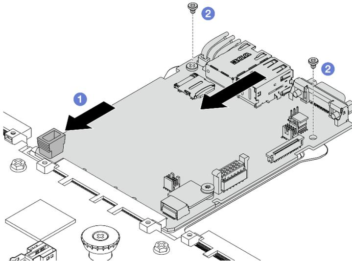
Figura 233. Installazione della scheda I/O di sistema sulla scheda del processore
