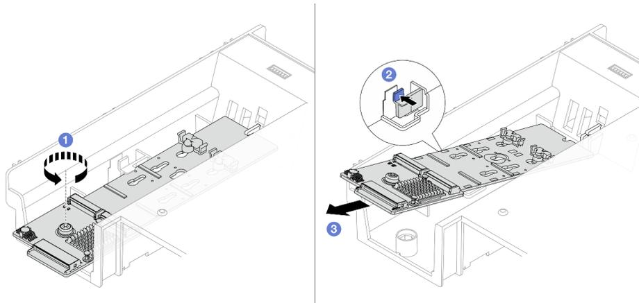
Figura 83. Rimozione del backplane M.2 dal deflettore d'aria
