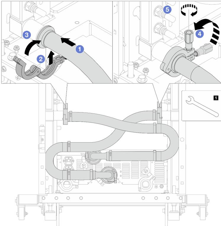
Figura 152. Installazione del set di collegamento
