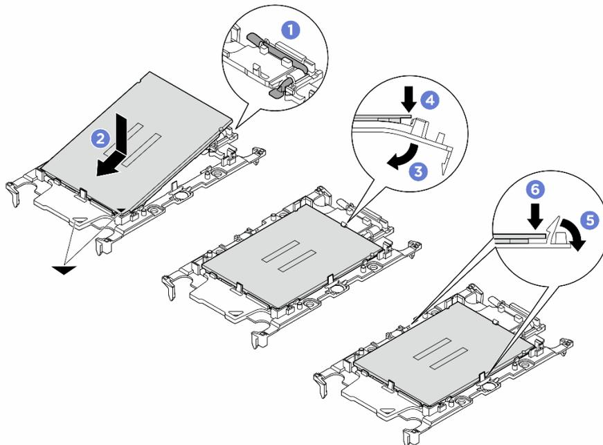
Figura 193. Installazione di una piastra del processore
