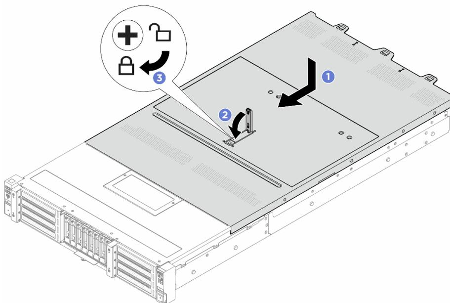
Figura 245. Installazione del coperchio superiore
