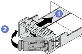
Figura 106. Installazione di un vassoio dell'unità M.2
