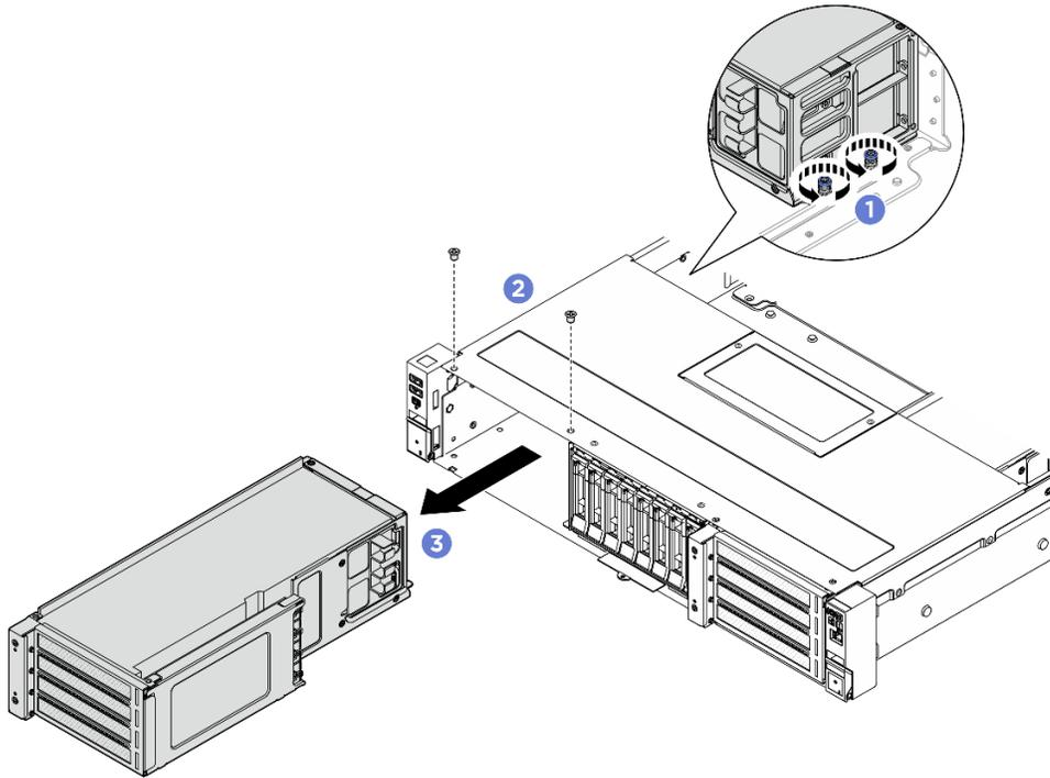
Figura 52. Rimozione di un'assieme verticale anteriore
