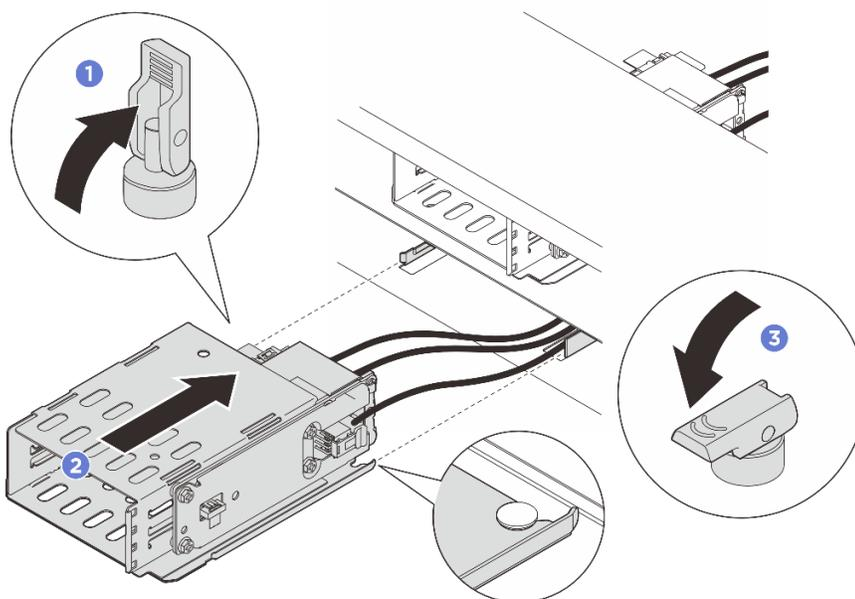
Figura 51. Installazione del telaio 1T E3.S
