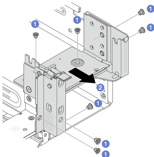
Figura 220. Rimozione della staffa posteriore destra per il montaggio a parete
