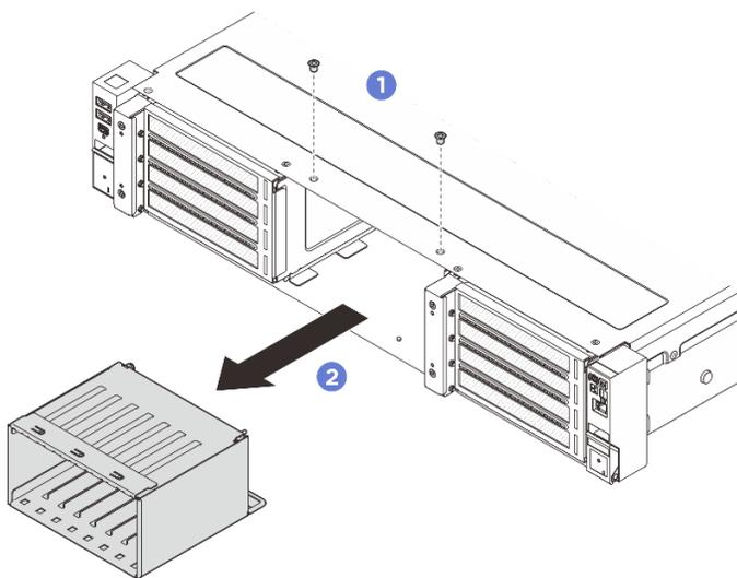
Figura 23. Rimozione del telaio dell'unità da 2,5"
