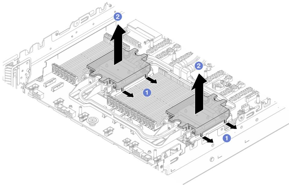
Figura 264. Rimozione del coperchio della piastra a freddo
