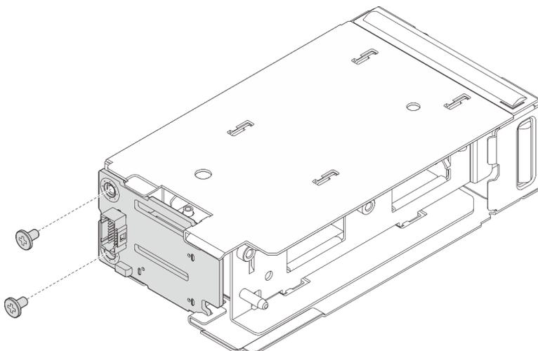
Figura 125. Installazione del backplane di avvio M.2
