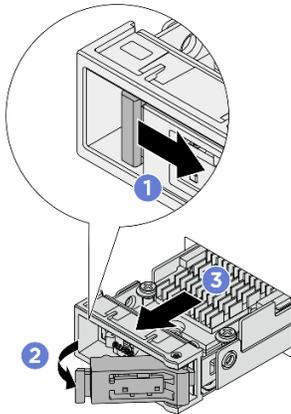
Figura 105. Rimozione di un assieme dell'unità M.2 hot-swap
