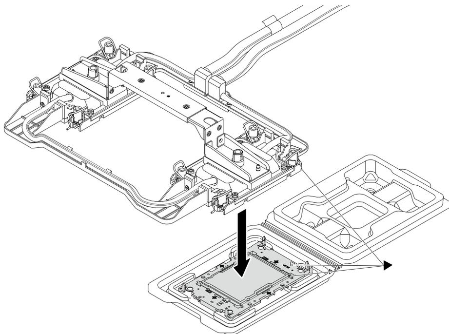
Figura 95. Installazione del processore
