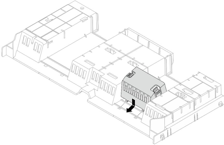
Figura 29. Installazione dell'elemento di riempimento del deflettore d'aria
