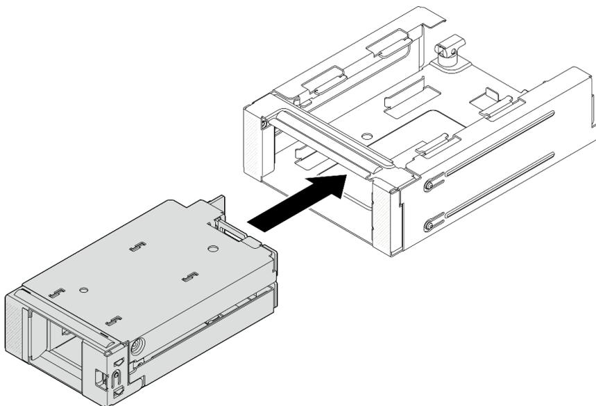
Figura 127. Installazione del telaio unità M.2 anteriore nell'intelaiatura
