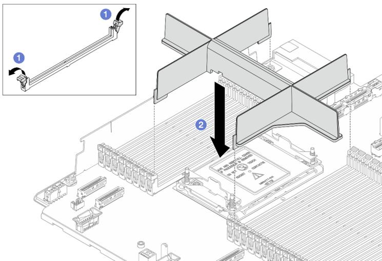
Figura 189. Installazione di un elemento di riempimento della PHM
