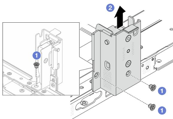
Figura 219. Rimozione della staffa posteriore centrale per il montaggio a parete
