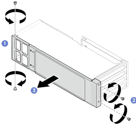
Figura 53. Rimozione della staffa di supporto laterale
