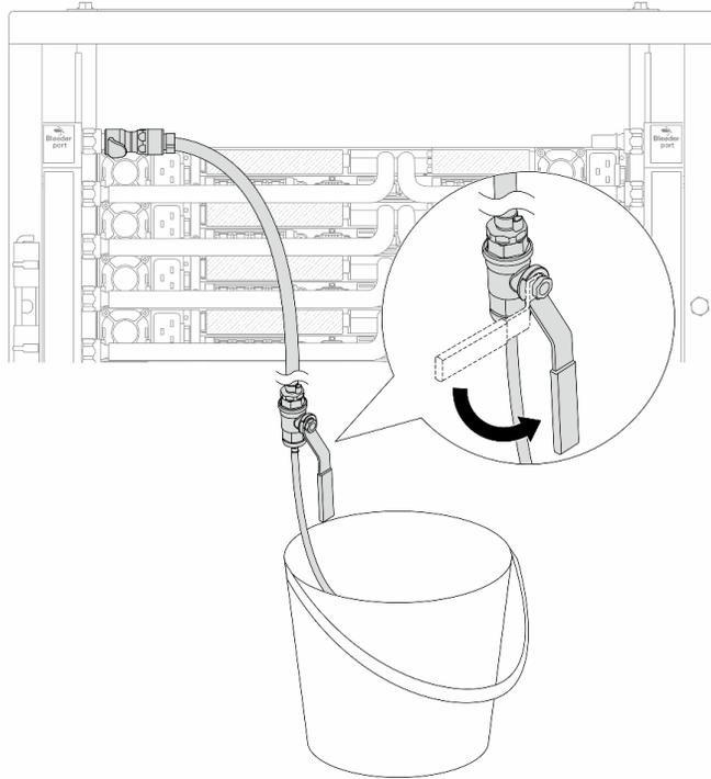
Figura 180. Apertura della valvola di sfiato sul lato di alimentazione
