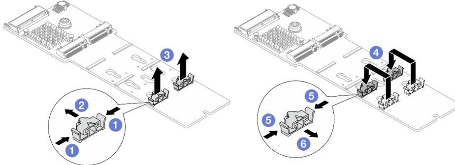
Figura 79. Regolazione del fermo M.2
