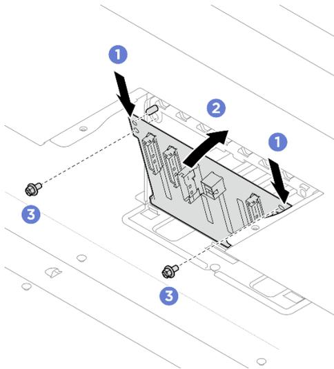
Figura 25. Installazione del backplane dell'unità da 2,5"
