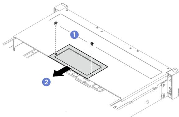
Figura 75. Rimozione della piastra di copertura
