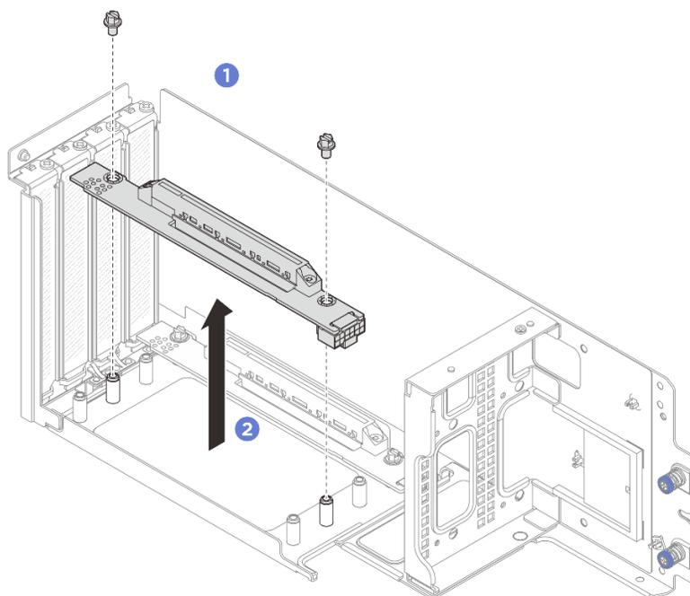
Figura 62. Rimozione della scheda verticale
