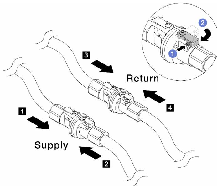
Figura 181. Apertura delle valvole a sfera
