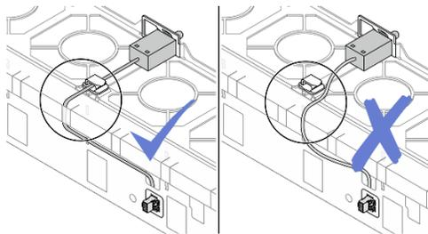
Passo 2. Installare l'alloggiamento della ventola di sistema. Vedere ["Installazione dell'alloggiamento della ventola del sistema" a pagina 251](#).
