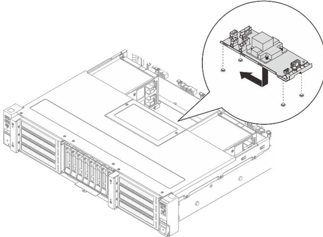
Figura 77. Installazione dell'adattatore CFF interno
