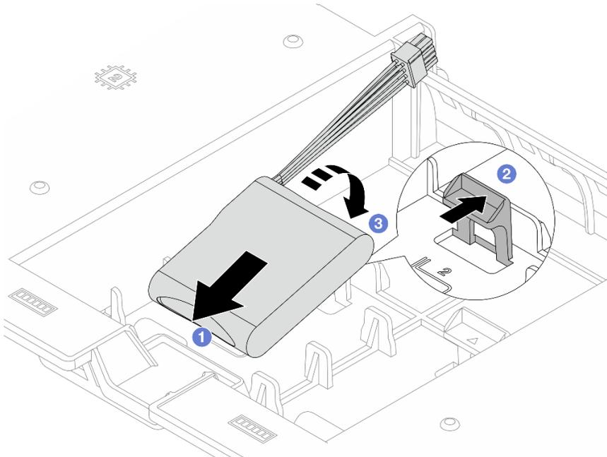
Figura 207. Installazione di un modulo di alimentazione flash RAID sul deflettore d'aria
