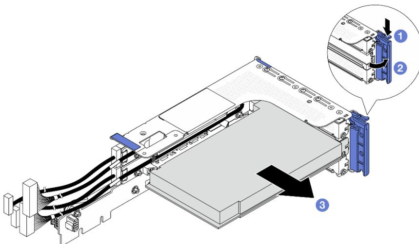
Figura 213. Rimozione di un adattatore PCIe dal telaio verticale 3FH
