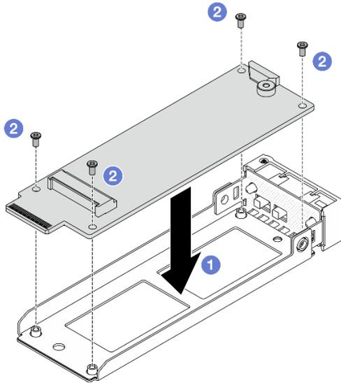
Figura 115. Installazione dell'interposer M.2
