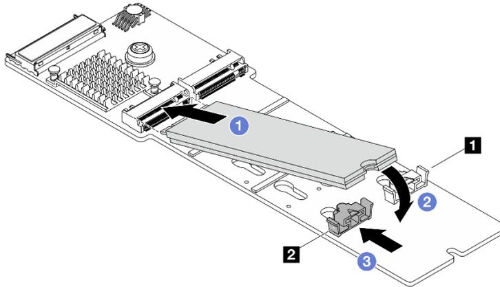
Figura 81. Installazione dell'unità M.2
