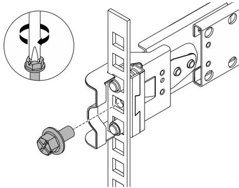
Figura 17. Fissaggio del server alla parte posteriore del rack
