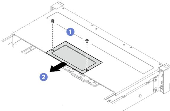
Figura 45. Rimozione della piastra di copertura
