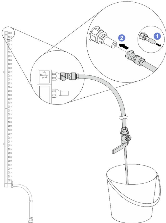
Figura 166. Installazione del kit di sfiato sul lato di alimentazione
