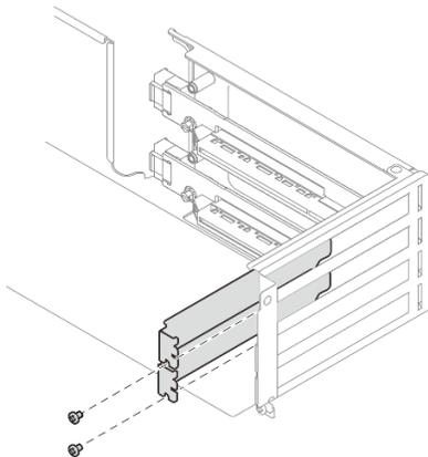
Figura 56. Elemento di riempimento dello slot PCIe
