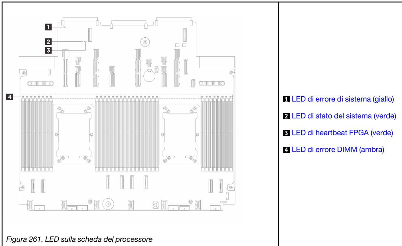
Figura 261. LED sulla scheda del processore
