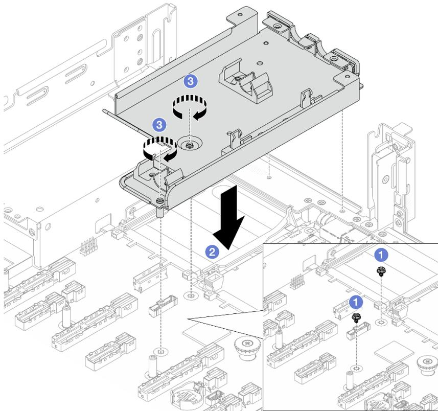
Figura 94. Installazione del supporto del tubo
