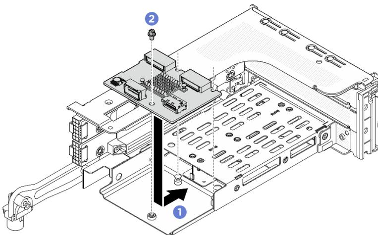
Figura 131. Installazione del backplane M.2 nel telaio verticale M.2 3FH
