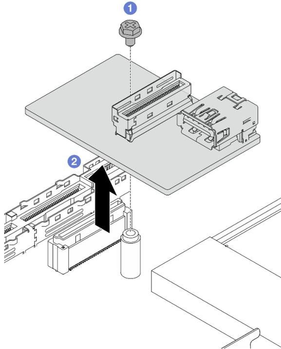
Figura 246. Rimozione della scheda I/O USB
