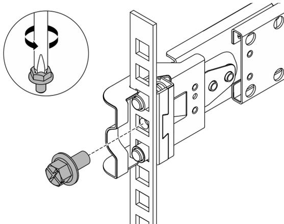
Figura 2. Rimozione della vite M6
