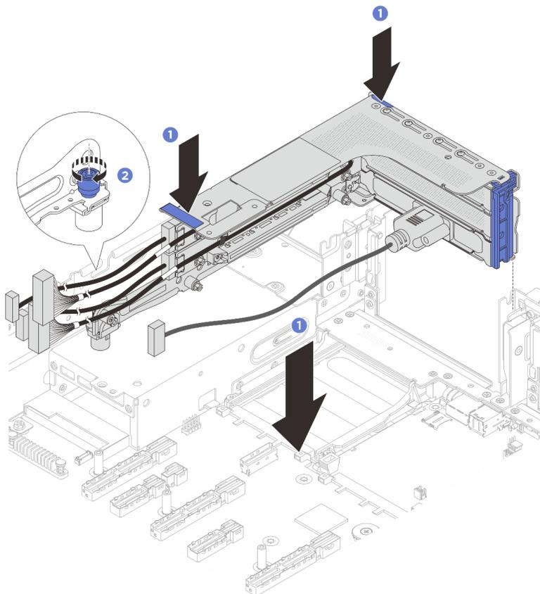
Figura 229. Installazione dell'assieme verticale
