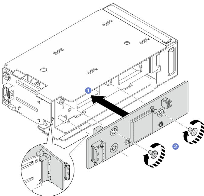
Figura 126. Installazione della scheda controller M.2 anteriore
