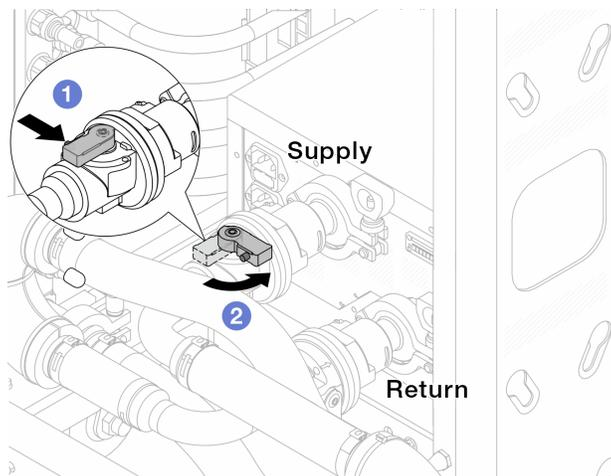
Figura 140. Chiusura delle valvole a sfera
