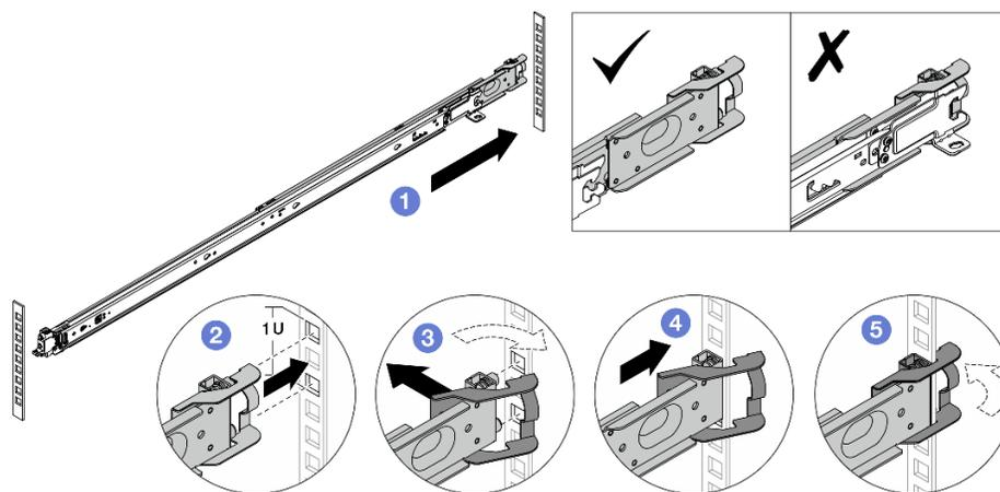
Figura 5. Installazione dei piedini di montaggio posteriori
