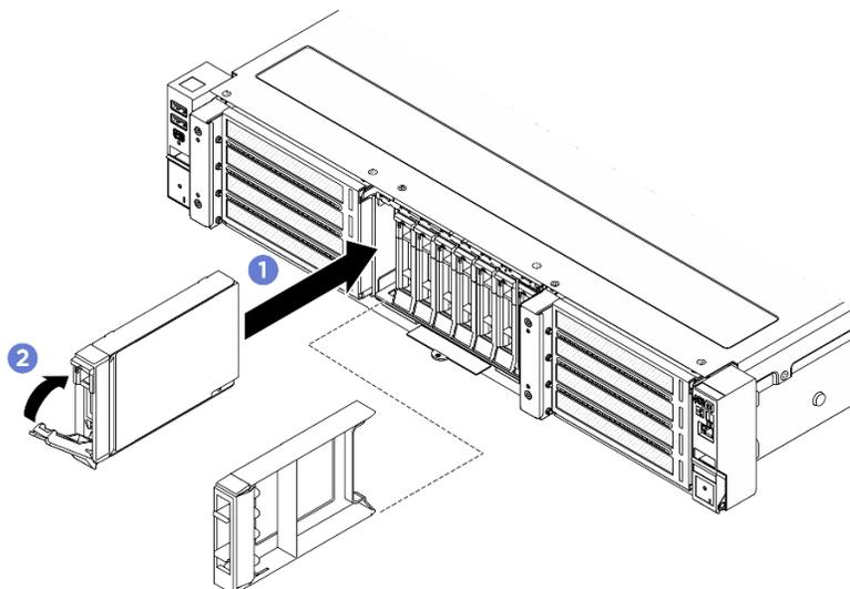
Figura 20. Installazione di un'unità hot-swap da 2,5"
