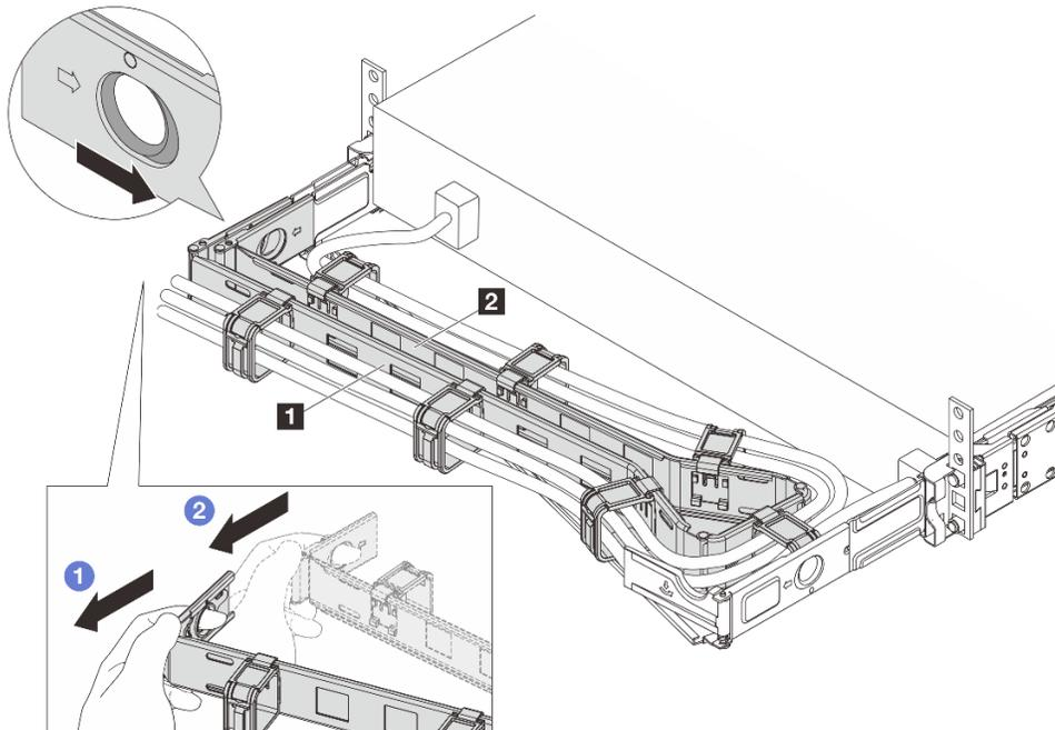
Figura 68. Rimozione del lato sinistro
