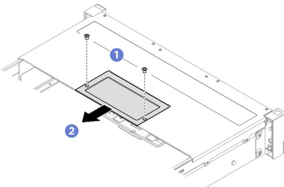
Figura 21. Rimozione della piastra di copertura
