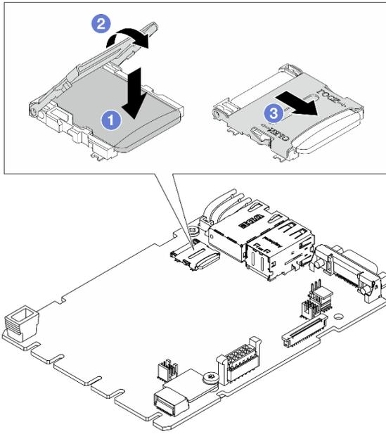
Figura 185. Installazione della scheda MicroSD
