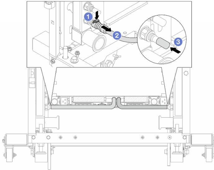
Figura 164. Rimozione della presa di collegamento
