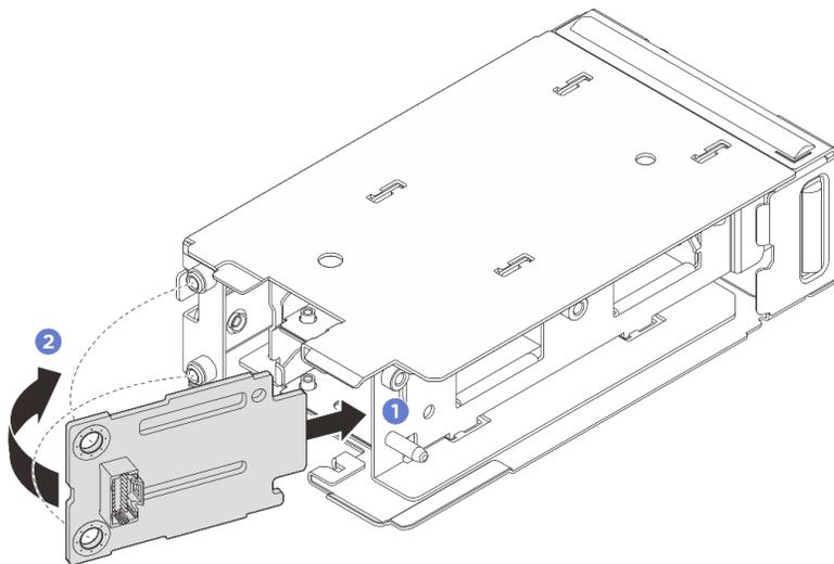
Figura 124. Installazione del backplane di avvio M.2
