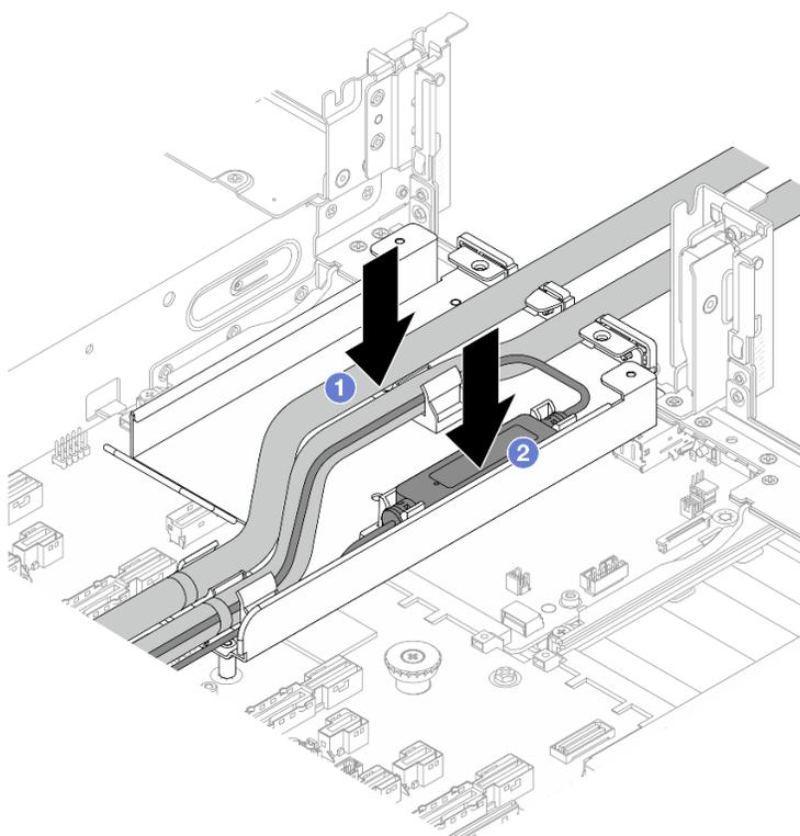
Figura 100. Posizionamento di tubi e modulo del sensore di rilevamento dei liquidi
