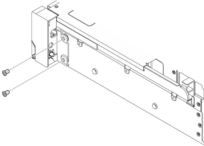
Figura 200. Rimozione delle viti
