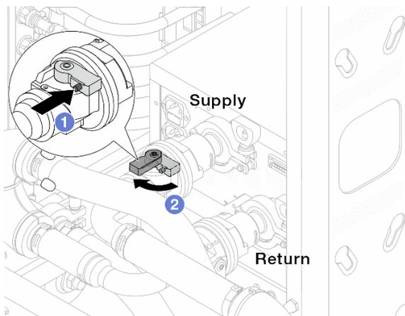
Figura 158. Apertura delle valvole a sfera
