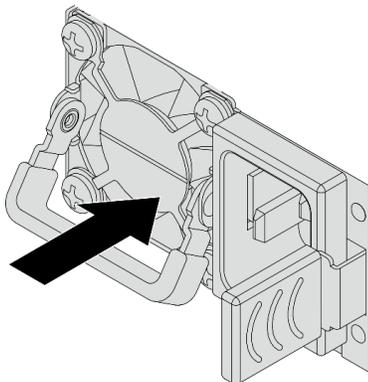
Figura 73. Installazione dell'unità di alimentazione hot-swap
