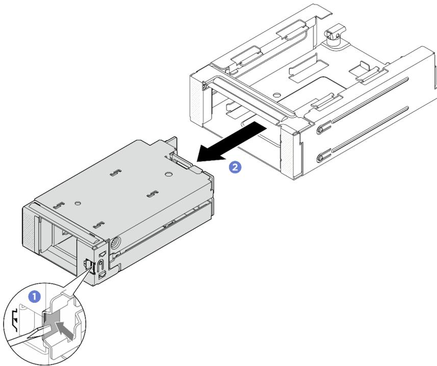
Figura 119. Rimozione del telaio unità M.2 anteriore dall'intelaiatura
