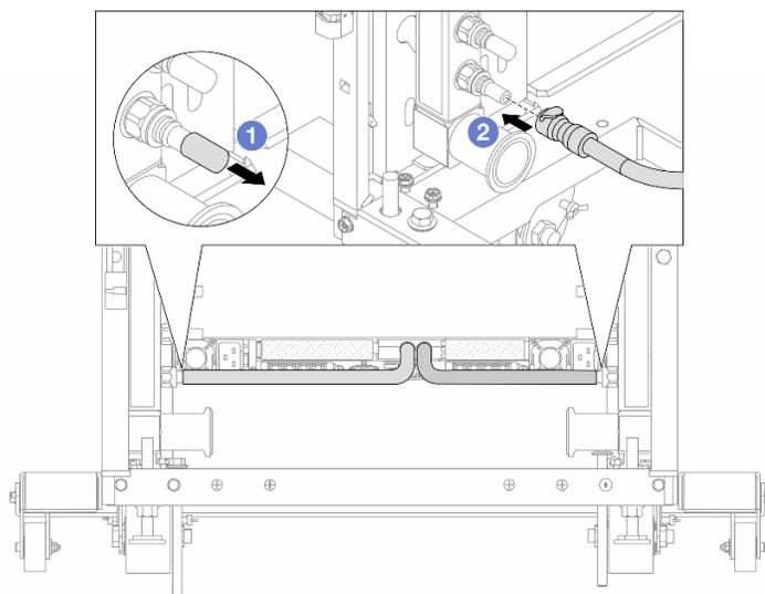
Figura 156. Installazione della presa di collegamento rapido
