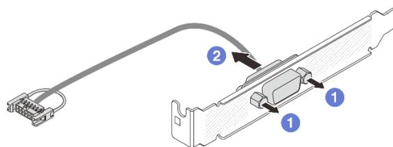
Figura 226. Smontaggio del modulo della porta seriale
