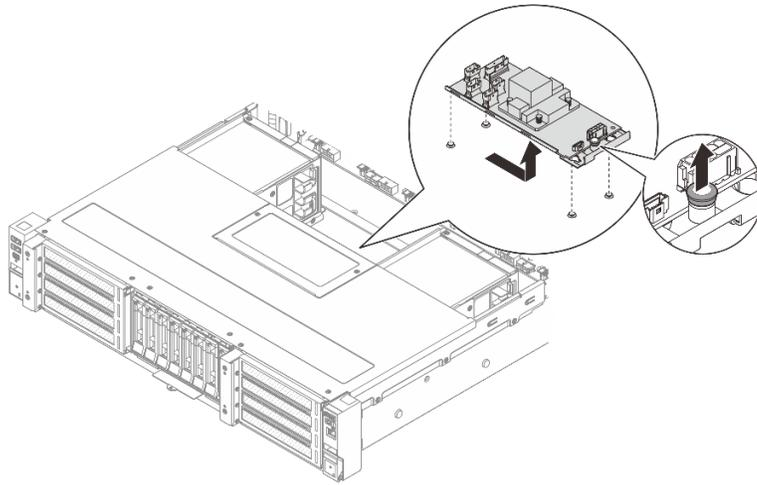
Figura 76. Rimozione dell'adattatore CFF interno
