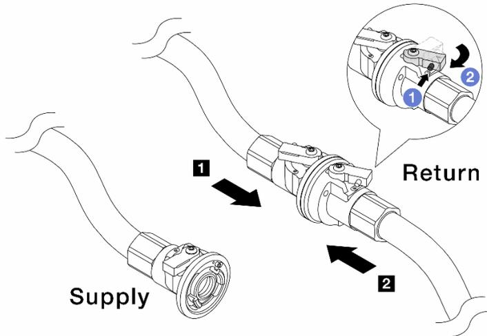
Figura 175. Alimentazione dell'impianto a ritorno del collettore
