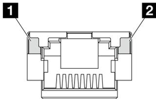
Figura 255. LED sulla Porta di gestione del sistema XCC (RJ-45 da 10/100/1000 Mbps)
