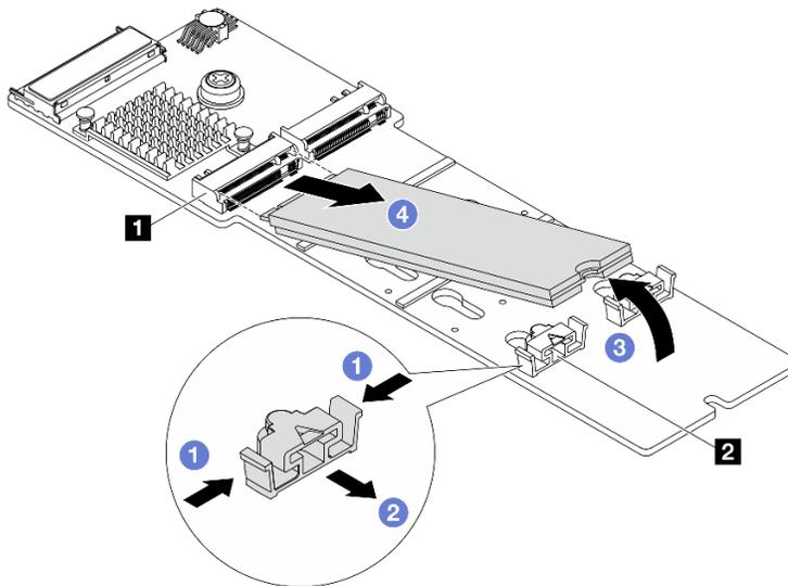
Figura 78. Rimozione dell'unità M.2
