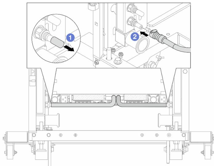
Figura 172. Installazione della presa di collegamento rapido
