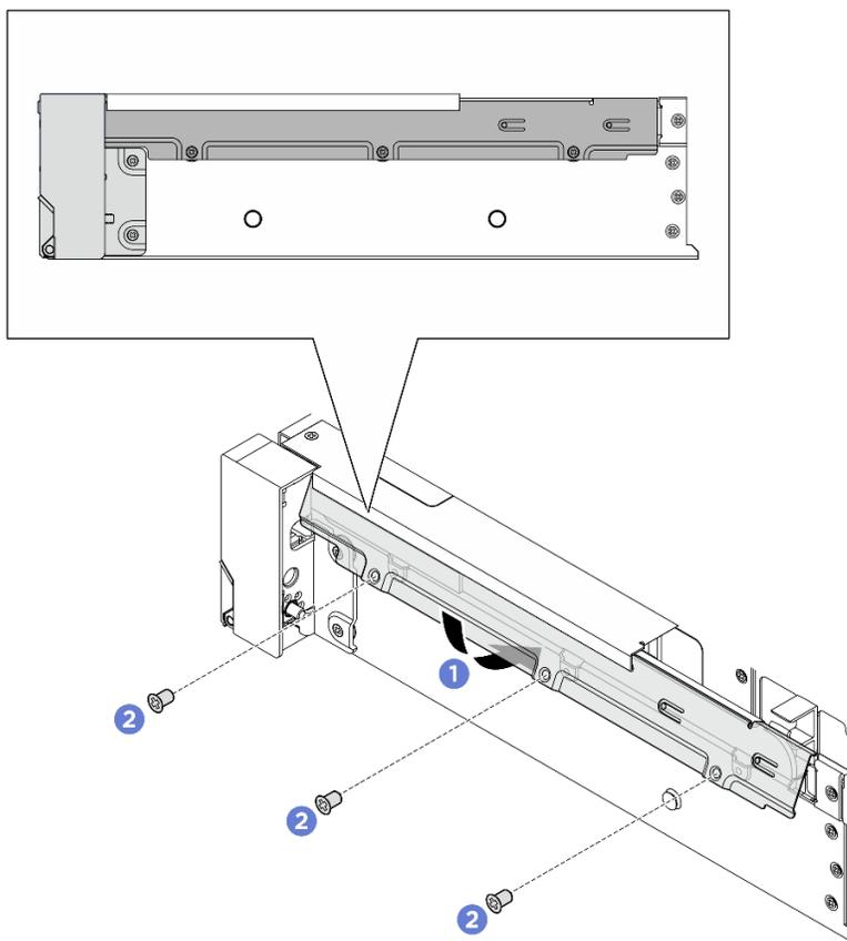
Figura 204. Installazione del fermacavo
