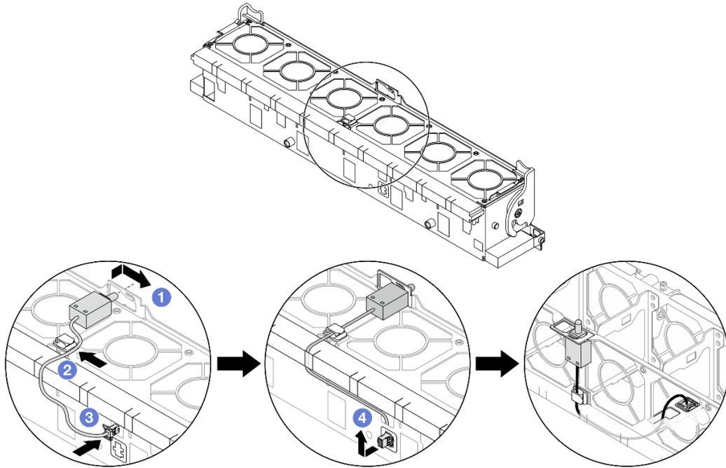
Figura 88. Installazione dello switch di intrusione
