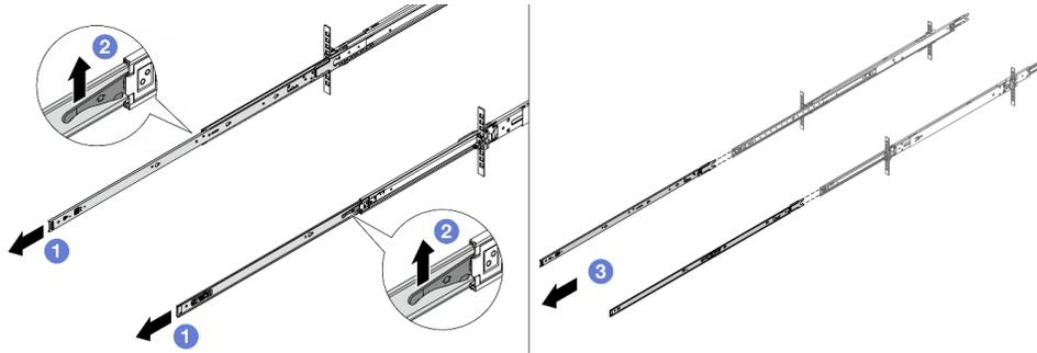
Figura 11. Estrazione delle guide
