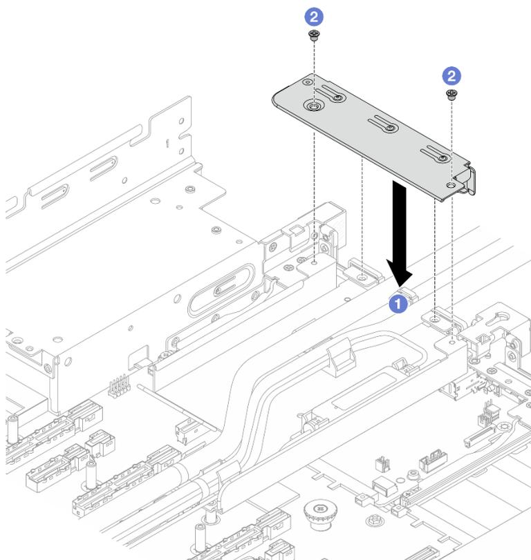
Figura 102. Installazione della staffa 1FH
