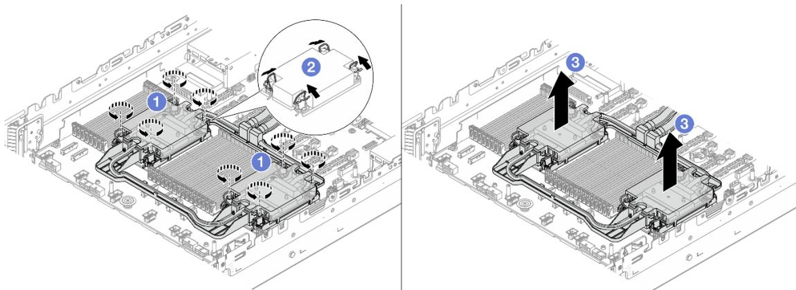
Figura 92. Rimozione del Processor Neptune Core Module
