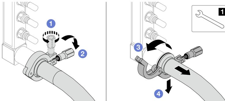
Figura 170. Separazione del collettore dal kit di tubi
