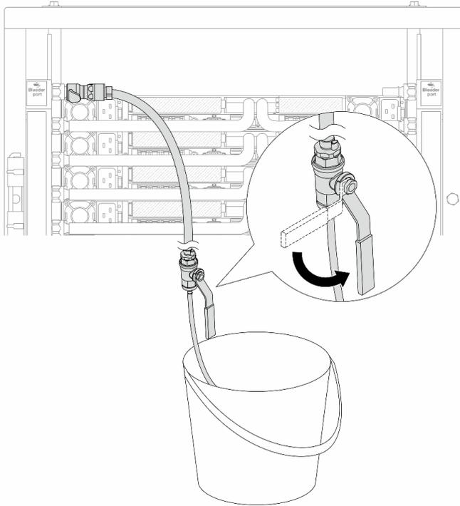
*Figura 176. Apertura della valvola di sfiato sul lato di alimentazione*
