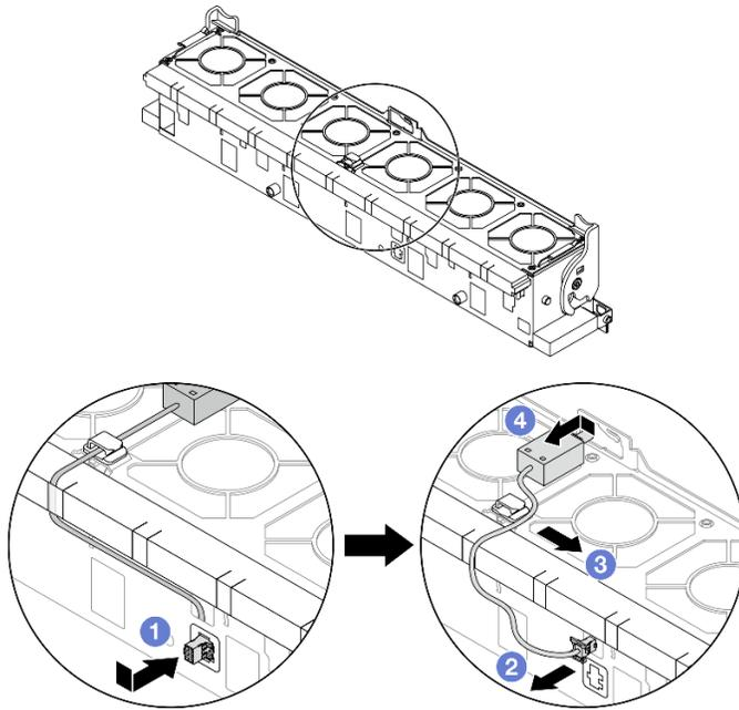
Figura 87. Rimozione dello switch di intrusione
