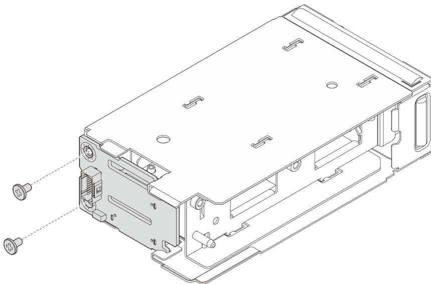
Figura 121. Rimozione del backplane di avvio M.2 anteriore
