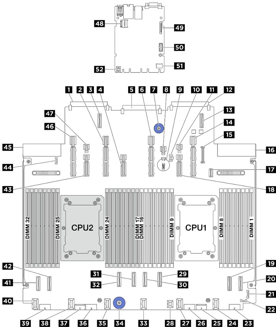
Figura 250. Connettori sull'assieme della scheda di sistema
