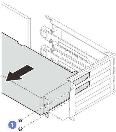
Figura 54. Rimozione dell'adattatore PCIe
