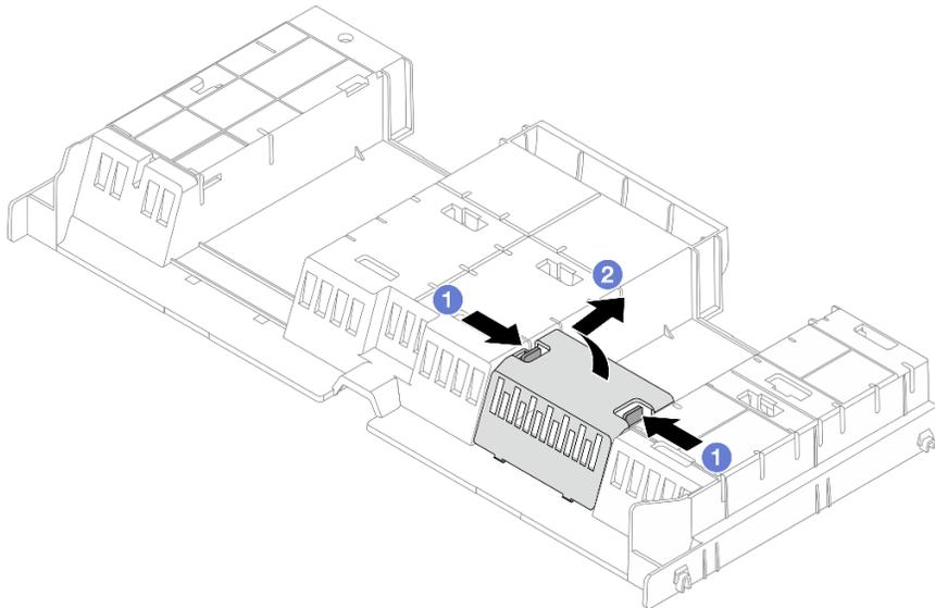
Figura 28. Rimozione dell'elemento di riempimento del deflettore d'aria
