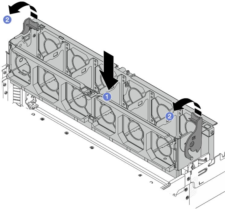
Figura 242. Installazione dell'alloggiamento delle ventole del sistema
