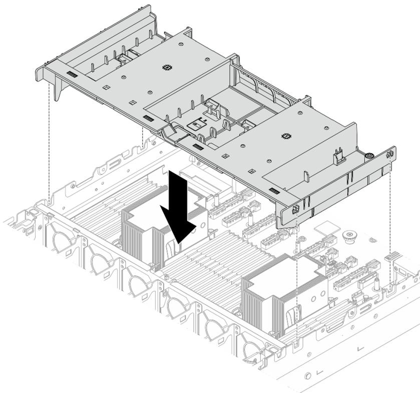
Figura 31. Installazione del deflettore d'aria
