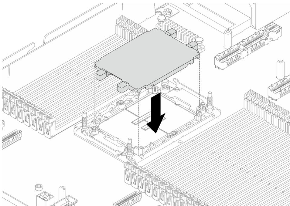
Figura 96. Installazione del coperchio del socket del processore
