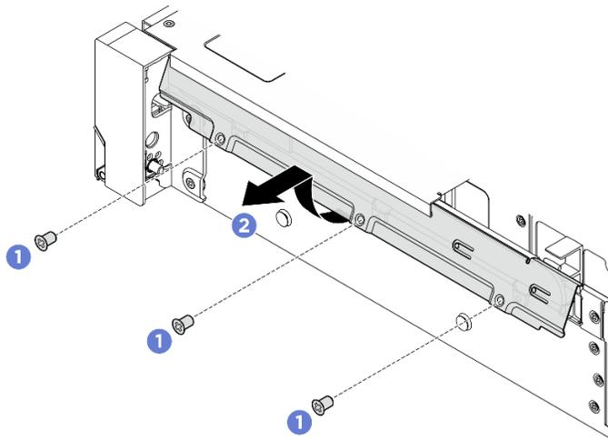
Figura 199. Rimozione del fermacavo
