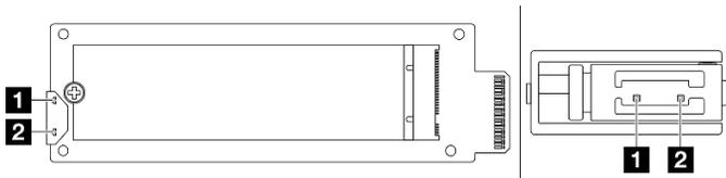
Figura 256. LED dell'interposer M.2
