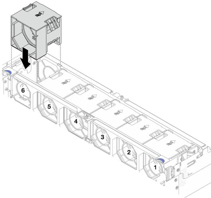
Figura 240. Installazione della ventola del sistema
