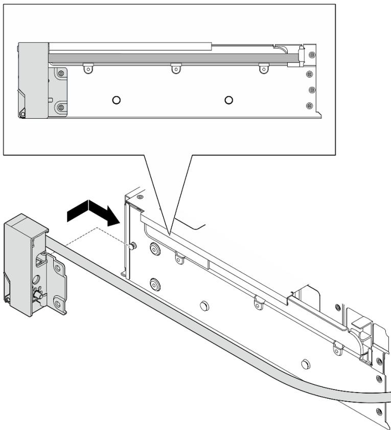
*Figura 202. Installazione del fermo del rack*
