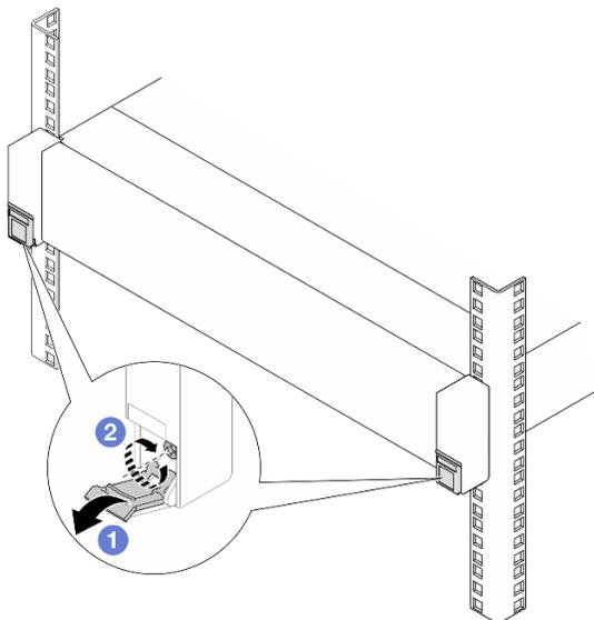
Figura 16. Fissaggio del server alla parte anteriore del rack
