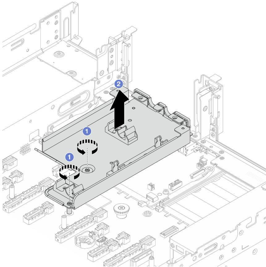
Figura 93. Rimozione del supporto del tubo
