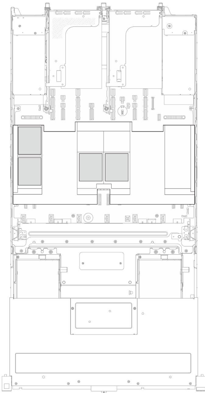
Figura 205. Posizione dei moduli di alimentazione flash RAID sul deflettore d'aria
