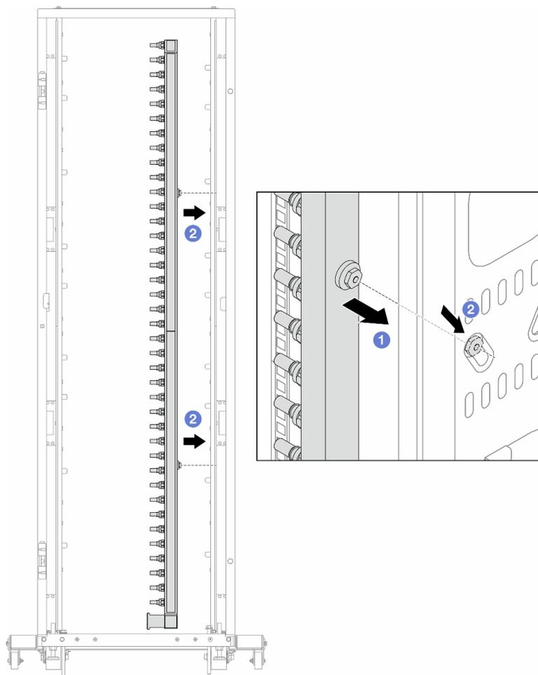
Figura 149. Installazione del collettore
