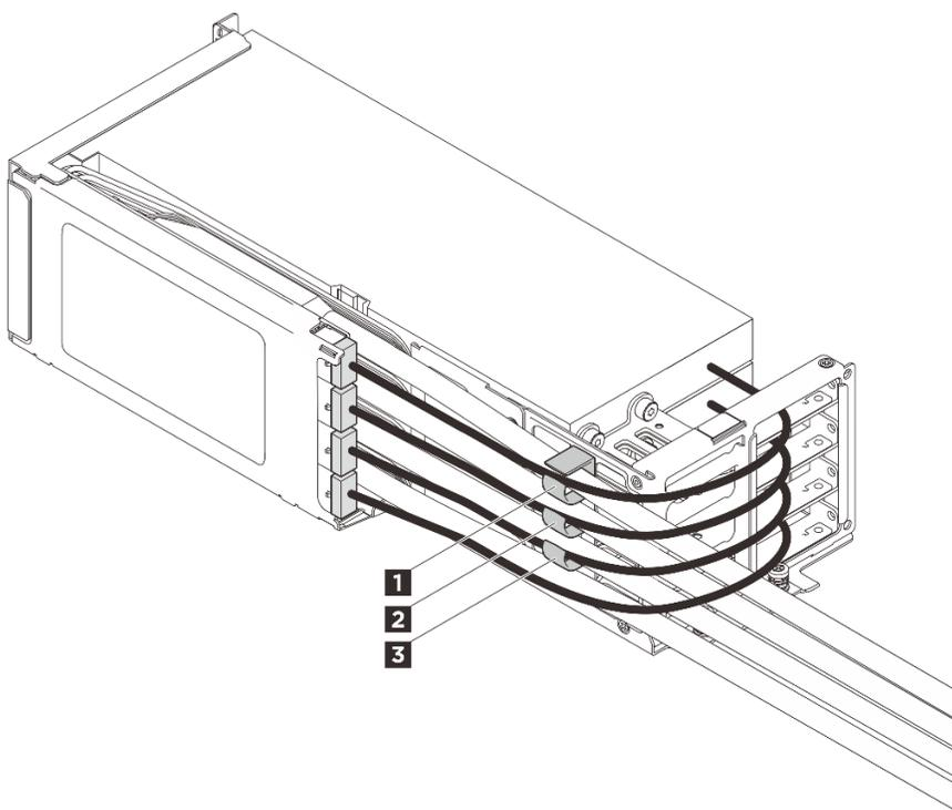
Figura 64. Fermacavi dell'assieme verticale anteriore
