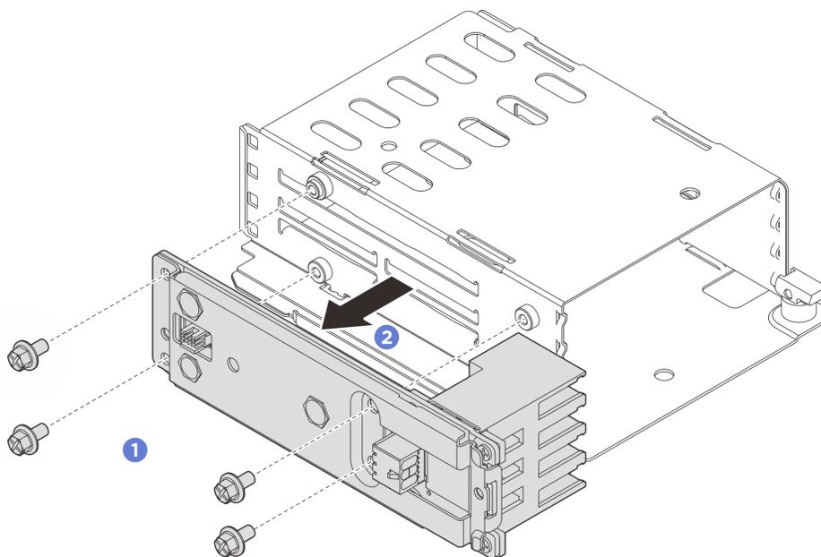
Figura 47. Rimozione dell'assieme backplane
