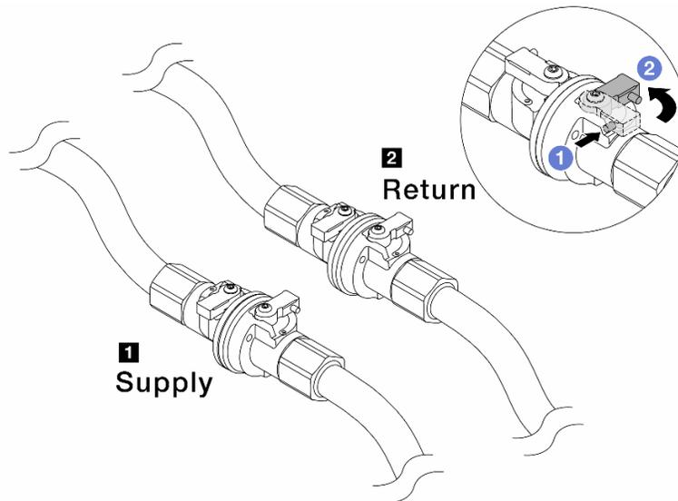
Figura 163. Chiusura delle valvole a sfera
