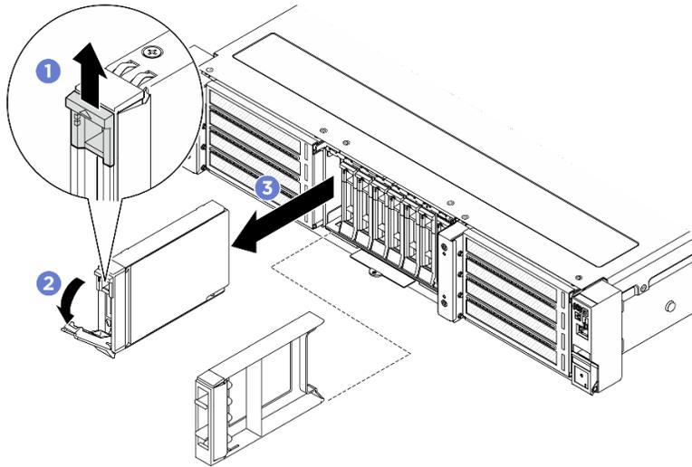
Figura 18. Rimozione di un'unità hot-swap da 2,5"
