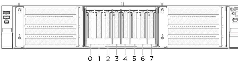
Figura 19. Numerazione del vano dell'unità da 2,5"
