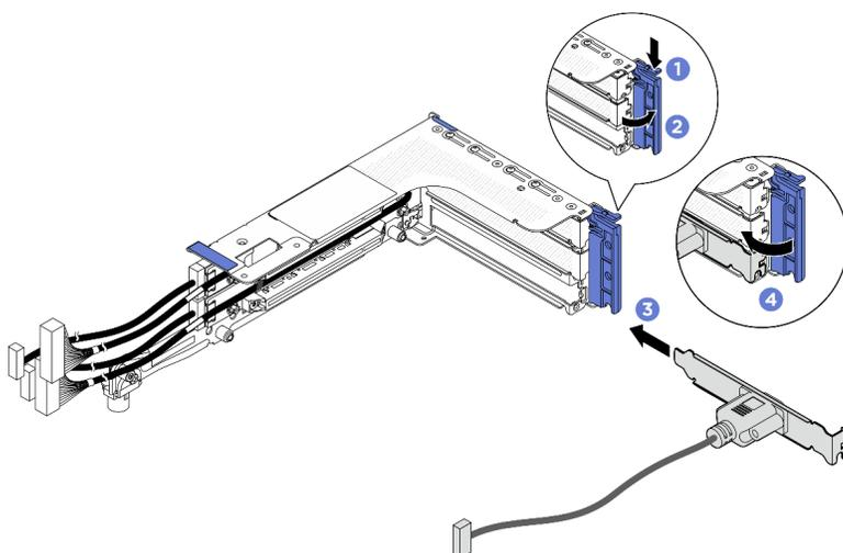
Figura 228. Installazione del modulo della porta seriale
