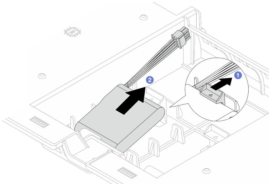
Figura 206. Rimozione del modulo di alimentazione flash RAID dal deflettore d'aria
