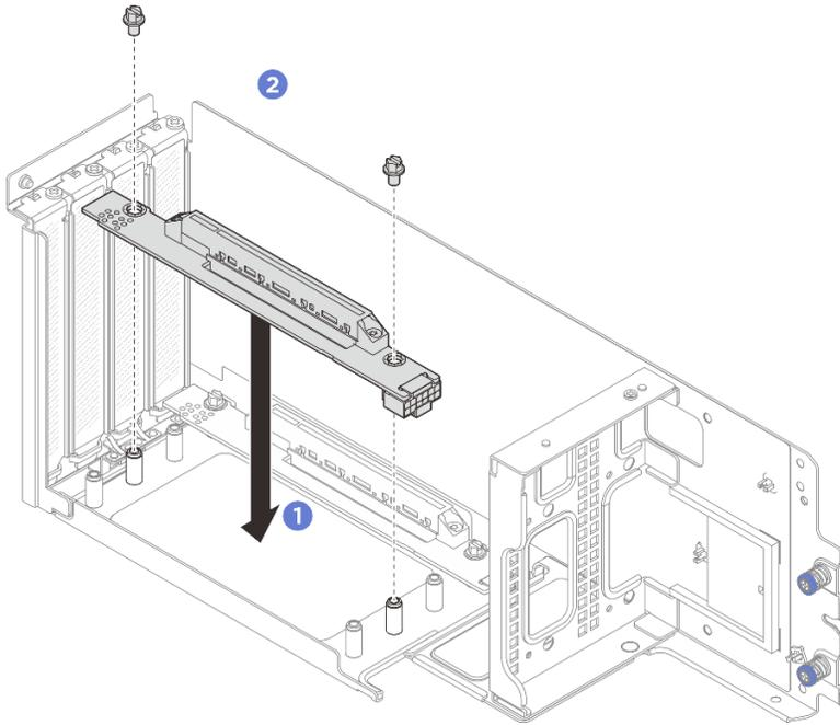
**그림 77. 라이저 카드 설치**
