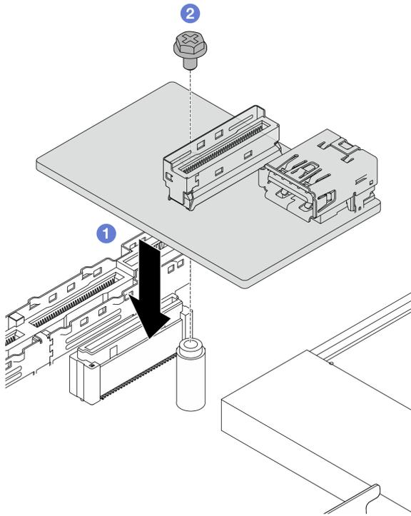
그림 261. USB I/O 보드 설치
