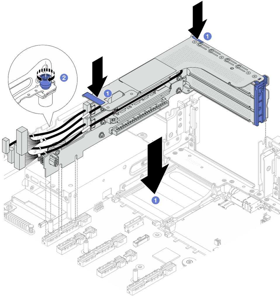
**그림 231. 3FH 라이저 어셈블리 설치**
