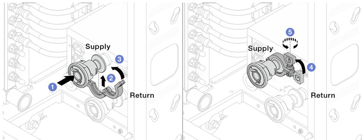
**그림 165. 볼 밸브 설치**
