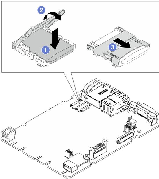
그림 199. MicroSD 카드 설치
