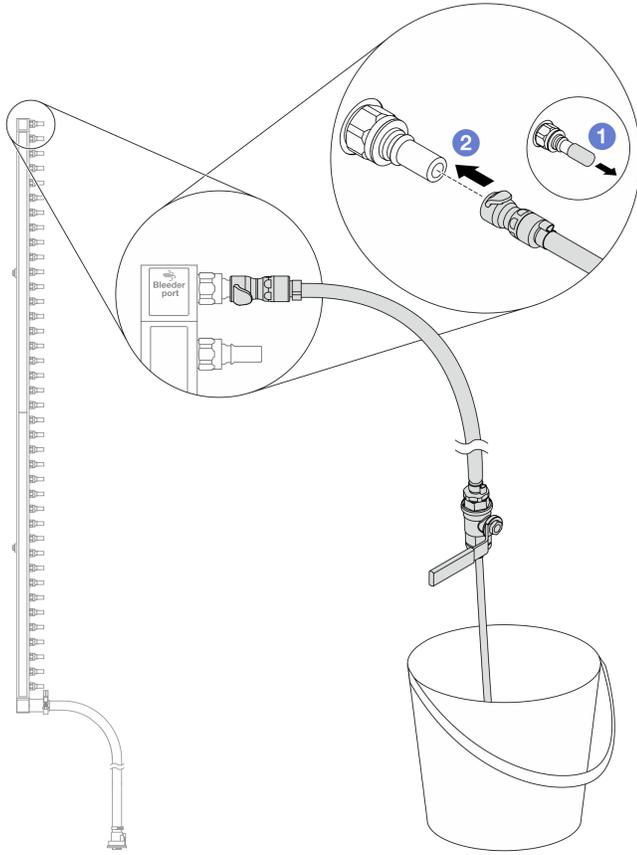
**그림 180. 공급 측에 블리드 키트 설치**
