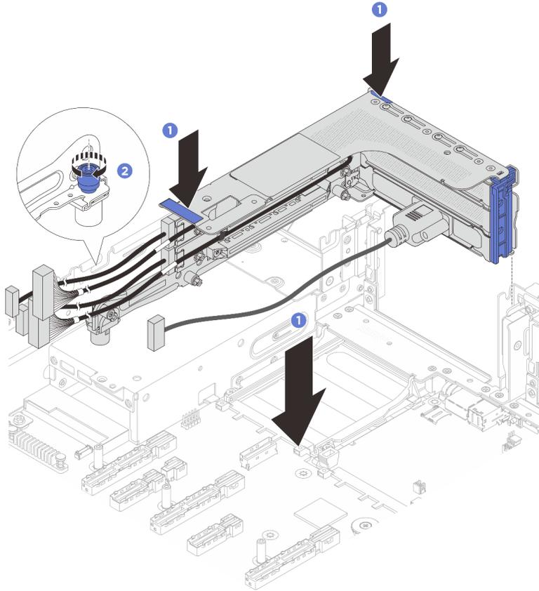
**그림 243. 라이저 어셈블리 설치**
