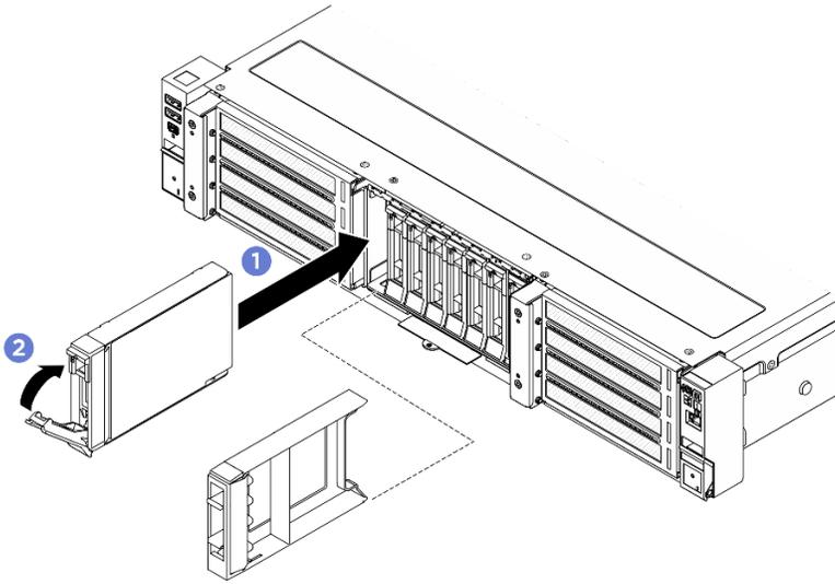
그림 34. 2.5" 핫 스왑 드라이브 설치
