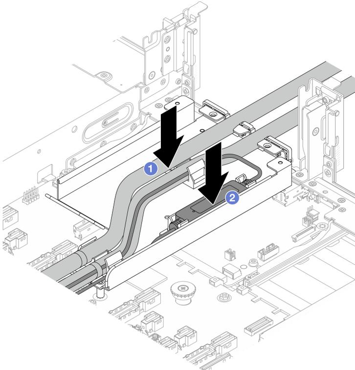
**그림 114. 호스 배치 및 액체 감지 센서 모듈**
