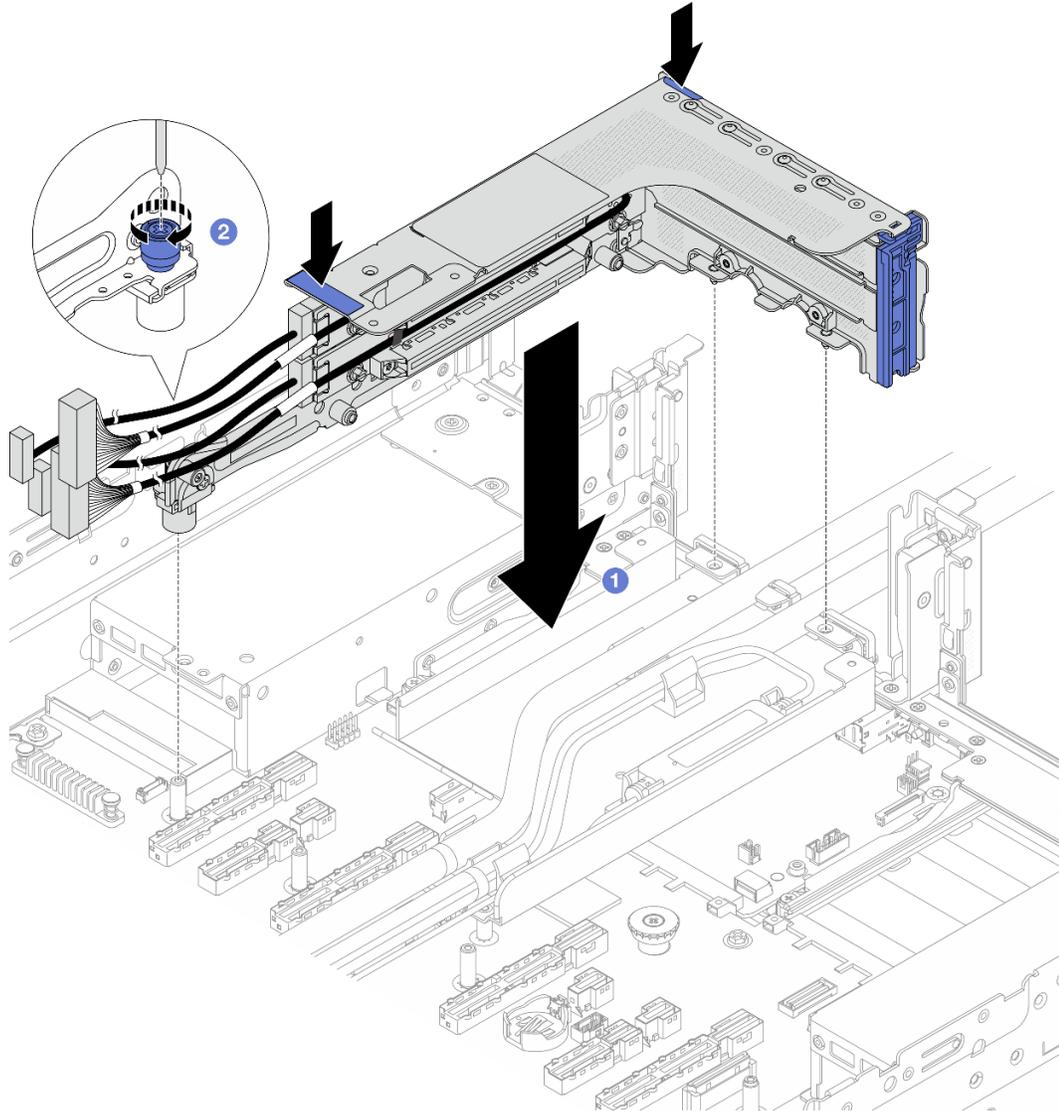
**그림 117. 3FH 라이저 케이스 설치**
