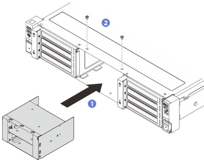
**그림 63. E3.S 케이스 설치**
