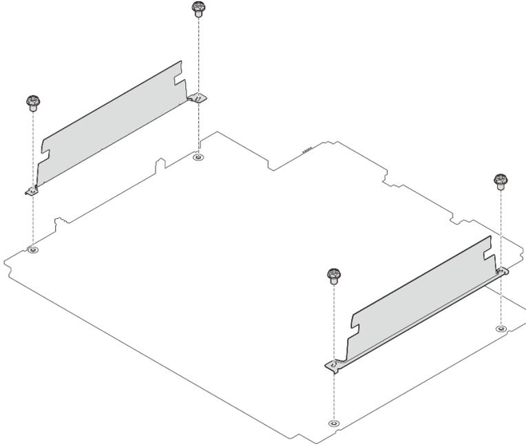
**그림 48. 케이블 벽 설치**
