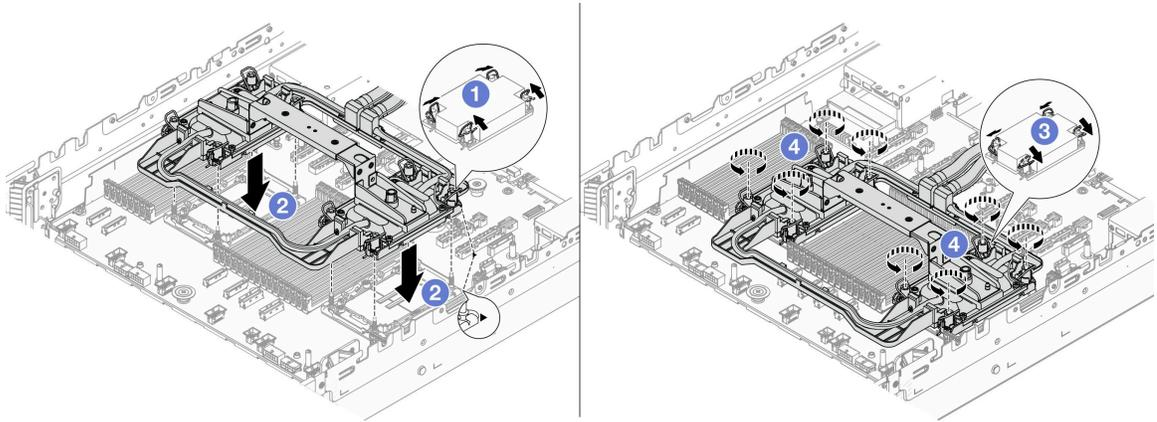
**그림 111. Processor Neptune Core Module 설치**
