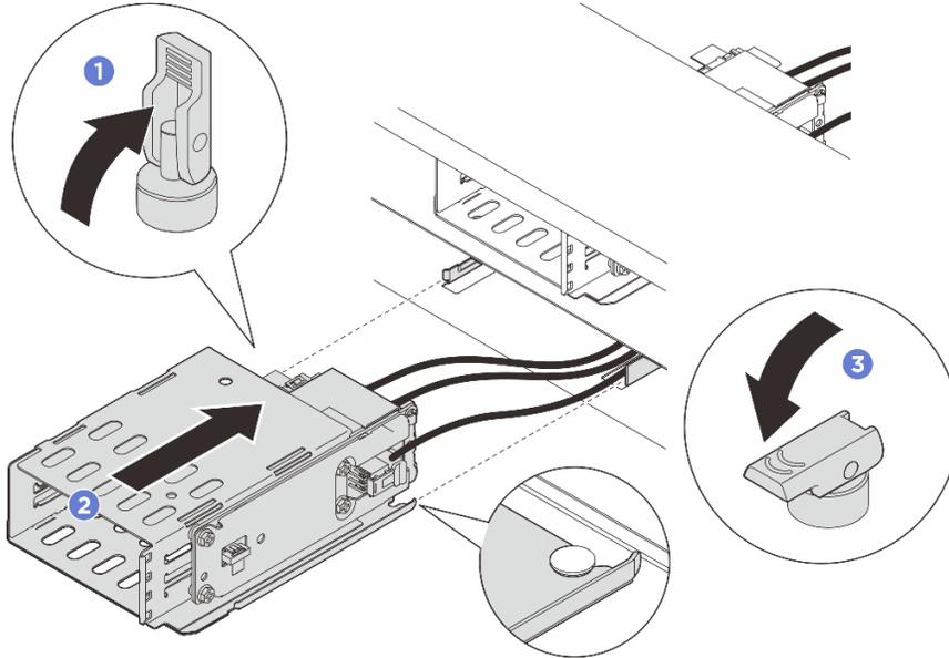
그림 65. E3.S 1T 케이스 설치
