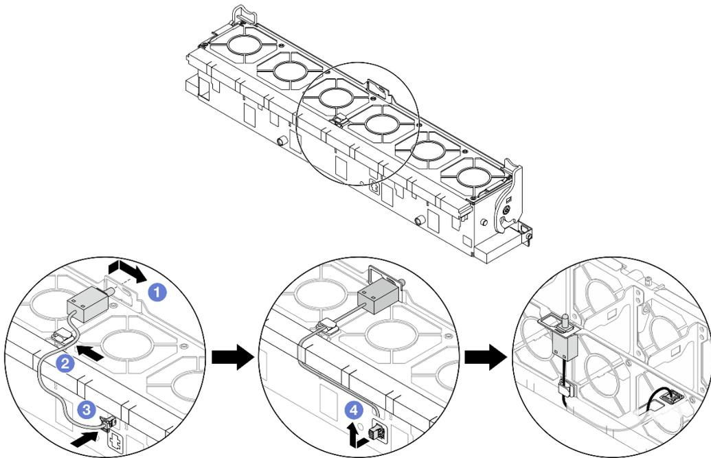
**그림 102. 침입 스위치 설치**
