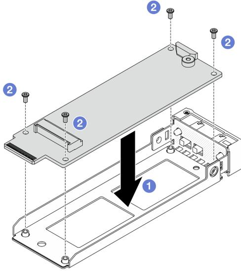
**그림 129. M.2 인터포저 설치**
