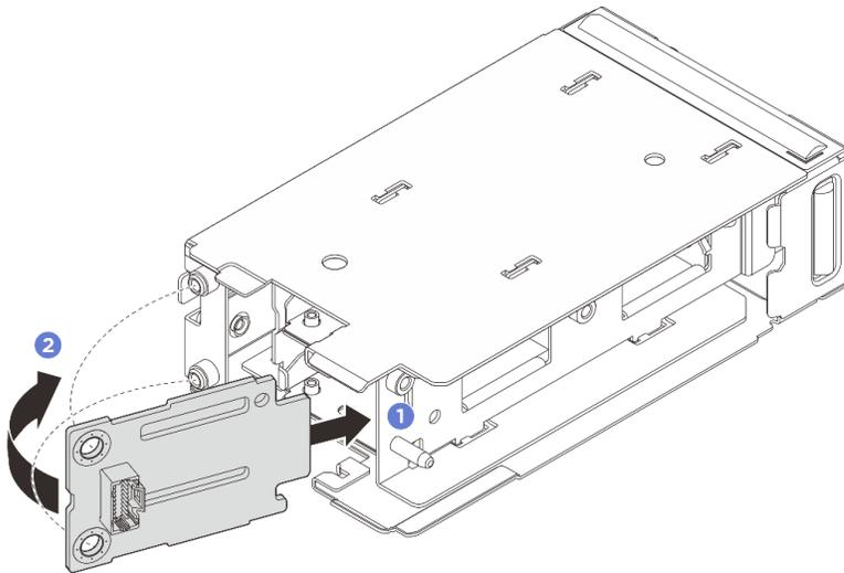
그림 138. M.2 부트 백플레인 설치
