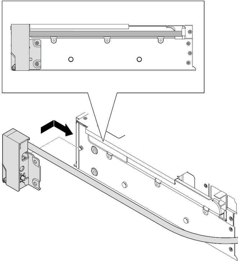
**그림 216. 랙 래치 설치**
