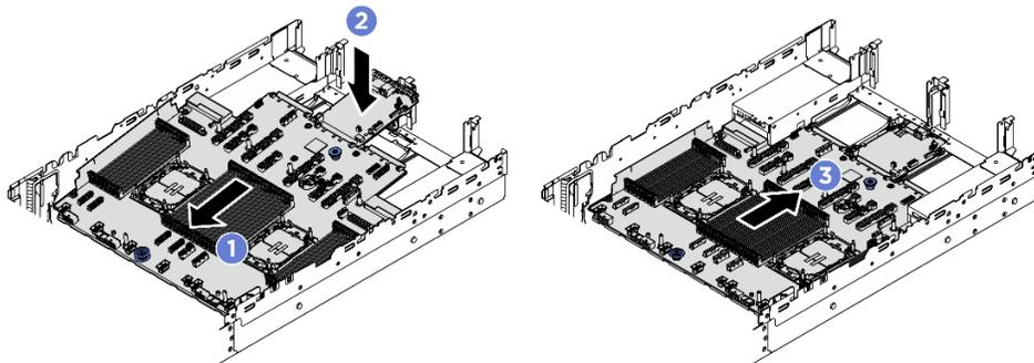
그림 248. 시스템 보드 어셈블리 설치
