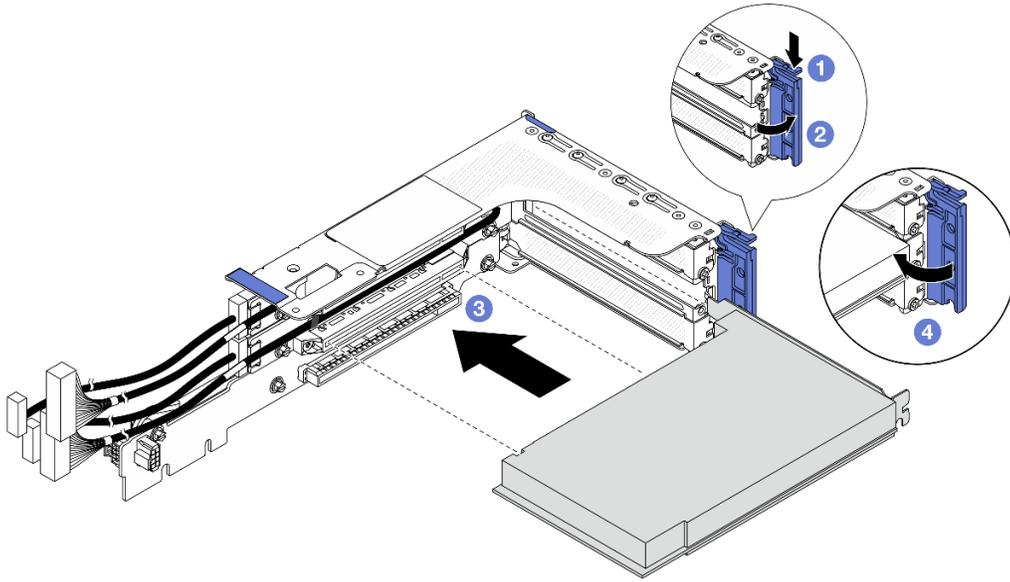
그림 230. 3FH 라이저 케이스에 PCIe 어댑터 설치
