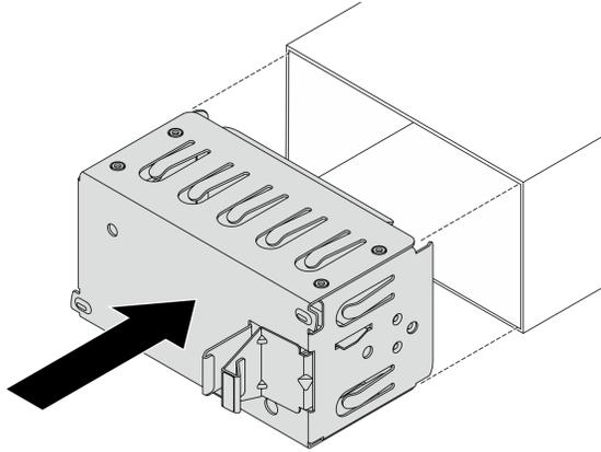
그림 84. 전원 공급 장치 필터 설치
