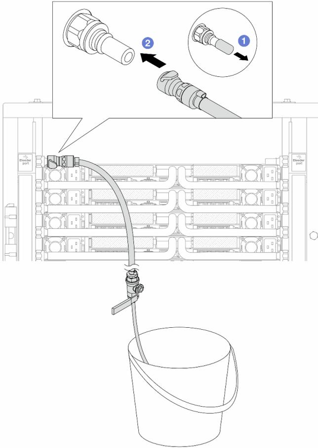
**그림 188. 공급 측에 블리드 키트 설치**
