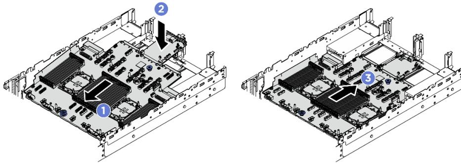
그림 252. 시스템 보드 어셈블리 설치
