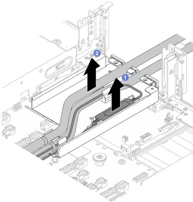
**그림 105. 호스 분리 및 액체 감지 센서 모듈**
