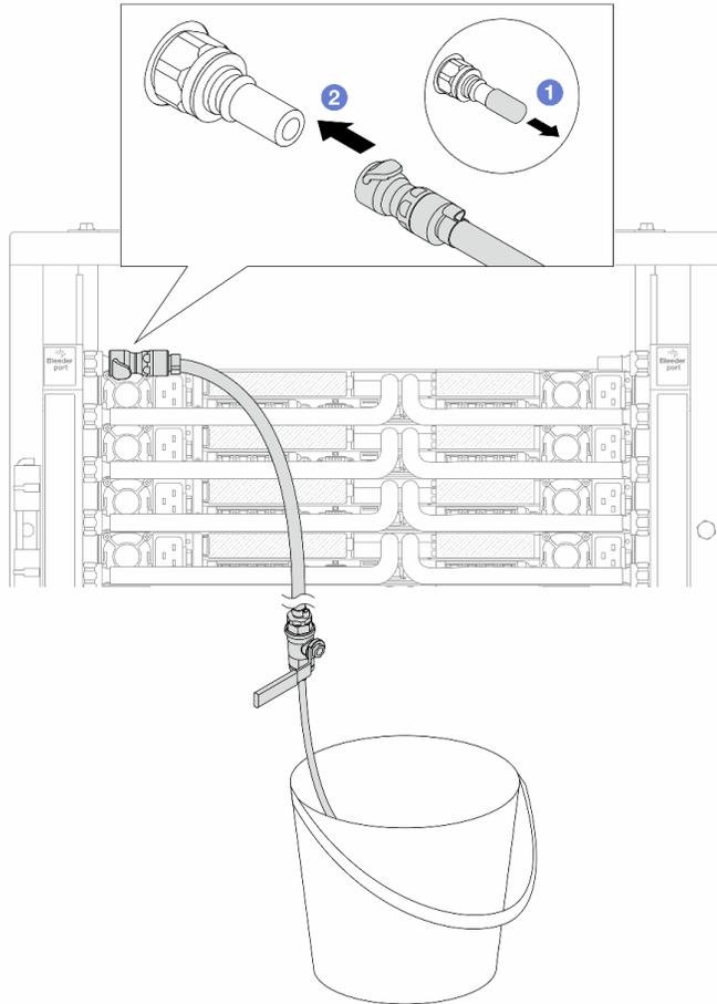
그림 171. 공급 측에 블리드 키트 설치
