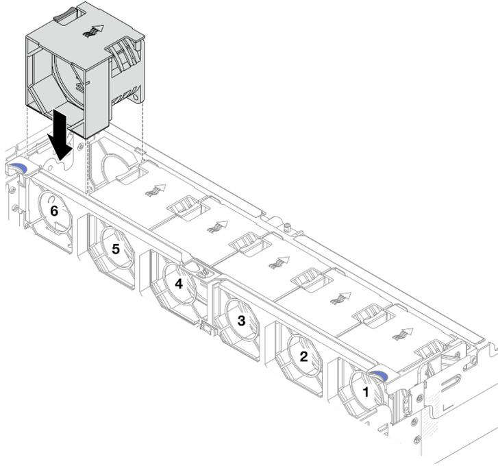
그림 254. 시스템 팬 설치
