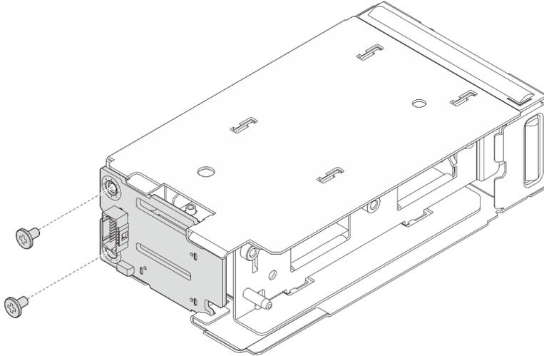
**그림 139. M.2 부트 백플레인 설치**
