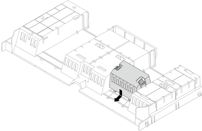
**그림 43. 공기 조절 장치 필러 설치**
