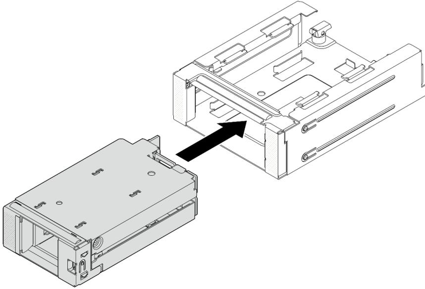
**그림 141. 케이스 프레임에 앞면 M.2 드라이브 케이스 설치**
