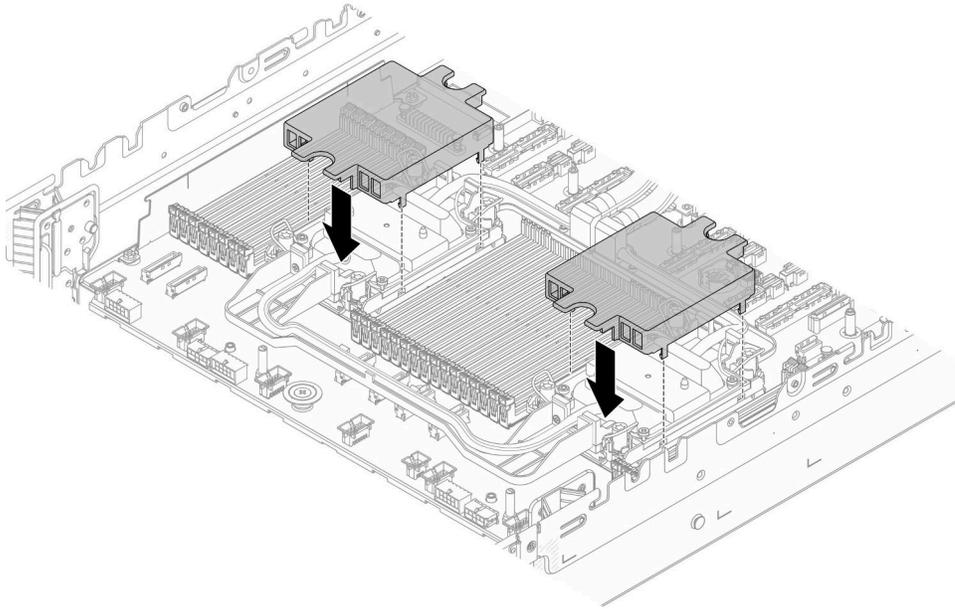
**그림 113. 냉각팬 덮개 설치**
