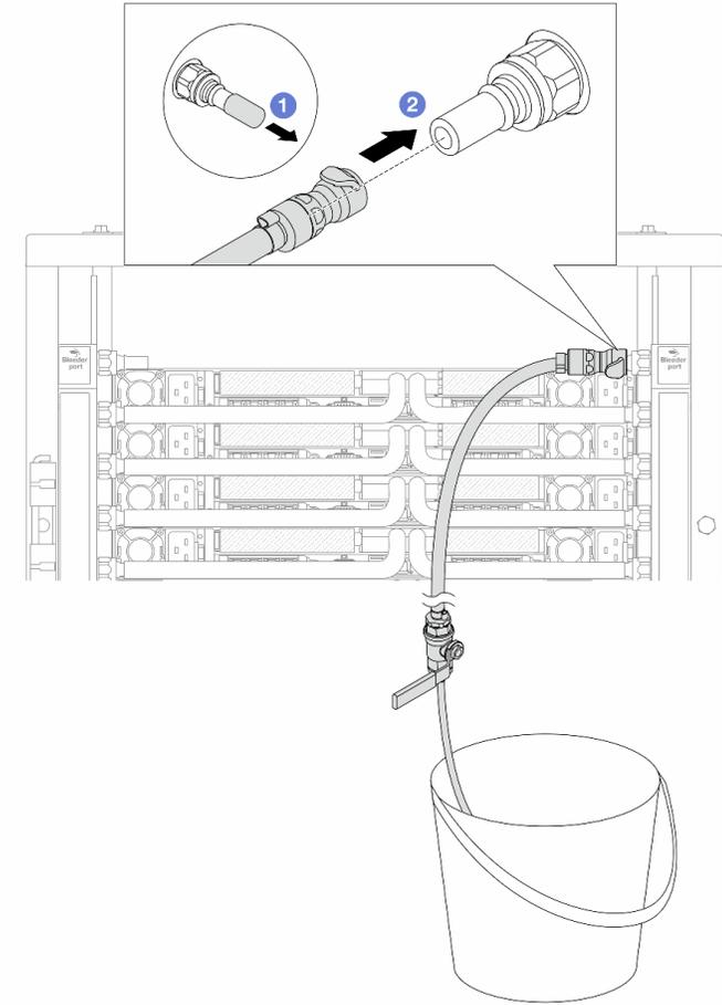
**그림 191. 리턴 측에 블리드 키트 설치**
