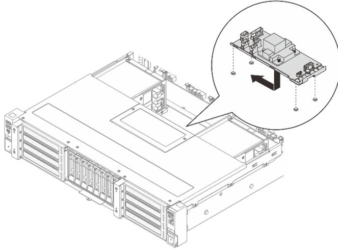
**그림 91. 내부 CFF 어댑터 설치**
