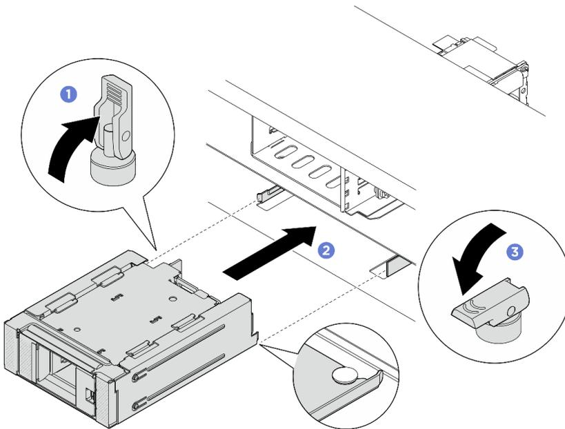
**그림 142. 프레임이 있는 전면 M.2 드라이브 케이스 설치**
