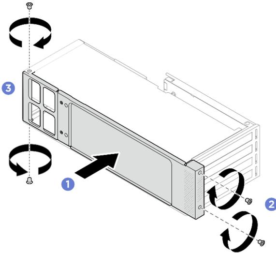
그림 73. 측면 지지 브래킷 설치
