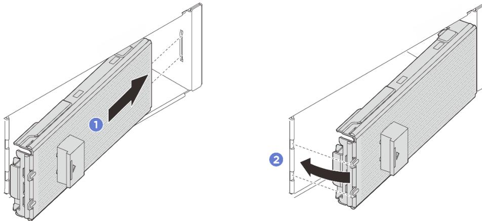
그림 58. E3.S 베젤 설치
