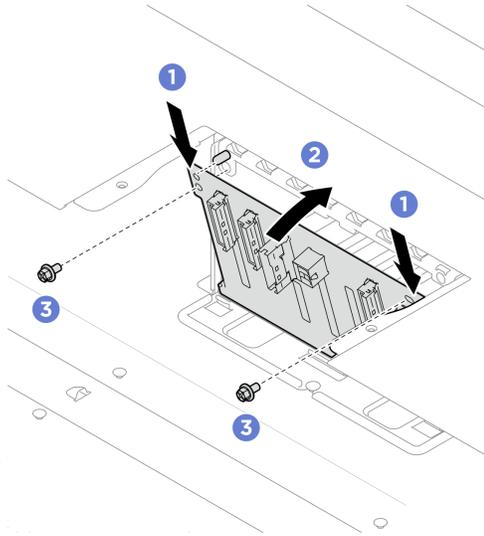
**그림 39. 2.5인치 드라이브 백플레인 설치**
