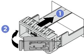
그림 120. M.2 드라이브 트레이 설치
