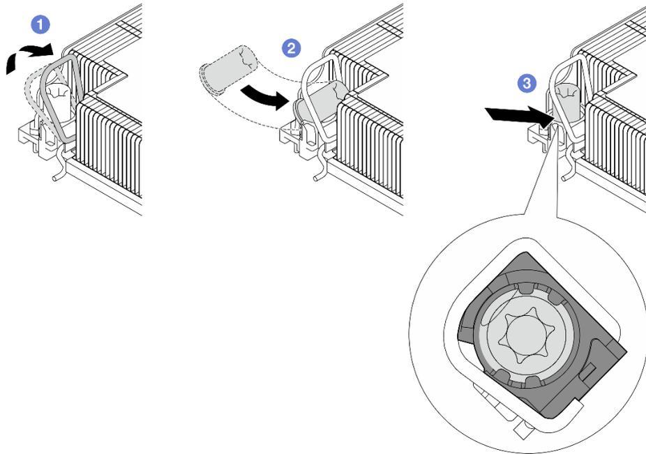
그림 80. 방열판에 Torx T30 너트 설치
