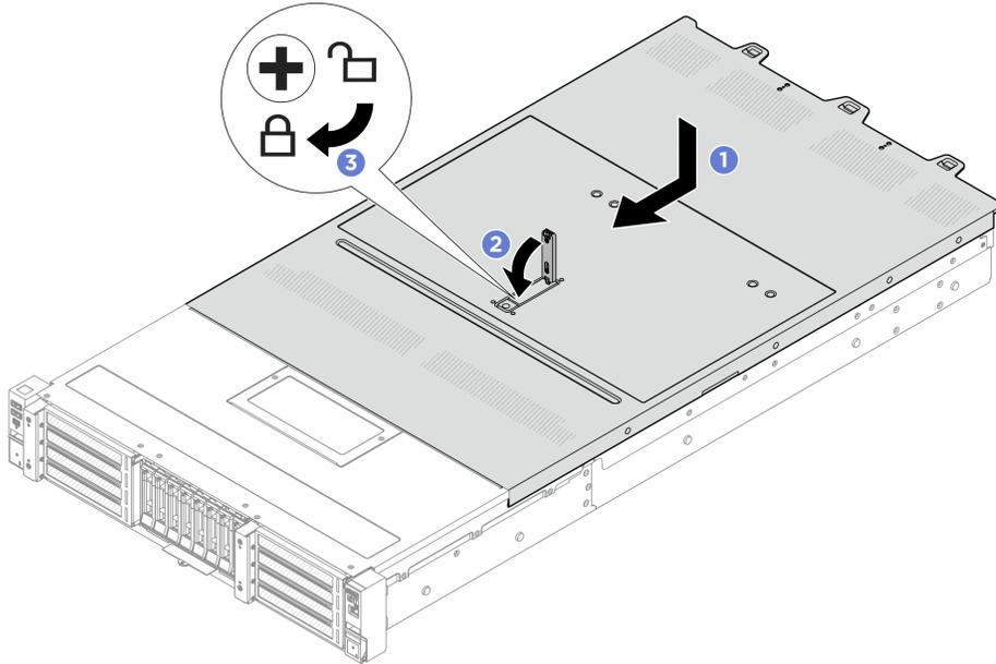
그림 259. 윗면 덮개 설치
