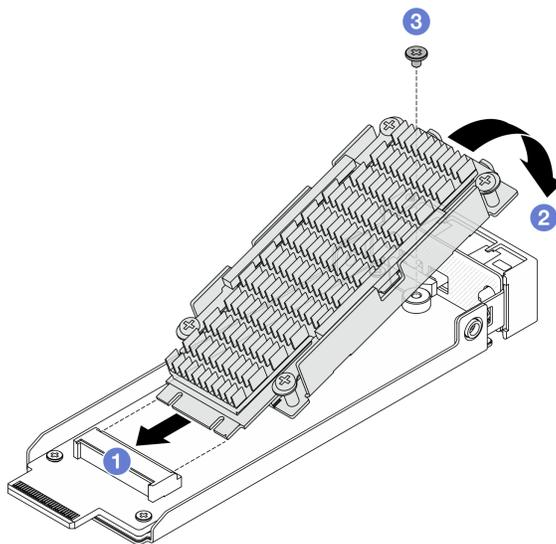
**그림 130. 방열판이 있는 M.2 드라이브 설치**
