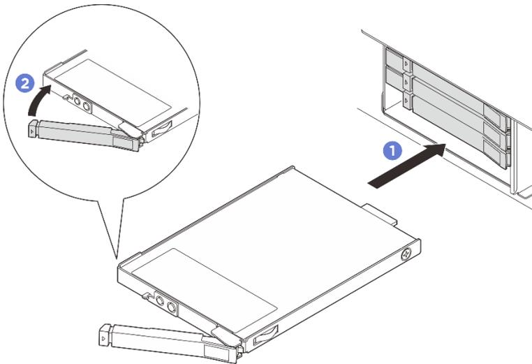
**그림 55. E3.S 핫 스왑 드라이브 설치**
