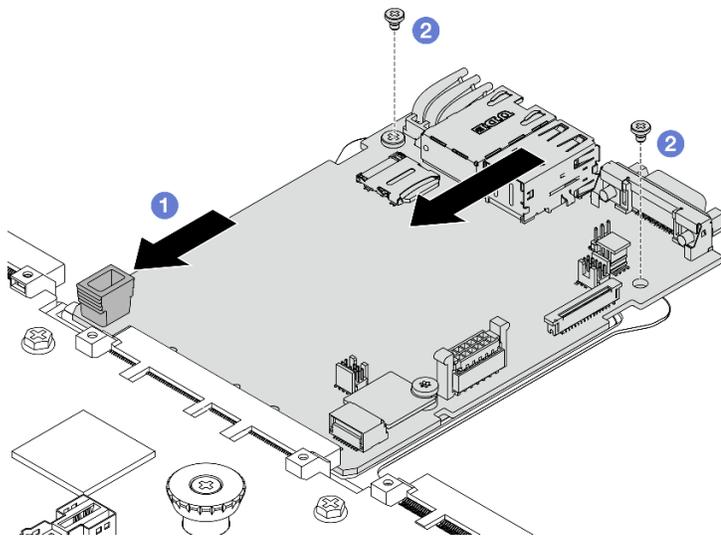
그림 251. 프로세서 보드에 시스템 I/O 보드 설치
