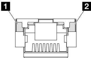
그림 268. XCC 시스템 관리 포트(10/100/1000Mbps RJ-45)의 LED
