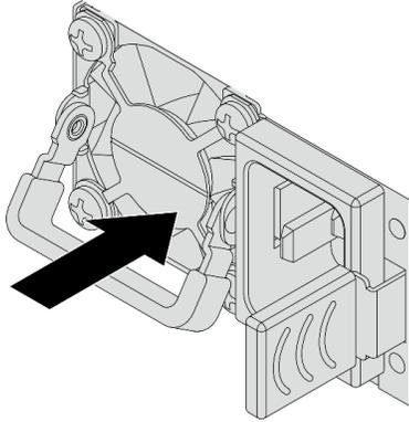
**그림 87. 핫 스왑 전원 공급 장치 설치**
