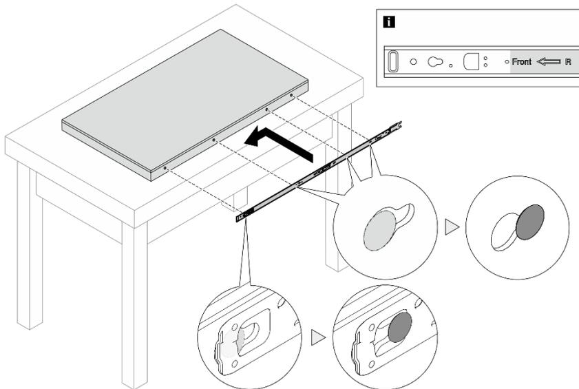
그림 26. 내부 레일 설치
