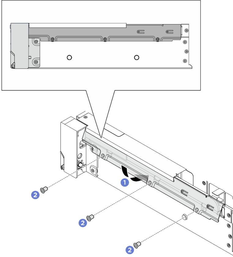
그림 218. 케이블 고정장치 설치
