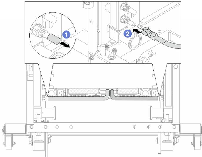
**그림 170. 퀵 커넥트 플러그 설치**
