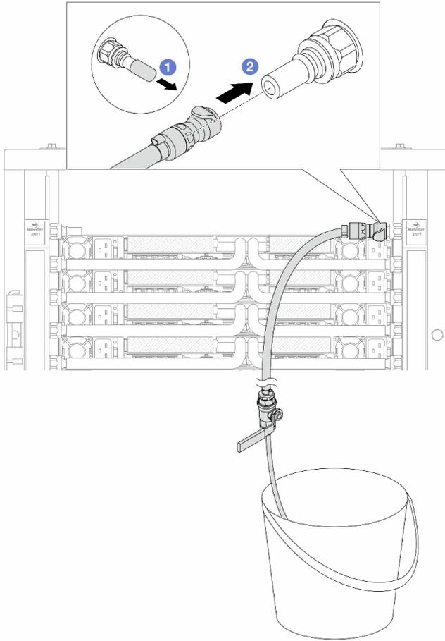
**그림 174. 리턴 측에 블리드 키트 설치**
