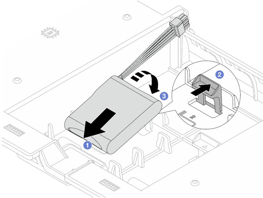
**그림 221. 공기 조절 장치에 RAID 플래시 전원 모듈 설치**
