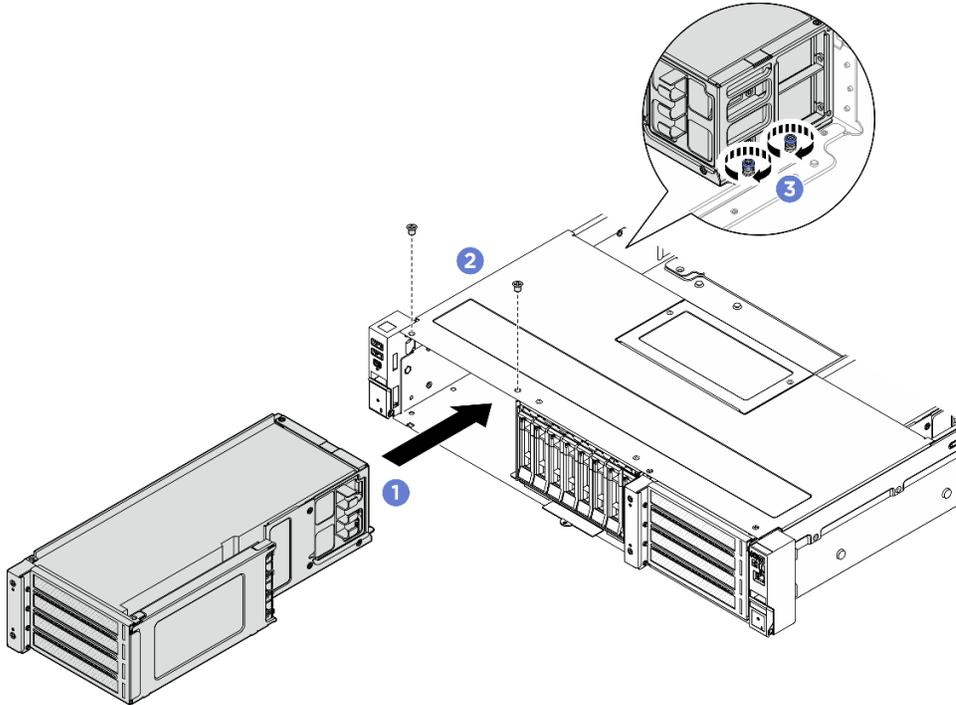
그림 74. 앞면 라이저 어셈블리 설치
