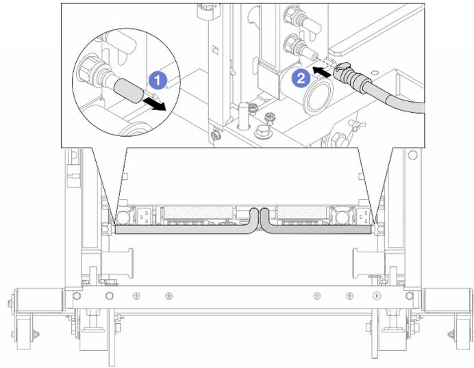
**그림 186. 퀵 커넥트 플러그 설치**
