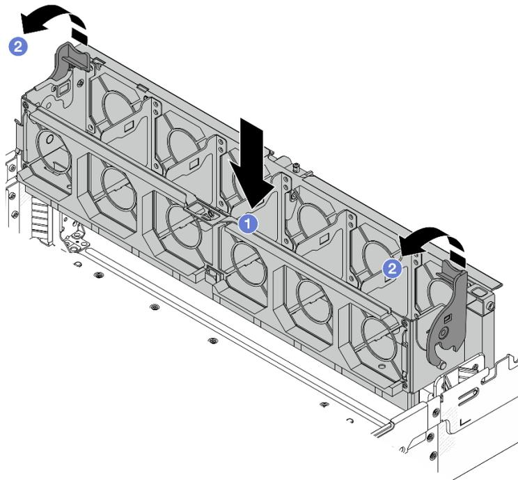
그림 256. 시스템 팬 케이스 설치
