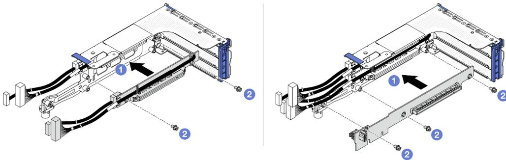
**그림 229. 3FH 라이저 케이스에 라이저 카드 설치**
