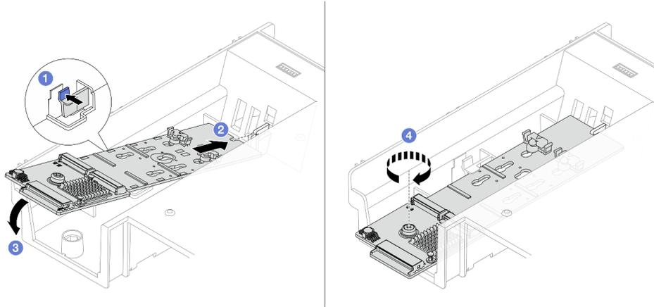
**그림 98. 공기 조절 장치에 M.2 백플레인 설치**
