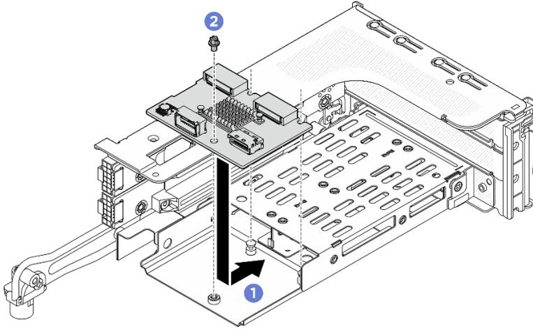
**그림 145. 3FH M.2 라이저 케이스에 M.2 백플레인 설치**
