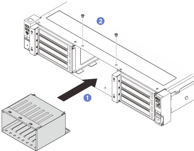
그림 38. 2.5인치 드라이브 케이지 설치
