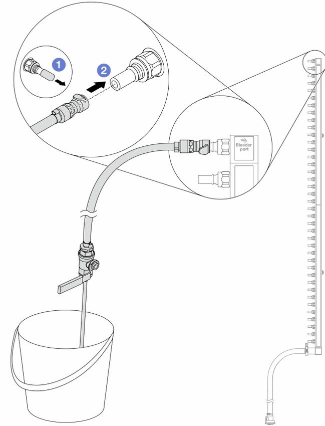
**그림 182. 리턴 측에 블리드 키트 설치**
