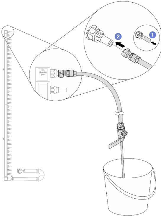
**그림 158. 공급 측에 블리드 키트 설치**
