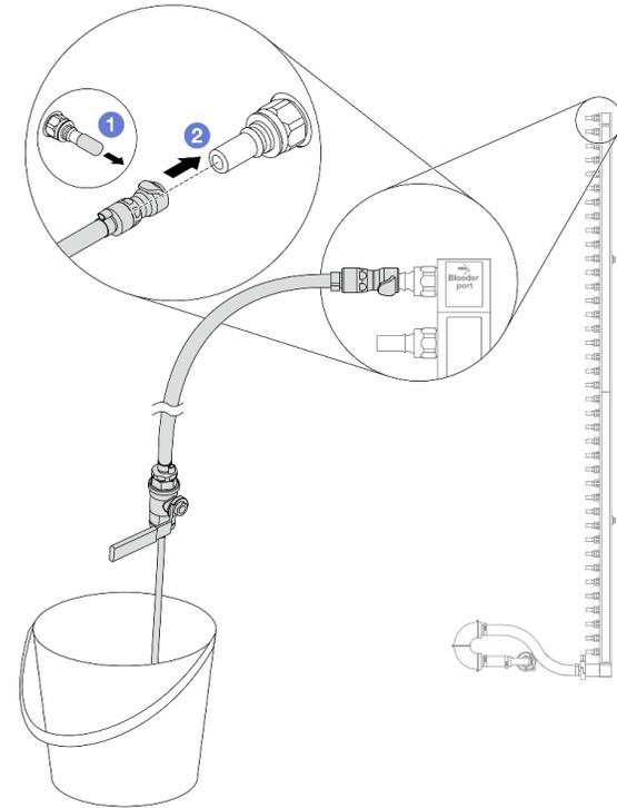
**그림 160. 리턴 측에 블리드 키트 설치**
