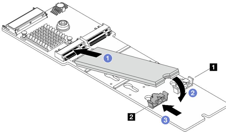
**그림 95. M.2 드라이브 설치**
