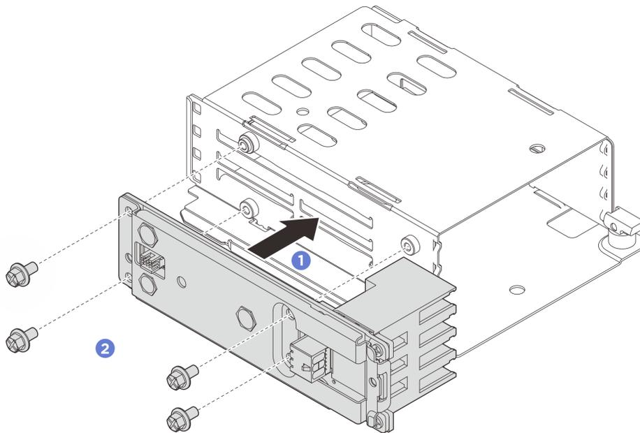
**그림 64. 백플레인 어셈블리 설치**
