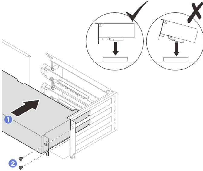
**그림 71. PCIe 어댑터 설치**
