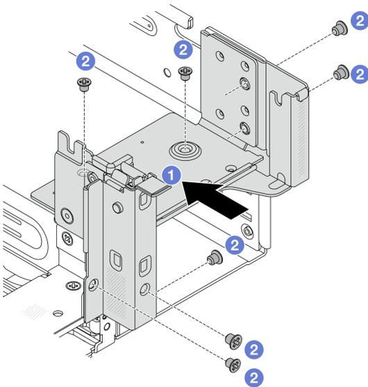
그림 237. 오른쪽 뒷면 벽 브래킷 설치
