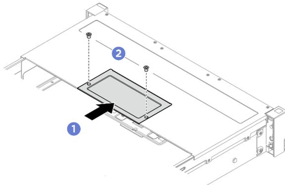
**그림 40. 덮개판 설치**
