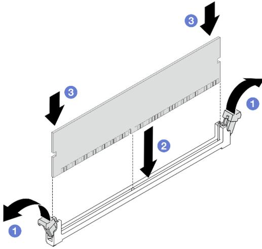
**그림 197. 메모리 모듈 설치**
