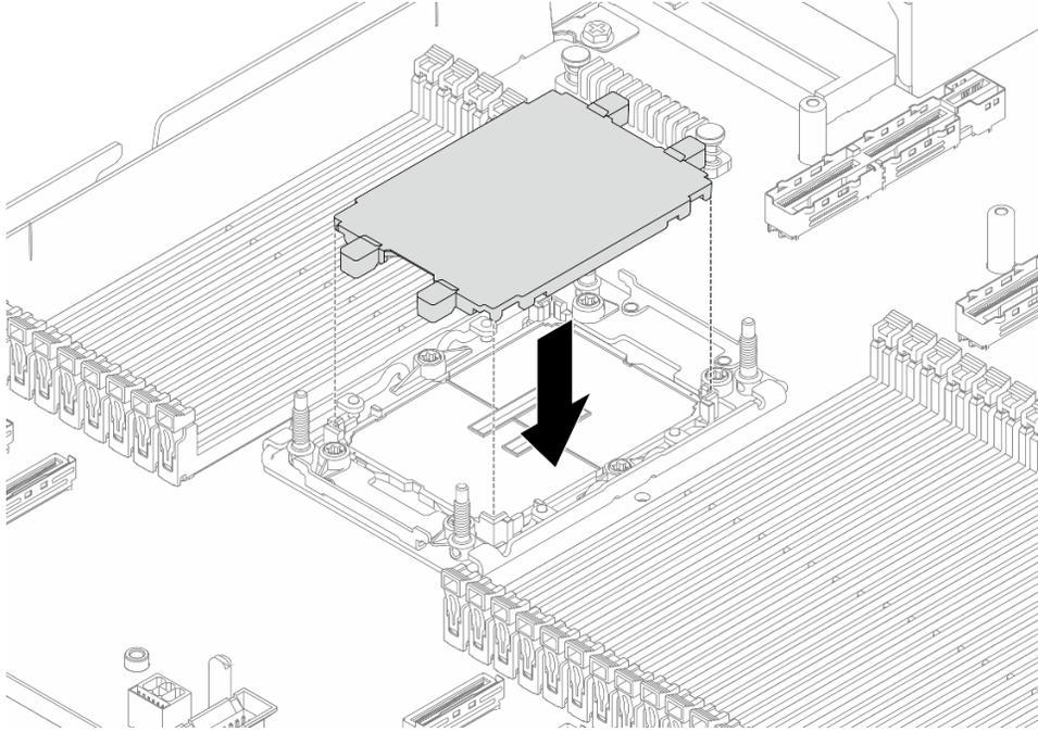
**그림 110. 프로세서 소켓 덮개 설치**
