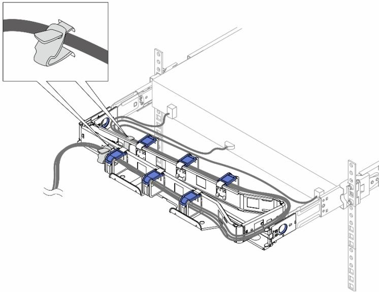
**Atenção:** Deslize cuidadosamente o servidor para frente e para trás para assegurar que os cabos não se tocam, se unam nem ficam pendurados no espaço em U diretamente abaixo do servidor.
