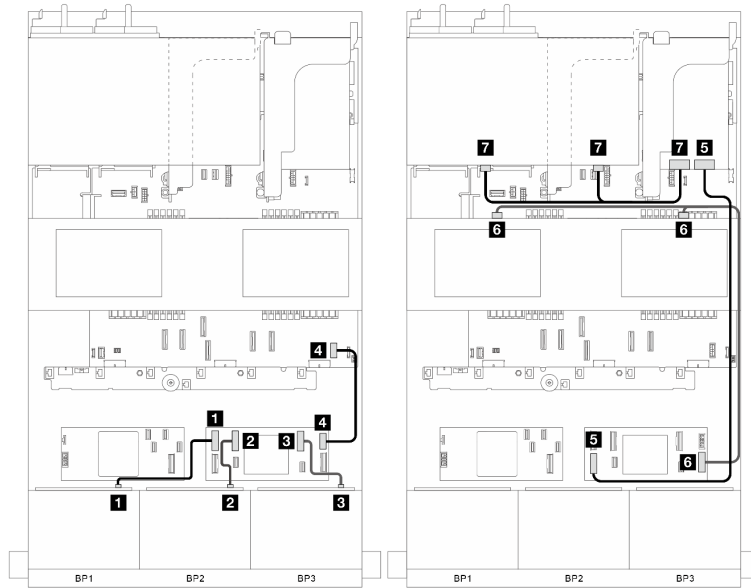
Figura 354. Disposición de los cables de señal
