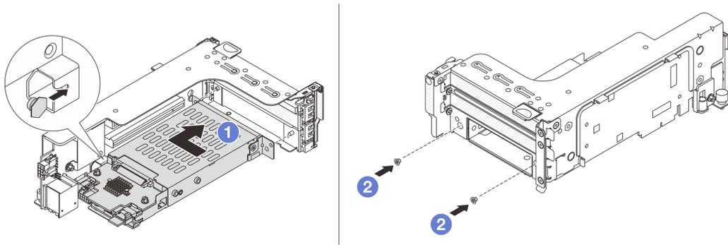
**그림 210. 라이저 어셈블리에 7mm 드라이브 케이스 설치**
