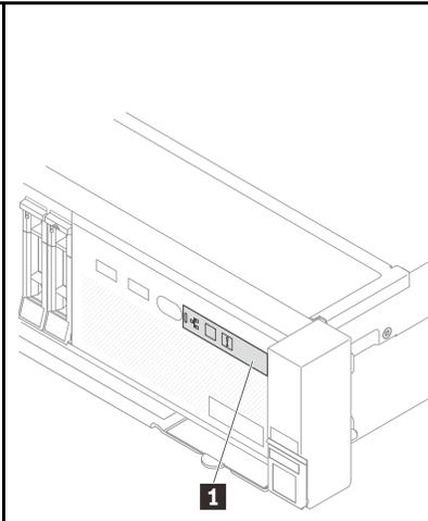
그림 6. 앞면 오퍼레이터 패널(LCD 디스플레이 미포함)
