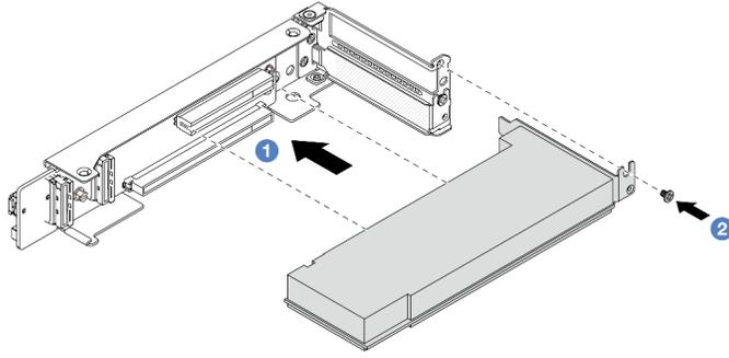
**그림 145. 4LP 라이저 3/4 어셈블리에 PCIe 어댑터 설치**
