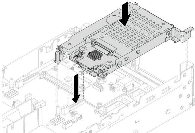
**그림 212. 7mm SSD 라이저 케이스 설치**
