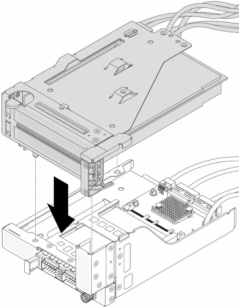
**그림 43. 앞면 OCP 어셈블리에 라이저 5 어셈블리 설치**
