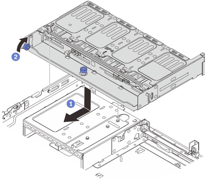
**그림 220. 8 x 2.5인치 드라이브 후면 케이지 설치**
