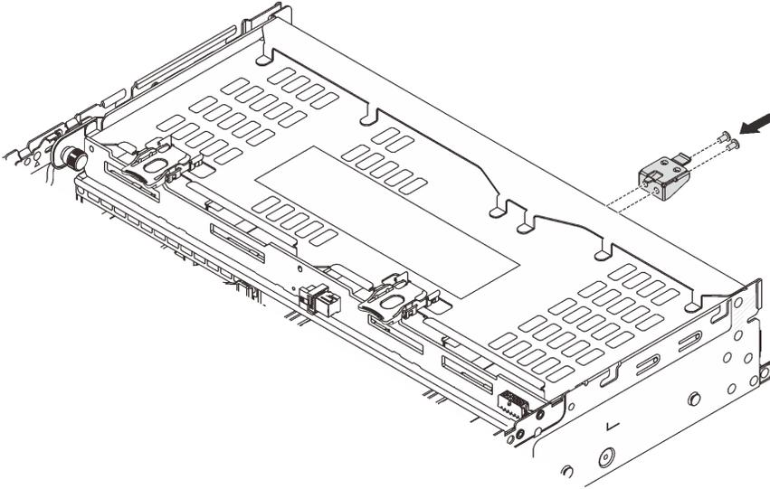
그림 229. 상단 덮개 지원 브라켓 설치
