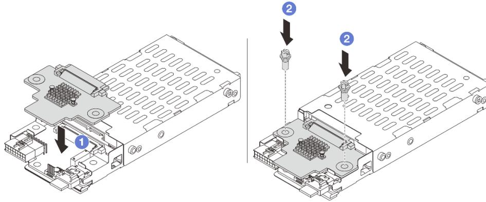
그림 208. 7mm 드라이브 백플레인 설치(상단)
