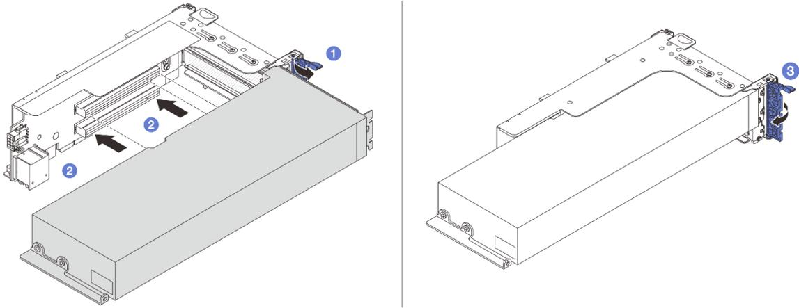
**그림 88. GPU 어댑터 설치**
