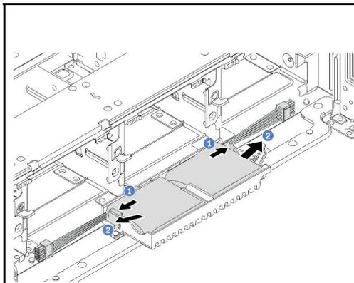
그림 179. Supercap Holder에서 RAID 플래시 전원 모듈 제거
