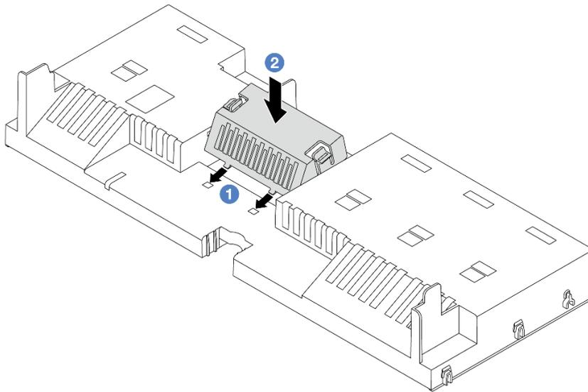
**그림 29. 공기 조절 장치 필터 설치**
