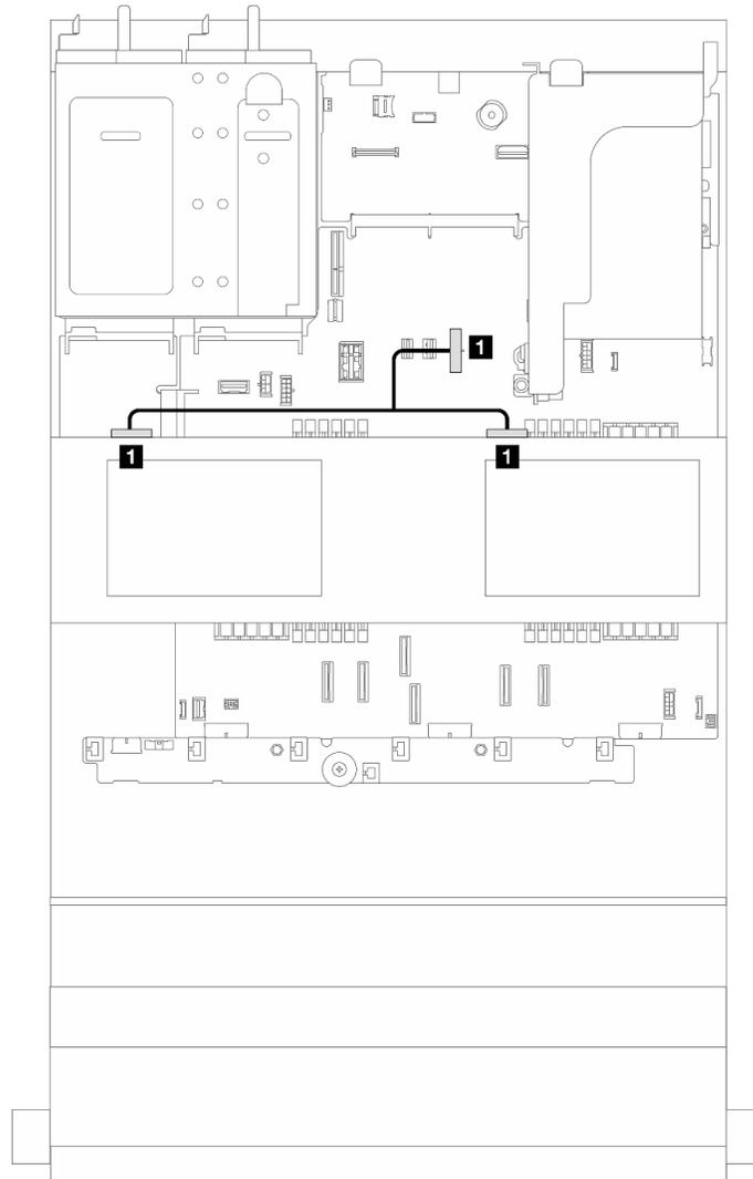
**그림 381. 4 x 2.5인치 중간 드라이브 백플레인 2개의 전원 케이블 배선**
