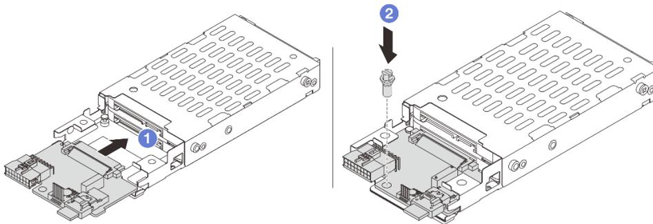
**그림 207. 7mm 드라이브 백플레인 설치(하단)**
