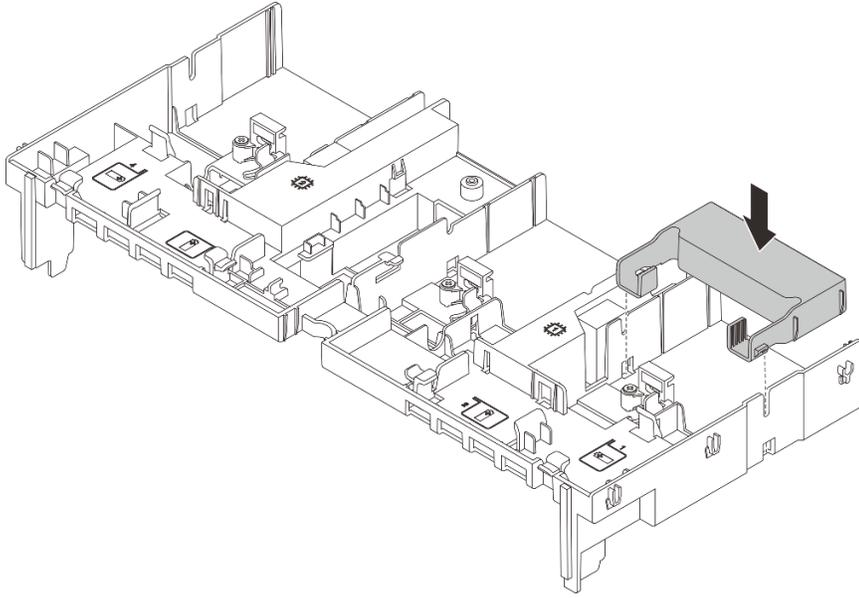
**그림 89. 추가 공기 조절 장치 설치**
