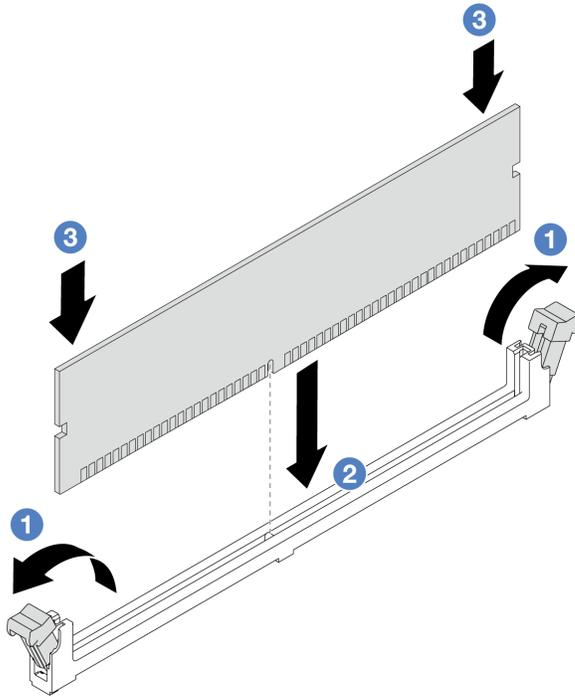
그림 121. 메모리 모듈 설치
