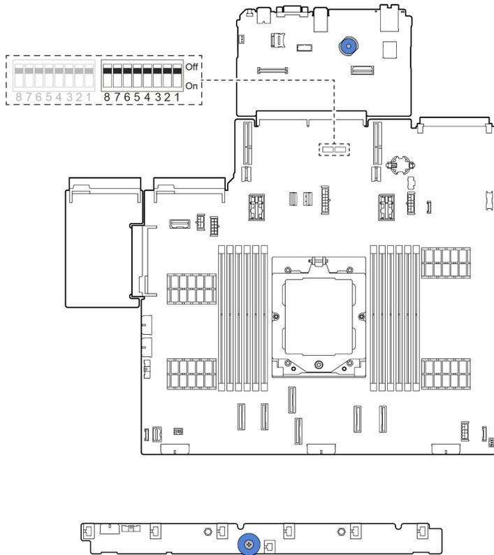
그림 12. 시스템 보드 어셈블리의 스위치 블록
