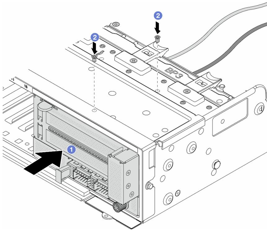
**그림 54. 앞면 어댑터 어셈블리 설치**
