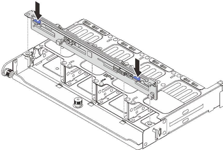
그림 219. 8 x 2.5인치 뒷면 드라이브 백플레인 설치
