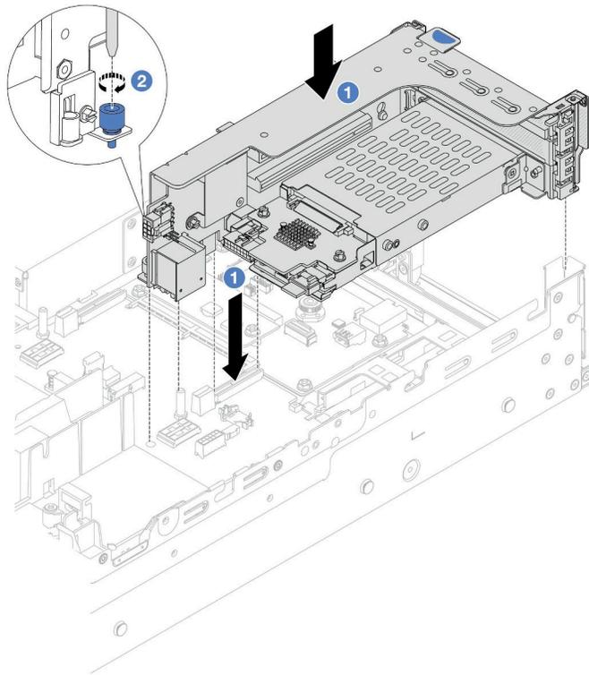
**그림 211. 2FH+7mm SSD 라이저 케이스 설치**
