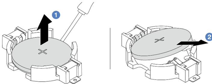
**그림 31. CMOS 배터리 제거**
