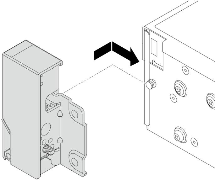
그림 172. 랙 래치 설치
