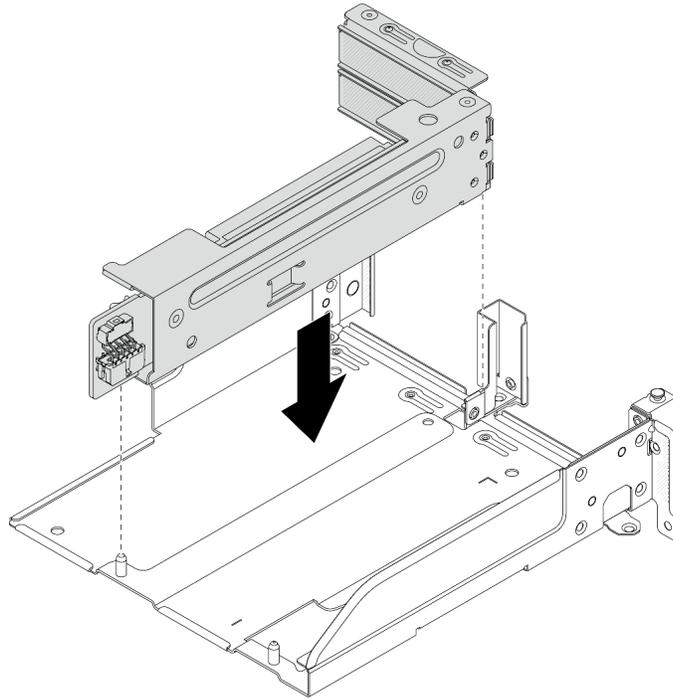
**그림 149. 라이저 3/4 어셈블리 설치**
