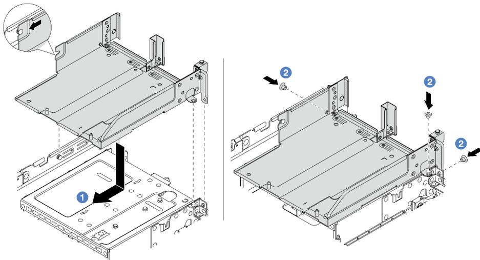
**그림 148. 라이저 케이스 트레이 설치**
