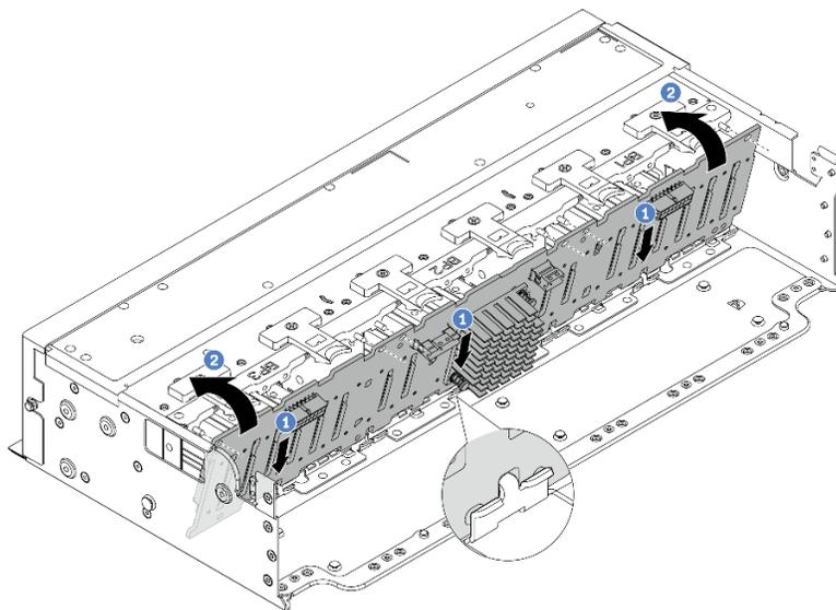
그림 71. 24베이 확장기 백플레인 설치
