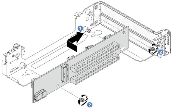
그림 141. 라이저 카드 3 설치
