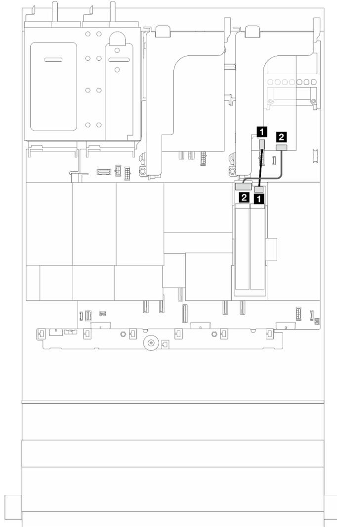
**그림 287. M.2 드라이브 백플레인의 RAID 케이블 배선**
