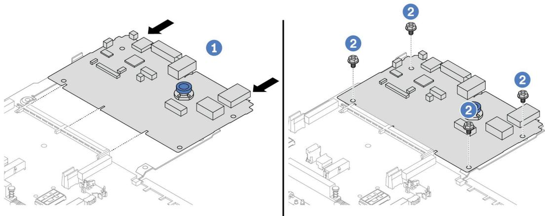
그림 240. 프로세서 보드에 시스템 I/O 보드 설치
