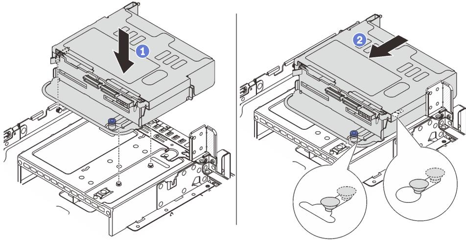
그림 216. 4 x 2.5인치 드라이브 후면 케이스 설치
