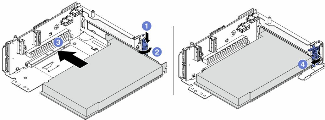
그림 62. 라이저 5 케이스에 PCIe 어댑터 설치
