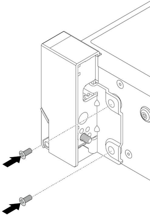
**그림 173. 나사 설치**
