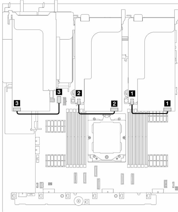
그림 281. GPU 어댑터의 케이블 배선
