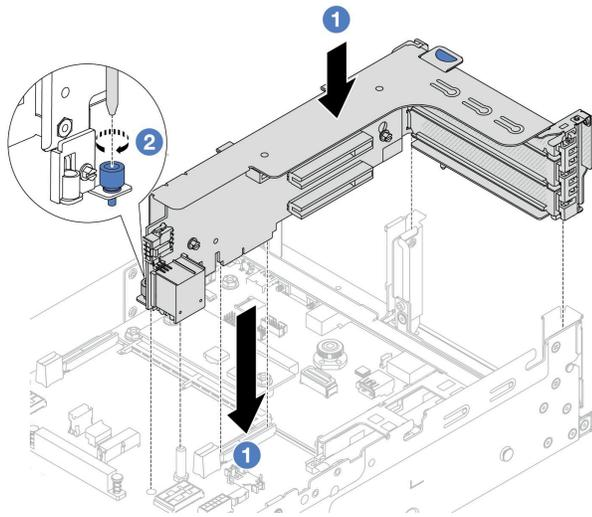
**그림 146. 라이저 1 어셈블리 설치**
