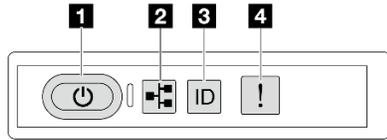
그림 408. 앞면 오퍼레이터 패널 LED
