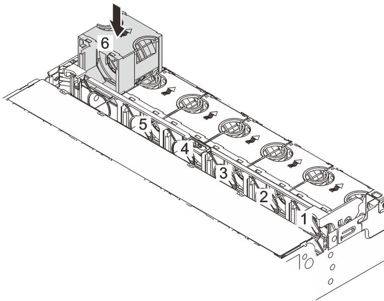
그림 246. 시스템 팬 설치
