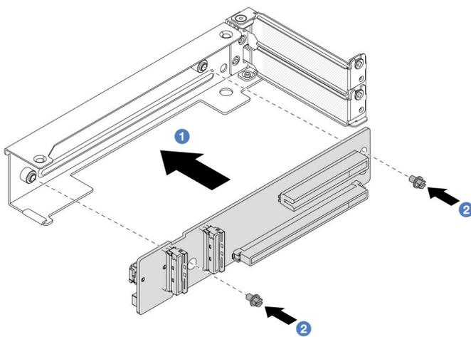
그림 142. 4LP 라이저 3/4 케이스에 라이저 카드 설치
