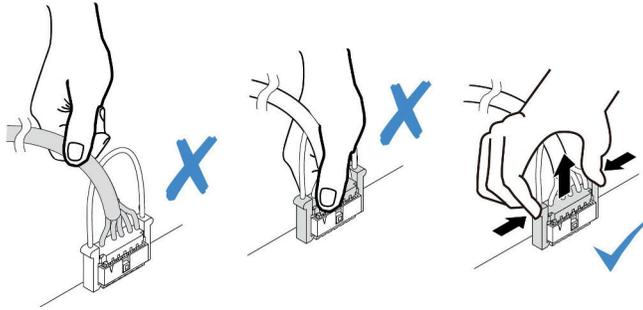
**그림 249. 시스템 I/O 보드에서 케이블 분리**
