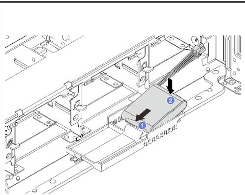
그림 186. Supercap Holder에 RAID 플래시 전원 모듈 설치
