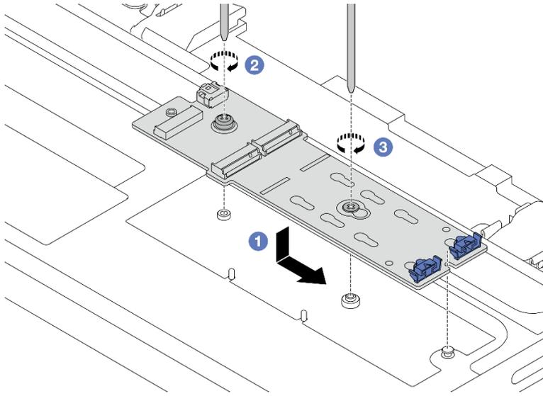
**그림 114. 중간 드라이브 케이스에 M.2 백플레인 설치**
