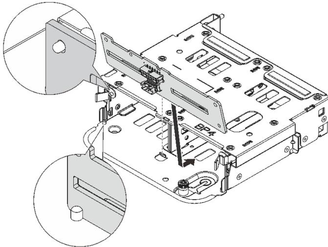
그림 215. 4 x 2.5인치 뒷면 드라이브 백플레인 설치
