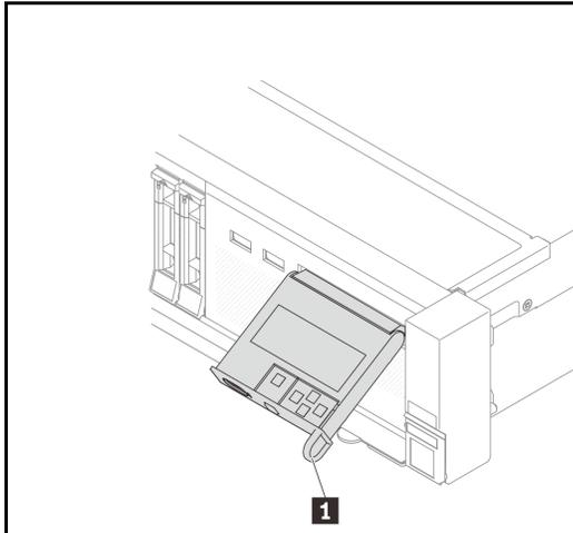
그림 5. 내장형 진단 패널(LCD 디스플레이 포함)
