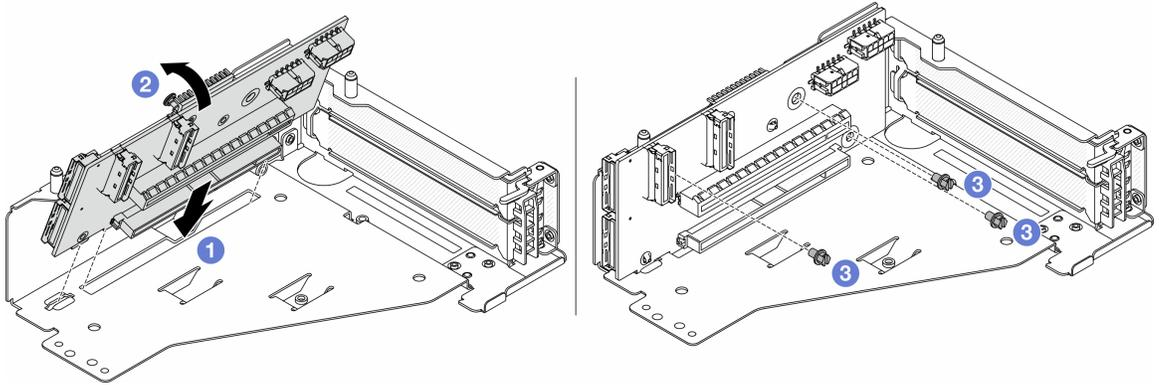
그림 61. 라이저 카드 설치
