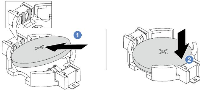
그림 32. CMOS 배터리 설치
