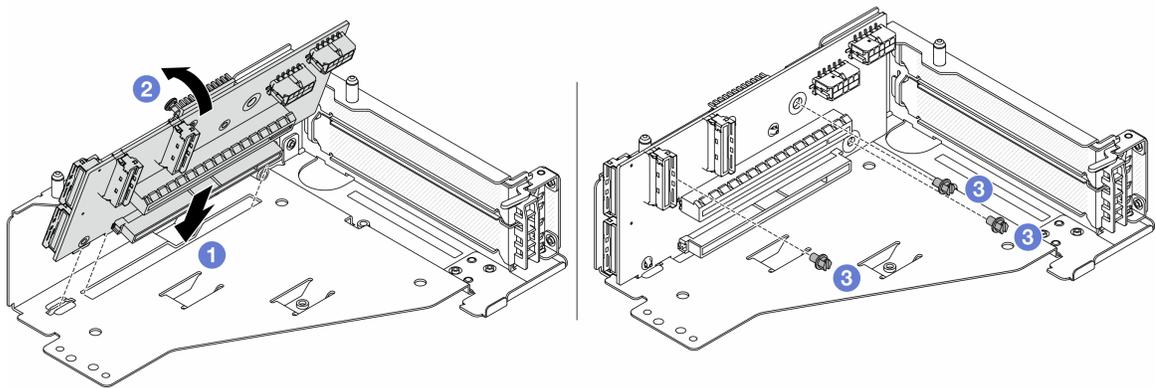
**그림 41. 라이저 카드 설치**
