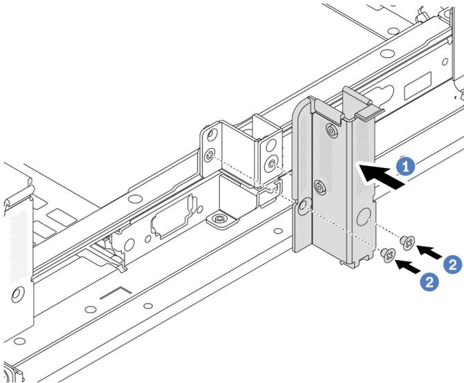
**그림 199. B1 뒷면 벽 브래킷 설치(중간)**
