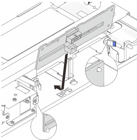
그림 127. 중간 2.5인치 드라이브 백플레인 설치
