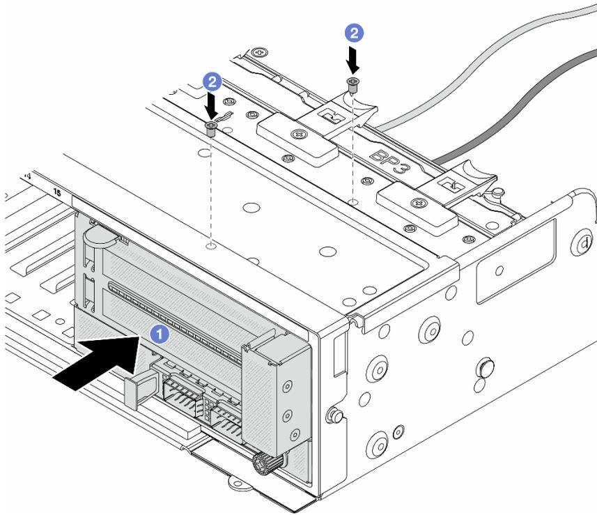
**그림 44. 앞면 어댑터 어셈블리 설치**
