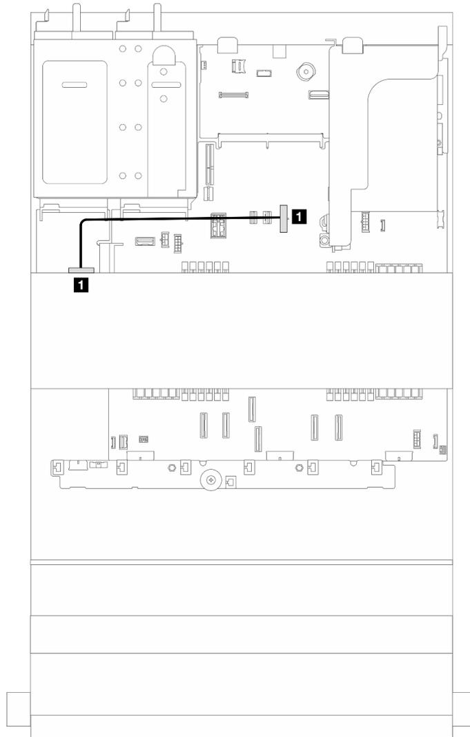
**그림 380. 4 x 2.5인치 또는 4 x 3.5인치 중간 드라이브 백플레인 1개의 전원 케이블 배선**
