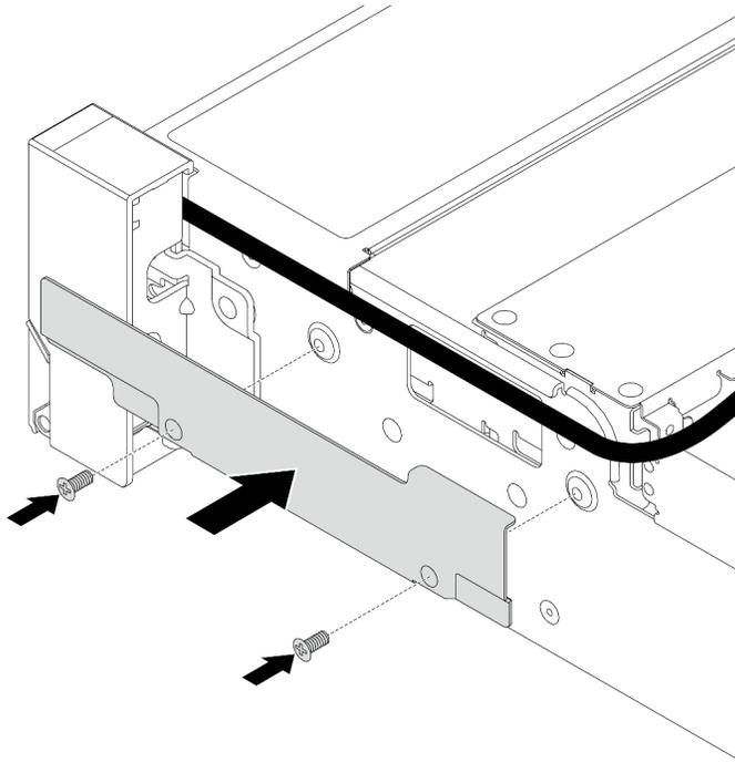
**그림 174. 케이블 고정장치 설치**
