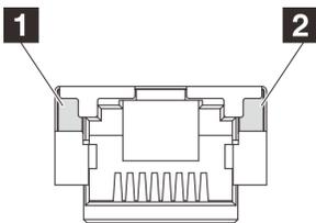
**그림 409. XCC 시스템 관리 포트(10/100/1000Mbps RJ-45) LED**
