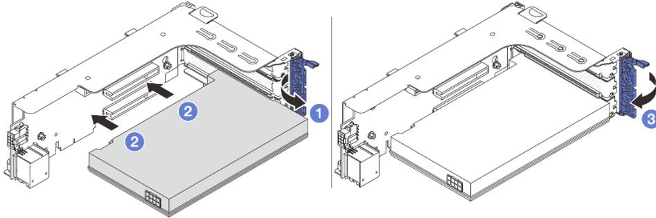
그림 143. 라이저 1 또는 2 어셈블리에 PCIe 어댑터 설치
