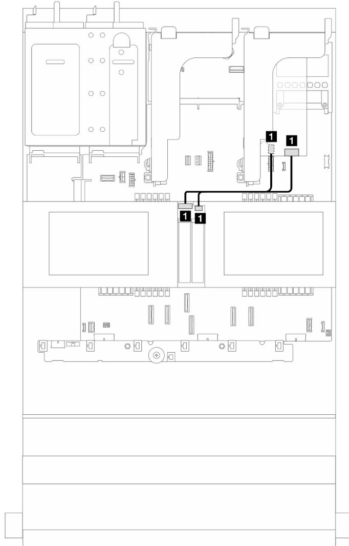
**그림 285. M.2 드라이브 백플레인의 RAID 케이블 배선**
