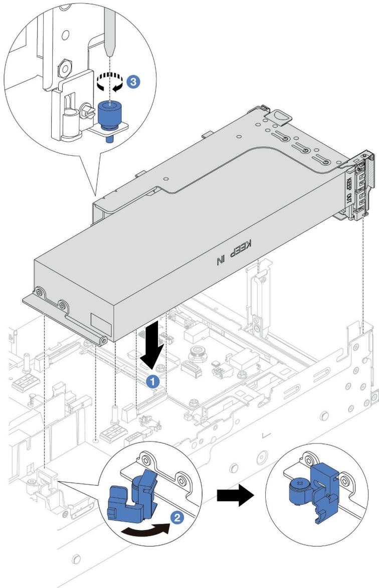
**그림 90. GPU 어댑터로 라이저 1 어셈블리 설치**
