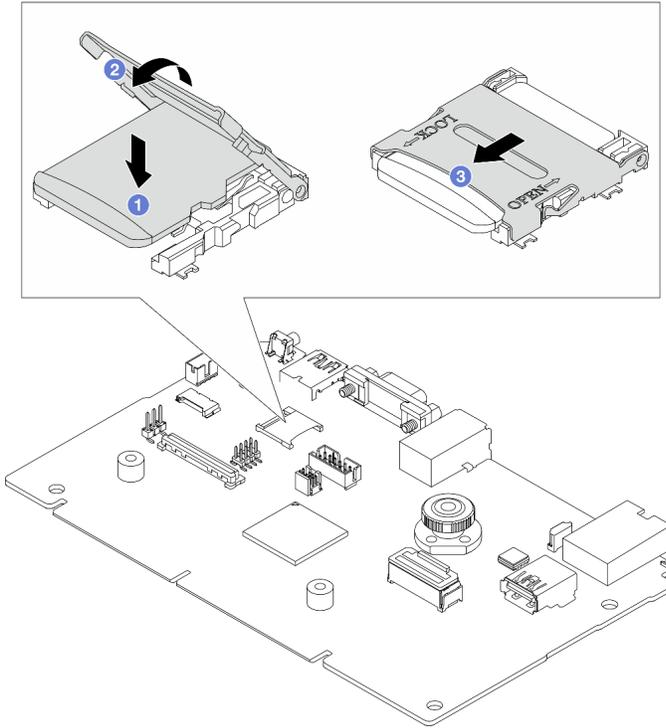
그림 123. MicroSD 카드 설치
