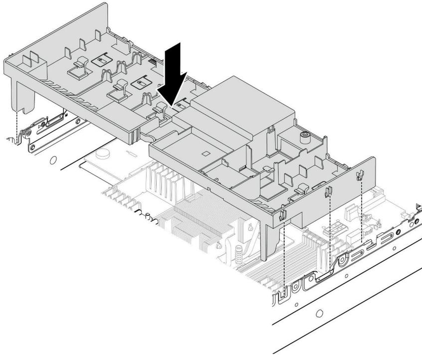
그림 30. 공기 조절 장치 설치
