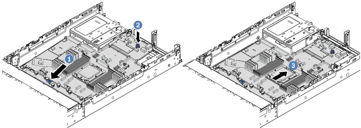
**그림 241. 시스템 보드 어셈블리 설치**
