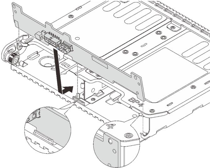
**그림 223. 2 x 3.5인치 뒷면 드라이브 백플레인 설치**
