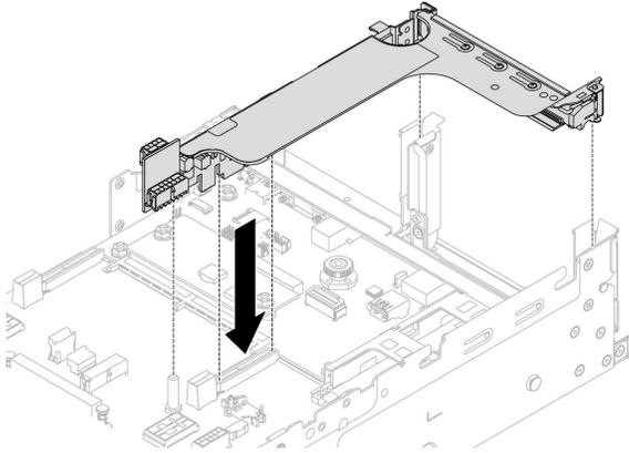
**그림 255. 라이저 어셈블리 설치**
