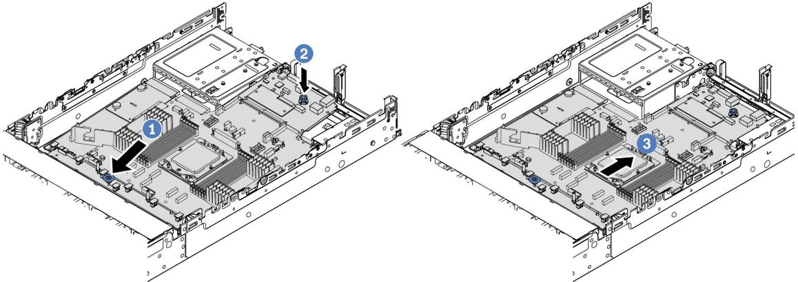
그림 244. 시스템 보드 어셈블리 설치
