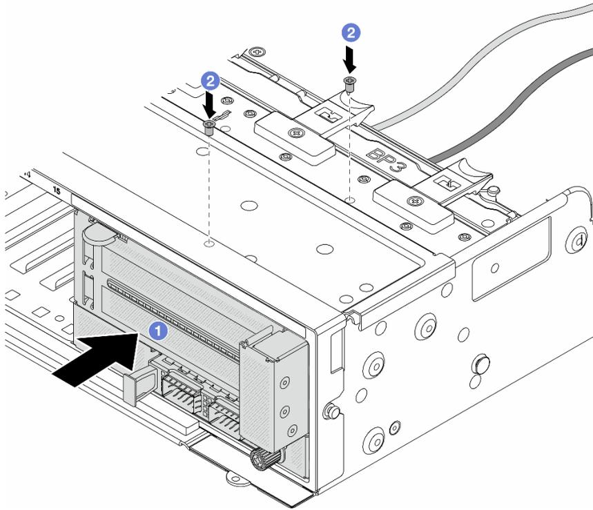
**그림 64. 앞면 어댑터 어셈블리 설치**
