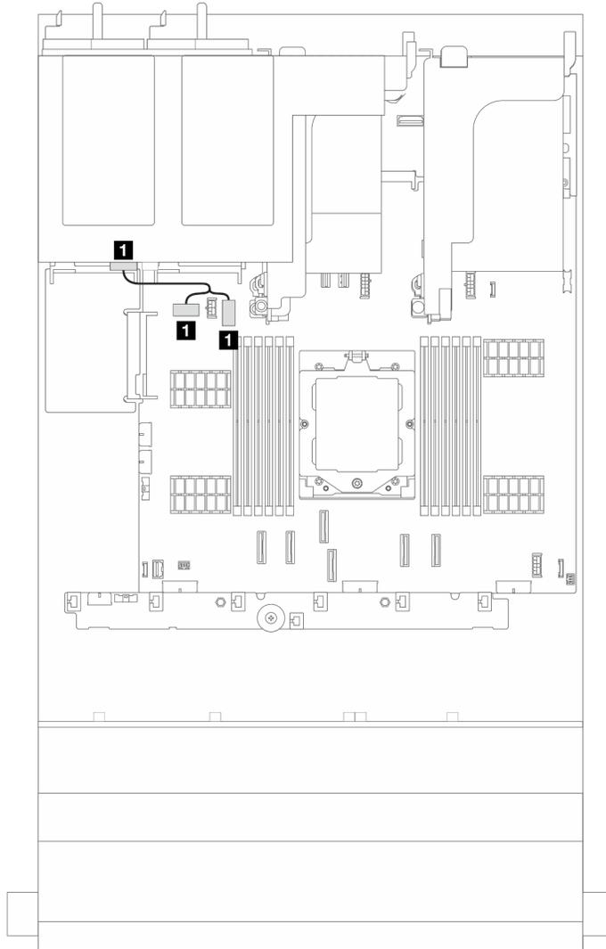
**그림 378. 2 x 3.5인치 및 4 x 2.5인치 뒷면 드라이브 백플레인의 전원 케이블 배선**
