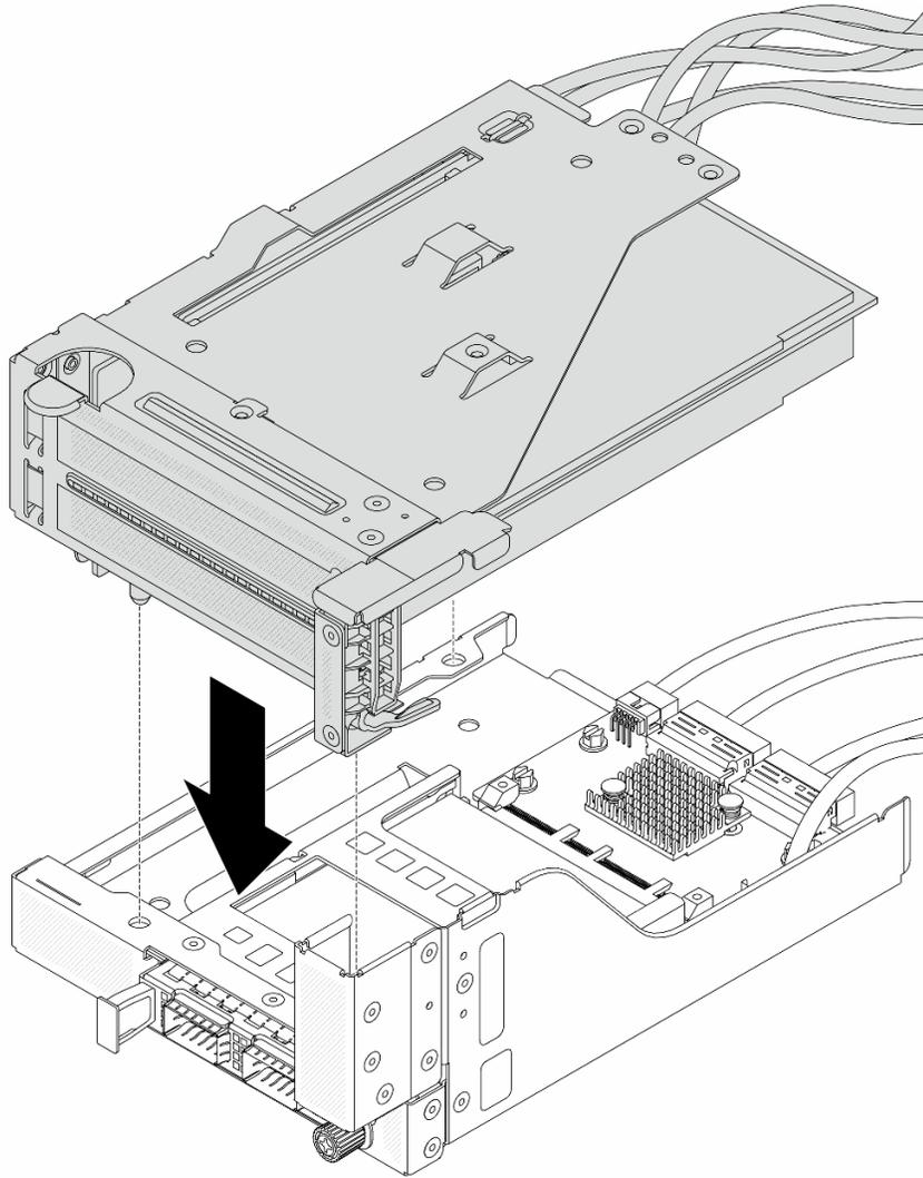
**그림 53. 앞면 OCP 어셈블리에 레이저 5 어셈블리 설치**
