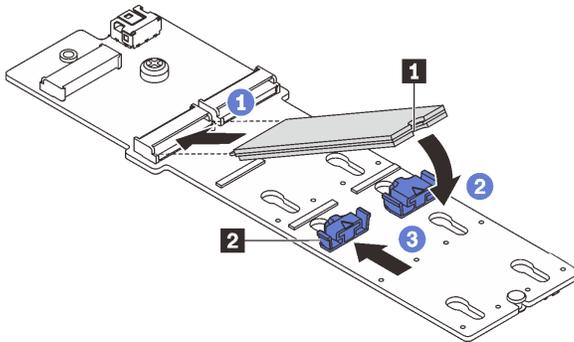
**그림 107. M.2 드라이브 설치**
