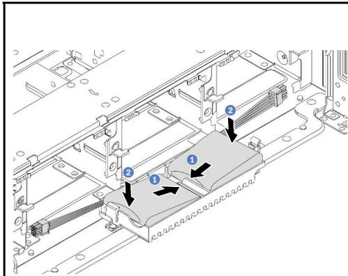
그림 185. Supercap Holder에 RAID 플래시 전원 모듈 설치
