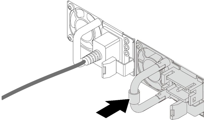
**그림 159. 전원 공급 장치 설치**
