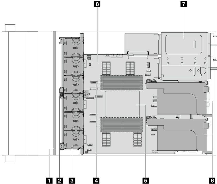
그림 9. 서버 평면도
