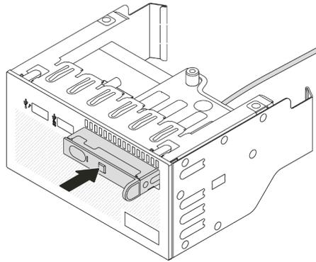
**그림 80. 내장형 진단 패널 설치**
