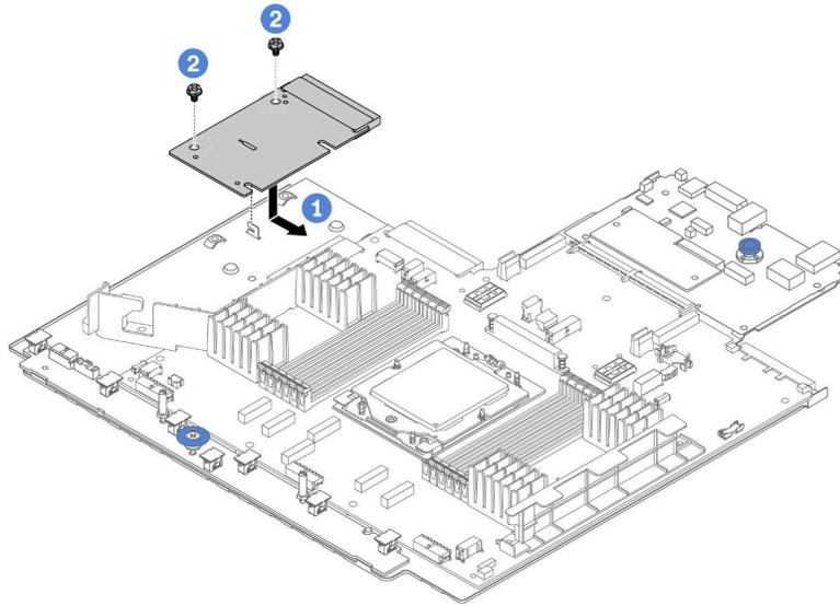
그림 155. PIB 설치
