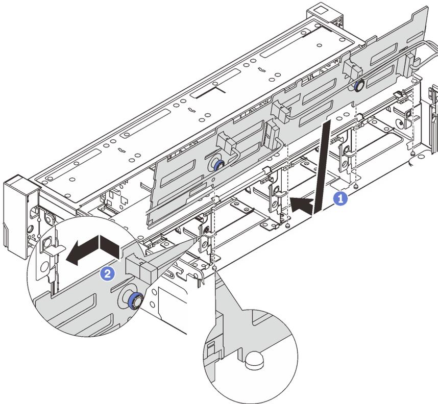
그림 73. 3.5인치 드라이브 백플레인 설치
