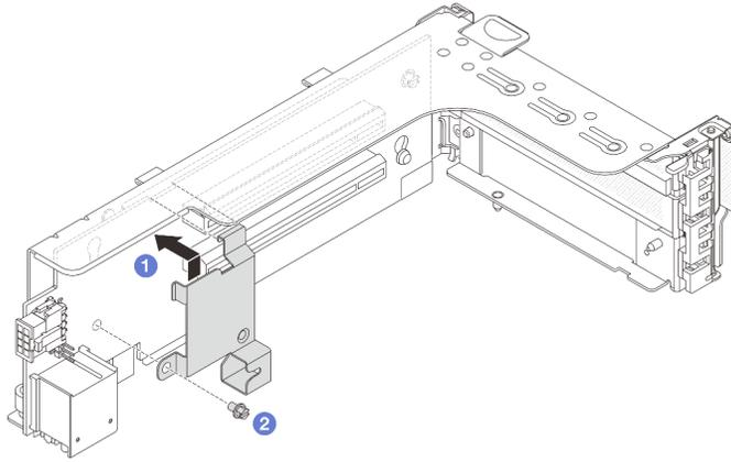
**그림 209. 7mm 드라이브 케이스 고정 클립 설치**
