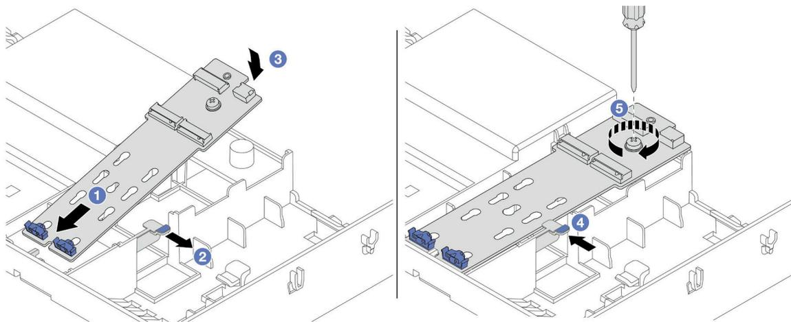
그림 113. 공기 조절 장치에 M.2 백플레인 설치
