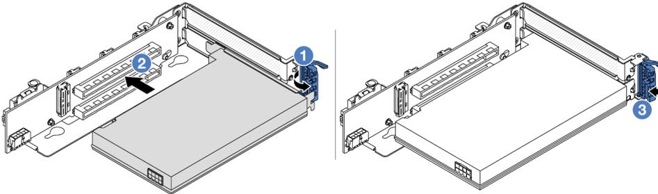
그림 144. 라이저 3 어셈블리에 PCIe 어댑터 설치
