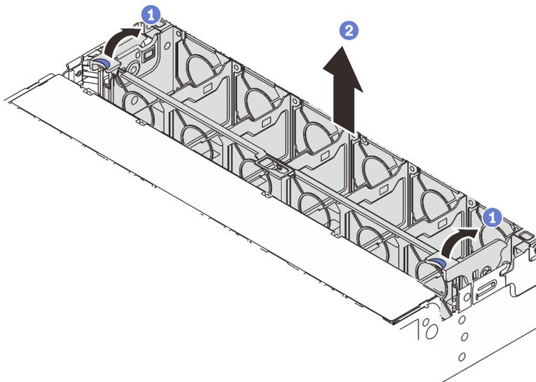
그림 247. 시스템 팬 케이스 제거
