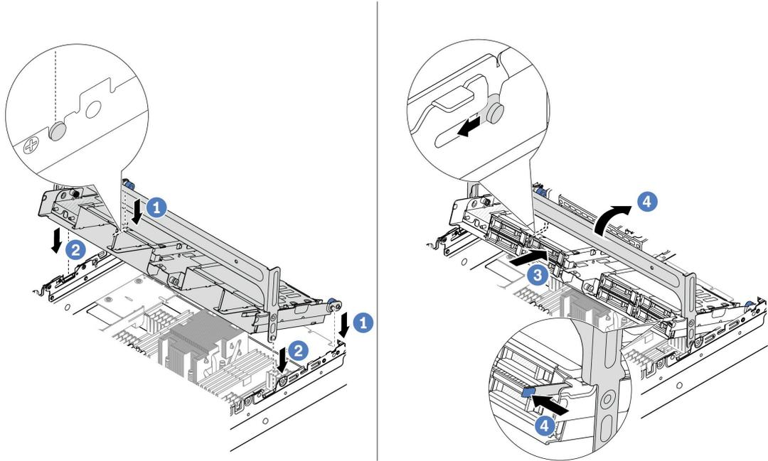
**그림 129. 중간 드라이브 케이지 및 드라이브 설치**
