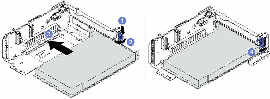
**그림 42. 라이저 5 케이스에 PCIe 어댑터 설치**
