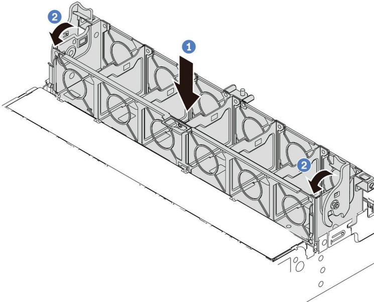
그림 248. 시스템 팬 케이스 설치
