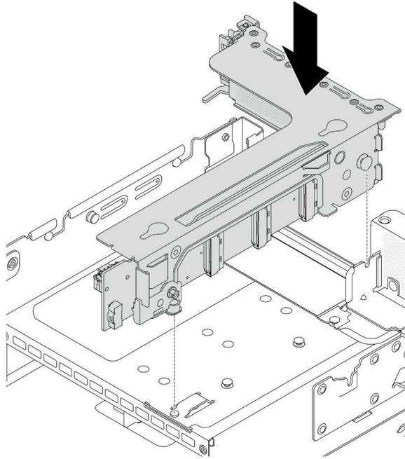
**그림 147. 라이저 3 어셈블리 설치**
