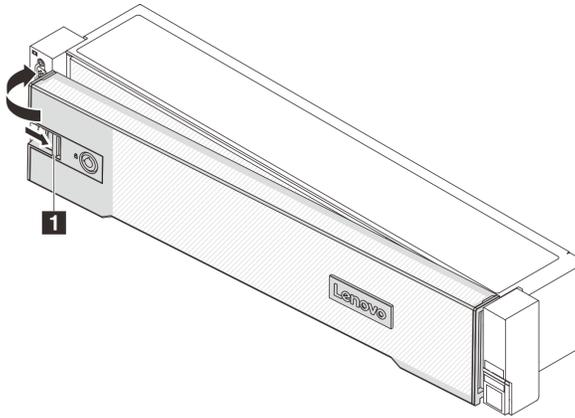
그림 233. 보안 베젤 설치
