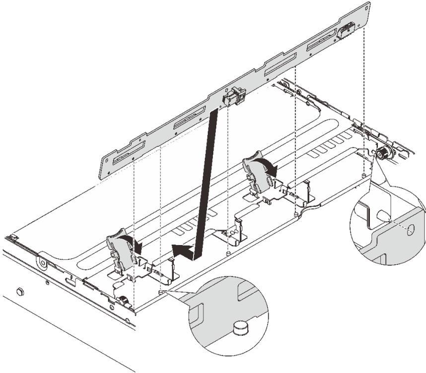
**그림 128. 중간 3.5인치 드라이브 백플레인 설치**
