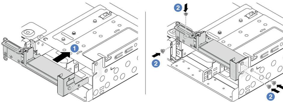
**그림 200. C1 뒷면 벽 브래킷 설치(오른쪽)**
