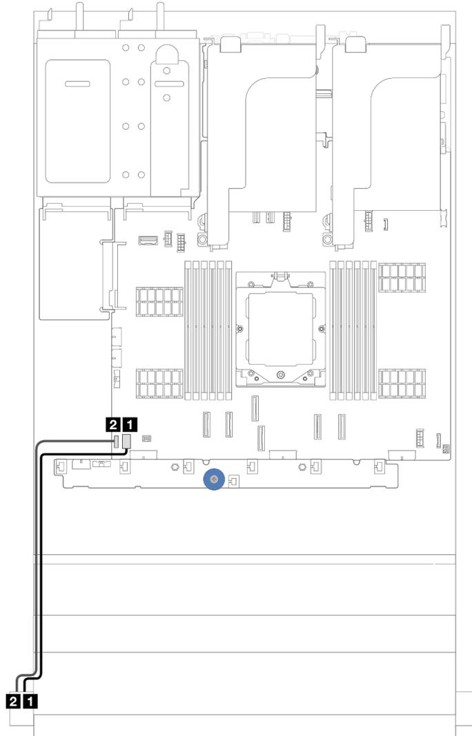
그림 272. 앞면 VGA 커넥터 및 외부 진단 커넥터의 케이블 배선
