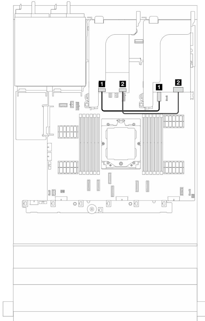
그림 275. 7mm 드라이브 백플레인의 RAID 케이블 배선
