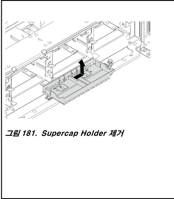
그림 181. Supercap Holder 제거
