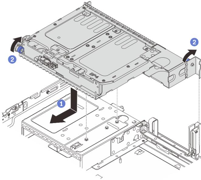
그림 224. 2 x 3.5인치 드라이브 후면 케이스 설치
