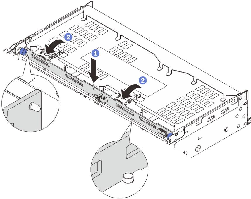
**그림 227. 4 x 3.5인치 뒷면 드라이브 백플레인 설치**
