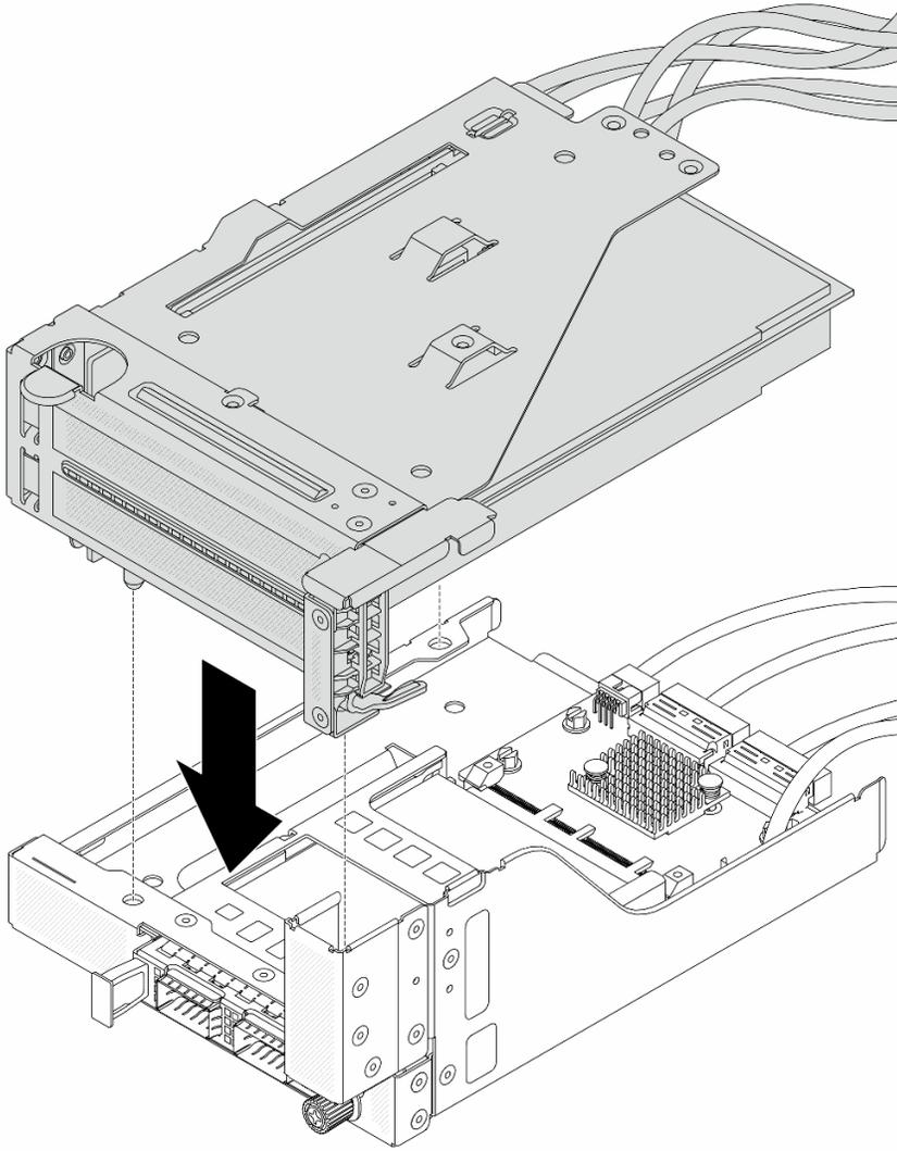
**그림 63. 앞면 OCP 어셈블리에 라이저 5 어셈블리 설치**
