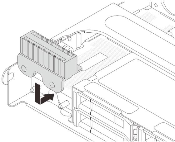
**그림 194. 고무 설치**
