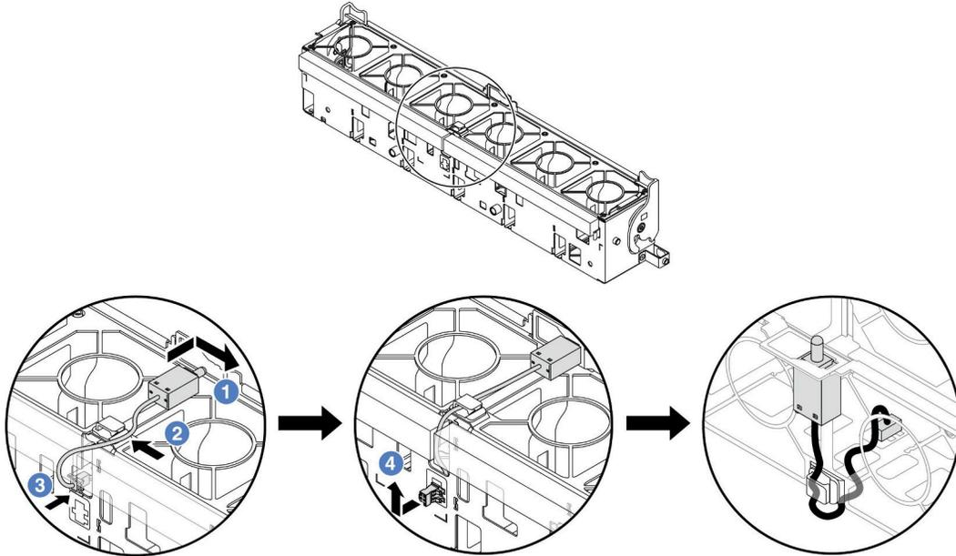
**그림 103. 침입 스위치 설치**
