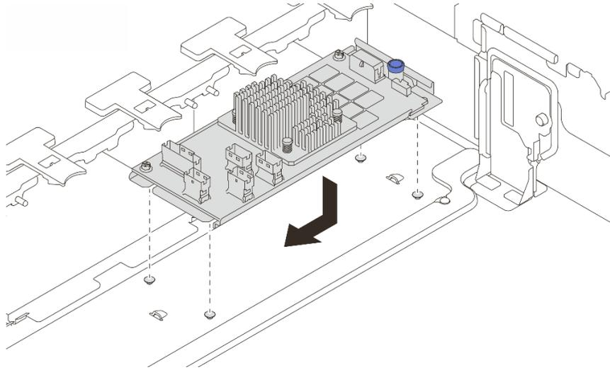
**그림 100. 내부 CFF 어댑터 설치**
