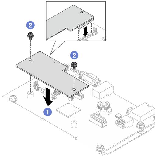
그림 237. 펌웨어 및 RoT 보안 모듈 설치
