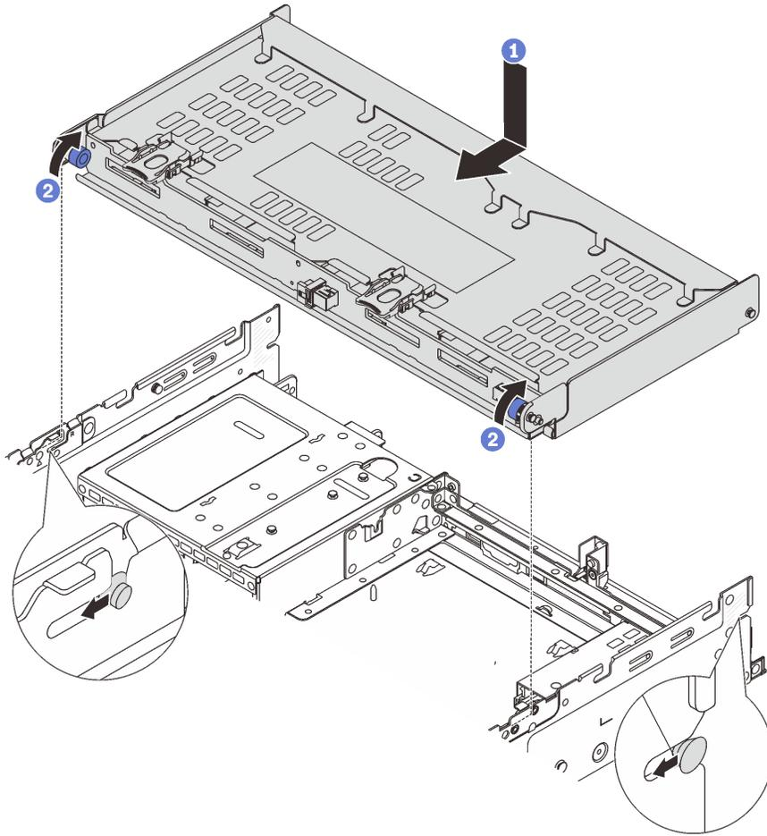
**그림 228. 4 x 3.5인치 뒷면 드라이브 케이지 설치**
