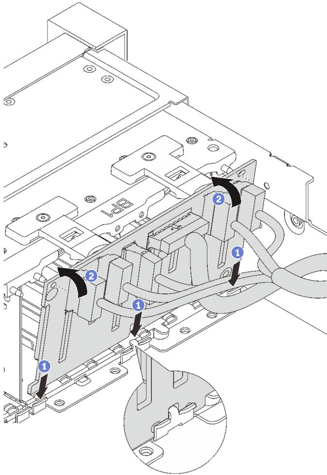
그림 70. 2.5인치 드라이브 백플레인 설치
