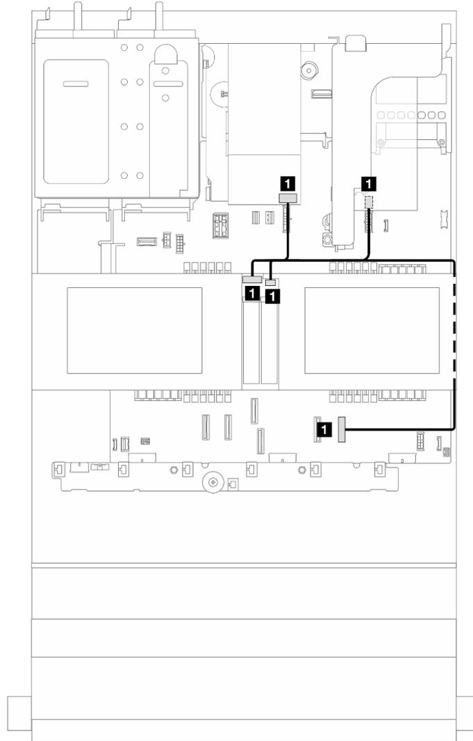
그림 290. M.2 드라이브 백플레인의 케이블 배선(7mm 백플레인 사용 시)
