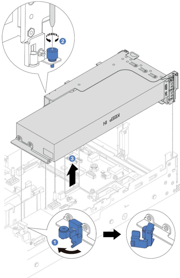
그림 85. GPU 어댑터로 라이저 1 어셈블리 제거
