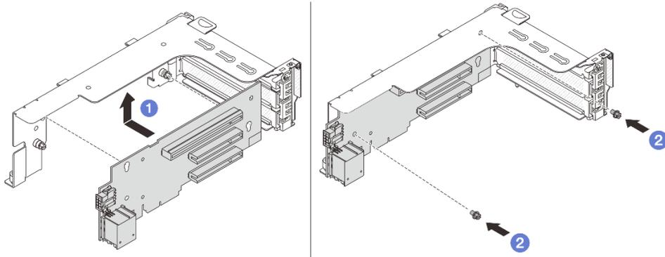
그림 140. 라이저 카드 1 설치
