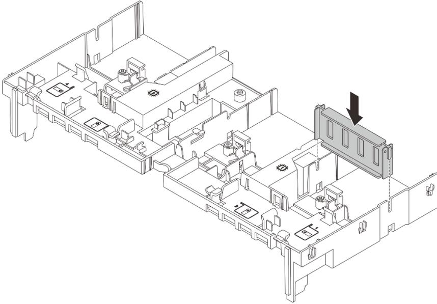
**그림 91. GPU 공기 조절 장치 필터 설치**
