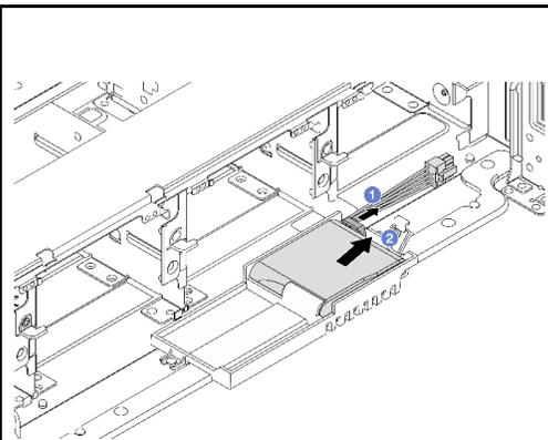
그림 180. Supercap Holder에서 RAID 플래시 전원 모듈 제거
