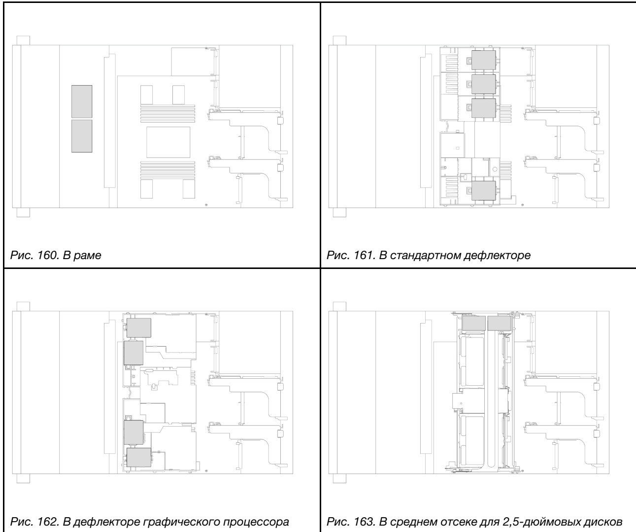
Табл. 4. Расположение модулей питания флэш-памяти RAID
