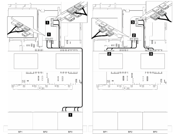
Рис. 352. Прокладка сигнальных кабелей, часть 2
