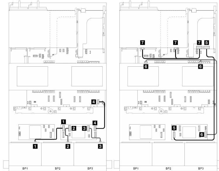
Рис. 346. Прокладка сигнальных кабелей
