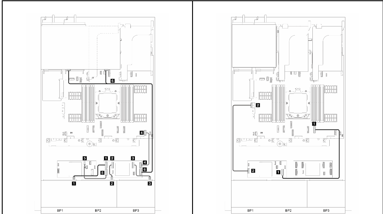
Рис. 350. Прокладка сигнальных кабелей, часть 1
