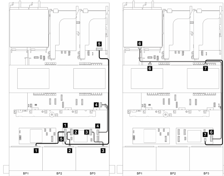
Рис. 358. Прокладка сигнальных кабелей
