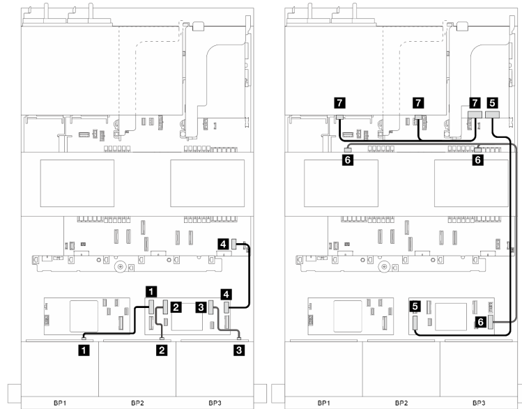
Рис. 361. Прокладка сигнальных кабелей
