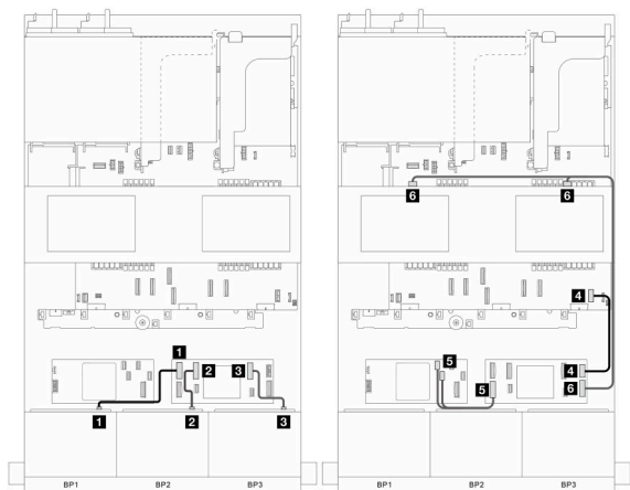
圖例 352. 信號線佈線第 1 部分
