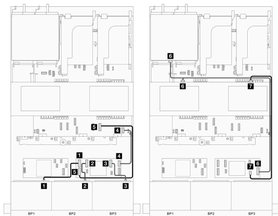
圖例 349. 信號線佈線第 1 部分
