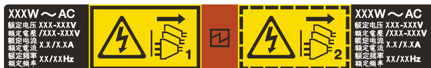
Рис. 238. Этикетка оперативно заменяемого блока питания на крышке
