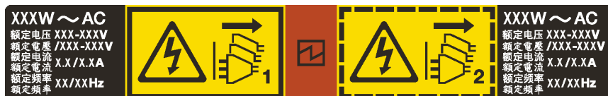
รูปภาพ 238. ป้ายแหล่งจ่ายไฟแบบ Hot-swap บนฝาครอบ
