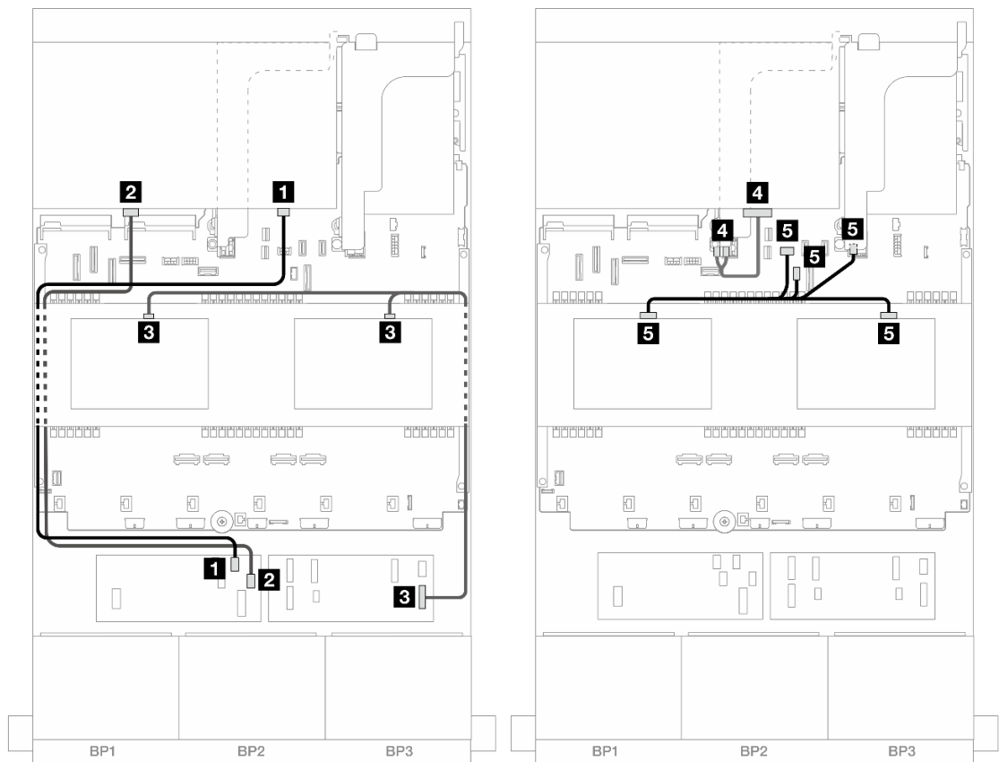
Abbildung 474. Kabelführung der mittleren/hinteren Rückwandplatine
