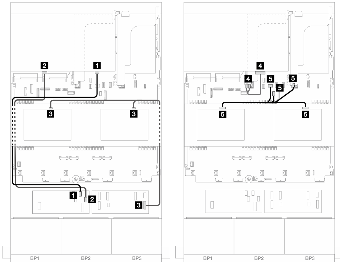
Abbildung 470. Kabelführung der mittleren/hinteren Rückwandplatine
