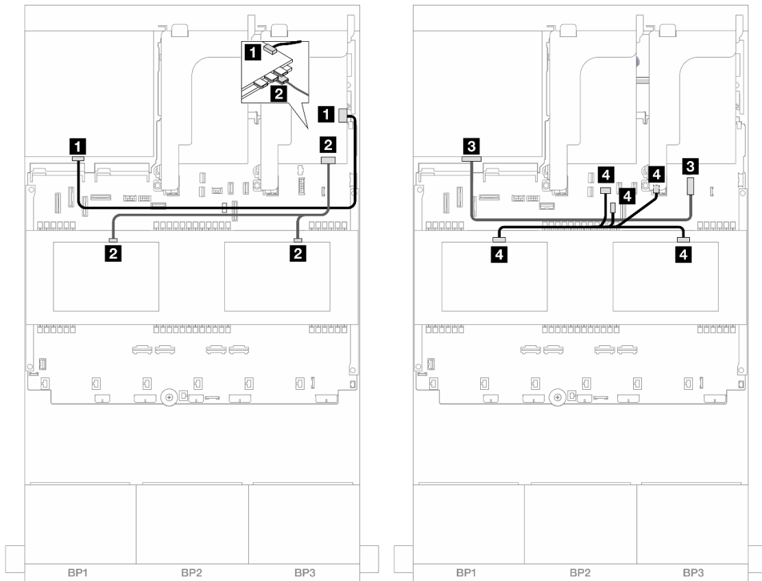
Abbildung 460. Kabelführung der mittleren/hinteren Rückwandplatine
