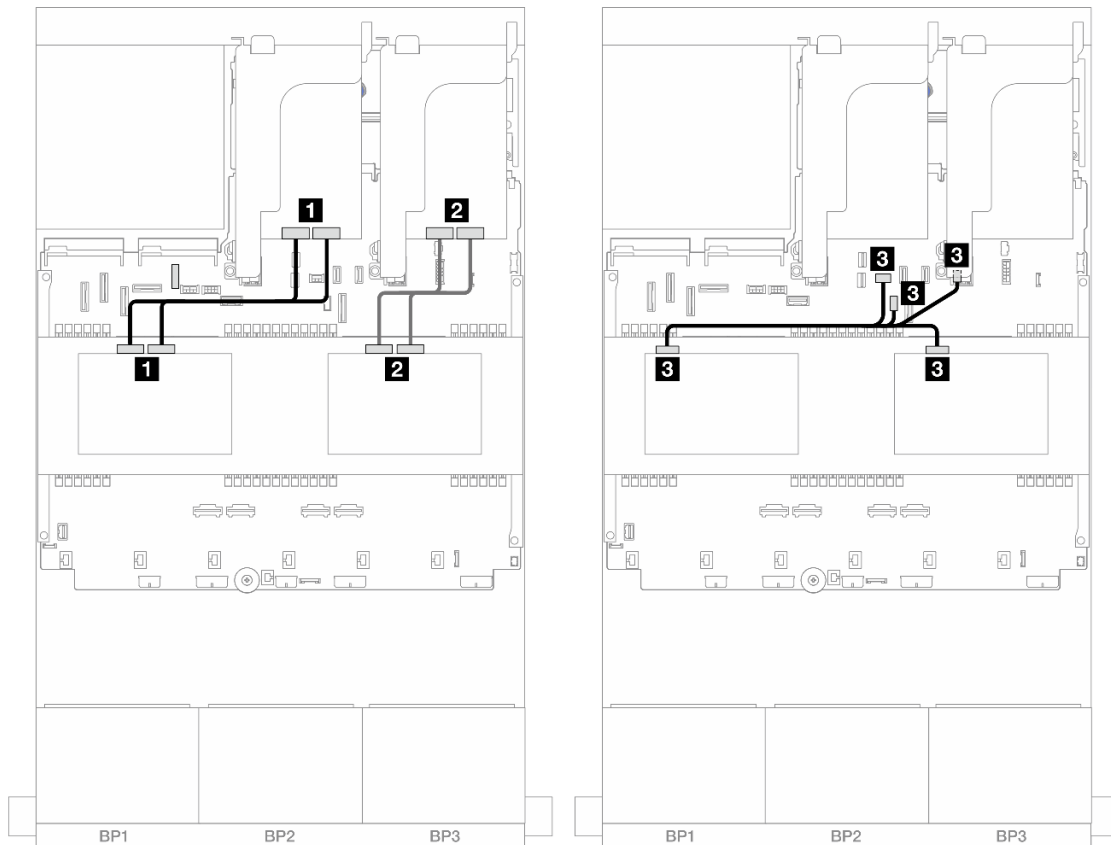
Abbildung 494. Kabelführung der mittleren Rückwandplatine
