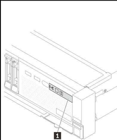
Figura 6. Panel frontal del operador (sin pantalla LCD)
