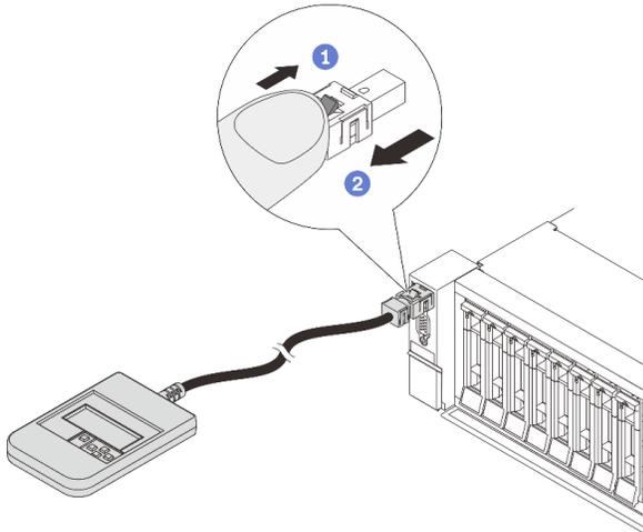
Paso 1. Presione el clip de plástico en el conector en la dirección que se muestra.
