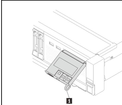
Figura 5. Panel de diagnóstico integrado (con pantalla LCD)
